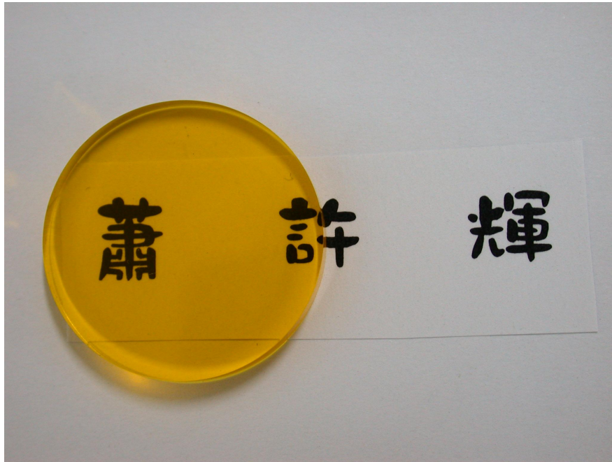
圖 A-1 PQ:PMMA 樣品的碟型照片，厚度約為 4 mm，直徑約為 2.54 cm。從照片中可以知道，我們所自行製作而成的樣品，光學品質相當良好，在樣品後方的字清晰可見，與右方的“輝”字相當。
