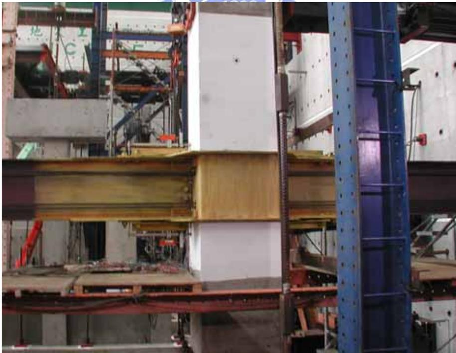
照片 3.21 試體 3 梁柱接合形式
