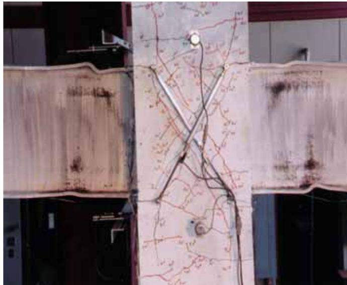
圖 1.1 鋼梁挫屈 (Courtesy : Chou & Uang 2002)
