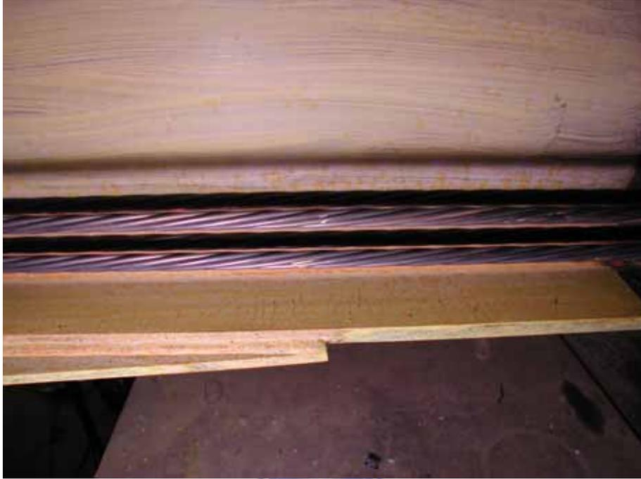
照片 3.22 試體 3 梁翼加勁板外之梁腹板與梁翼板內側降伏( $\theta = 0.03 \text{ rad}$ )
