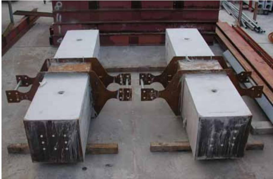
照片 3.3 試體 4 與試體 5 鋼筋混凝土柱製作完成
