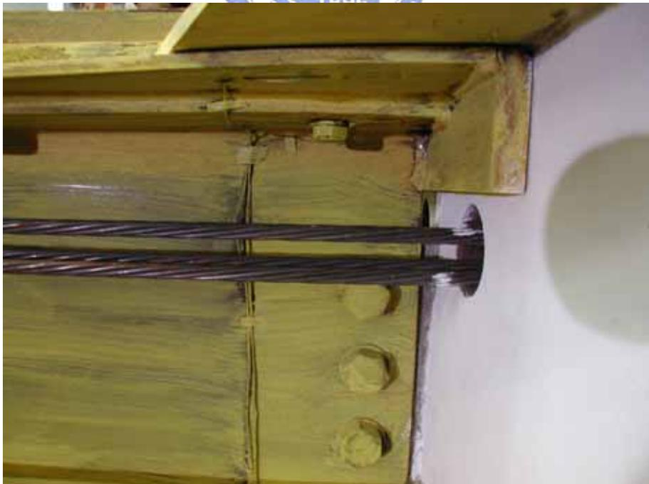
照片 3.8 試體 1 承壓板內側梁腹板降伏
