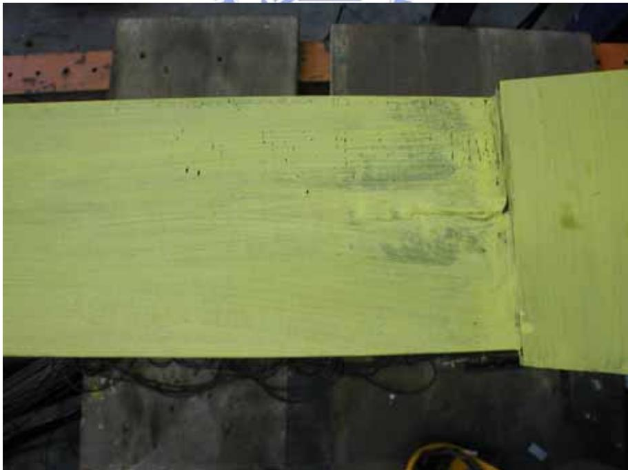
照片 3.10 試體 1 梁翼加勁板外側產生降伏( $\theta = 0.03 \text{ rad}$ )
