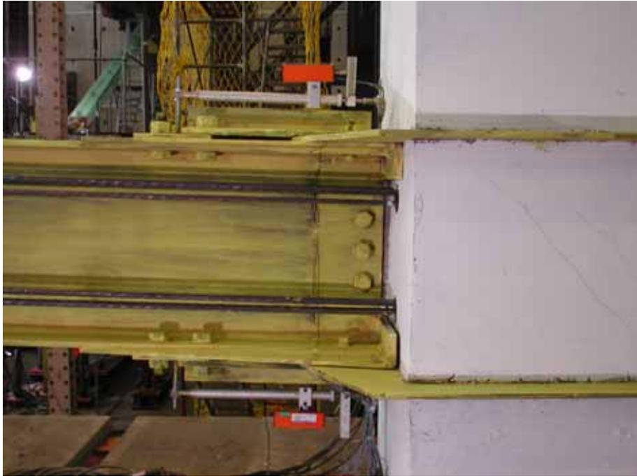
照片 3.11 試體 1 梁柱分離情形( $\theta = 0.03$  rad)
