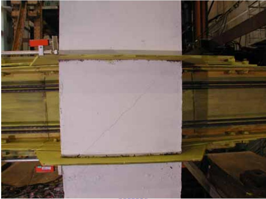
照片 3.9 試體 1 梁柱交會區混凝土剪力裂縫( $\theta = 0.005 \text{ rad}$ )
