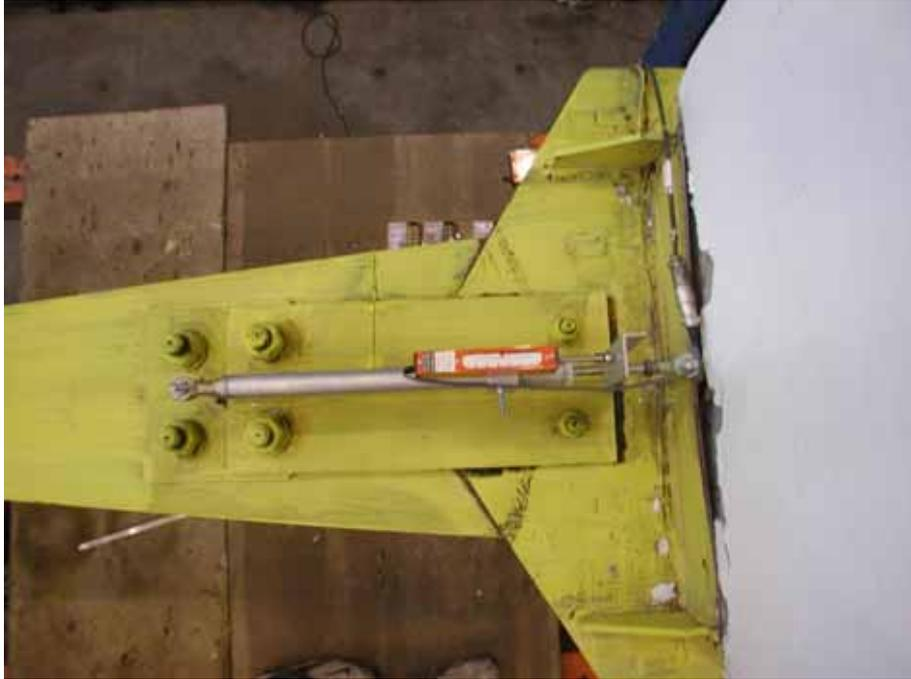
照片 3.32 試體 5 削切鋼板降伏( $\theta = 0.03 \text{ rad}$ )
