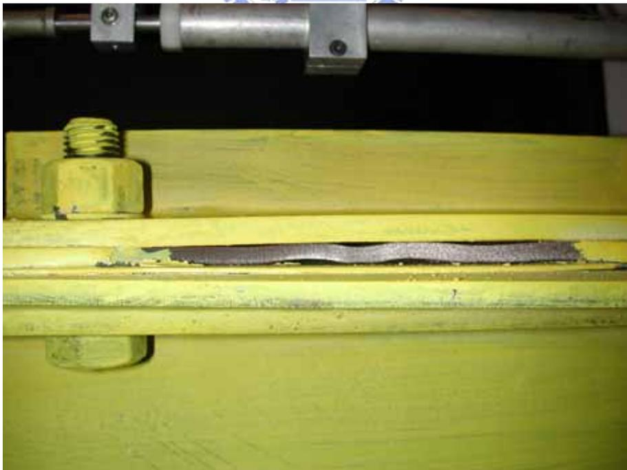
照片 3.18 試體 2 削切鋼板產生高模態挫屈( $\theta = 0.05 \text{ rad}$ )
