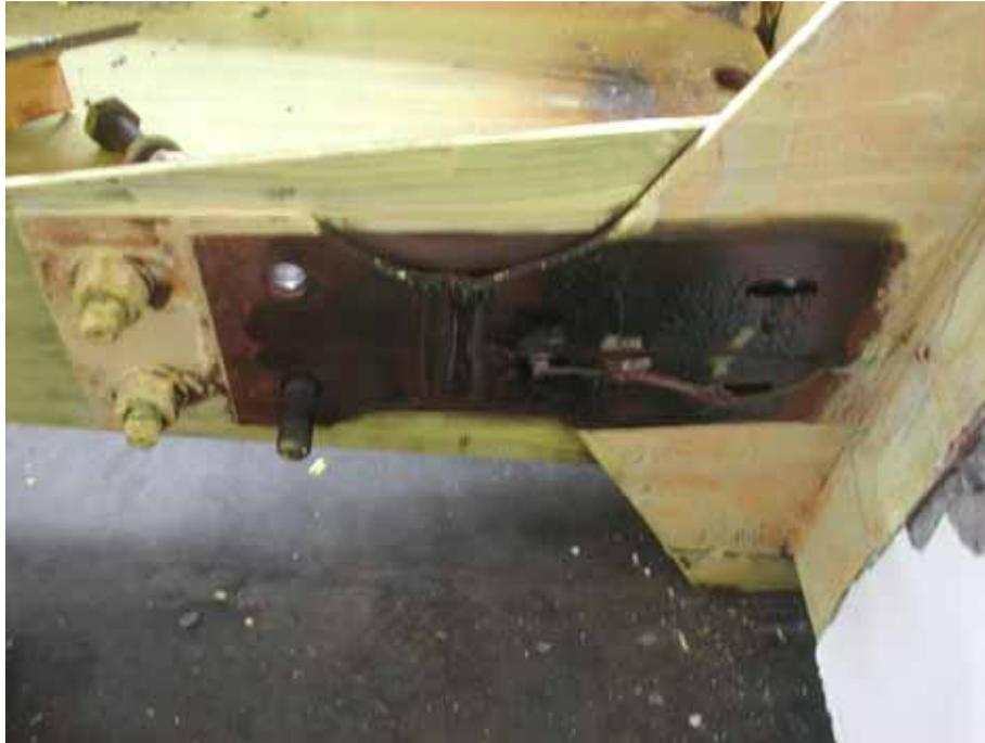
照片 3.30 試體 4 削切鋼板受拉產生斷裂( $\theta = 0.05 \text{ rad}$ )
