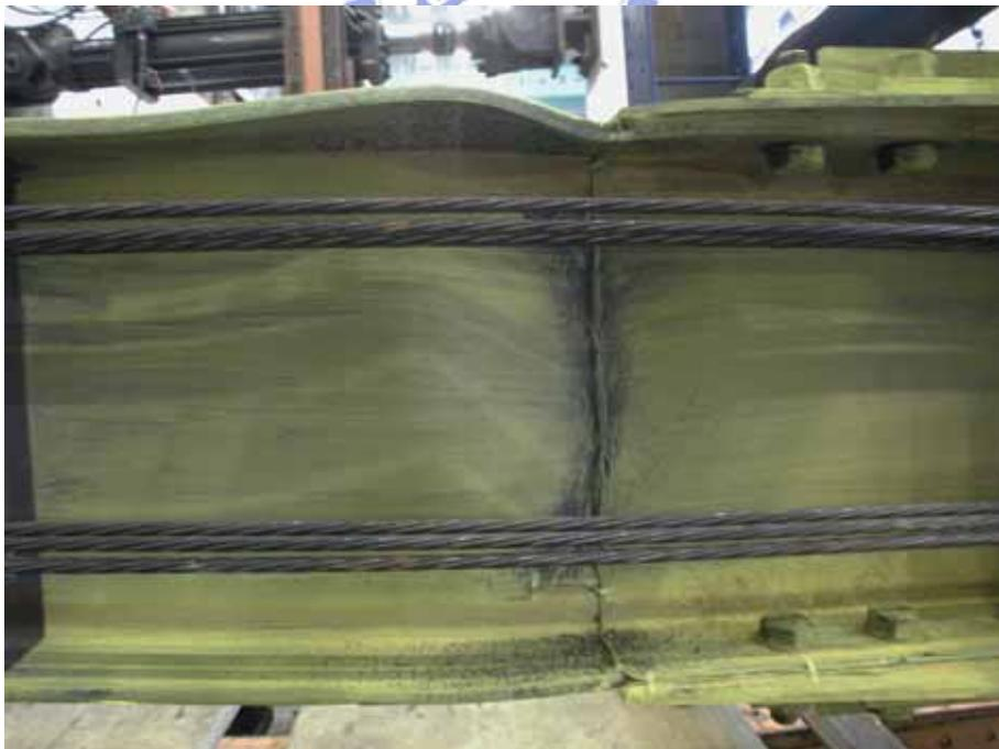
照片 3.14 試體 1 梁上下翼板皆挫屈( $\theta = 0.04 \text{ rad}$ )
