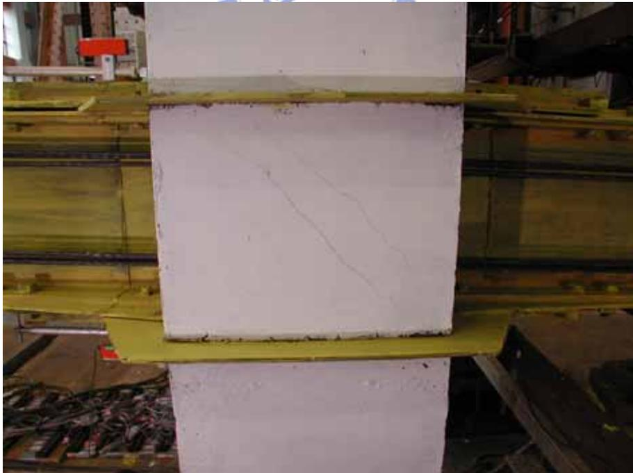
照片 3.12 試體 1 梁柱接頭區剪力裂縫
