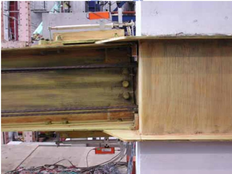
照片 3.23 試體 3 梁柱介面分離( $\theta = 0.04 \text{ rad}$ )
