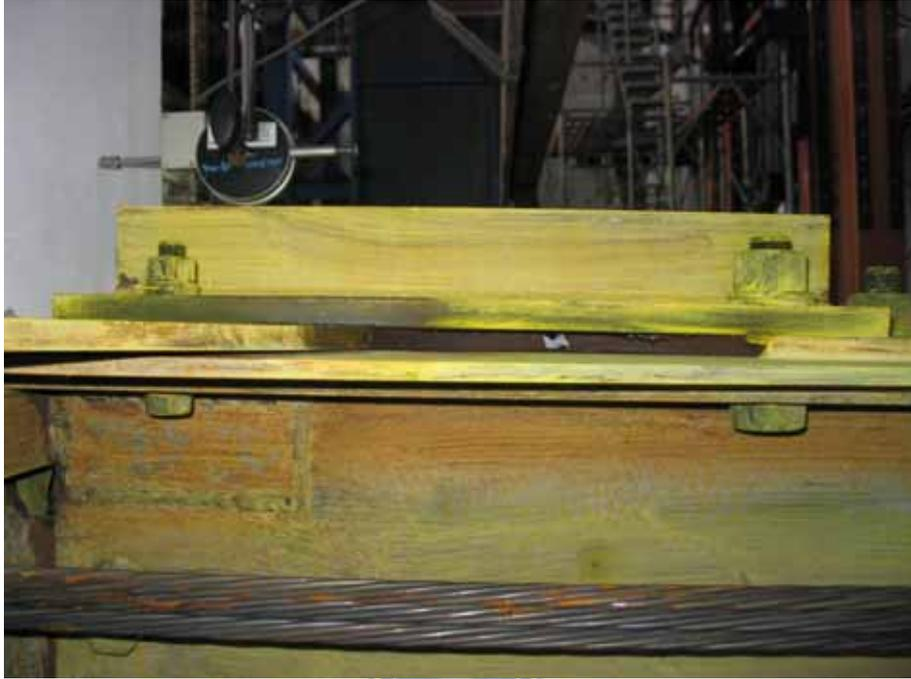
照片 3.24 試體 3 削切鋼板破壞情形(2nd 次試驗， $\theta = 0.04 \text{ rad}$ )
