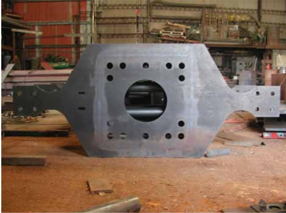
照片 3.20 試體 3 削切鋼板
