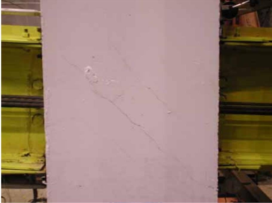
照片 3.17 試體 2 梁柱接頭區剪力裂縫( $\theta = 0.01 \text{ rad}$ )
