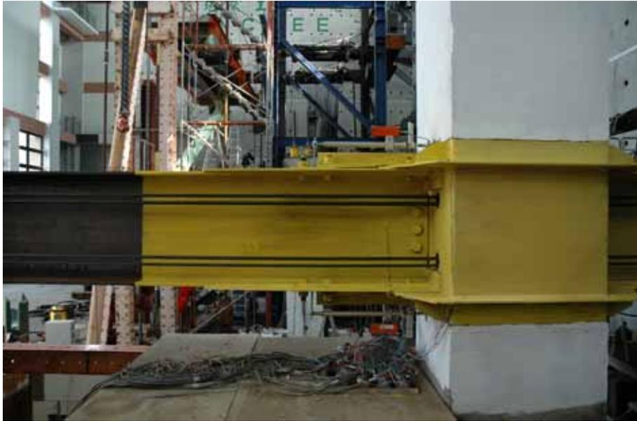
照片 3.34 試體 5 梁未產生明顯降伏( $\theta = 0.04$  rad, 1st Test)
