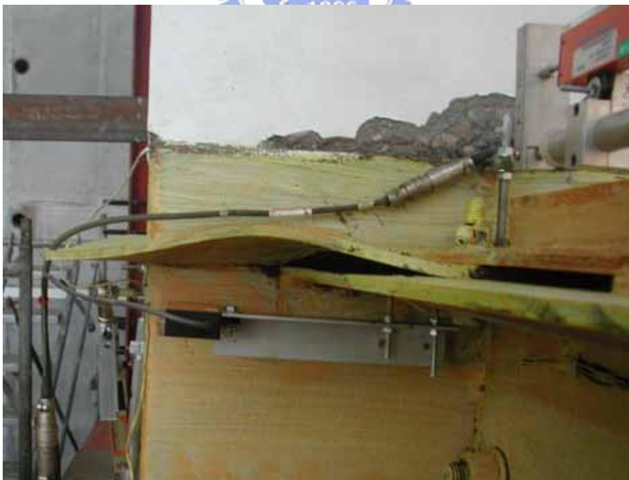
照片 3.27 試體 4 削切鋼板端部外側挫屈( $\theta = 0.04 \text{ rad}$ )
