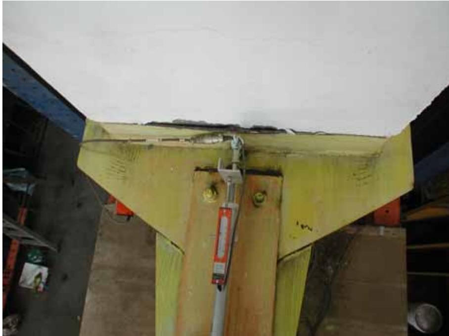
照片 3.26 試體 4 削切鋼板端部降伏( $\theta = 0.03 \text{ rad}$ )
