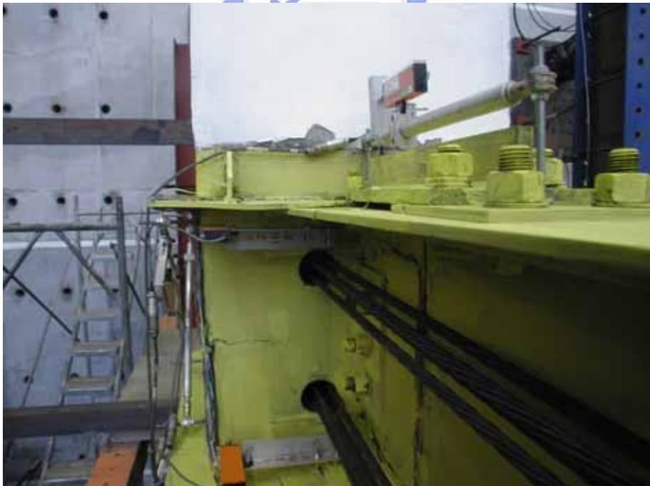
照片 3.33 試體 5 削切鋼板加勁後於端部未挫屈( $\theta = 0.04 \text{ rad}$ )
