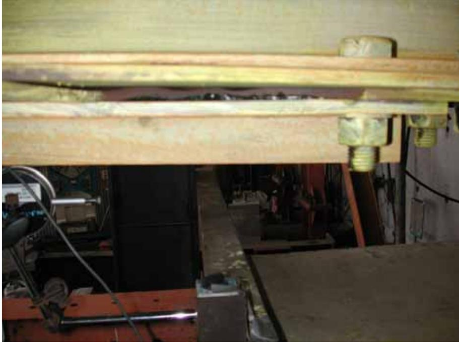
照片 3.28 試體 4 削切鋼板高模態挫屈( $\theta = 0.04 \text{ rad}$ )
