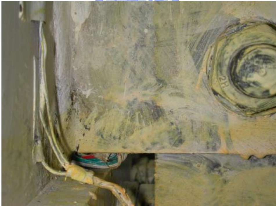
照片 3.44 試體 4 剪力板下側端部降伏 ( \theta = -0.03 弧度)
