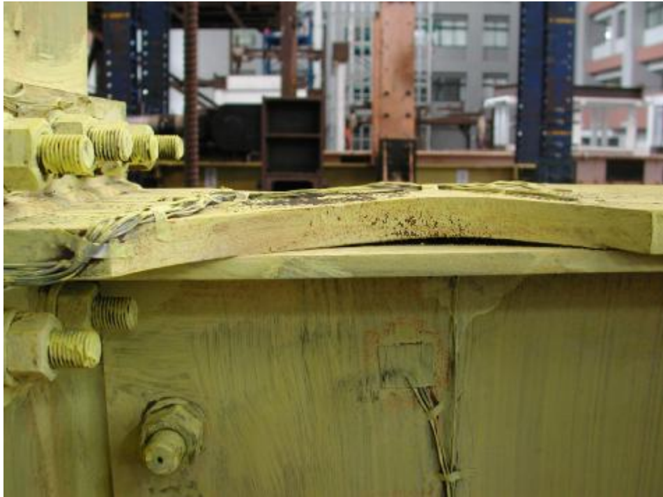
照片 3.31 試體 3 上側削切蓋板挫屈 ( \theta = 0.03 弧度)
