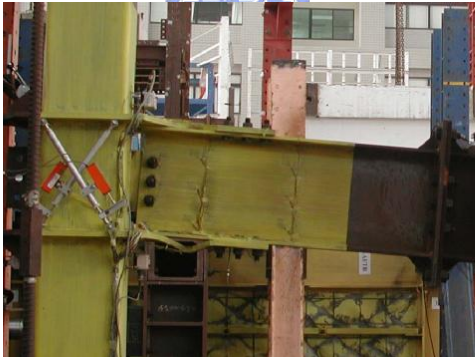
照片 3.12 試體 1 整體變形情形 ( \theta = -0.06 弧度)
