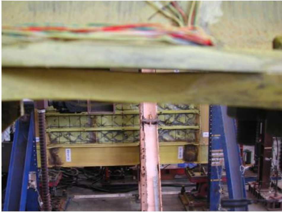
照片 3.21 試體 2 下側削切蓋板挫屈 ( \theta = -0.03 弧度)
