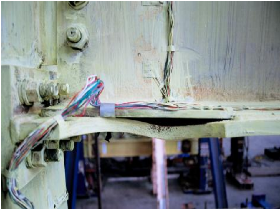
照片 3.33 試體 3 下側削切蓋板挫屈 ( \theta = -0.03 弧度)
