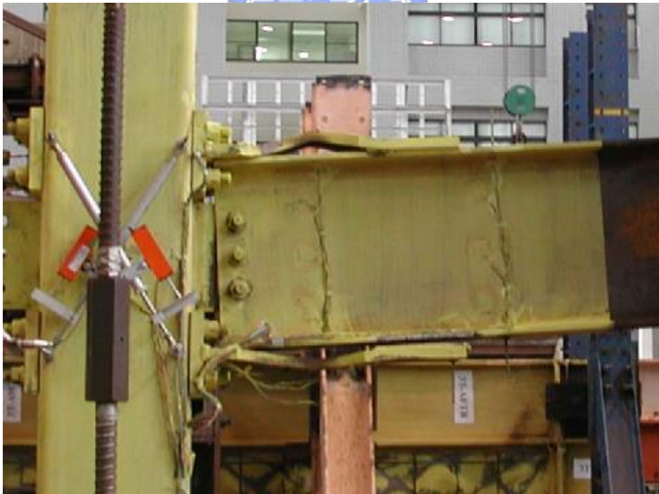
照片 3.38 試體 3 下側削切蓋板與梁分離 ( \theta = 0.06 弧度)
