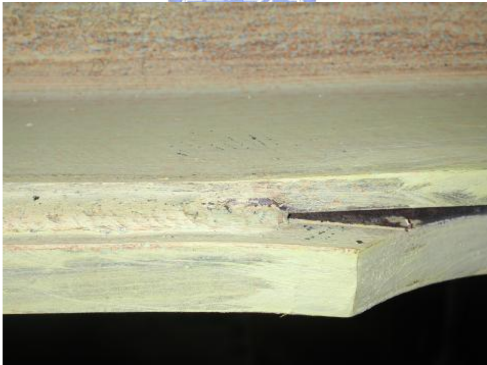
照片 3.34 試體 3 削切蓋板與梁翼板間焊接處降伏 ( \theta = -0.03 弧度)
