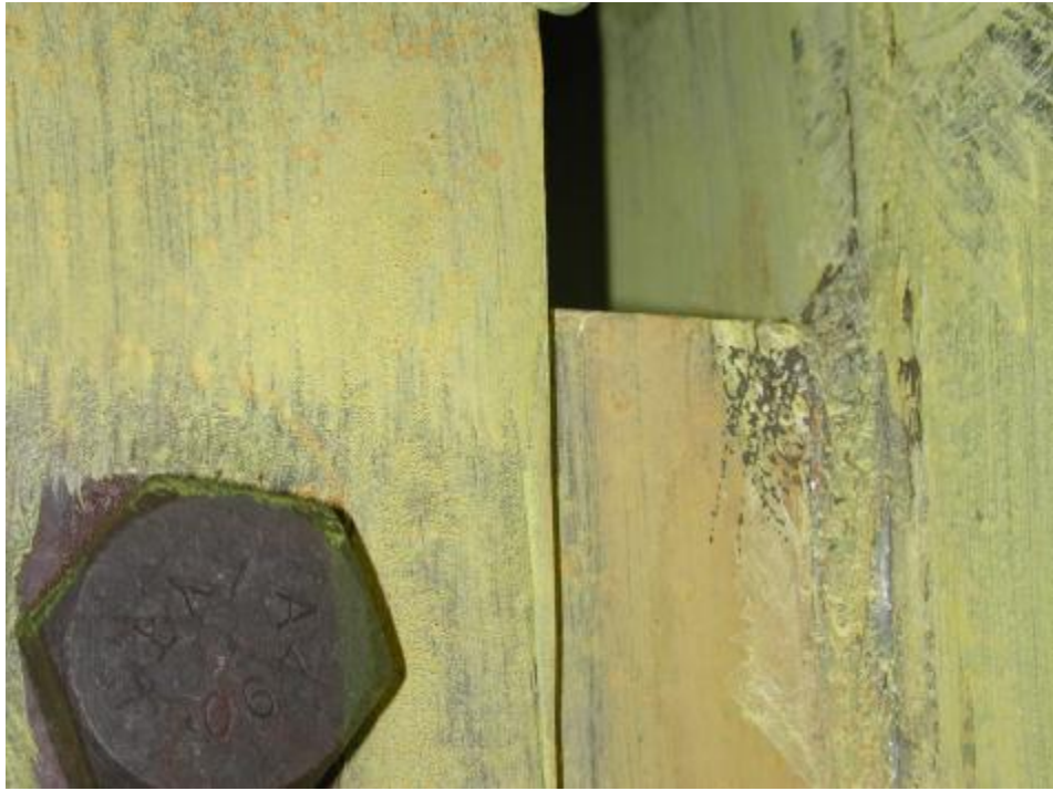
照片 3.23 試體 2 剪力板降伏 ( \theta = 0.04 弧度)
