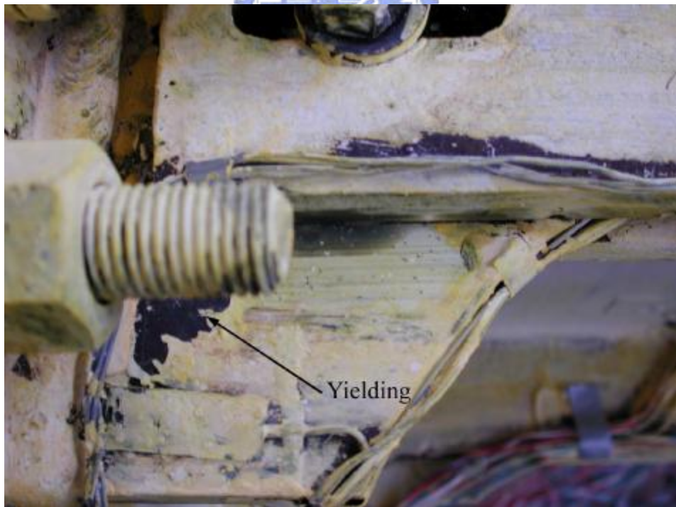
照片 3.42 試體 4 削切蓋板靠近端部角落降伏 ( \theta = -0.03 弧度)
