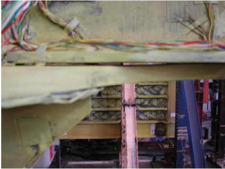
照片 3.17 試體 2 下側削切蓋板與梁翼板間之空隙 ( \theta = 0.015 弧度)
