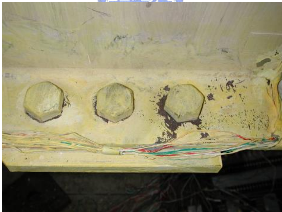
照片 3.48 試體 4 梁翼板降伏 ( \theta = -0.05 弧度)
