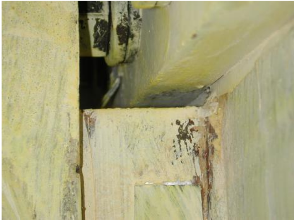
照片 3.45 試體 4 剪力板上側端部降伏 ( \theta = 0.04 弧度)
