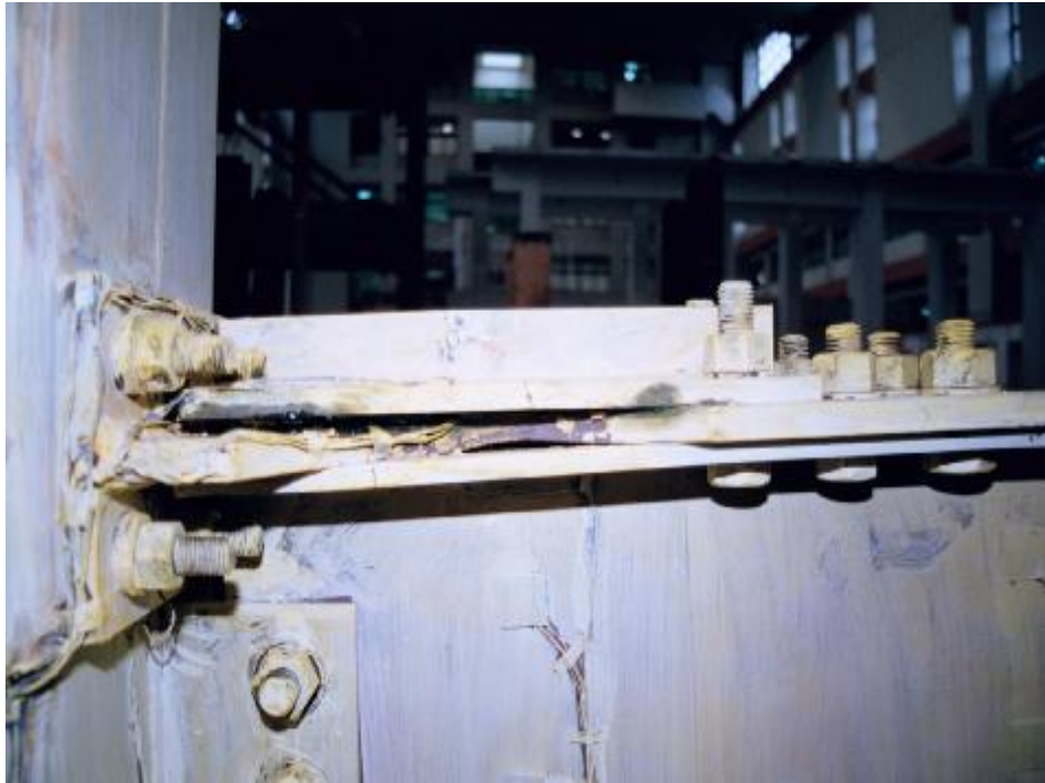
照片 3.55 試體 4 上側削切蓋板挫屈( \theta = 0.07 弧度)
