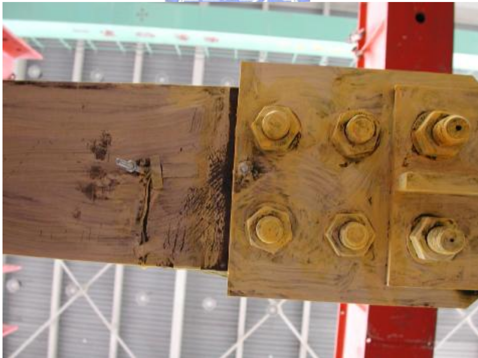
照片 3.50 試體 4 下側削切蓋板端部之梁翼板降伏 ( \theta = 0.06 弧度)
