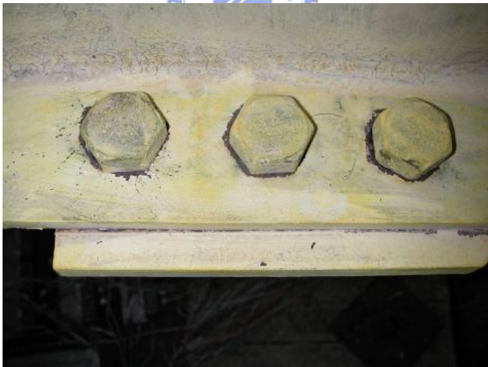
照片 3.46 試體 4 梁下翼板螺栓孔周圍降伏 ( \theta = 0.04 弧度)
