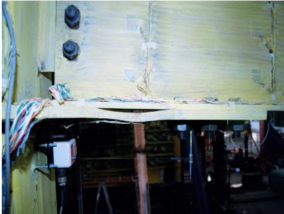
照片 3.11 試體 1 下側削切蓋板挫屈 ( \theta = -0.05 弧度)
