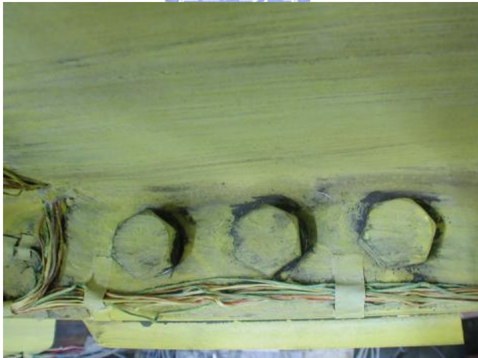
照片 3.8 試體 1 螺栓孔附近梁翼板降伏 ( \theta = 0.04 弧度)
