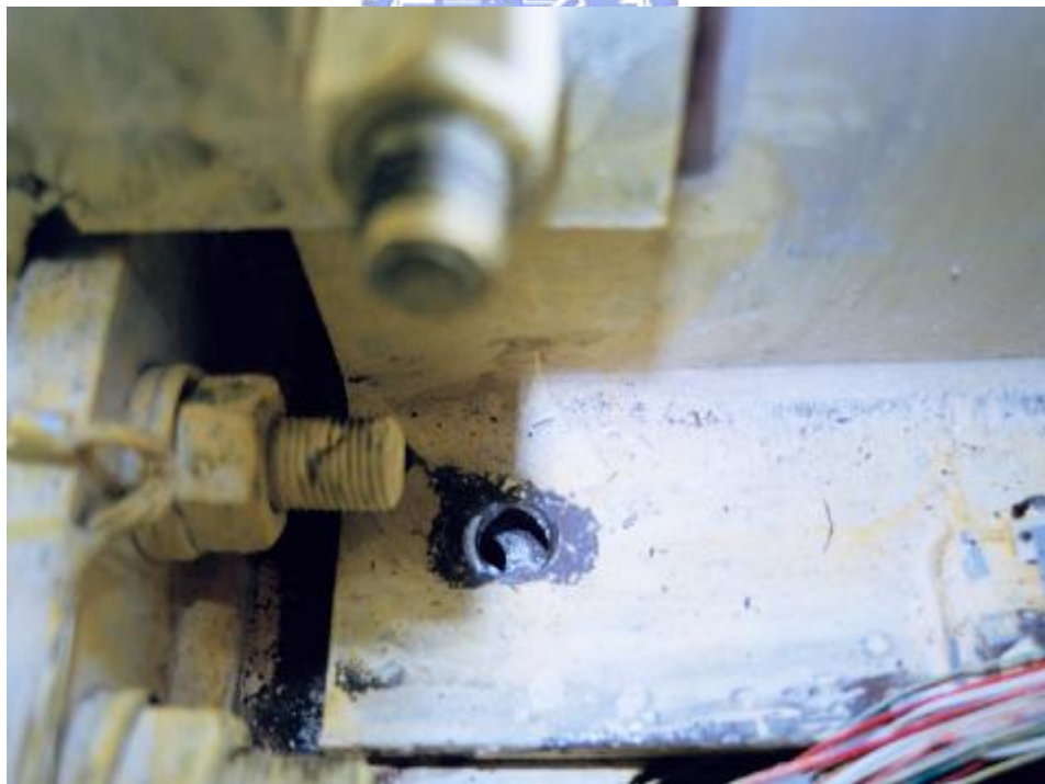
照片 3.54 試體 4 下側螺栓彈出 ( \theta = 0.07 弧度)
