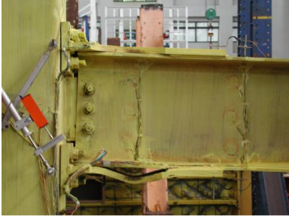
照片 3.35 試體 3 下側削切蓋板挫屈 ( \theta = -0.04 弧度)
