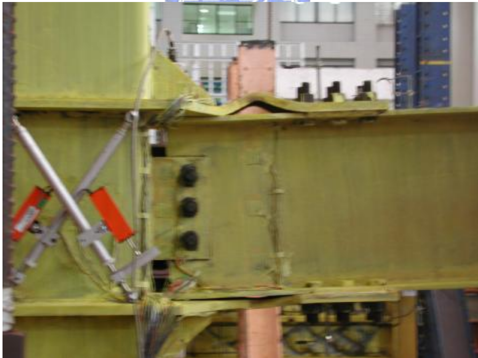
照片 3.24 試體 2 上側削切蓋板挫屈 ( \theta = 0.05 弧度)
