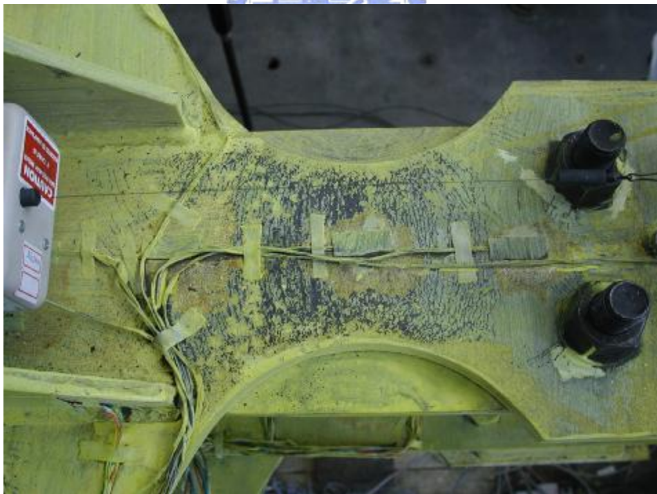
照片 3.18 試體 2 上側削切蓋板降伏 ( \theta = 0.03 弧度)
