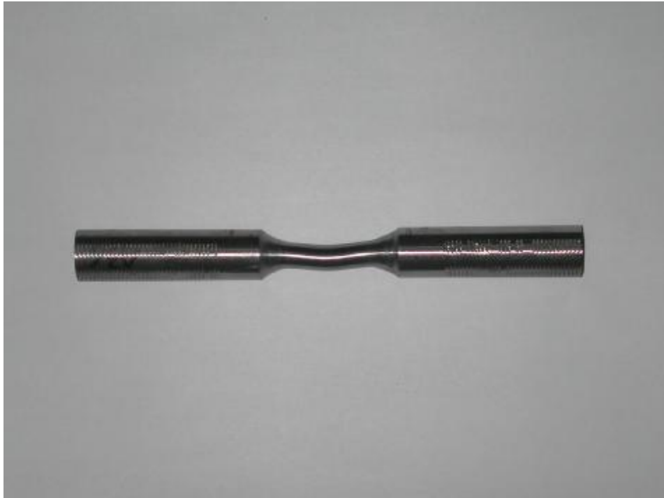
照片 4.2 試片 A1 試驗後挫屈情形
