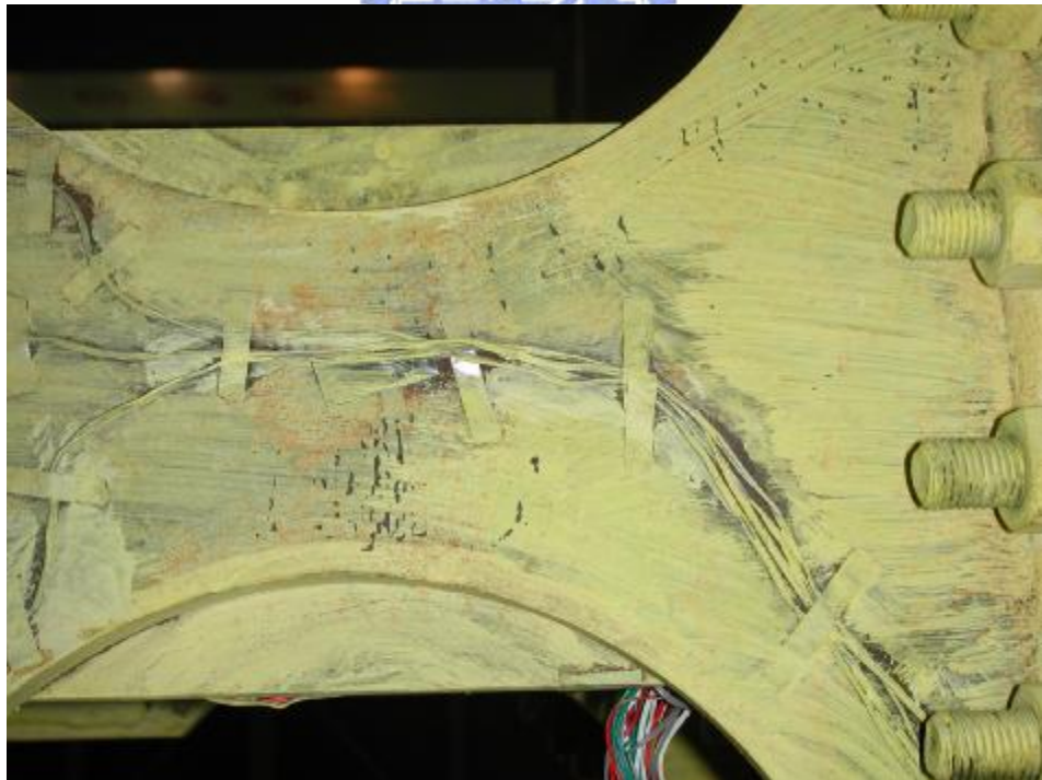
照片 3.28 試體 3 下側削切蓋板降伏 ( \theta = 0.01 弧度)
