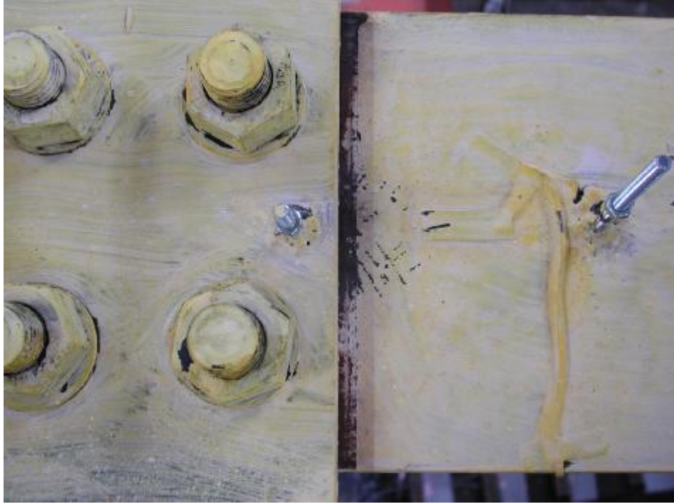
照片 3.43 試體 4 削切蓋板端部之梁翼板降伏 ( \theta = -0.03 弧度)
