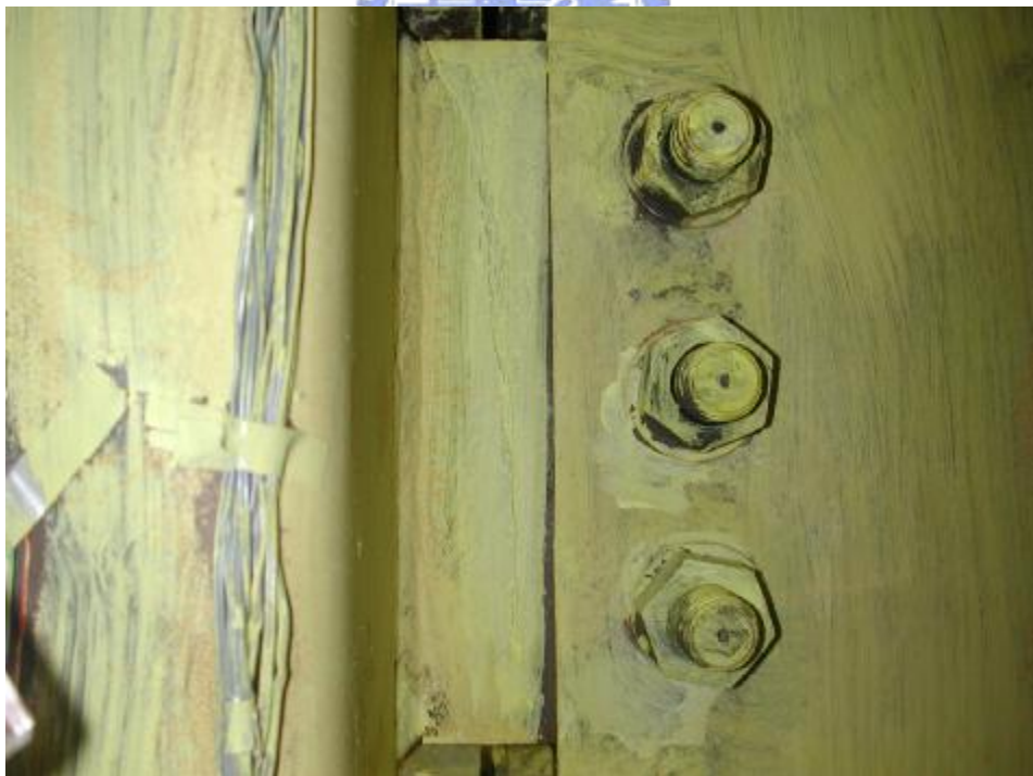
照片 3.32 試體 3 梁腹板轉動 ( \theta = 0.03 弧度)
