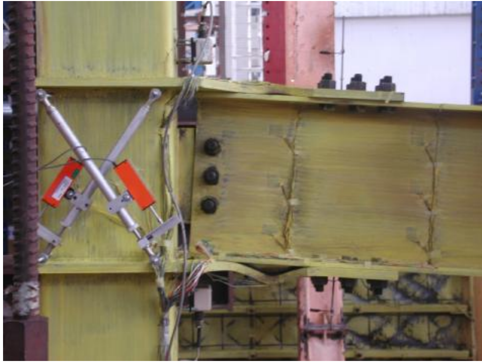
照片 3.13 試體 1 上下削切蓋板變形情形 ( \theta = -0.06 弧度)
