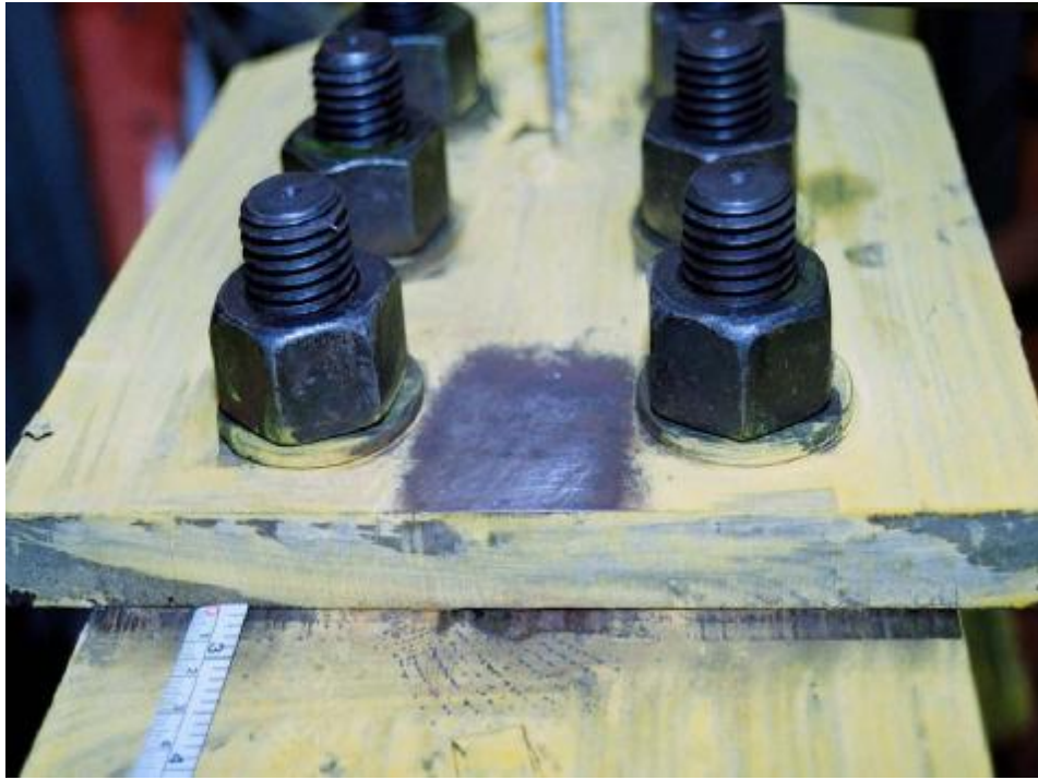
照片 3.9 試體 1 削切蓋板端部梁翼板降伏 ( \theta = 0.04 弧度)
