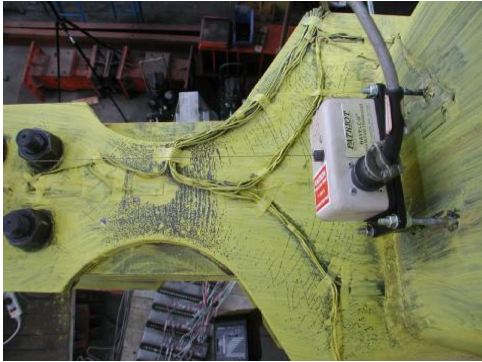
照片 3.7 試體 1 上側削切蓋板降伏 ( \theta = 0.04 弧度)
