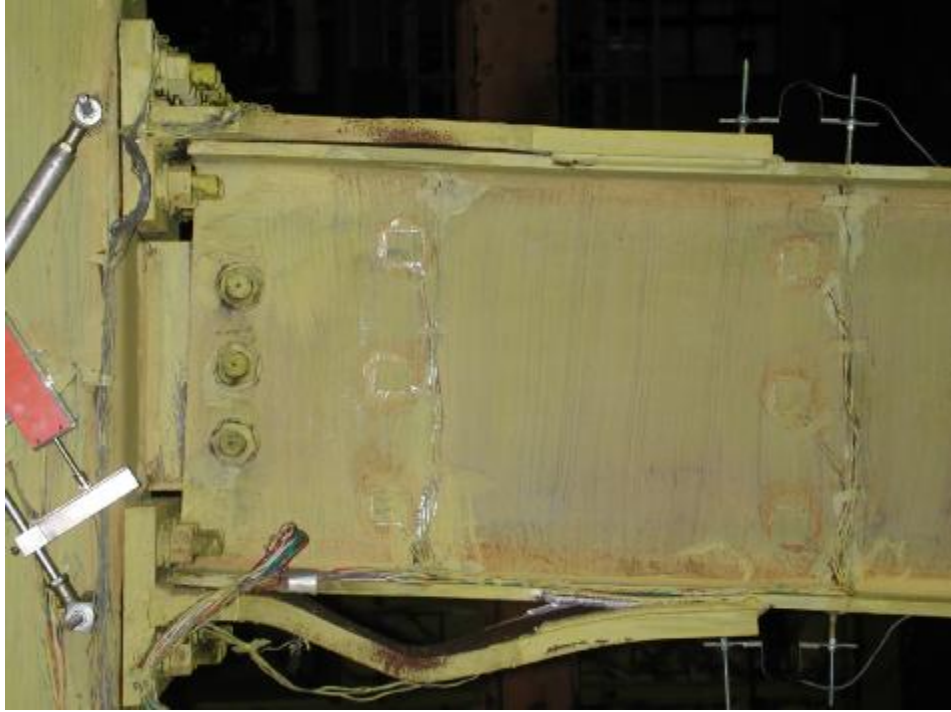
照片 3.37 試體 3 下側削切蓋板挫屈 ( \theta = -0.05 弧度)
