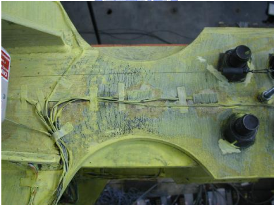
照片 3.16 試體 2 上側削切蓋板降伏 ( \theta = 0.015 弧度)
