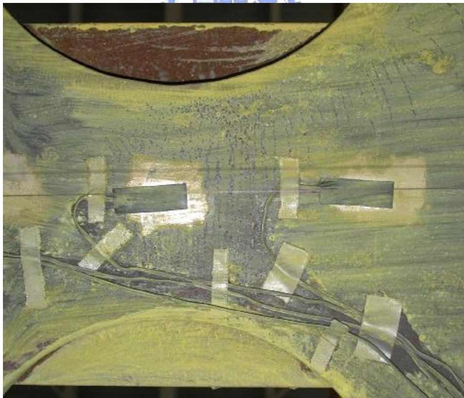
照片 3.6 試體 1 下側削切蓋板降伏 ( \theta = -0.03 弧度)
