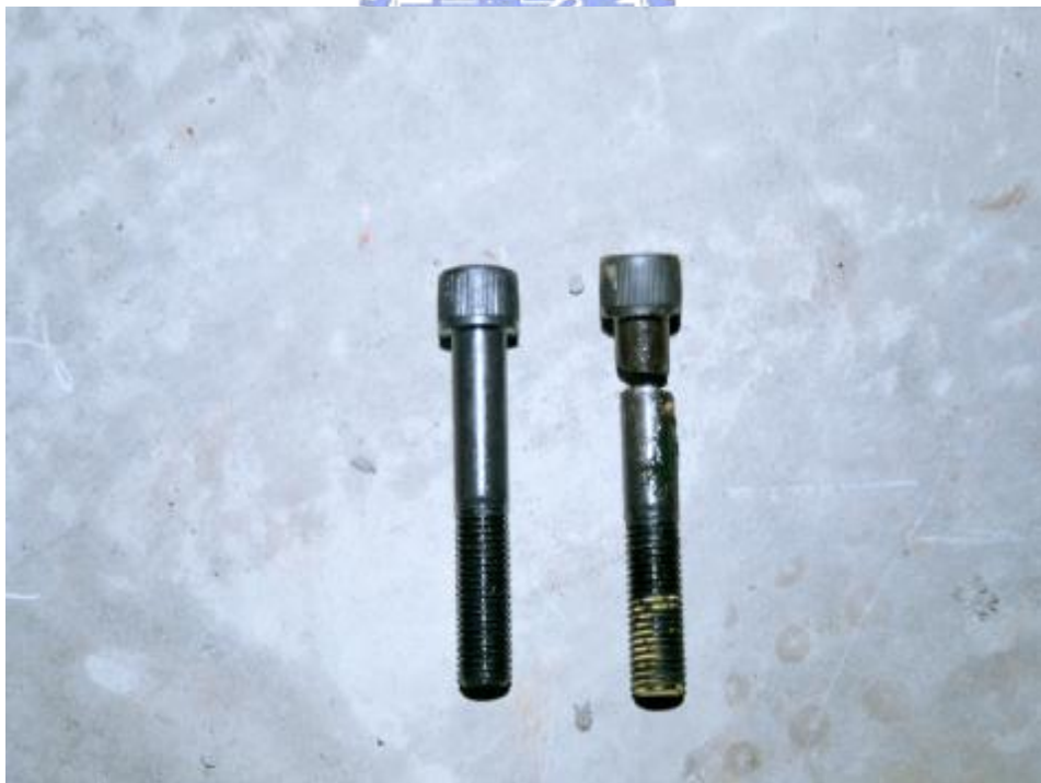
照片 3.56 試體 4 剪斷之螺栓與完好之螺栓比較 ( \theta = 0.07 弧度)
