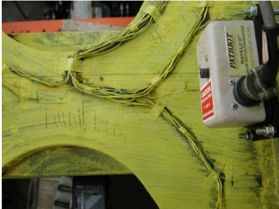
照片 3.5 試體 1 上側削切蓋板降伏 ( \theta = 0.03 弧度)
