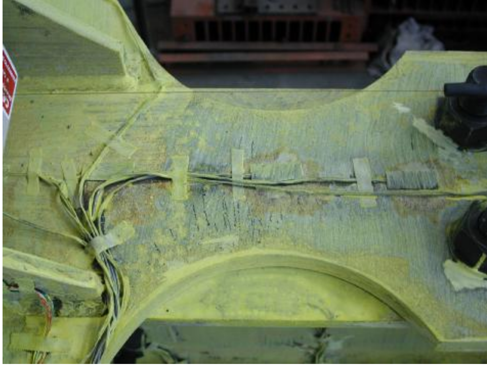
照片 3.15 試體 2 上側削切蓋板降伏 ( \theta = 0.01 弧度)
