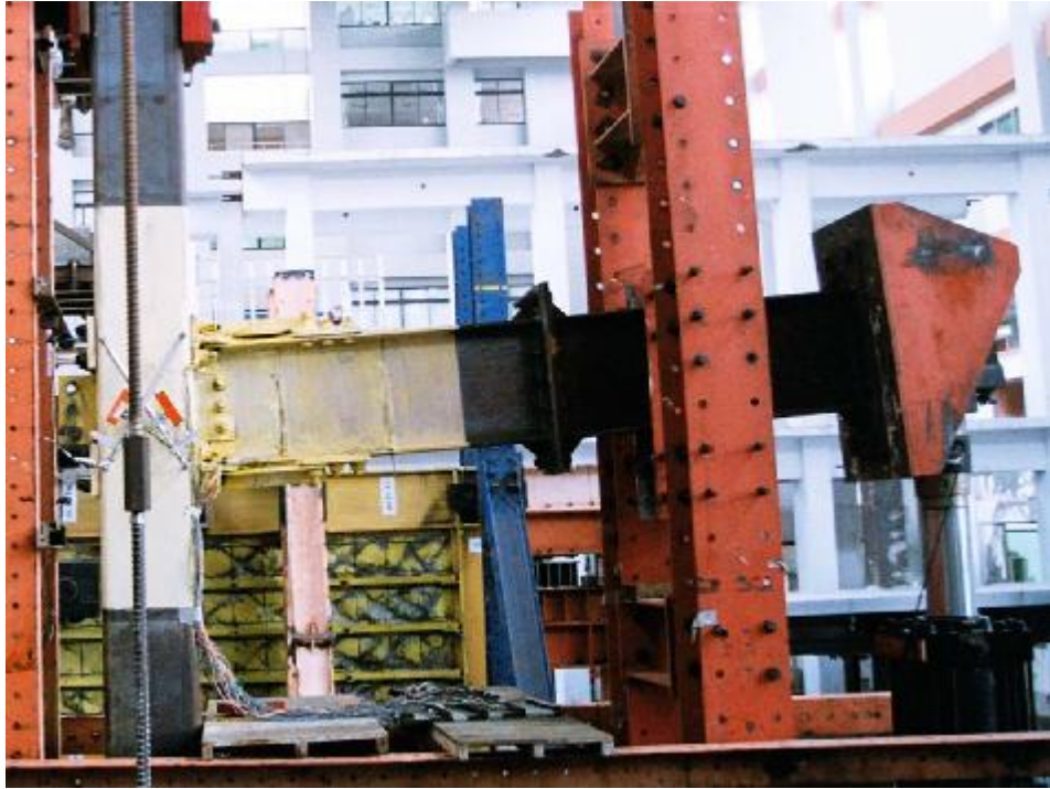
照片 3.53 試體 4 試驗後全景 ( \theta = 0.07 弧度)
