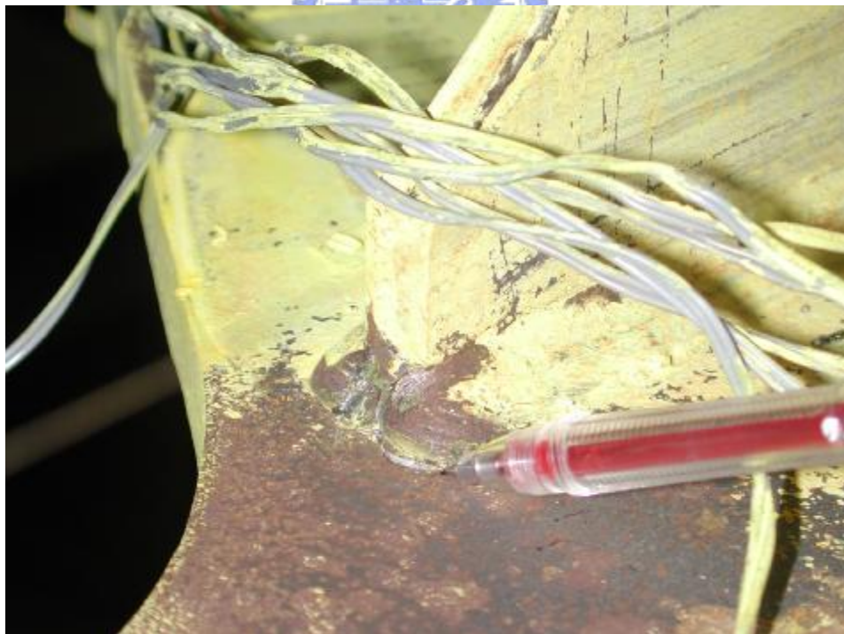
照片 3.26 試體 2 加勁板焊道些微拉裂 ( \theta = -0.05 弧度)
