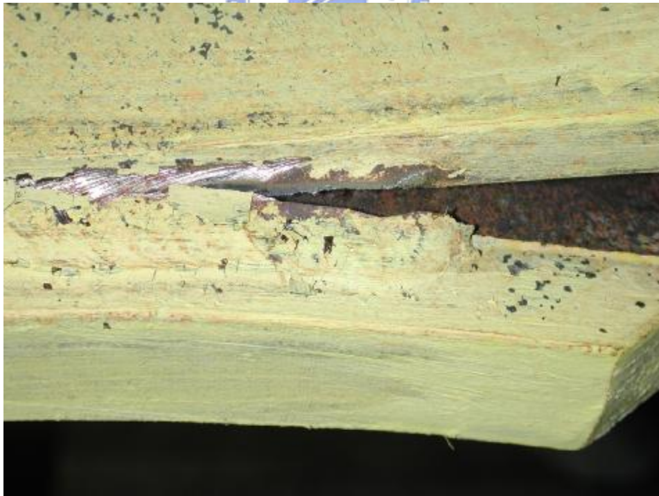
照片 3.36 試體 3 焊道拉裂 ( \theta = -0.04 弧度)
