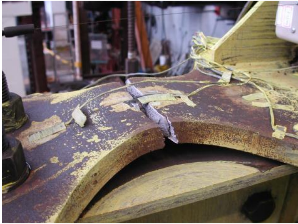
照片 3.25 試體 2 上側削切蓋板拉斷( \theta = -0.05 弧度)
