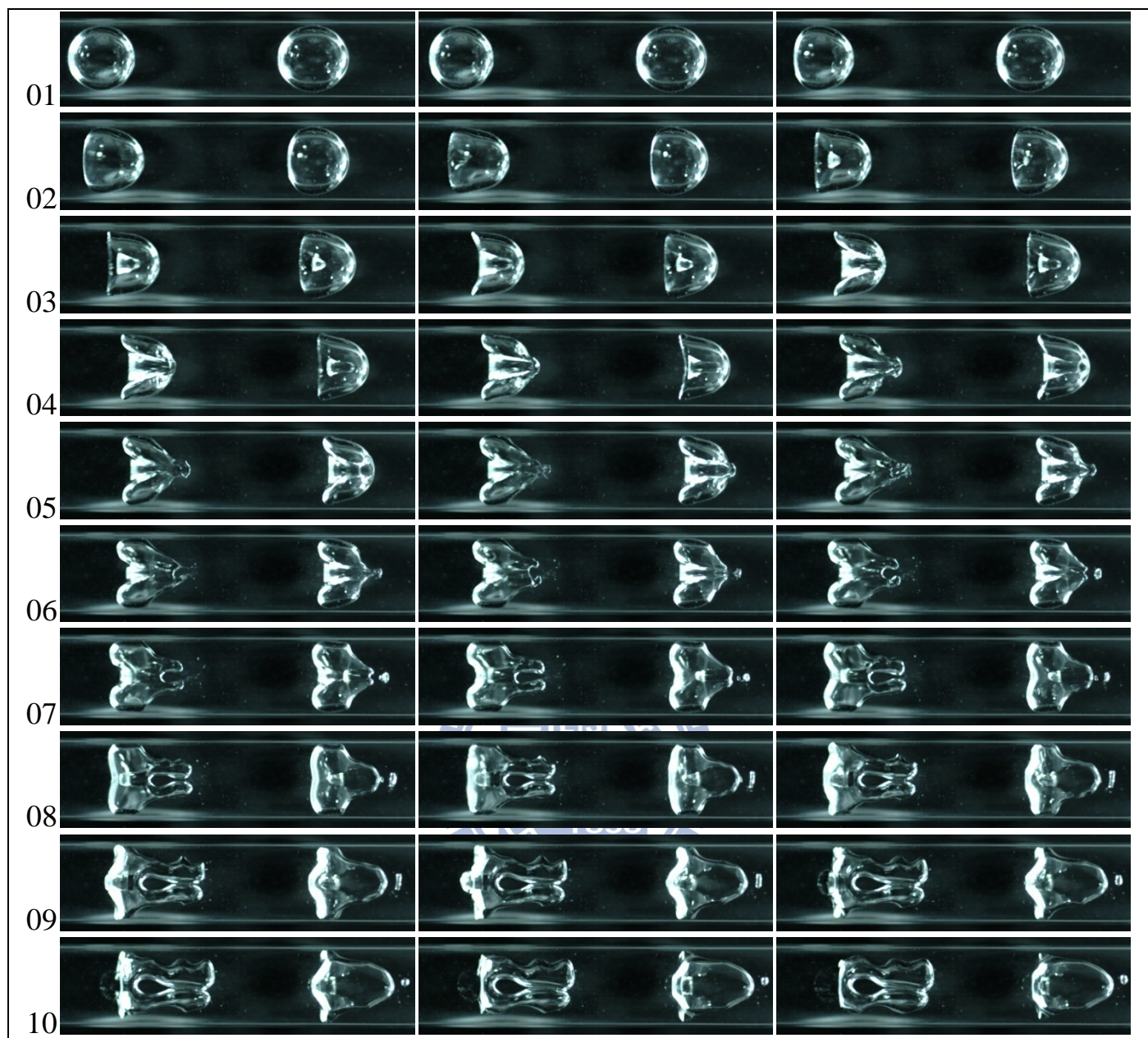
圖 4.13 距離參數 \gamma \approx 6 之雙穴蝕氣泡兩顆皆破之過程；最大壓力波強度為 115 kpa，影像時間間距 1/8000 秒，影像大小為 24.0 mm x 6.0mm，氣泡半徑為 2.5 mm。 (文中影像每張間隔 3/8000 秒)
