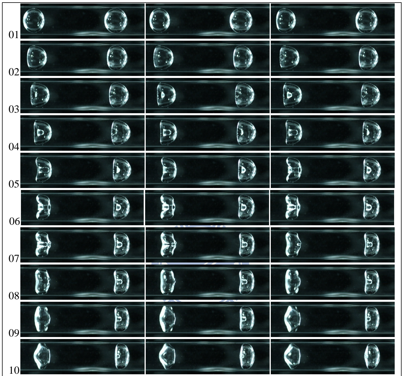
圖 4.18 距離參數 \gamma > 6 之雙穴蝕氣泡兩顆皆不破之過程；最大壓力波強度為 43.4 kpa，影像時間間距 1/8000 秒，影像大小為 24.0 mm × 6.0mm，氣泡半徑為 2.5 mm。(文中影像每張間隔 3/8000 秒)
