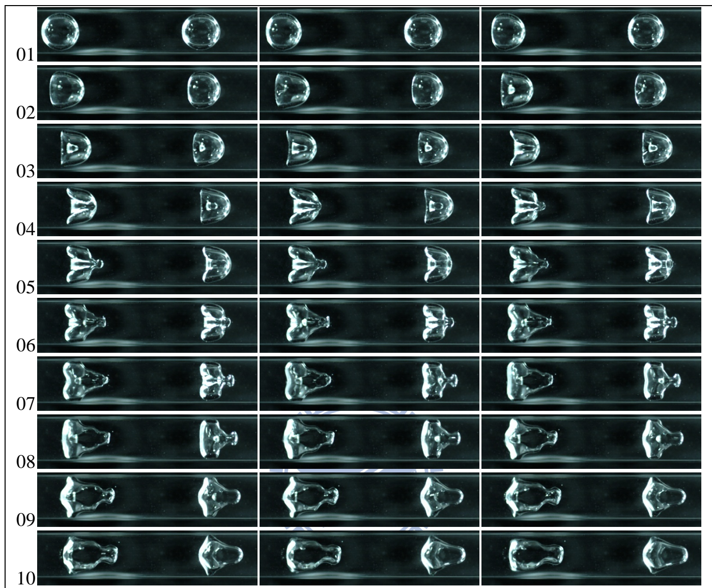
圖 4.16 距離參數 \gamma > 6 之雙穴蝕氣泡兩顆皆破之過程；最大壓力波強度為 81 kpa， 影像時間間距 1/8000 秒，影像大小為 24.0 mm x 6.0mm，氣泡半徑為 2.5 mm。 (文中影像每張間隔 3/8000 秒)
