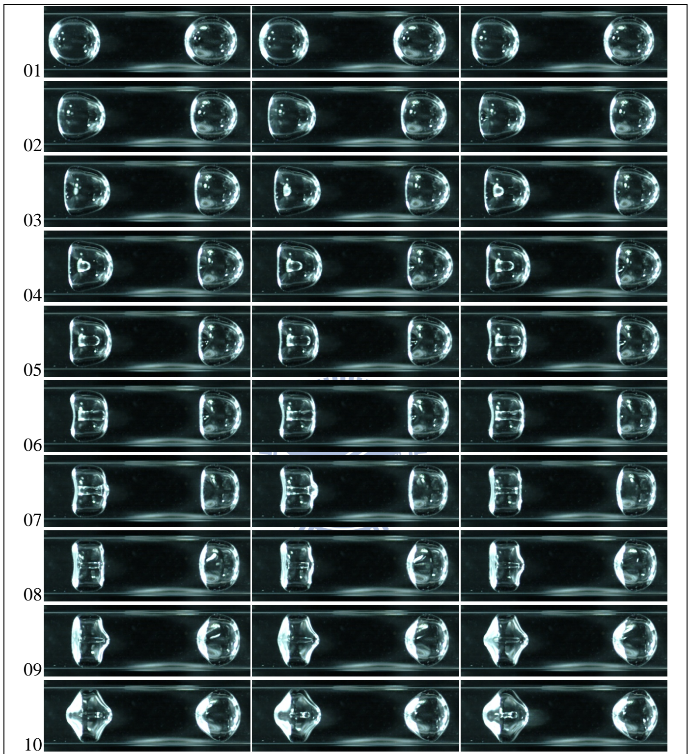
圖 4.14 距離參數 \gamma \approx 6 之雙穴蝕氣泡左破右不破之過程；最大壓力波強度為 84.6 kpa，影像時間間距 1/8000 秒，影像大小為 24.0 mm × 6.0mm，氣泡半徑為 2.5 mm。(文中影像每張間隔 3/8000 秒)
