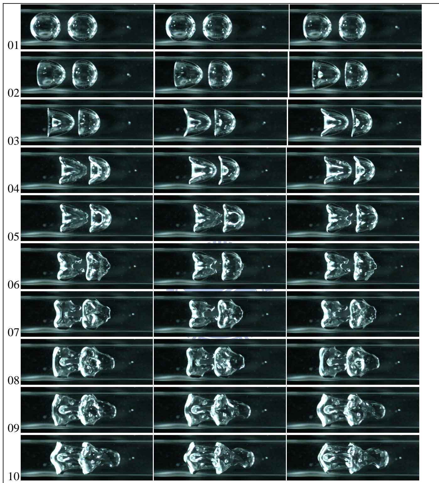
圖 4.1 距離參數 \gamma \approx 2 之雙穴蝕氣泡兩顆皆破之過程；最大壓力波強度為 186 kpa， 影像時間間距 1/8000 秒，影像大小為 24.0 mm × 6.0mm，氣泡半徑為 2.5 mm。 (文中影像每張間隔 3/8000 秒)
