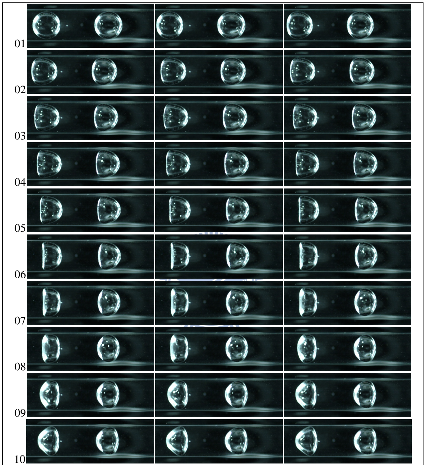
圖 4.9 距離參數 \gamma \approx 4 之雙穴蝕氣泡兩顆皆不破之過程；最大壓力波強度為 62.5 kpa， 影像時間間距 1/8000 秒，影像大小為 24.0 mm × 6.0mm，氣泡半徑為 2.5 mm。 (文中影像每張間隔 3/8000 秒)
