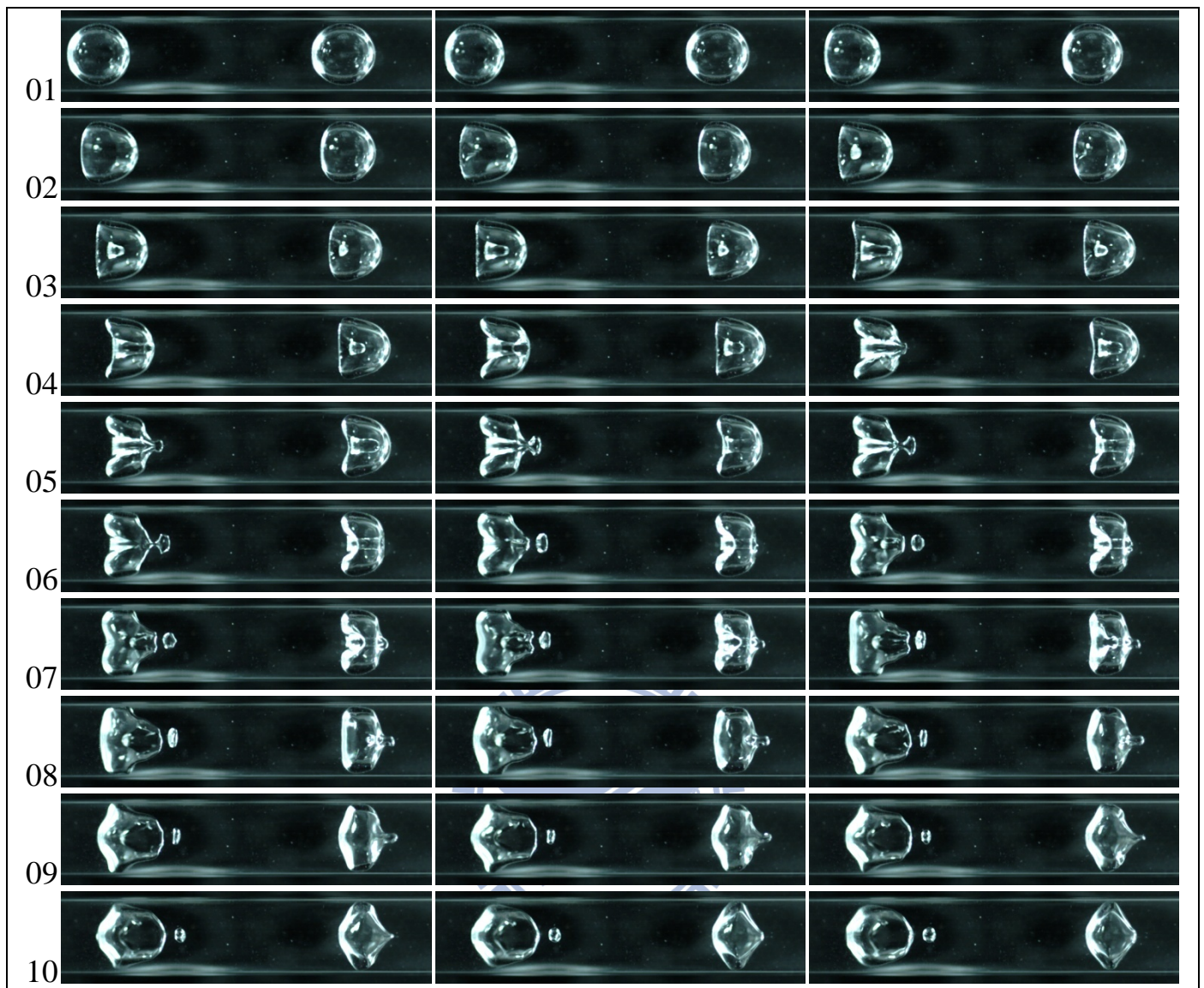
圖 4.17 距離參數 \gamma > 6 之雙穴蝕氣泡左破右不破之過程；最大壓力波強度為 48 kpa，影像時間間距 1/8000 秒，影像大小為 24.0 mm × 6.0mm，氣泡半徑為 2.5 mm。(文中影像每張間隔 3/8000 秒)
