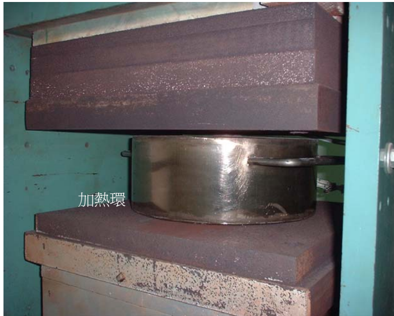
圖3-5. 單軸熱壓成型機。
