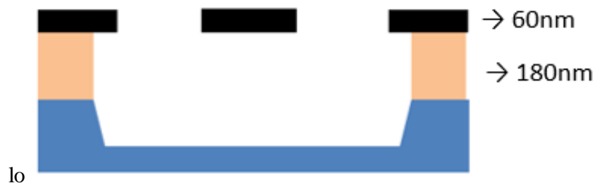
圖 三-11 Device 的 Cross section 示意圖
