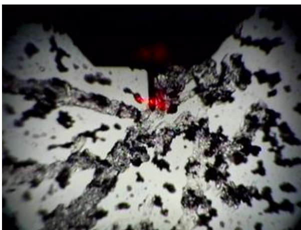
圖 二-7 利用混合溶劑法製備之 P3HT 奈米線(1.25 wt%)的 CCD 圖
