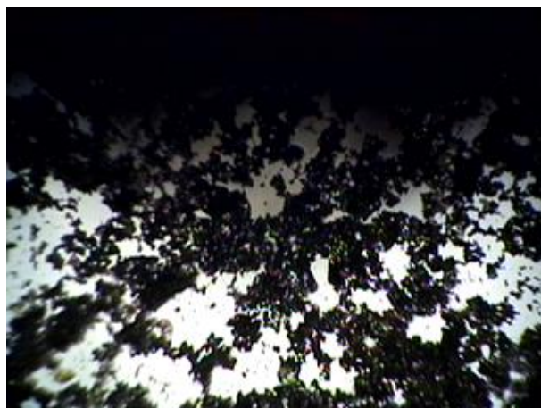
圖 二-8 利用混合溶劑法製備之 P3HT 奈米線(1.25 wt%)的 CCD 圖
