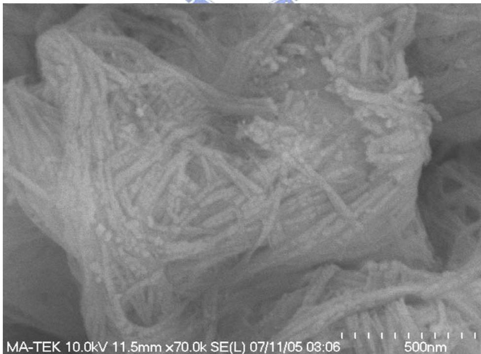
圖 4-7-2B 反應 24 小時的二氧化鈦奈米管之 SEM 照片 (70K)
