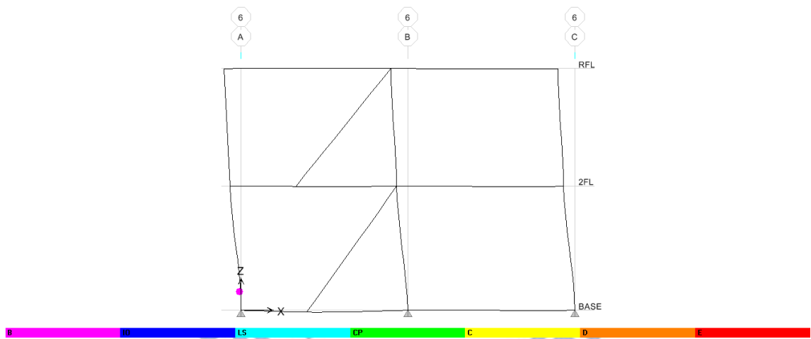
圖 5.103 案例八構架 6 性能點塑鉸發展情形
