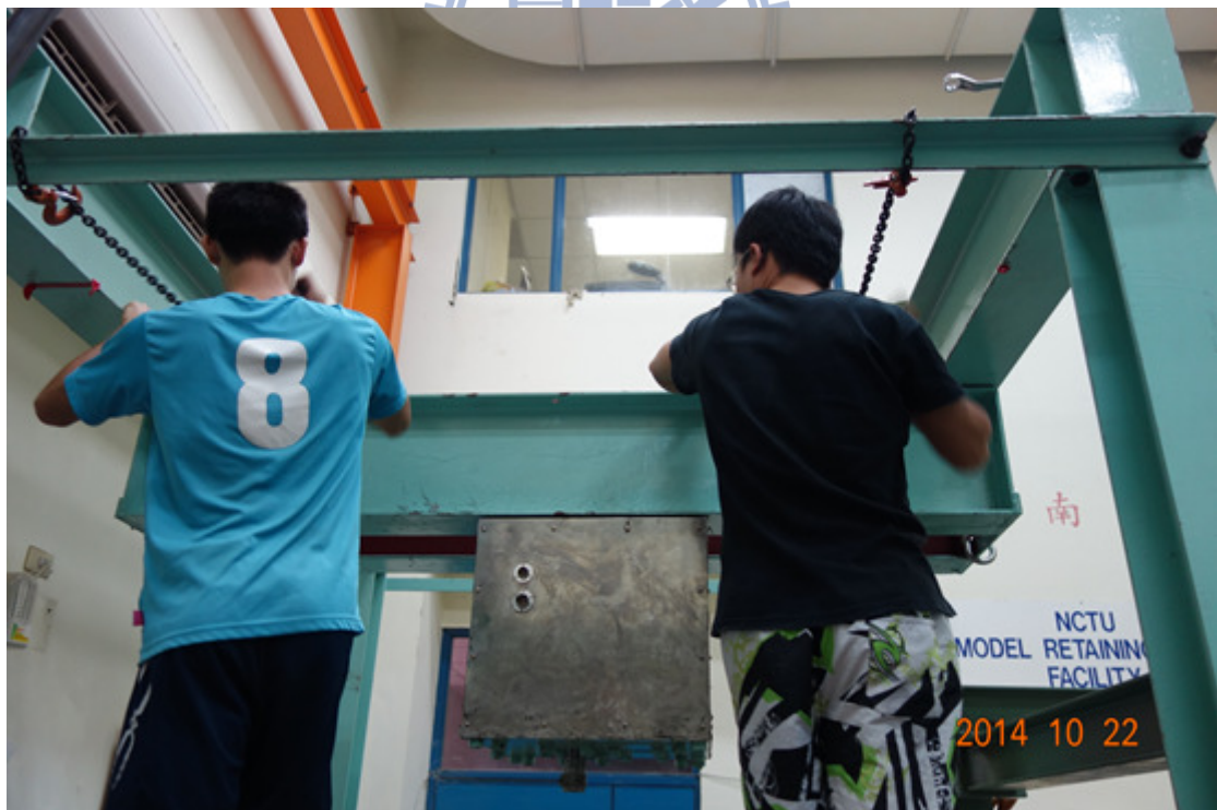
圖 5-2 將移動式反力鋼樑移動至預定位置
