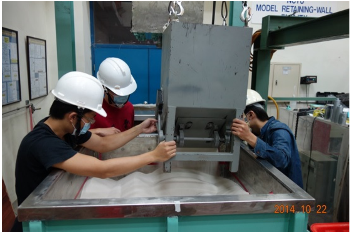
圖 4-21 使用砂斗提升法備製疏鬆乾砂試體
