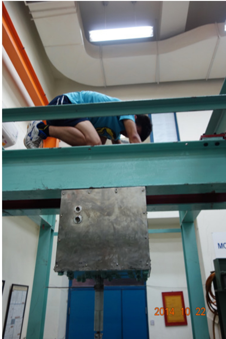
圖 5-3 鎖緊並確認移動式反力鋼樑與壓力機之螺栓
