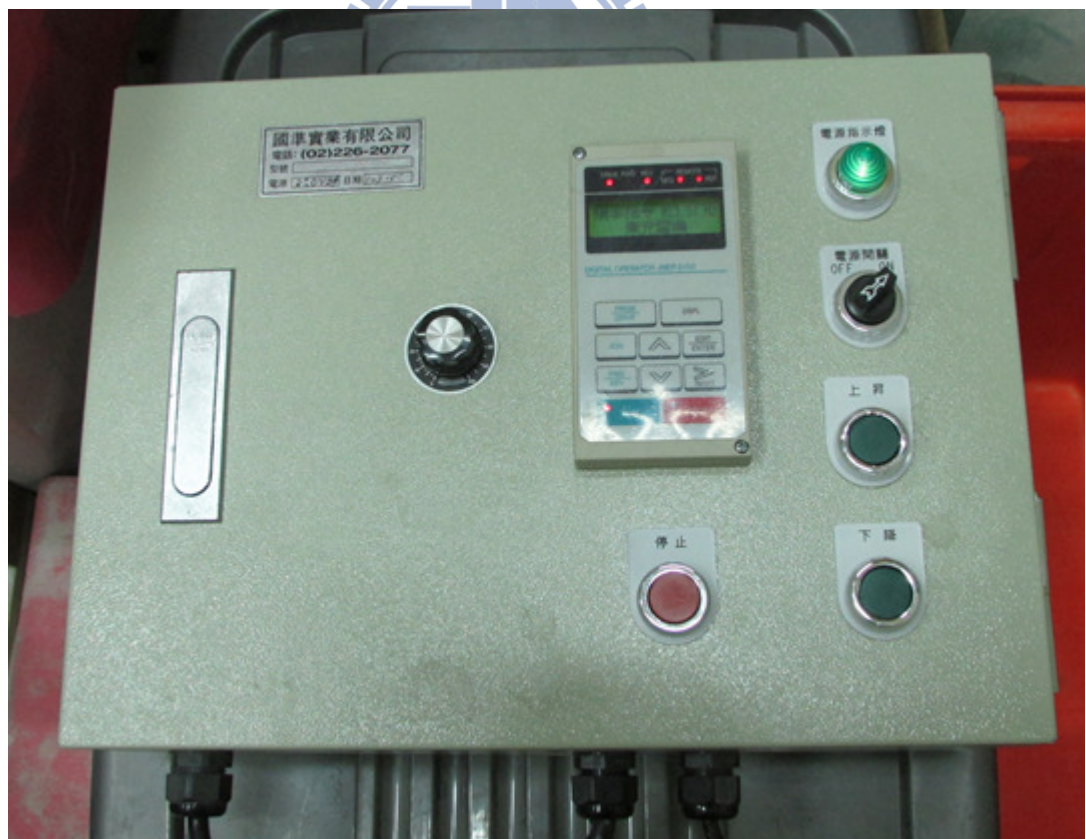
圖 3-6 spudcan 貫入速度控制器
