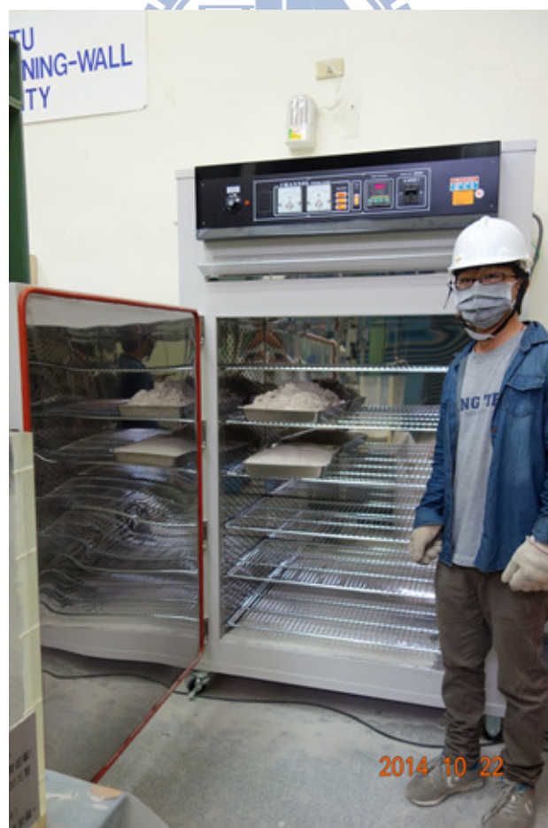
圖 5-8 將裝入濕砂之鐵盤放至大型烘箱烘乾
