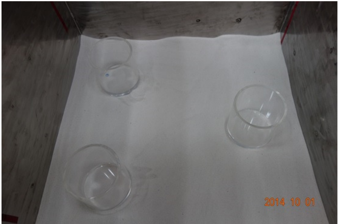
圖 4-17 砂土密度控制實驗之密度盒擺放情形
