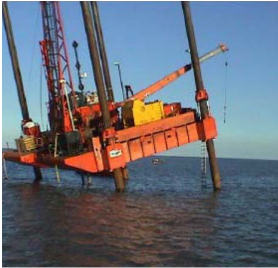
圖 1-4 支撐基腳貫穿式破壞造成之自升式平台傾斜損壞
