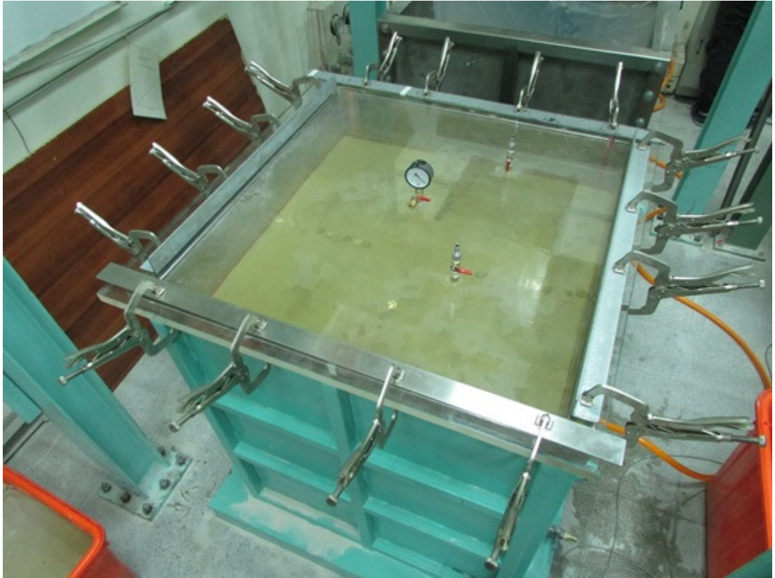
圖 4-27 放置氣密蓋板及 16 隻 C 型夾
