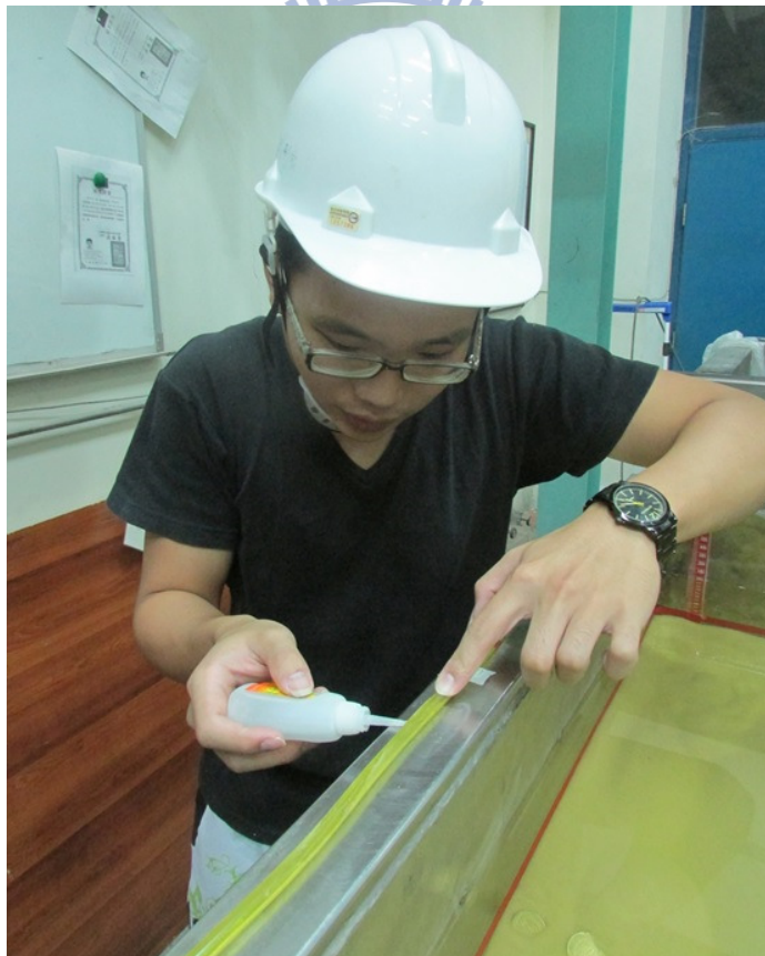
圖 4-26 以快乾膠固定氣密膠條
