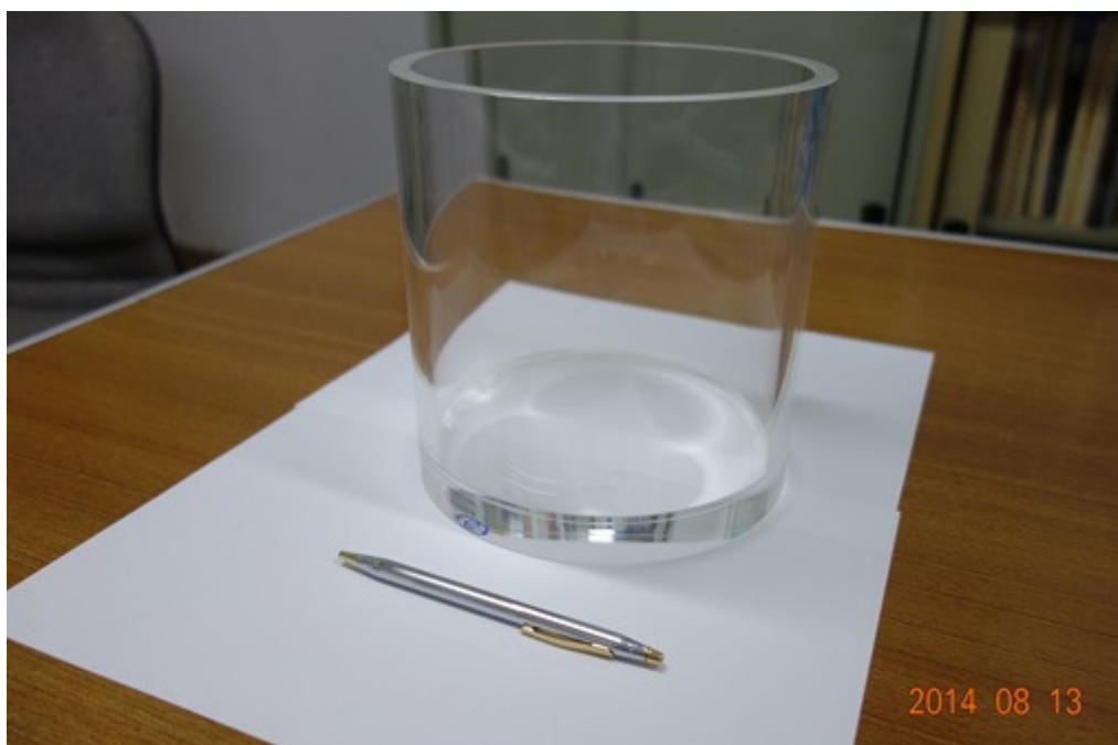
圖 4-12 ASTM D4254 圓柱形密度盒
