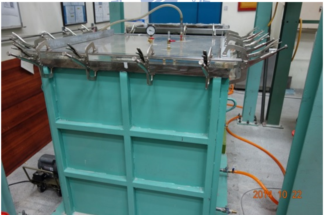
圖 4-28 以抽氣幫浦為浸水砂土試體進行抽氣
