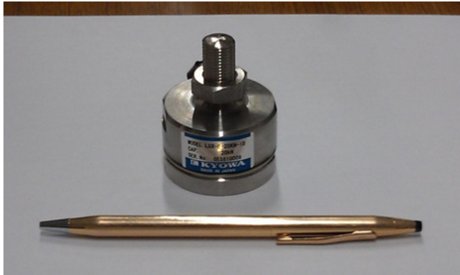
圖 3-7 20 kN 壓拉兩用荷重計(Kyowa LUX-B-20kN-ID)
