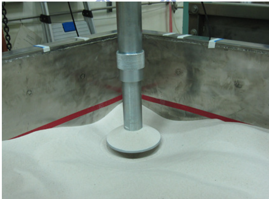
圖 5-10 直徑 150 mm spudcan 提腿離開砂土試體
