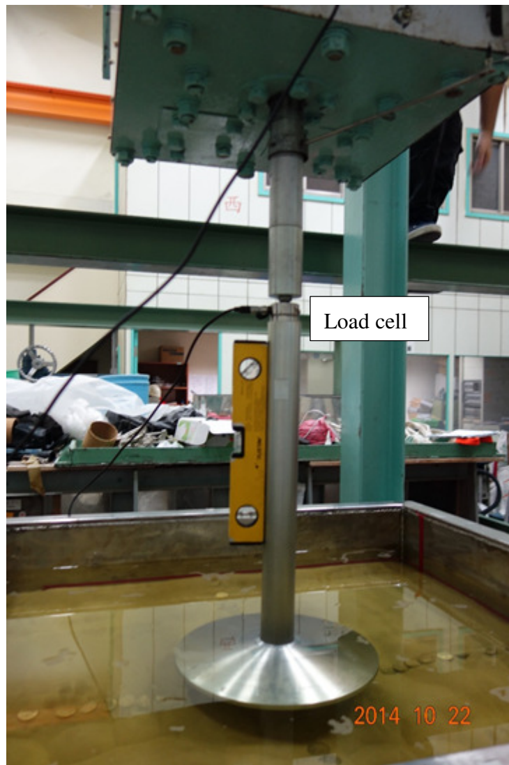
圖 3-8 試驗時之荷重計位置
