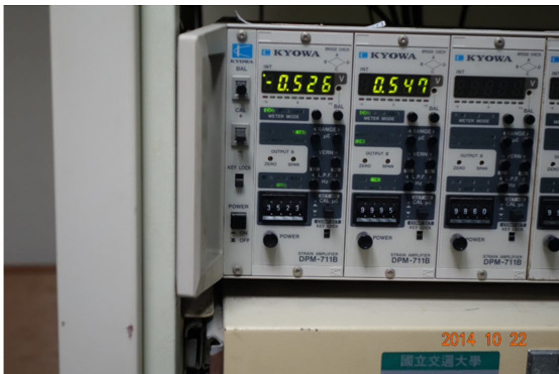
圖 3-18 動態應變放大器(Kyowa DPM-711B)
