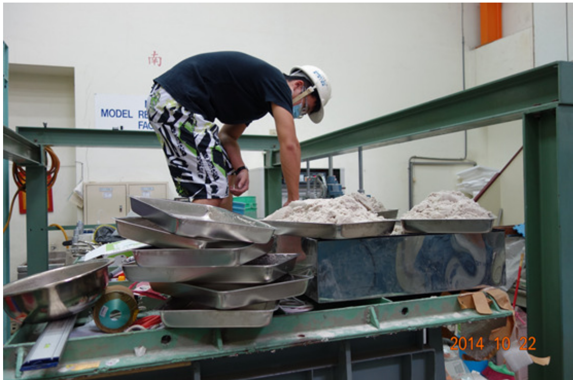
圖 5-7 試驗後分裝潮濕砂土至烘乾鐵盤
