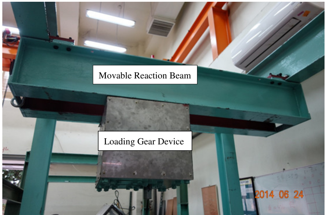
圖 3-5 移動式反力鋼樑及馬達齒輪式壓力機
