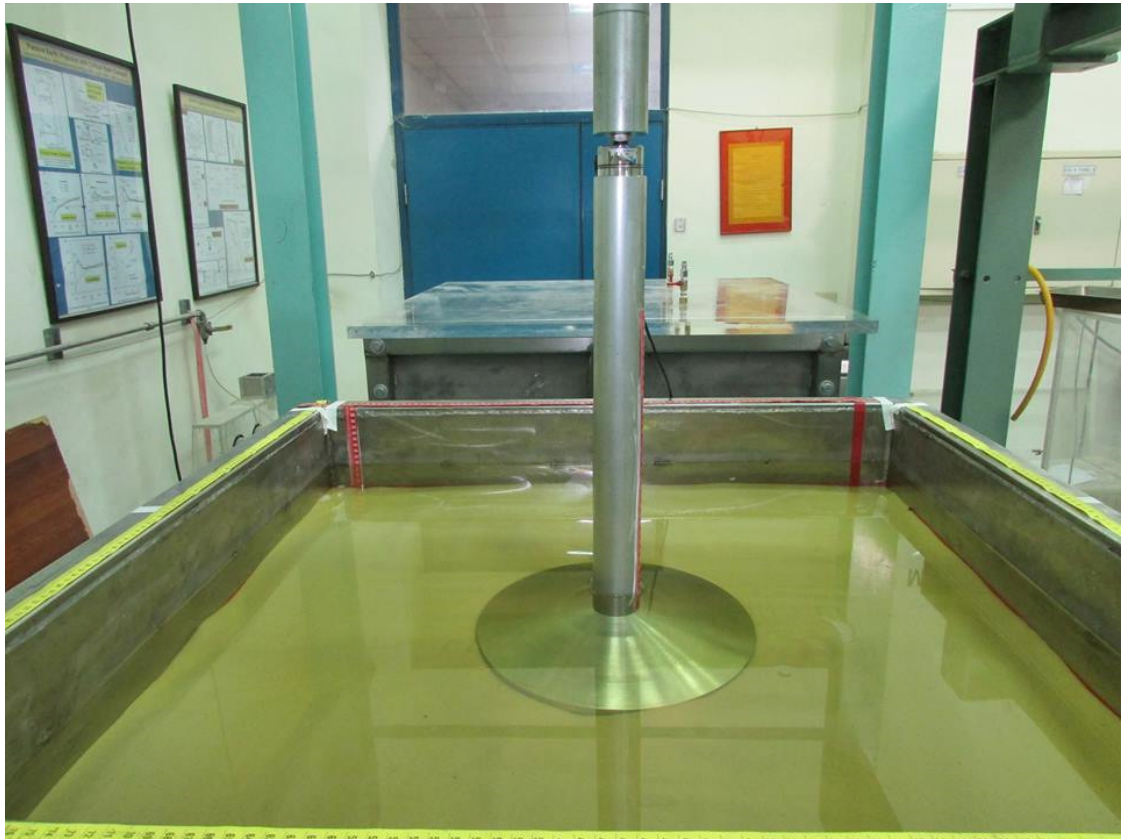
圖 5-37 直徑 300 mm spudcan 貫入浸水砂土
