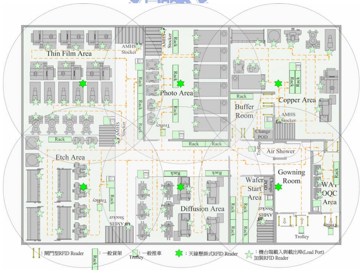
圖 2 3 搭配 Microwave RFID 系統之晶圓廠廠區佈置與動線運作示意圖
