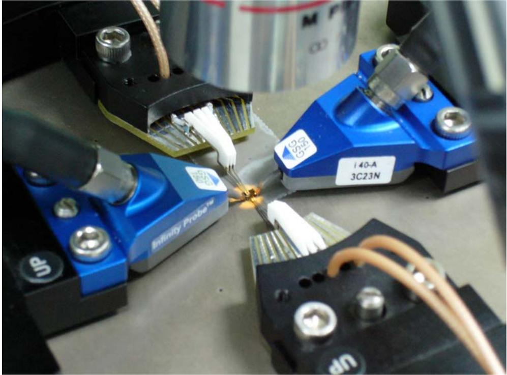
Figure 4.2.3 使用 4 組探針做 on-wafer 量測
