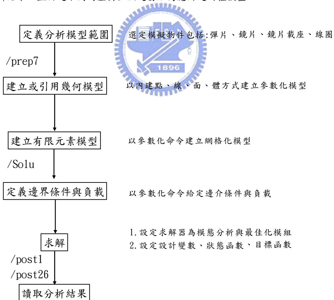
圖 3-1 穿透式平順圖像裝置有限元素分析模型建立之流程
