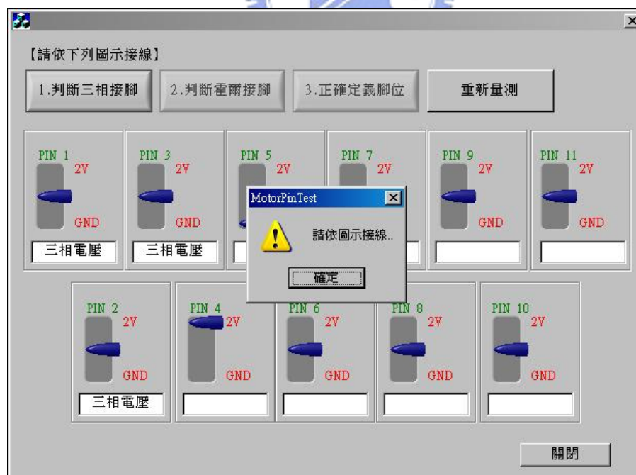
圖 5.5: 找出三相線圈電壓接腳
