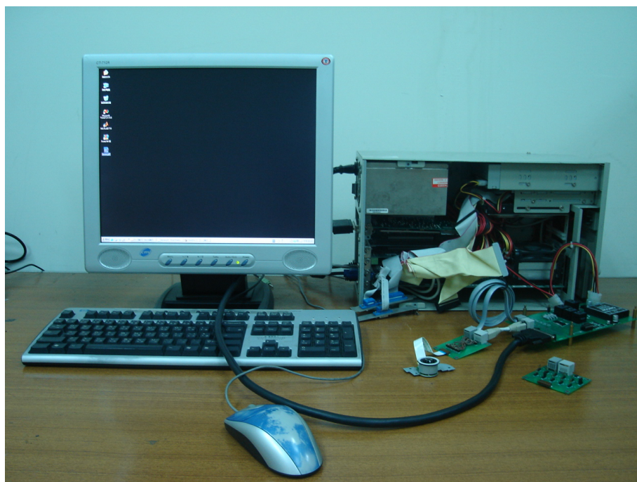
圖 5.12: 馬達扭矩常數量測機台實體
