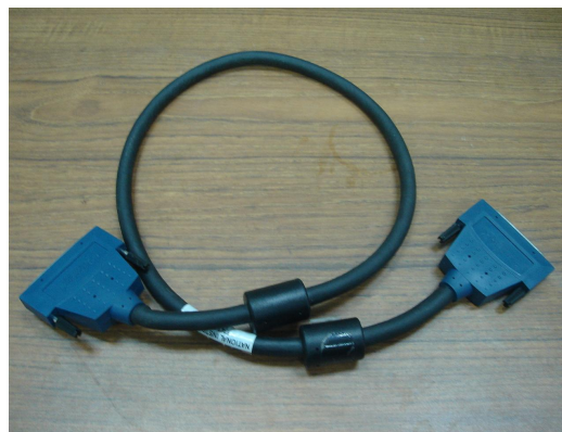
圖 2.15: PCI-6052E 的接線盒及轉接線
