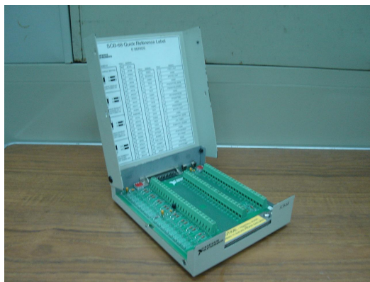
圖 2.15: PCI-6052E 的接線盒及轉接線
