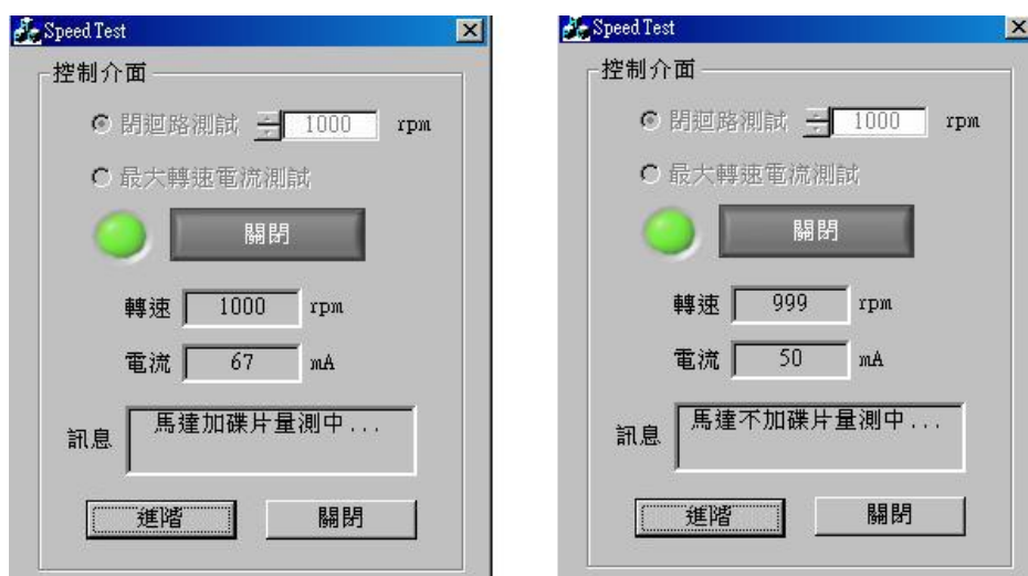
圖 5.23: 馬達轉速與電流量測之視窗化操作介面
