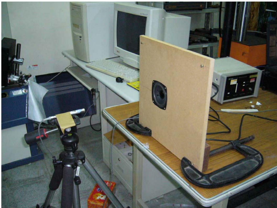
圖 5.2 傳統錐形喇叭失真量測圖
