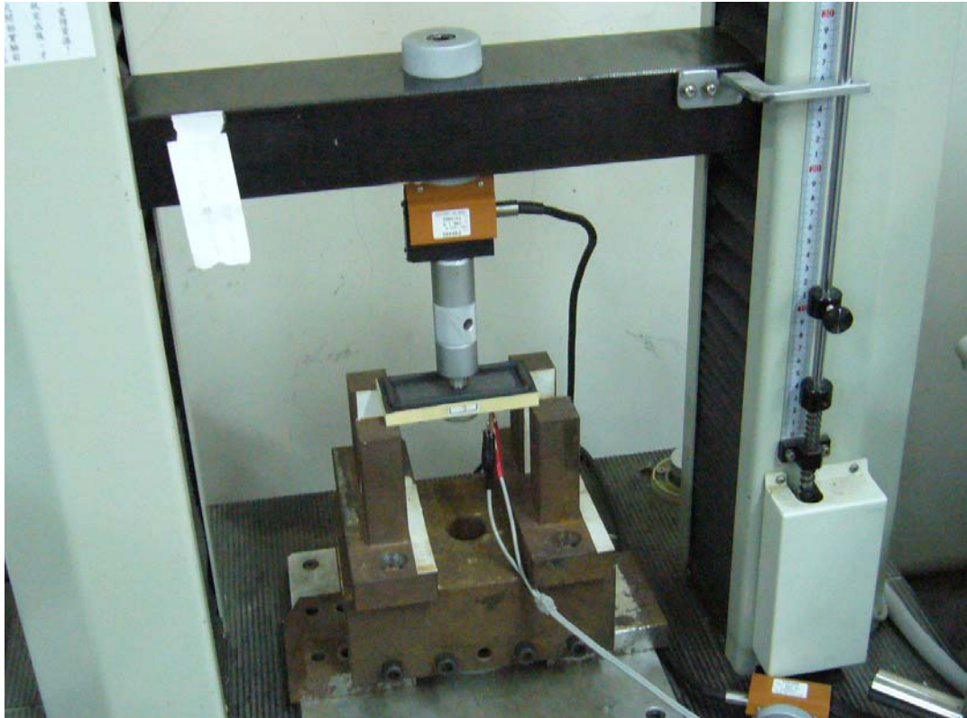
圖 5.18 量測振幅及勁度與位移關係實驗設備架設
