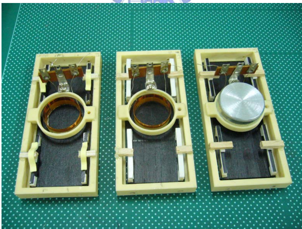
圖 5.44 揚聲器支承設計 8—4 支碳纖臂+膠棉阻尼支承
