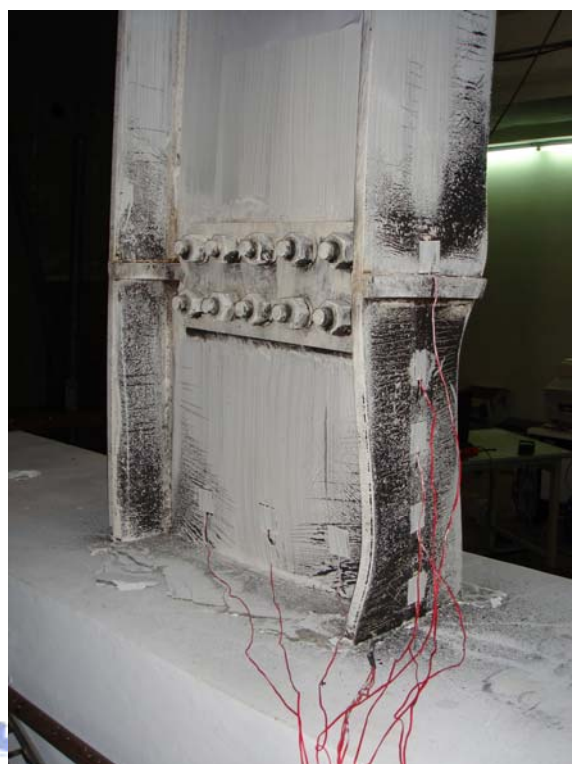
照片 4.5 試體 JBC-SRC1 在層間變位角達 4.0% 弧度時之情形
