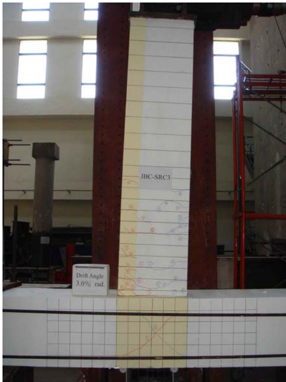
照片 4.19 試體 JBC-SRC3 在層間變位角達 3.0% 弧度時之情形
