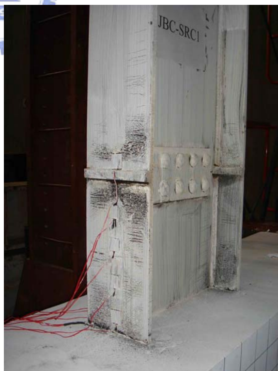
照片 4.4 試體 JBC-SRC1 在層間變位角達 3.0% 弧度時之情形
