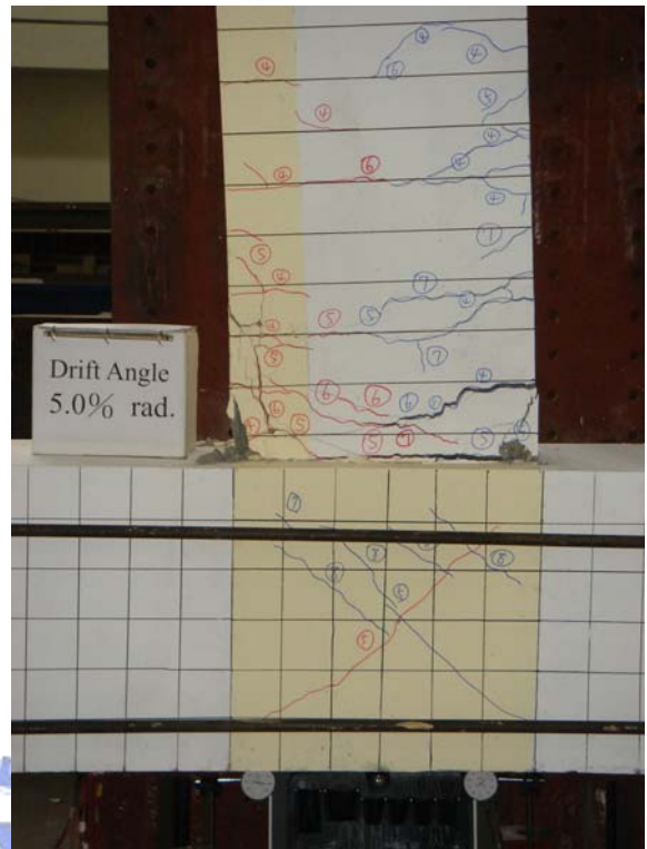
照片 4.21 試體 JBC-SRC3 在層間變位角達 5.0% 弧度第一迴圈時之情形
