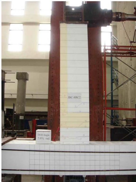
照片 4.11 試體 JBC-SRC2 在層間變位角達 2.0% 弧度時之情形
