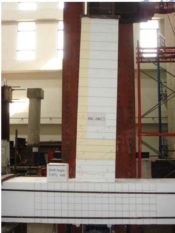
照片 4.12 試體 JBC-SRC2 在層間變位角達 3.0% 弧度時之情形
