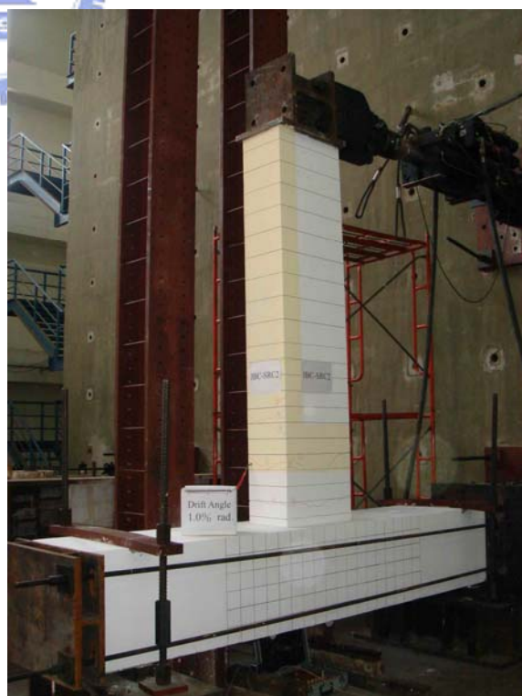
照片 4.10 試體 JBC-SRC2 在層間變位角達 1.0% 弧度時之情形
