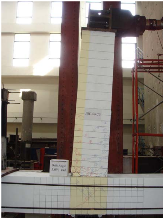
照片 4.21 試體 JBC-SRC3 在層間變位角達 5.0% 弧度第一迴圈時之情形
