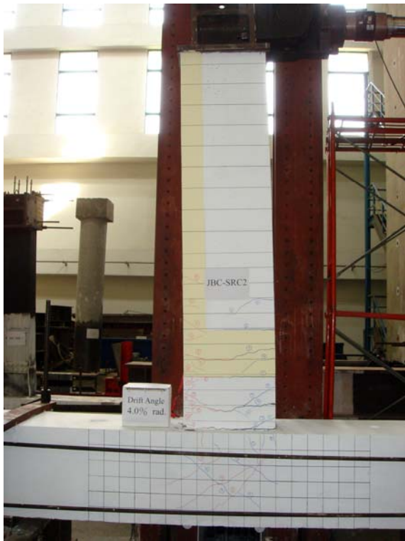
照片 4.13 試體 JBC-SRC2 在層間變位角達 4.0% 弧度時之情形
