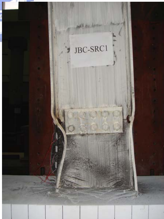
照片 4.6 試體 JBC-SRC1 在層間變位角達 5.0% 弧度第一迴圈時之情形： (1) 鋼梁發展出良好的塑性鉸；(2) 托梁續接處之銲道保持良好； (3) 梁柱接頭區之混凝土無明顯開裂。
