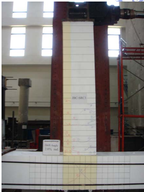
照片 4.18 試體 JBC-SRC3 在層間變位角達 2.0% 弧度時之情形
