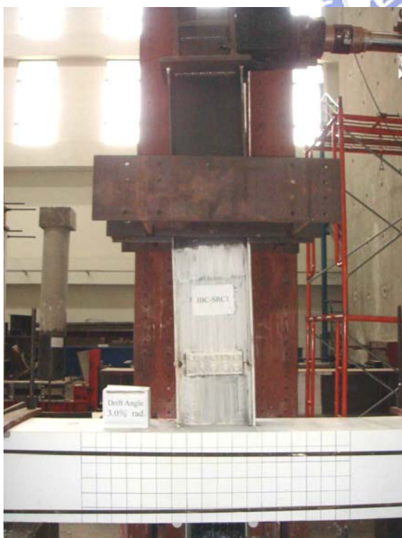
照片 4.4 試體 JBC-SRC1 在層間變位角達 3.0% 弧度時之情形
