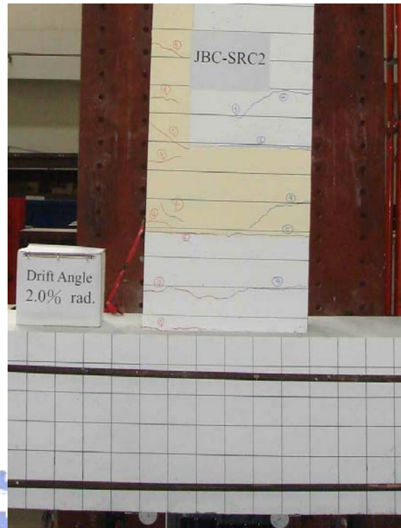
照片 4.11 試體 JBC-SRC2 在層間變位角達 2.0% 弧度時之情形
