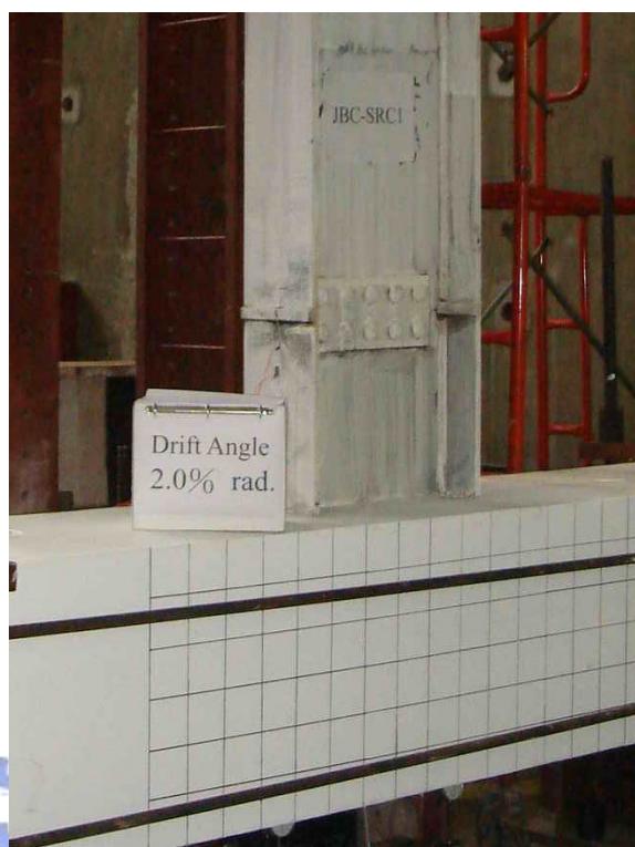
照片 4.3 試體 JBC-SRC1 在層間變位角達 2.0% 弧度時之情形
