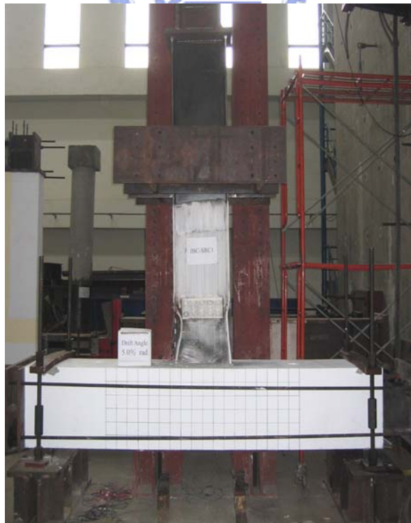
照片 4.8 試體 JBC-SRC1 在層間變位角達 5.0% 弧度第二迴圈末期試驗終止時之情形
