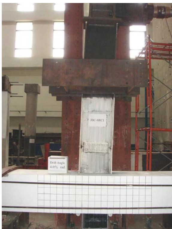
照片 4.5 試體 JBC-SRC1 在層間變位角達 4.0% 弧度時之情形
