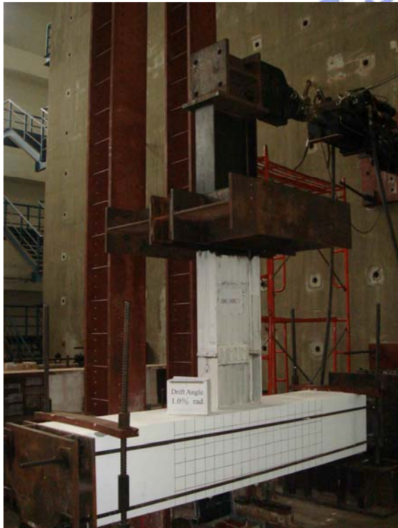
照片 4.2 試體 JBC-SRC1 在層間變位角達 1.0% 弧度時之情形
