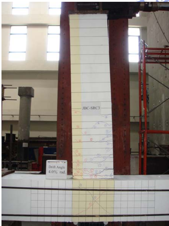
照片 4.20 試體 JBC-SRC3 在層間變位角達 4.0% 弧度時之情形
