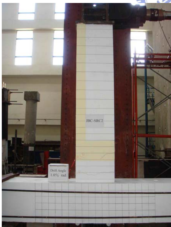
照片 4.10 試體 JBC-SRC2 在層間變位角達 1.0% 弧度時之情形
