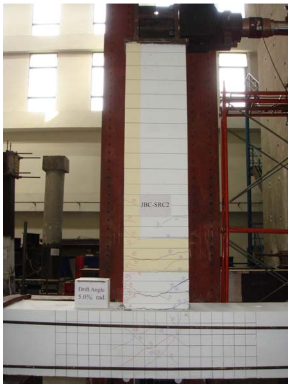
照片 4.15 試體 JBC-SRC2 在層間變位角達 5.0% 弧度後 試驗終止時之情形
