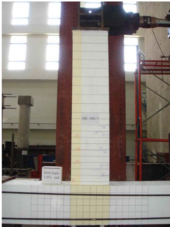
照片 4.17 試體 JBC-SRC3 在層間變位角達 1.0% 弧度時之情形
