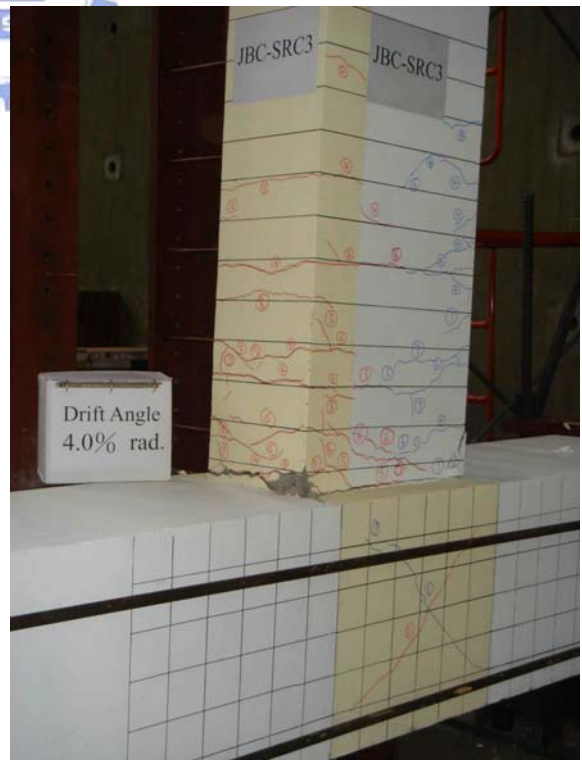
照片 4.20 試體 JBC-SRC3 在層間變位角達 4.0% 弧度時之情形
