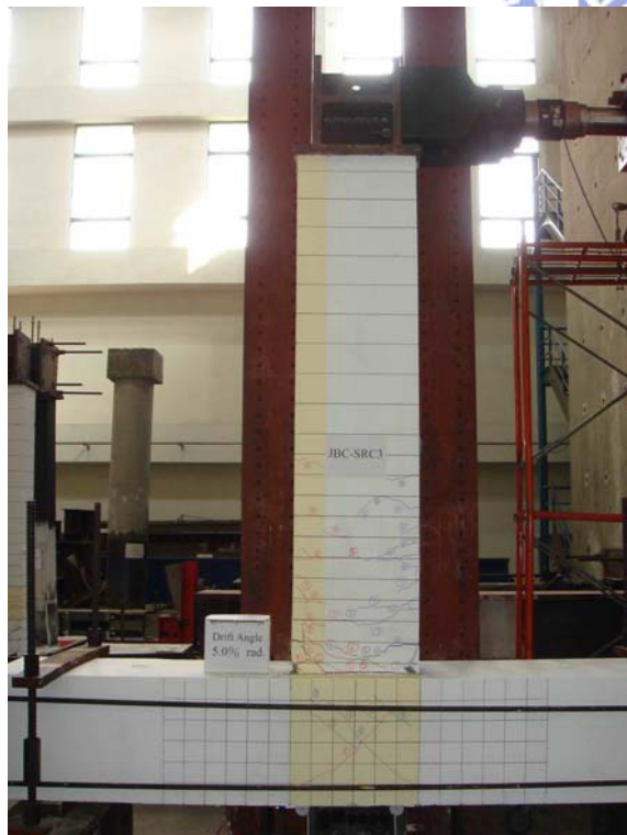
照片 4.22 試體 JBC-SRC3 在層間變位角達 5.0% 弧度後 試驗終止時之情形
