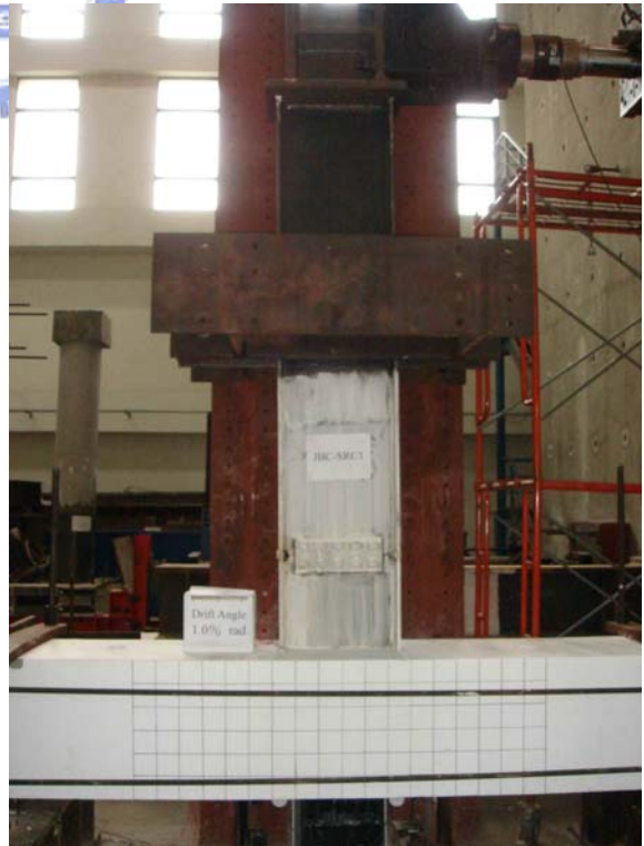
照片 4.2 試體 JBC-SRC1 在層間變位角達 1.0% 弧度時之情形
