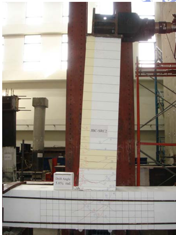
照片 4.14 試體 JBC-SRC2 在層間變位角達 5.0% 弧度時之情形
