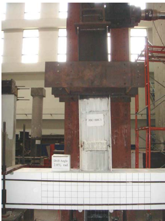
照片 4.3 試體 JBC-SRC1 在層間變位角達 2.0% 弧度時之情形
