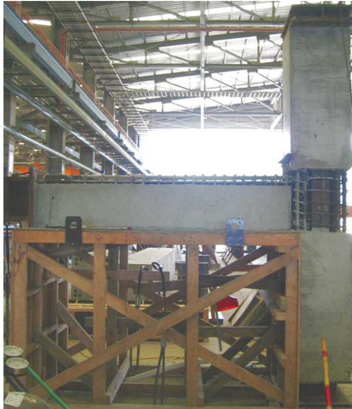
(a) 預鑄 SRC 梁柱接頭混凝土第二次灌漿前之情形
