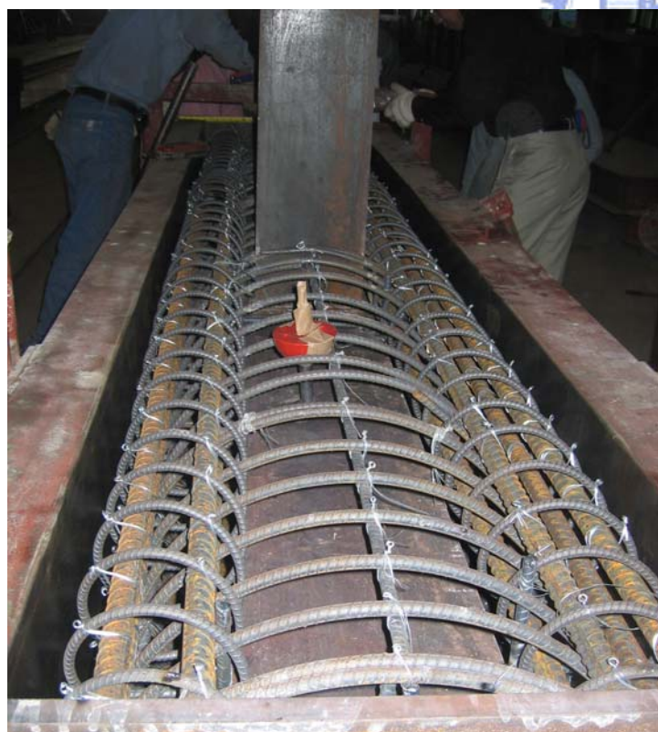
(b) 試體封模混凝土灌漿前之情形
