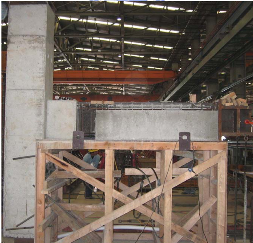
(b) 半預鑄 SRC 梁混凝土第二次灌漿前之情形
