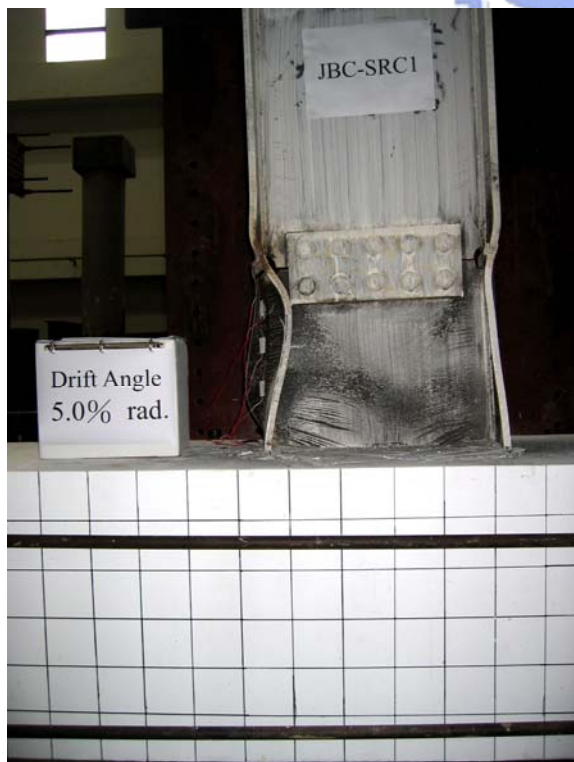
照片 4.6 試體 JBC-SRC1 在層間變位角達 5.0% 弧度第一迴圈時之情形： (1) 鋼梁發展出良好的塑性鉸；(2) 托梁續接處之銲道保持良好； (3) 梁柱接頭區之混凝土無明顯開裂。
