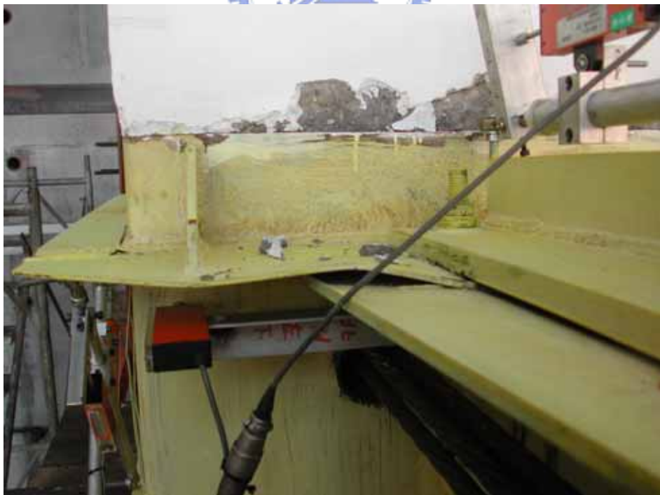
照片 3.36 削切鋼板挫屈 ( \theta=0.04 rad)
