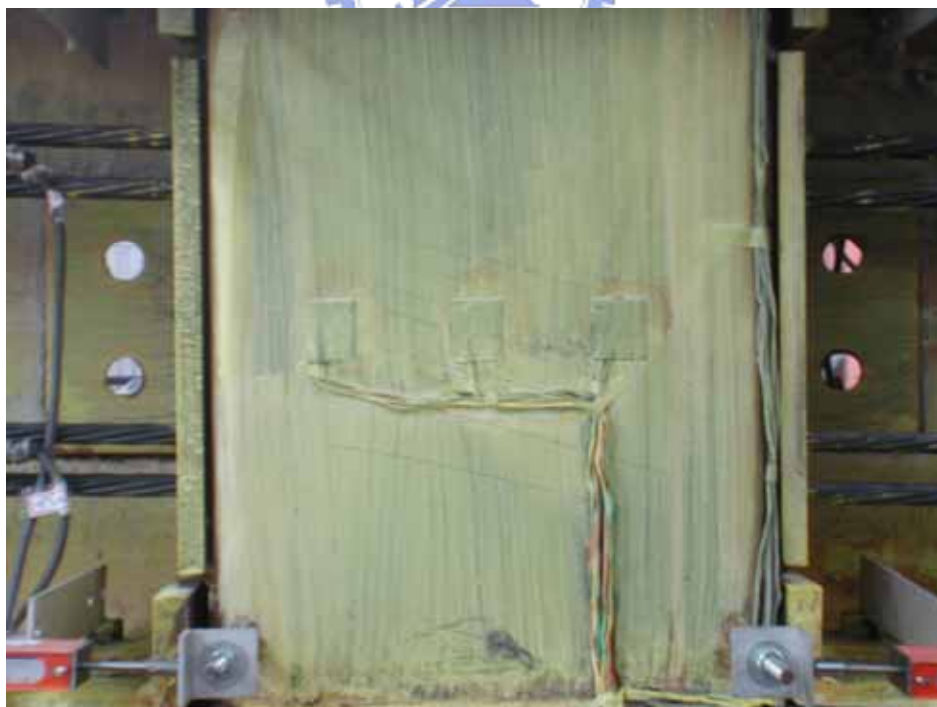
照片 3.8 鋼管混凝土柱的梁柱接合區鋼管剪力降伏 ( \theta=0.03 rad)
