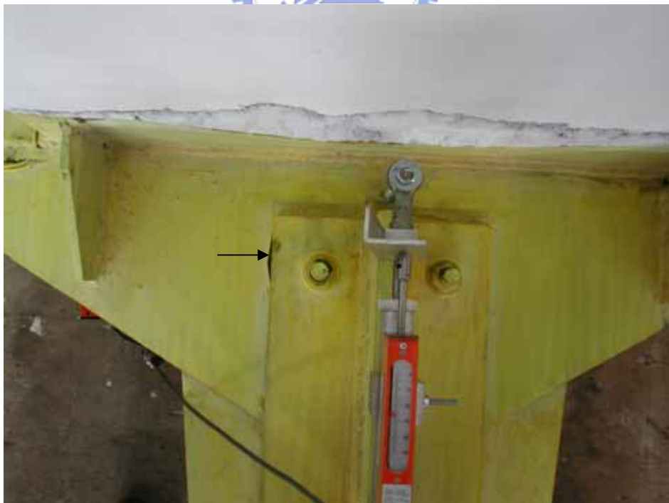
照片 3.32 蓋板附近石膏漆剝落照片 ( \theta=0.00375 rad)
