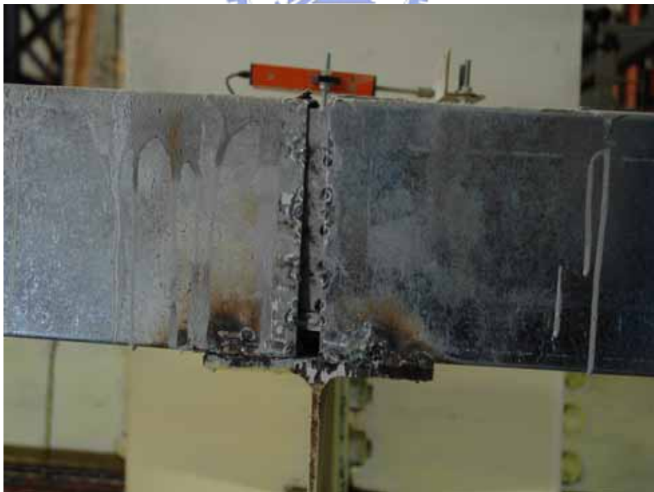
照片 3.46 兩片鋼承版接合處分離 ( \theta=0.04 rad)
