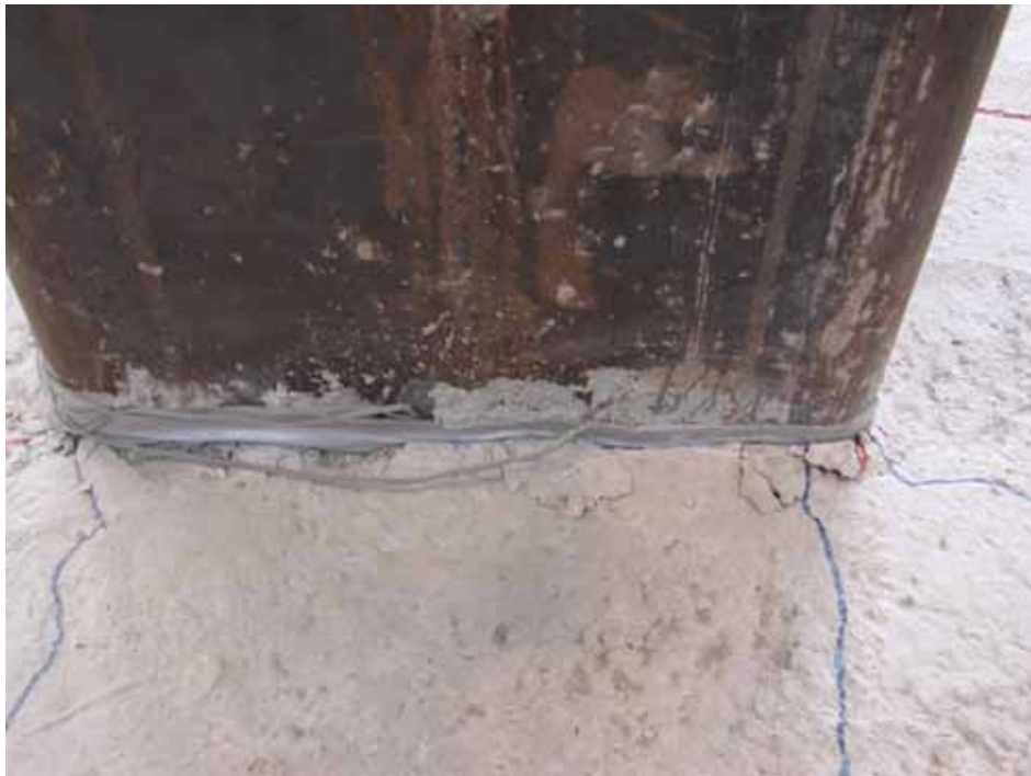
照片 3.17 受壓側柱角落混凝土壓碎 ( \theta=0.015 rad)
