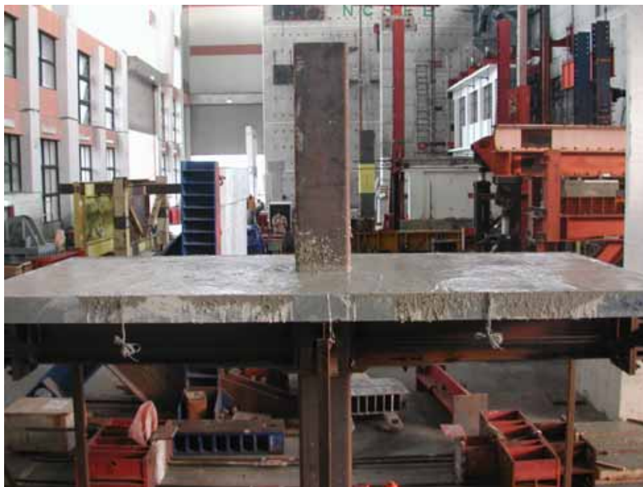
照片 3.5 試體 2 樓版灌漿完成
