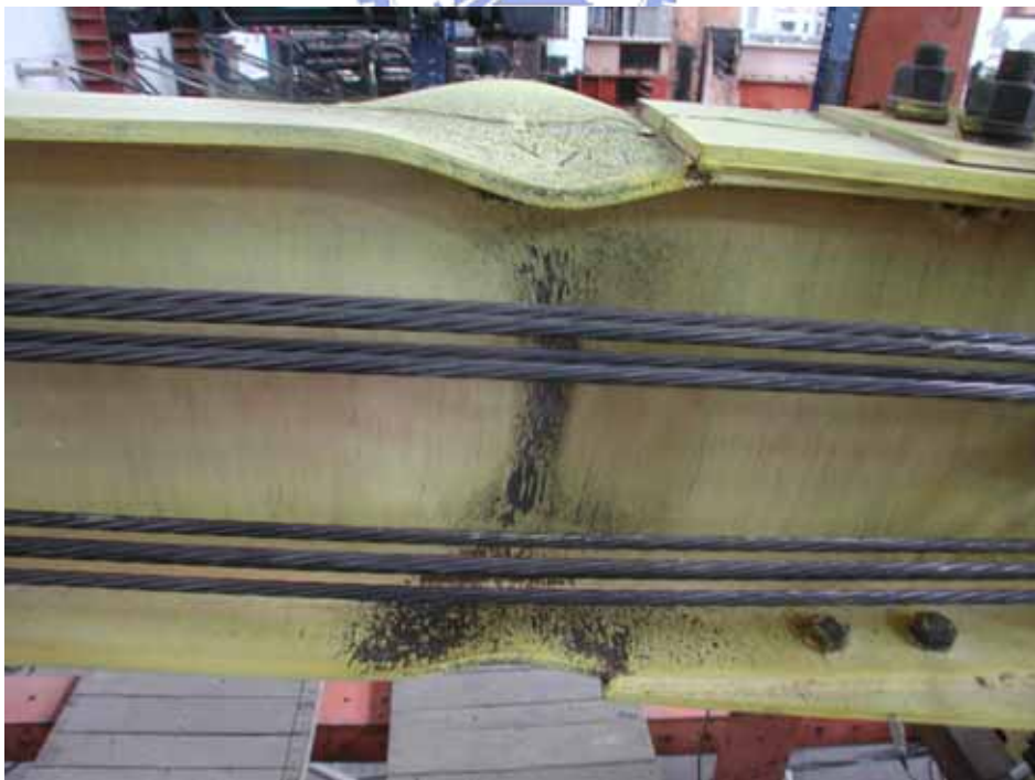
照片 3.12 梁 1 上下翼板挫屈 ( \theta=0.04 rad)
