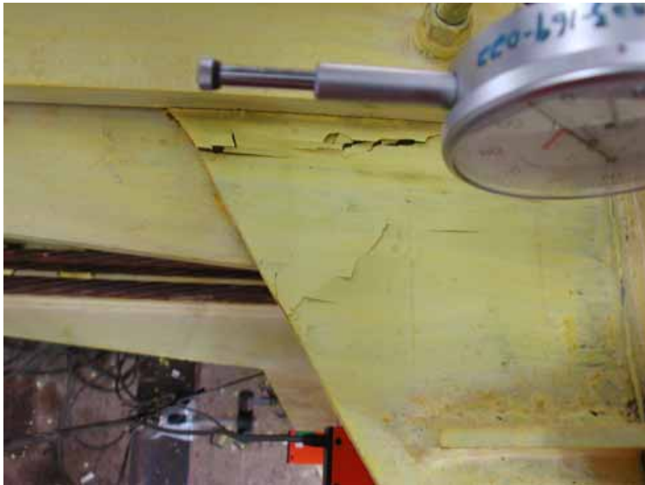
照片 3.33 梁 1 上方 4 mm 削切鋼板降伏 ( \theta=0.01 rad)
