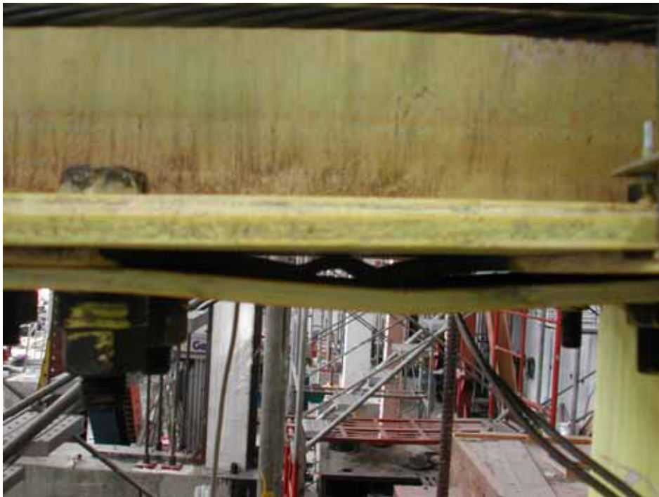
照片 3.11 下方削切鋼板高模態挫屈 ( \theta=0.04 rad)
