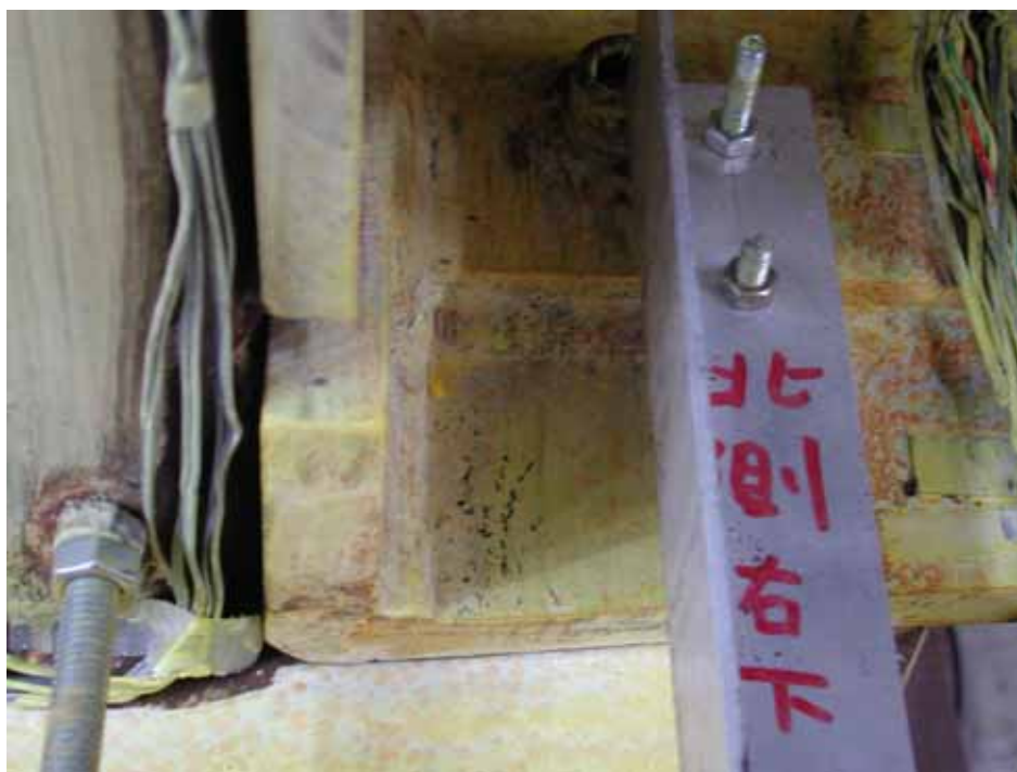
照片 3.7 下翼板外側加勁板末端降伏 ( \theta=0.01 rad)
