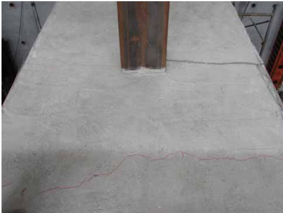
照片 3.15 樓版混凝土出現拉力裂縫 ( \theta=0.005 rad)
