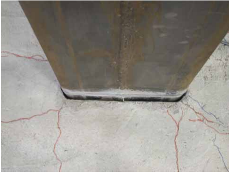
照片 3.21 樓版混凝土裂縫 ( \theta=0.04 rad)
