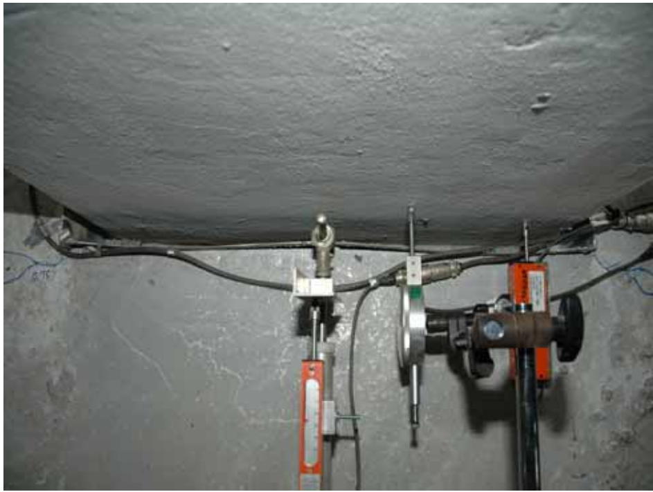
照片 3.41 樓版混凝土邊板被推開 ( \theta=0.01 rad)
