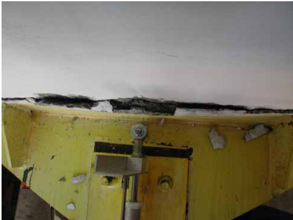
照片 3.35 柱面包覆鋼板被拉開 ( \theta=0.04 rad)
