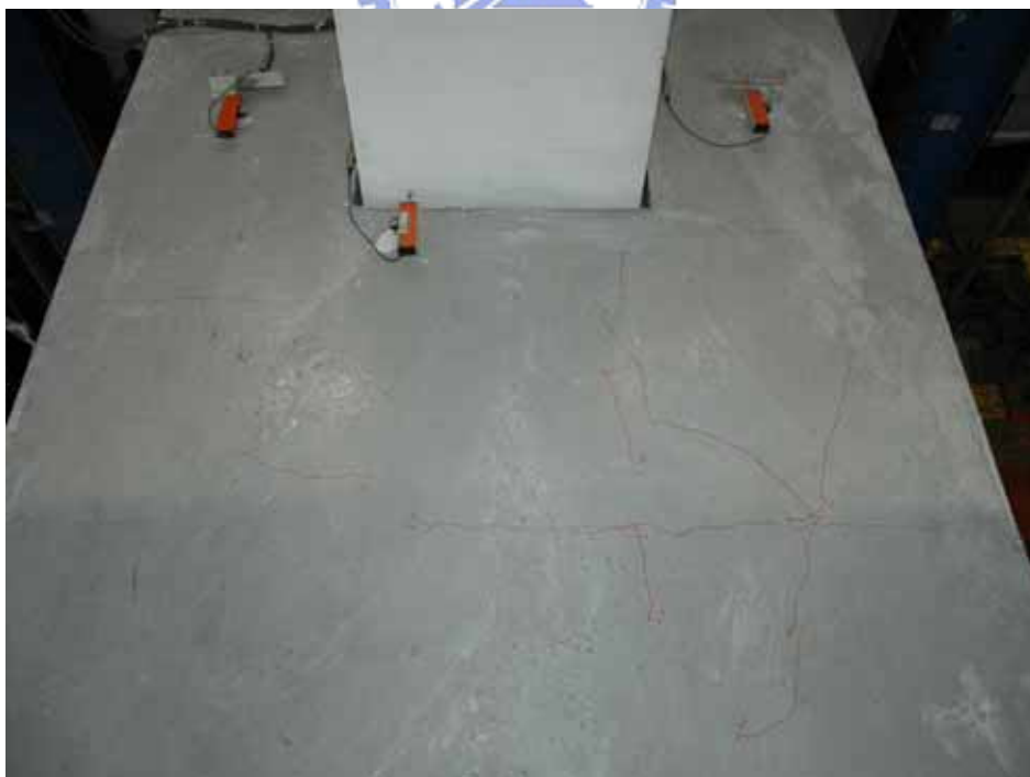
照片 3.40 樓版混凝土出現裂縫 ( \theta=0.005 rad)
