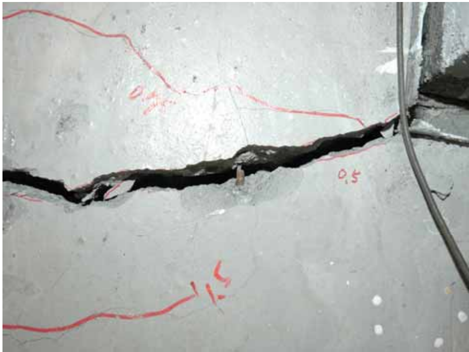
照片 3.43 樓版南側 6 根鋼絲網斷裂 ( \theta=0.03 rad)
