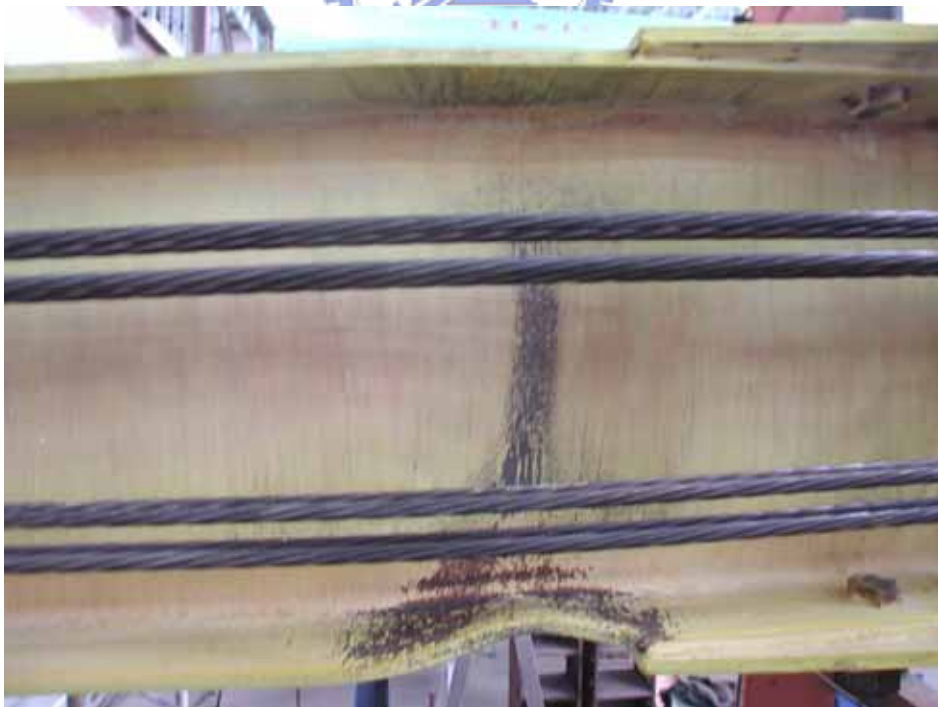
照片 3.10 梁 1 下翼板挫屈 ( \theta=0.04 rad)
