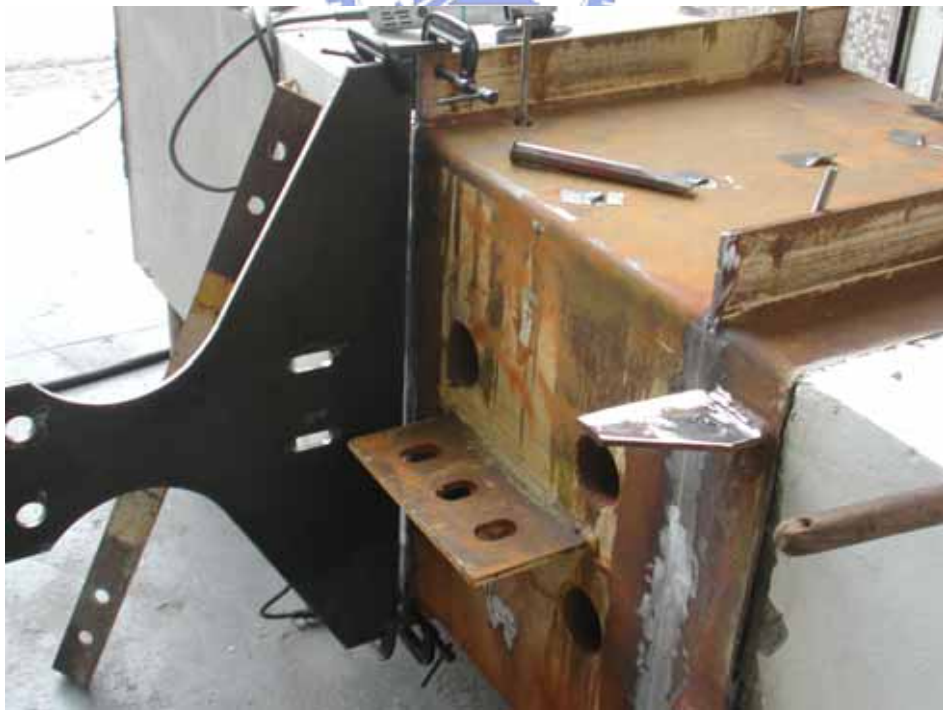
照片 3.26 用 C 型夾進行假固定
