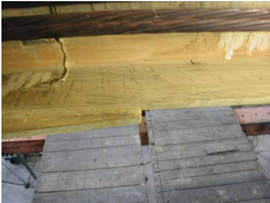
照片 3.19 梁下翼板降伏 ( \theta=0.02 rad)
