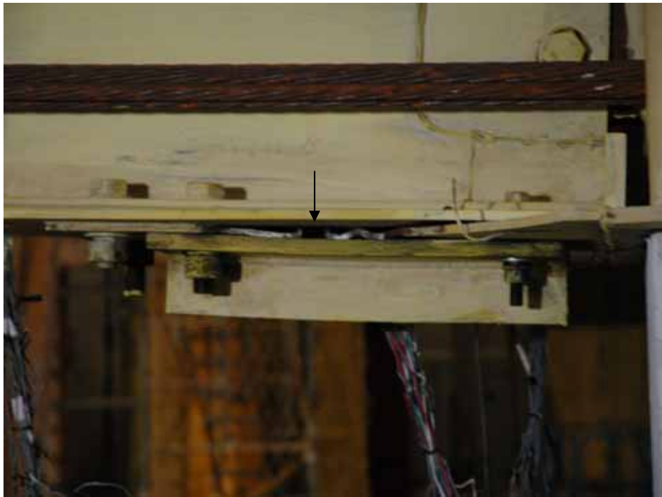
照片 3.47 鋼梁下方 8 mm 削切鋼板斷裂 ( \theta=0.05 rad)
