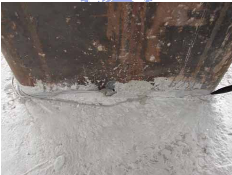
照片 3.14 柱周圍混凝土出現裂縫 ( \theta=0.00375 rad)
