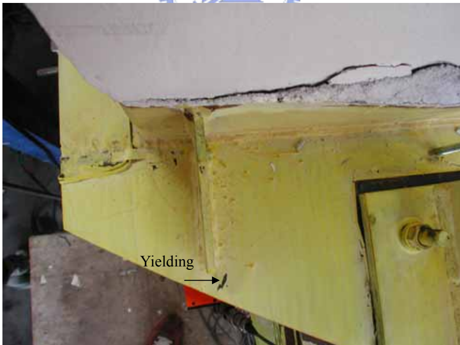
照片 3.34 梁 2 上方 4 mm 削切鋼板降伏 ( \theta=0.03 rad)
