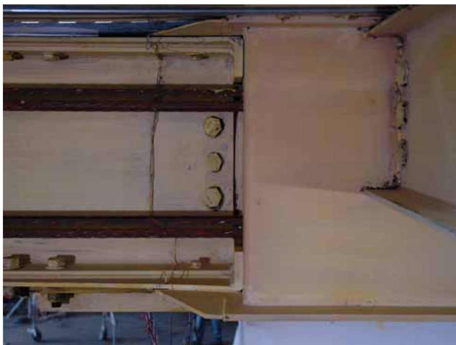
照片 3.39 梁端承壓版與柱面間打開 ( \theta=0.005 rad)
