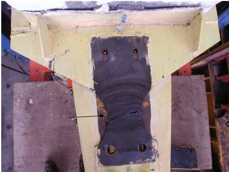
照片 3.37 4 mm 削切鋼板斷裂
