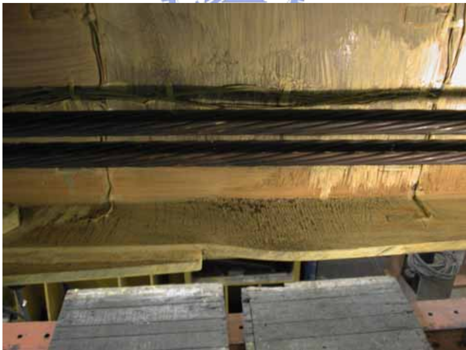
照片 3.20 梁下翼板挫屈 ( \theta=0.04 rad)
