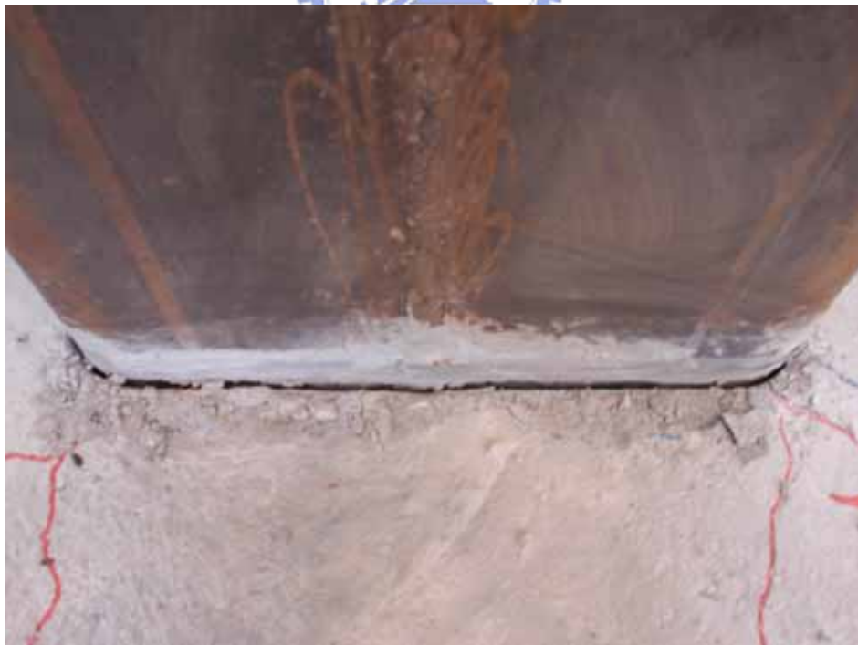
照片 3.16 受拉側柱邊混凝土裂縫約 2 mm ( \theta=0.015 rad)
