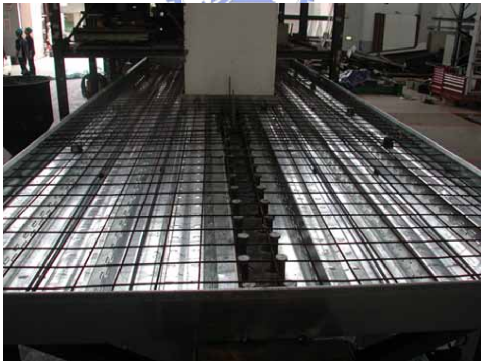
照片 3.30 鋼筋及鋼絲網都已鋪設完成
