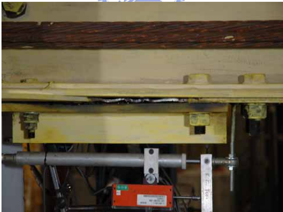
照片 3.44 梁下方 8 mm 削切鋼板挫屈 ( \theta=0.04 rad)
