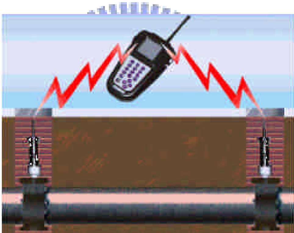
圖 3.7 漏水噪音監控系統（G R Fricke and J Manuel,2005）
