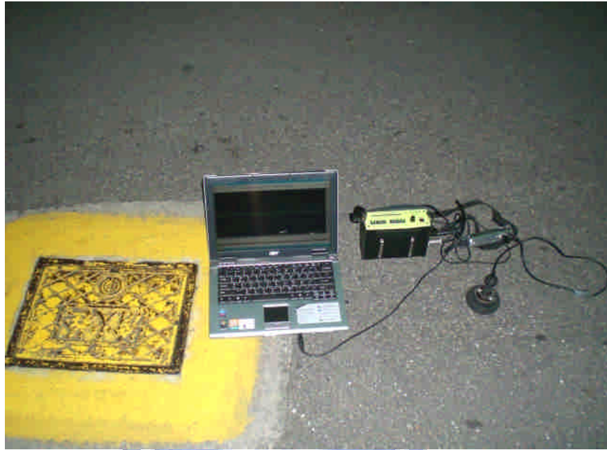
圖 4.2 現地試驗於非漏水點之管線上方路面檢測
