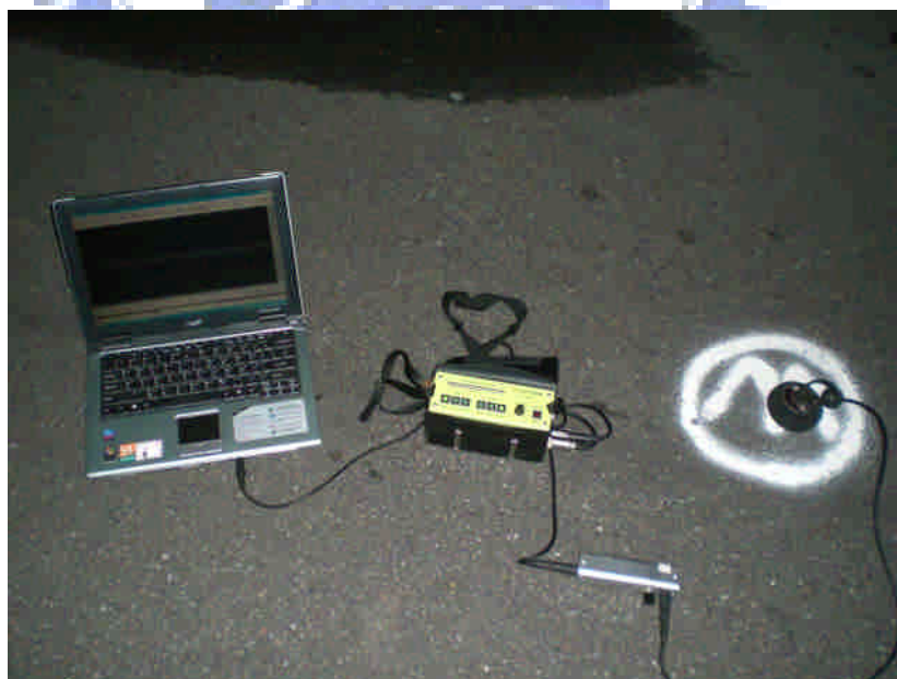
圖 4.1 現地實驗於疑似漏水點上路面檢測
