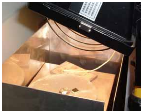
圖 3-5 以鹵素燈加熱石墨基板
