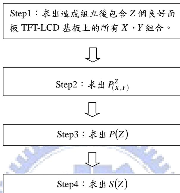
圖 3.6 Cell 組立製程運算模組運算流程
