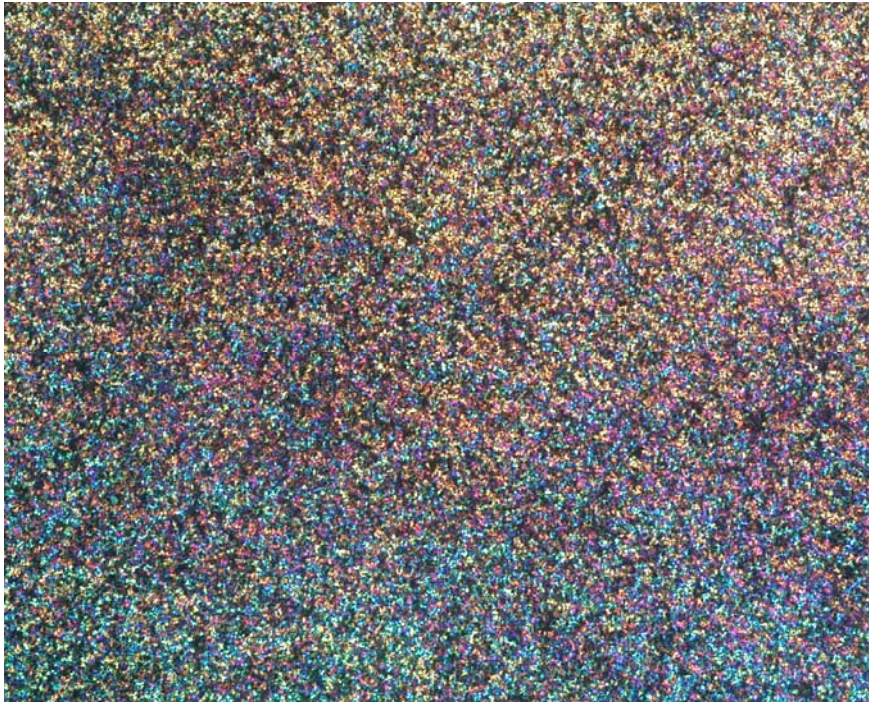
圖 4- 16 0.125%黑色素薄膜在 40°C 成膜之光學顯微鏡影像
