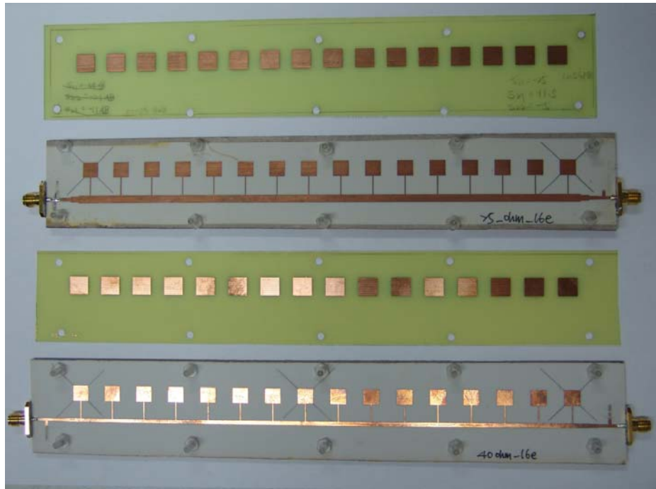
圖(4.3.1) 由上至下為 25 歐姆和 40 歐姆一段式傳輸線的饋入天線
