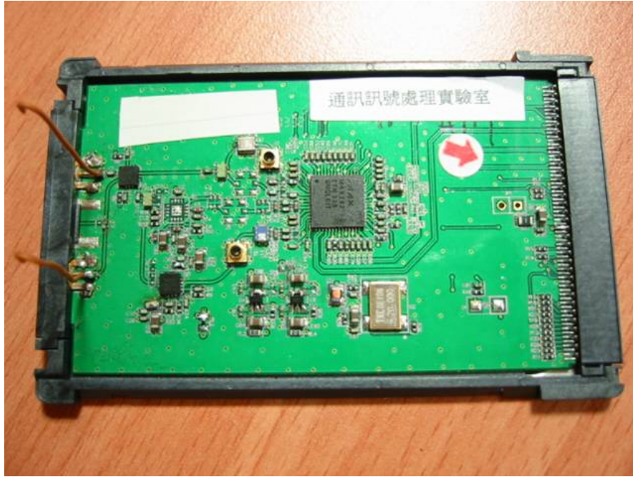
圖 3-14 射頻模組與 MAX2827 晶片
