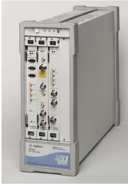
圖 3-25 向量訊號分析儀器與視窗軟體工作畫面
