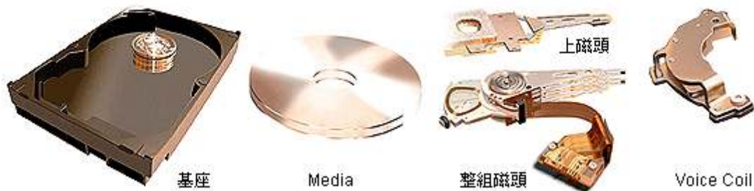
圖 8 硬式磁碟機的關鍵零組件
