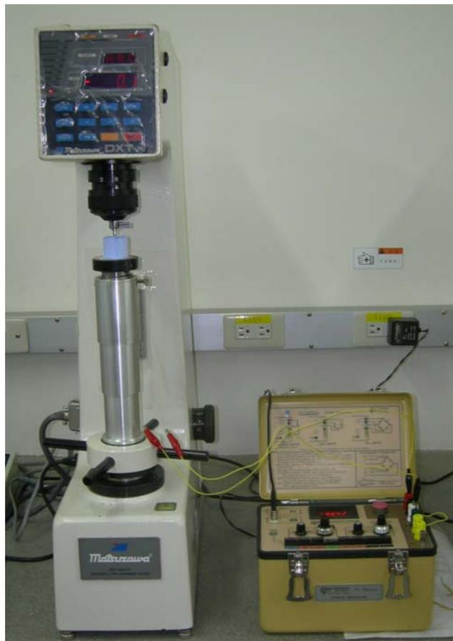
圖 38 以左邊之硬度計施壓，以右邊之應變計測量
