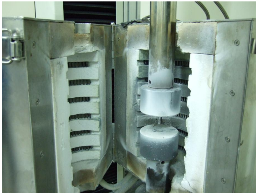
圖3-8 搭搭配材料試驗機之加熱裝置內部
