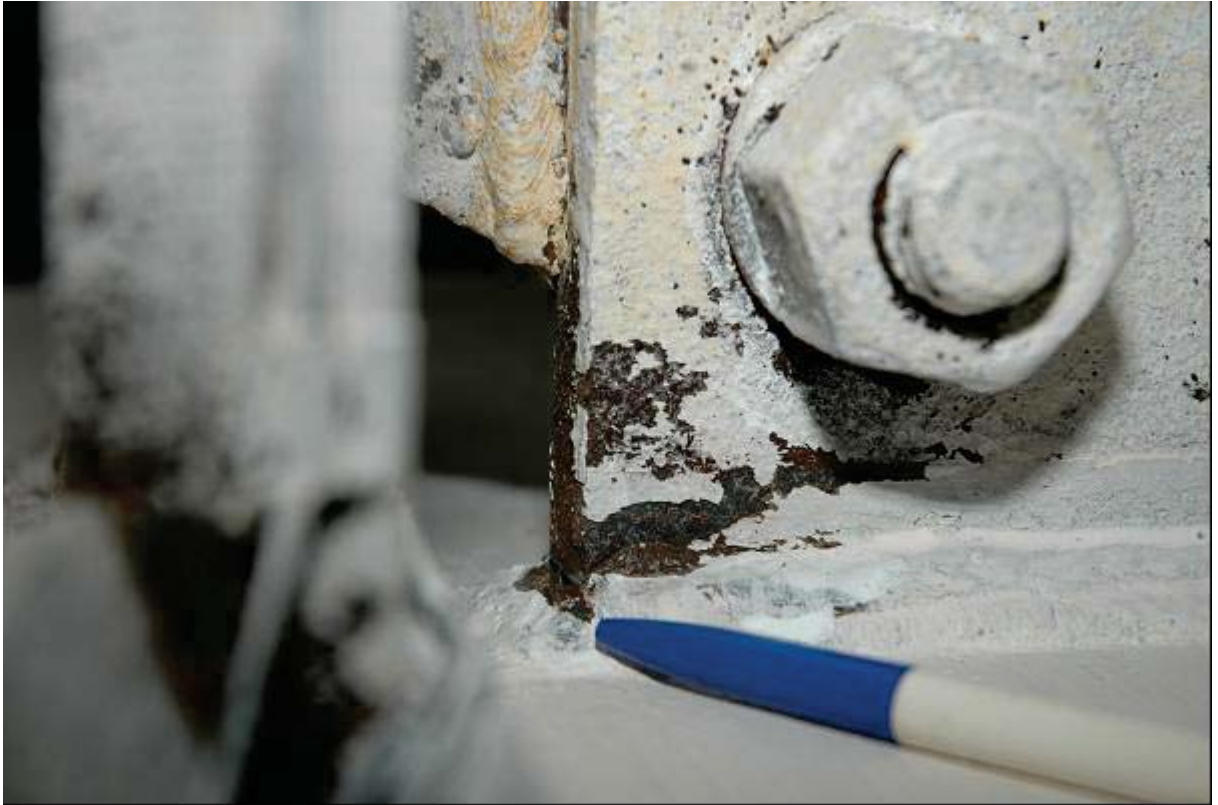
照片 3.7 試體 UR 剪力板焊道端部裂縫 ( \theta = -3.0\% 弧度第一圈)
