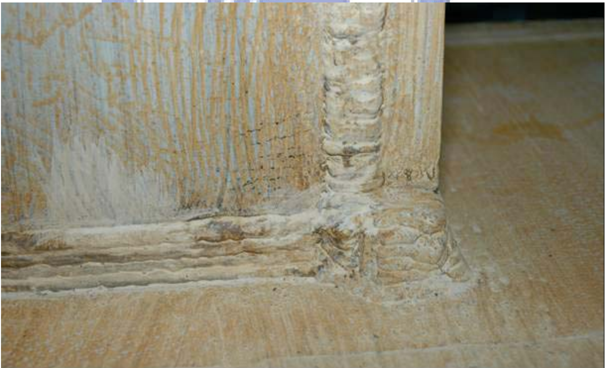
照片 4.42 試體 FDWS3 加勁板降伏情形 ( \theta=3.0\% 弧度結束)
