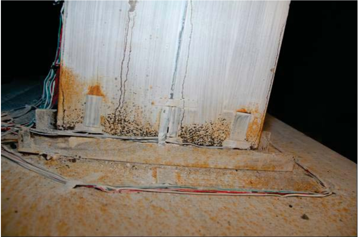
照片 3.23 試體 IFS1 梁下翼板降伏情形 ( \theta = +4.8\% 弧度)
