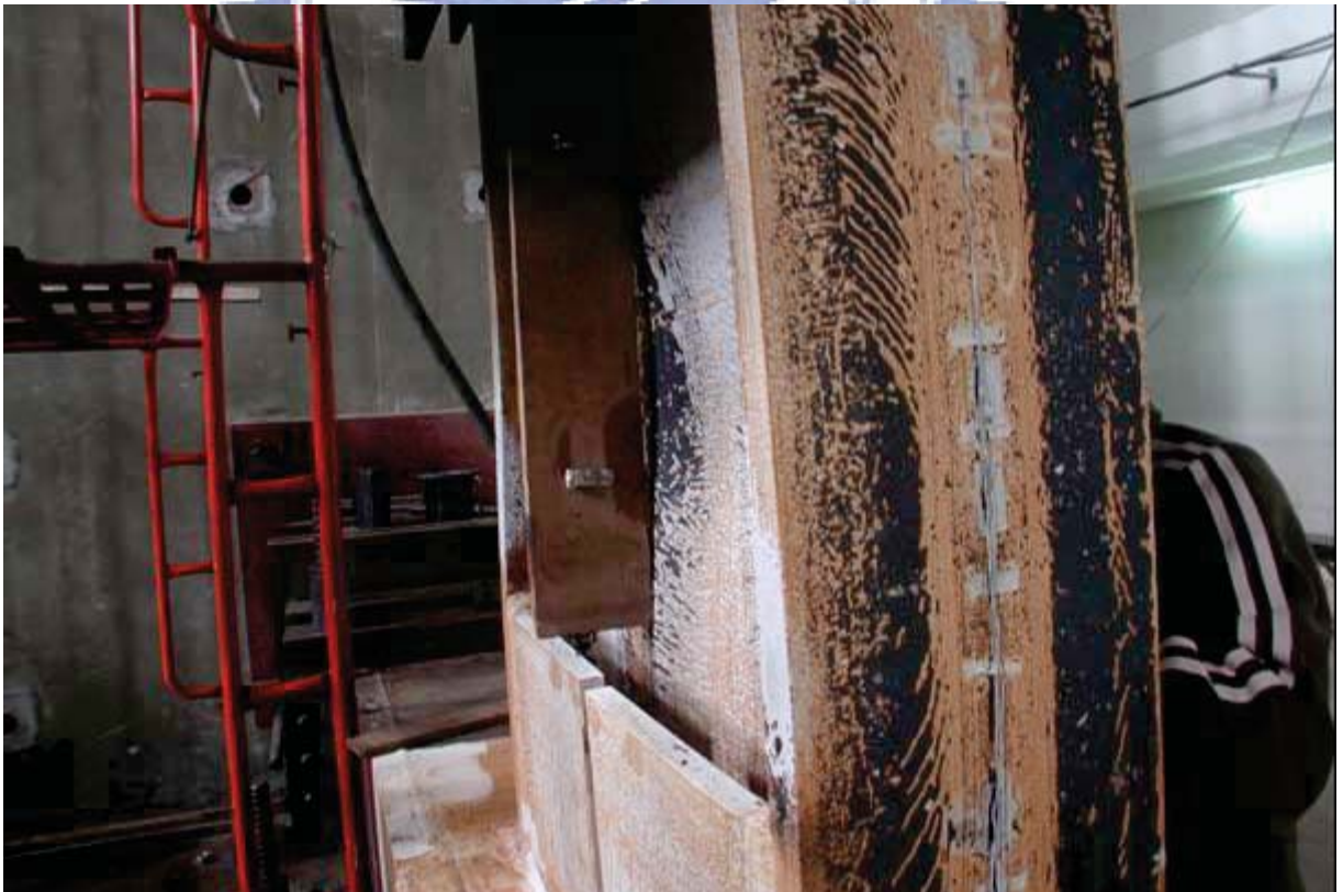
照片 3.70 試體 IFS5 梁下翼腹板挫屈 18 mm (位移角 \theta = -4.7\% 弧度)
