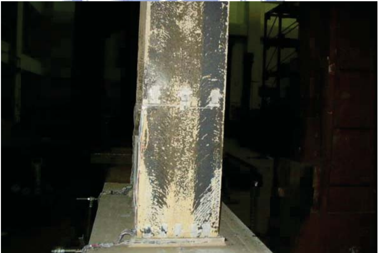
照片 3.48 試體 IFS4 梁下翼板之降伏情形 ( \theta=4.0\% 弧度結束)
