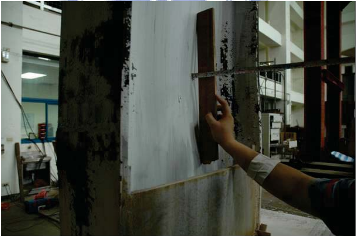
照片 4.8 試體 FDWS1 梁腹板挫屈幅度達 25 mm ( \theta = +3.0\% 弧度)
