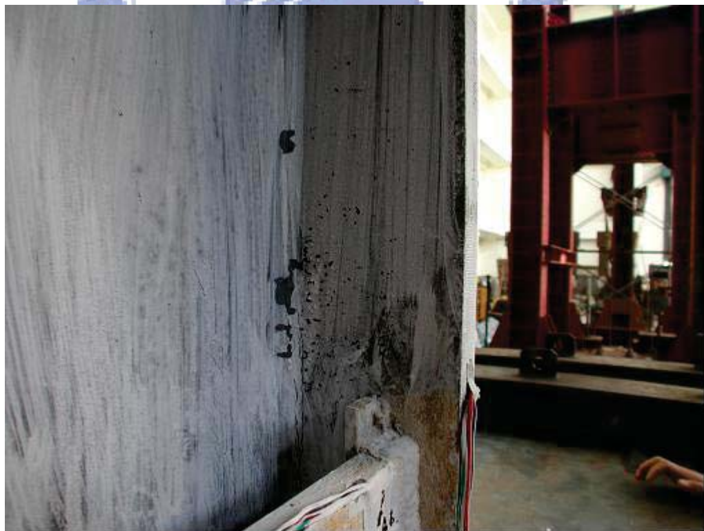
照片 3.28 試體 IFS2 下翼板內側降伏 ( \theta = +2.0\% 弧度)
