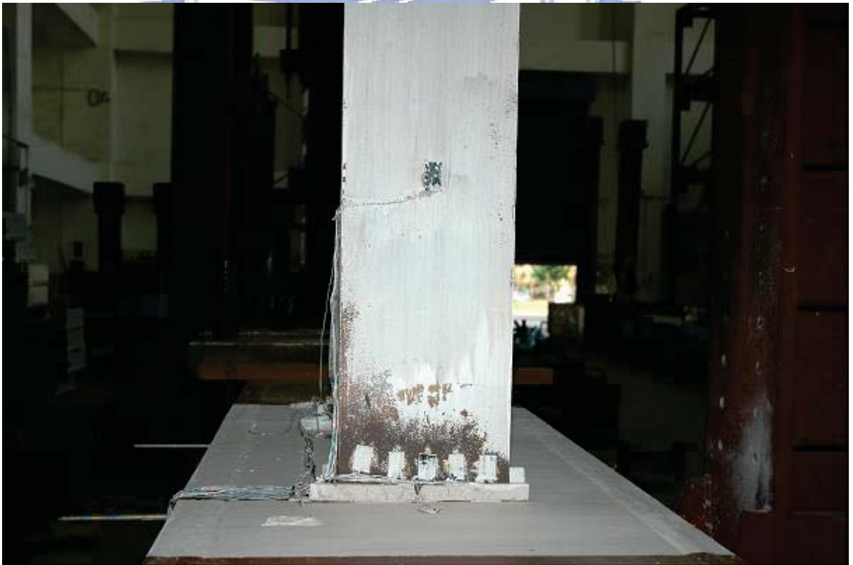
照片 3.12 試體 UR 梁下翼板降伏 ( \theta = 4.0\% 弧度第一圈結束)
