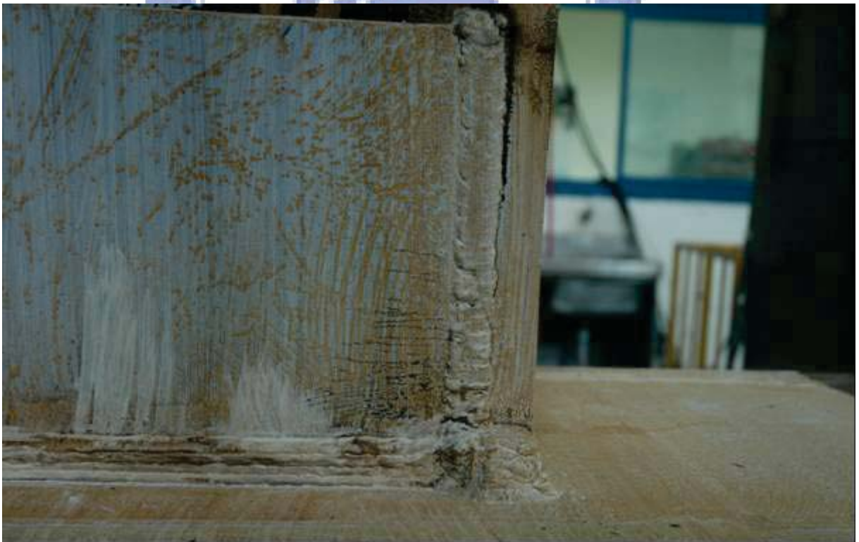
照片 4.50 試體 FDWS3 加勁板之降伏範圍擴大情形 ( \theta=4.8\% 弧度結束)
