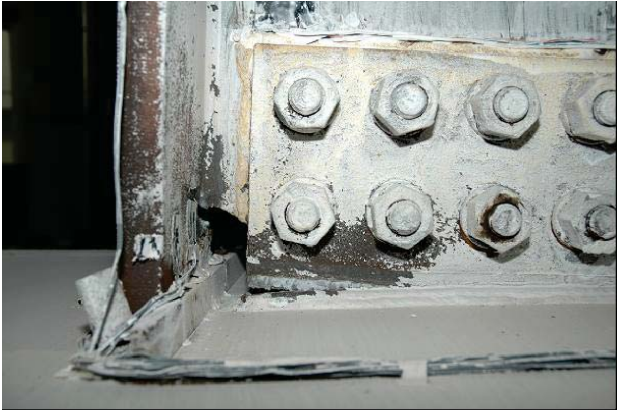
照片 3.11 試體 UR 剪力板焊道端部裂縫 ( \theta = -4.0\% 弧度第一圈)
