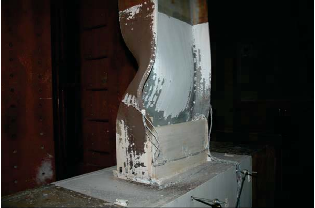
照片 4.11 試體 FDWS1 梁上翼板挫屈幅度達 105 mm ( \theta = +4.7\% 弧度)
