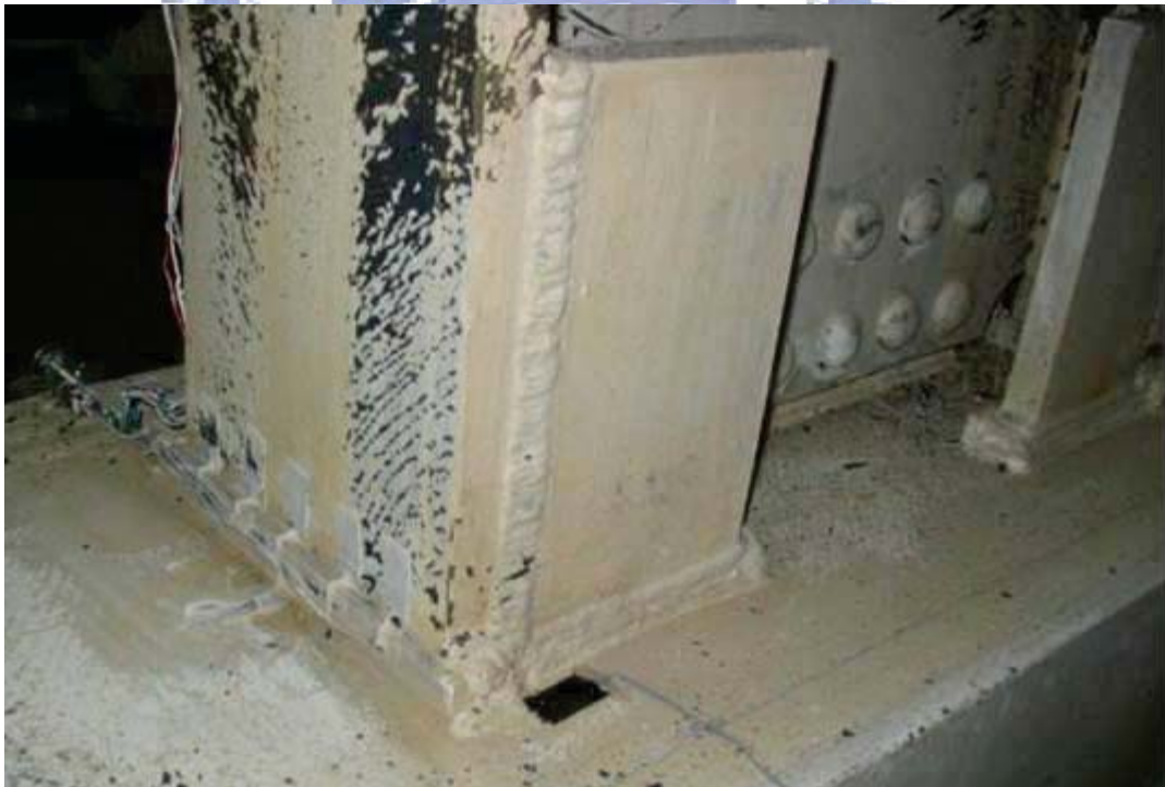
照片 3.46 試體 IFS4 加勁板與梁翼板接合之焊道降伏 ( \theta=3.0\% 弧度結束)
