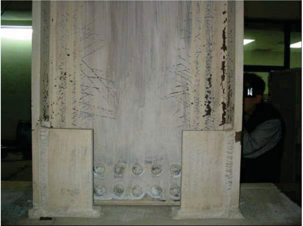
照片 3.45 試體 IFS4 梁腹板降伏範圍增加 ( \theta=1.5\% 弧度結束)
