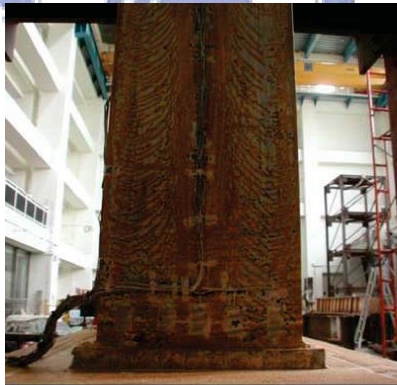
照片 3. 64 試體 IFS5 下翼板降伏 ( \theta=1.0\% 弧度結束)
