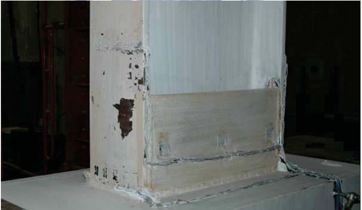
照片 4.2 試體 FDWS1 上翼板降伏 ( \theta=1.0\% 弧度結束)
