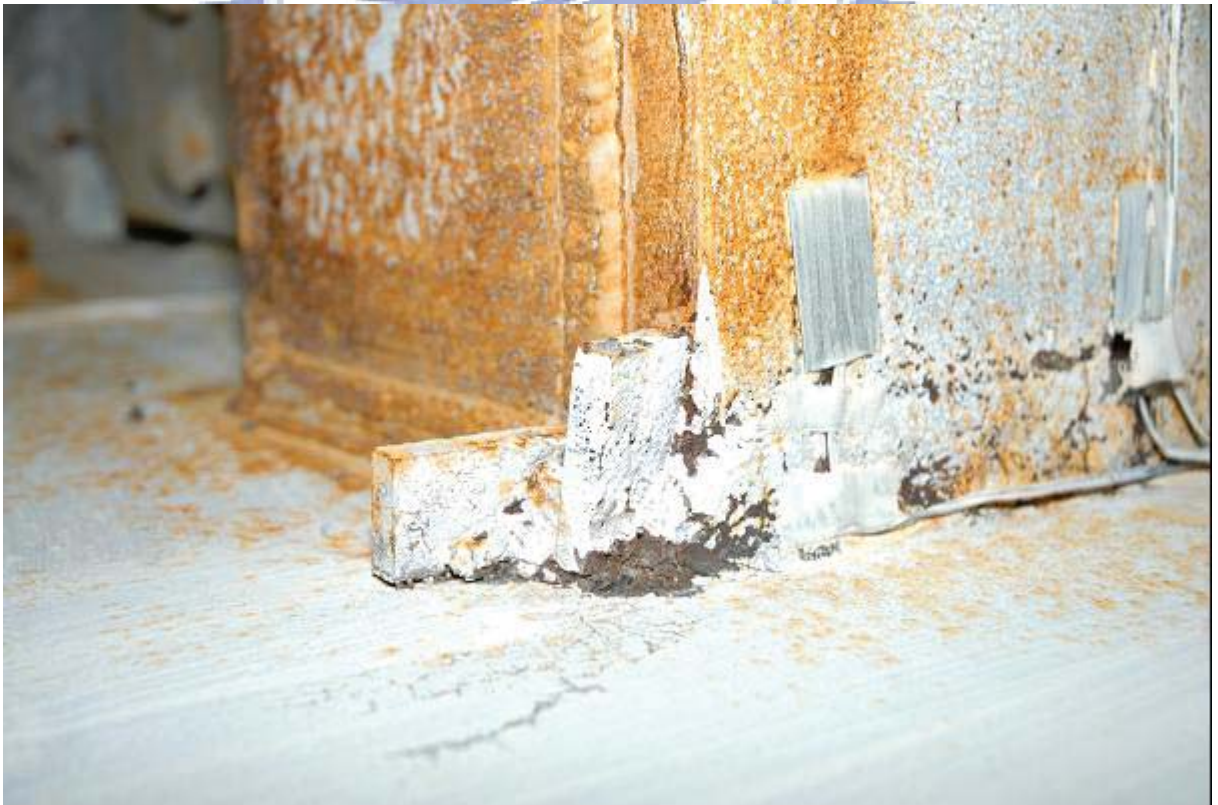
照片 3.18 試體 IFS1 上翼板左側之裂痕 ( \theta = -2.0\% 弧度)
