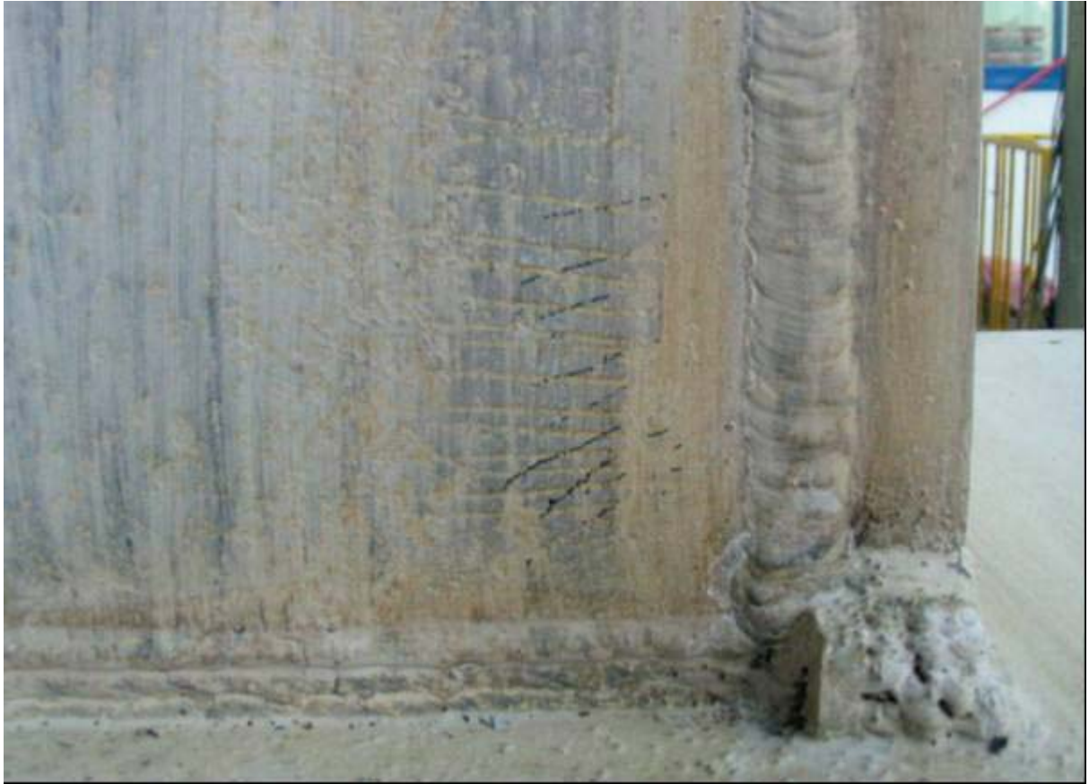
照片 4.21 試體 FDWS2 加勁板降伏範圍擴大之情形 ( \theta=3.0\% 弧度結束)
