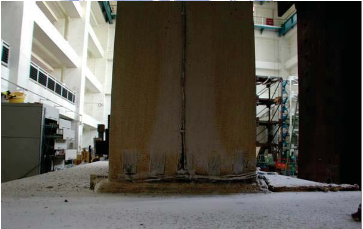
照片 3.32 試體 IFS2 梁上翼焊道無出現降伏現象 ( \theta = -4.8\% 弧度)
