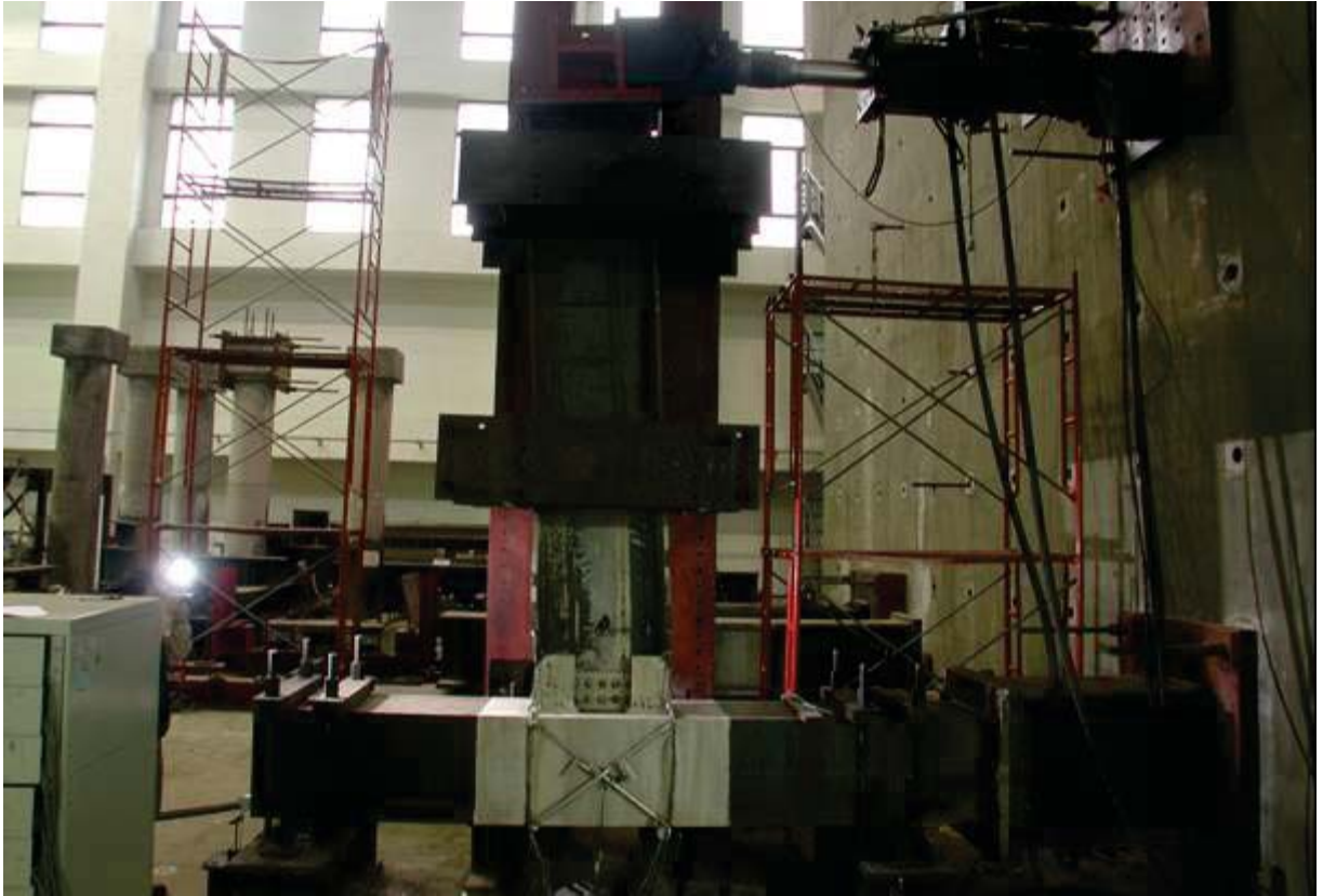
照片 3.59 試體 IFS4 第二次試驗結束前全景 ( \theta = +4.4\% 弧度)
