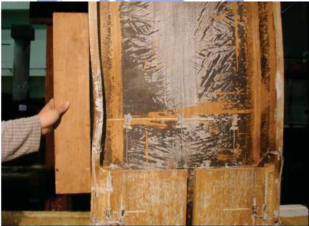
照片 3.82 試體 IFS5 第二次試驗上翼板之挫屈情形
