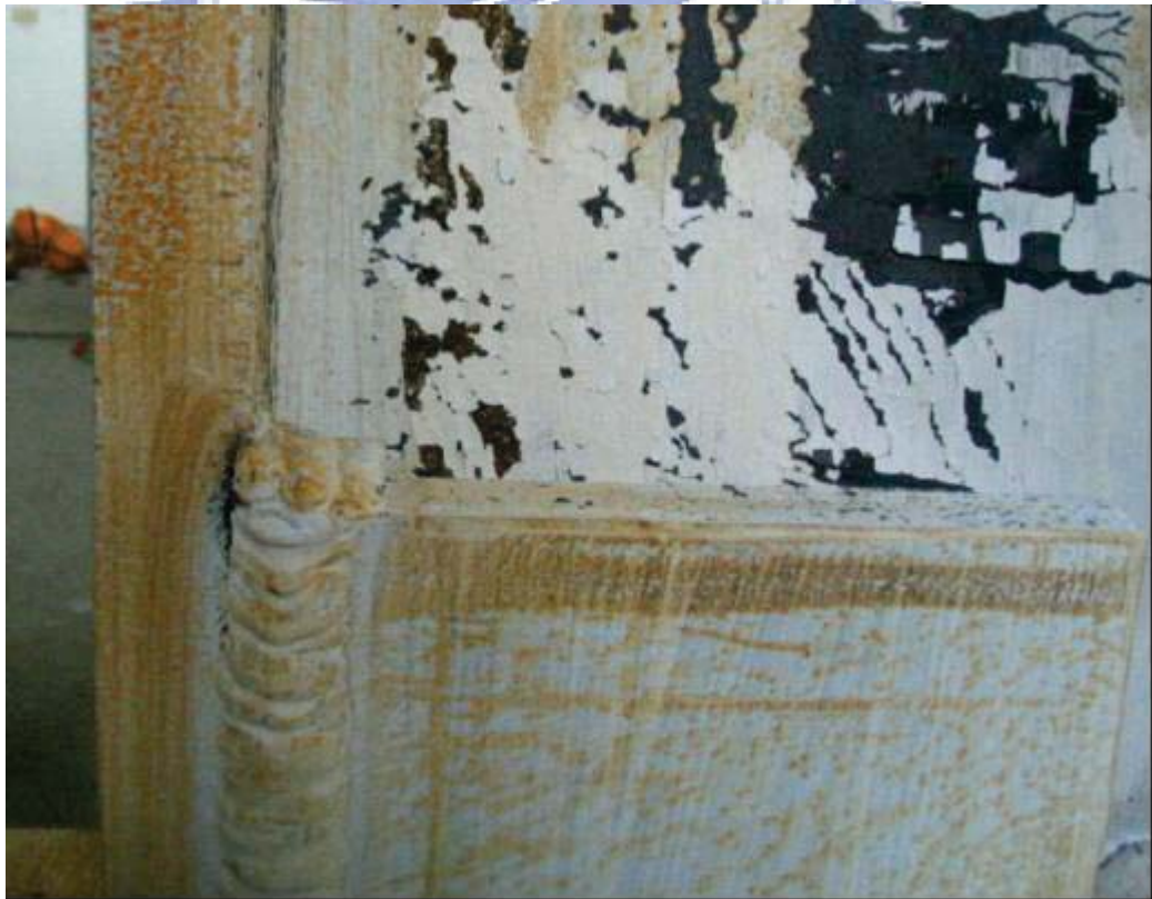
照片 3.38 試體 IFS3 梁下翼板於加勁板端部降伏 ( \theta = +3.0\% 弧度)
