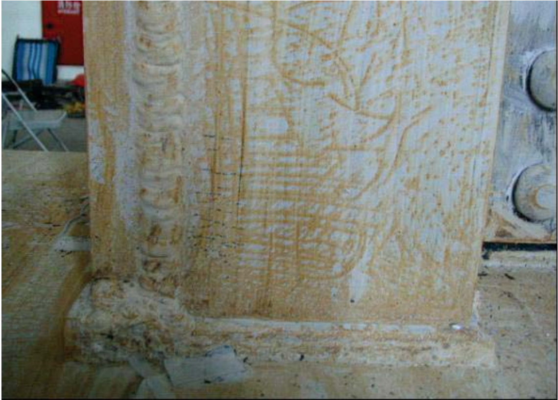
照片 3.37 試體 IFS3 梁下翼加勁板降伏 ( \theta = -3.0\% 弧度)
