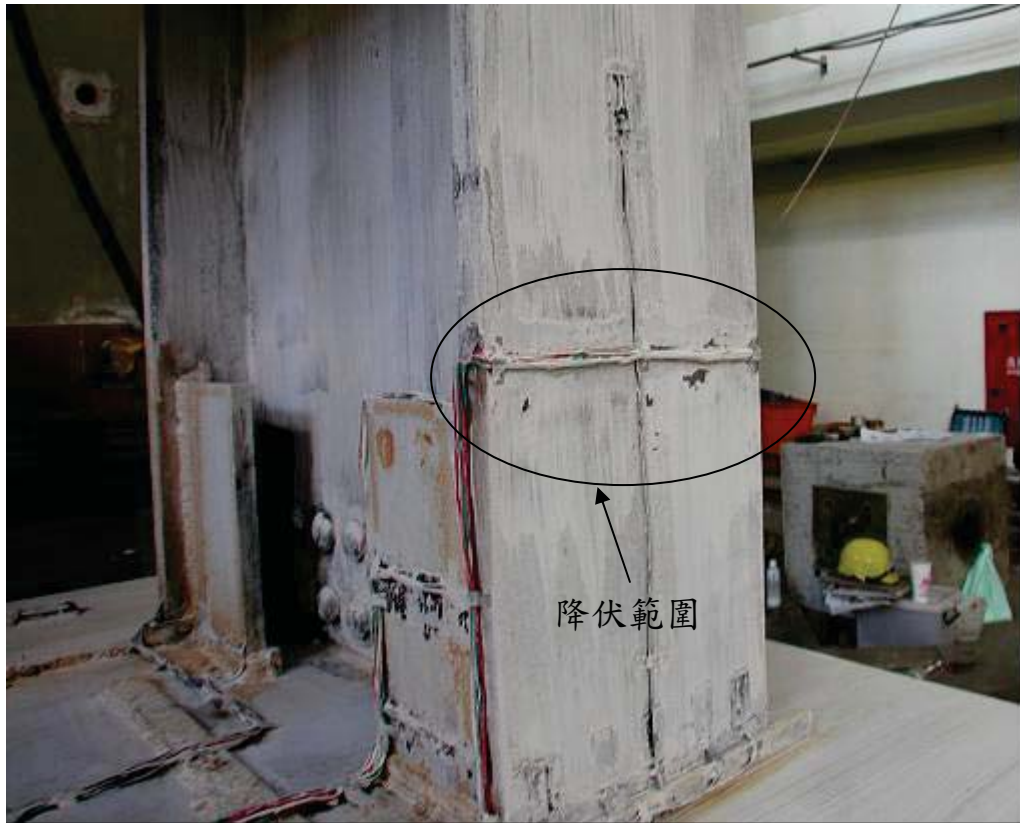
照片 3.27 試體 IFS2 下翼板降伏 ( \theta = +2.0\% 弧度)
