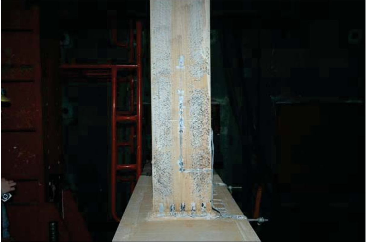
照片 4.39 試體 FDWS3 梁上翼板之降伏情形 ( \theta=1.5\% 弧度結束)
