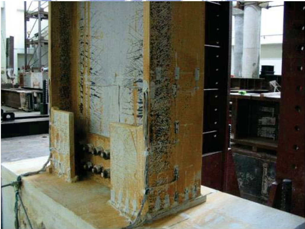
照片 3.36 試體 IFS3 梁上下翼板及腹板大範圍降伏 ( \theta = 2.0\% 弧度結束)
