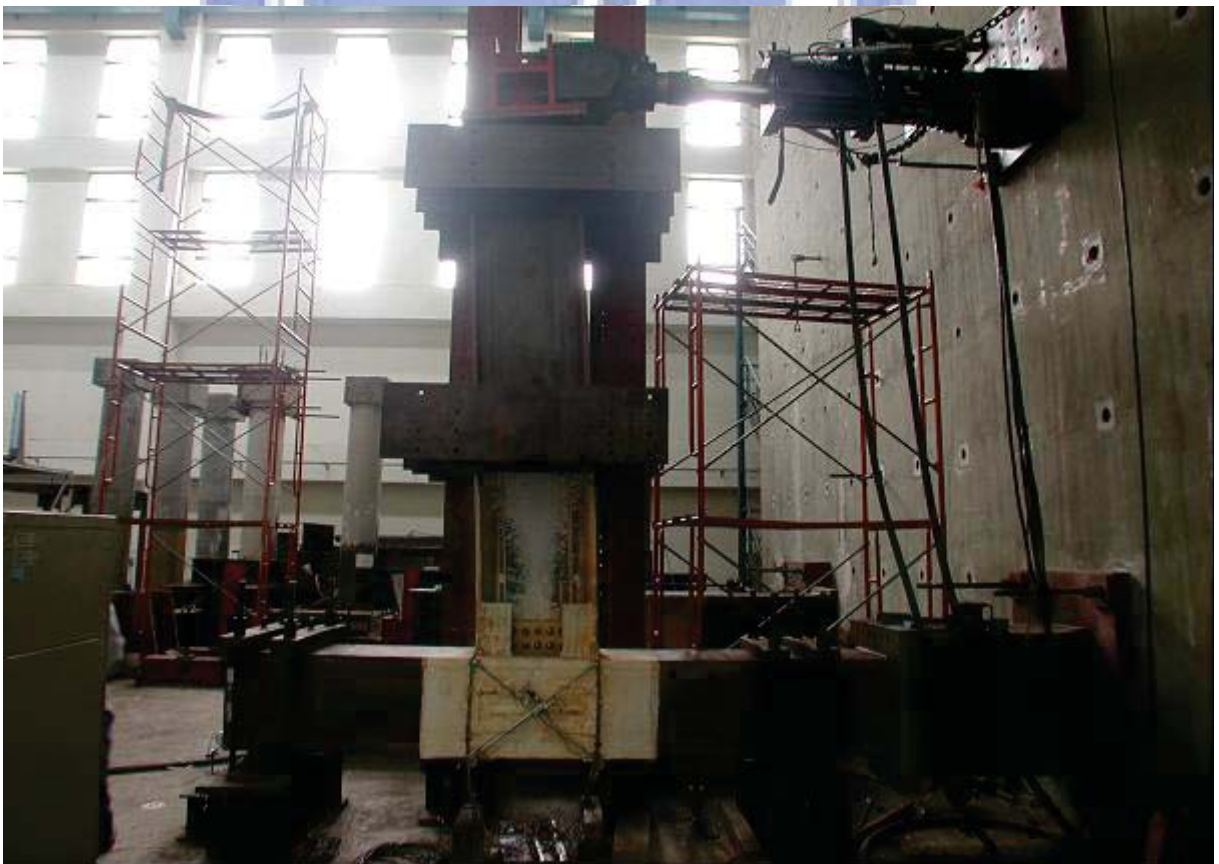
照片 3.40 試體 IFS3 最大位移角之全景。( \theta = +5.0\% 弧度)
