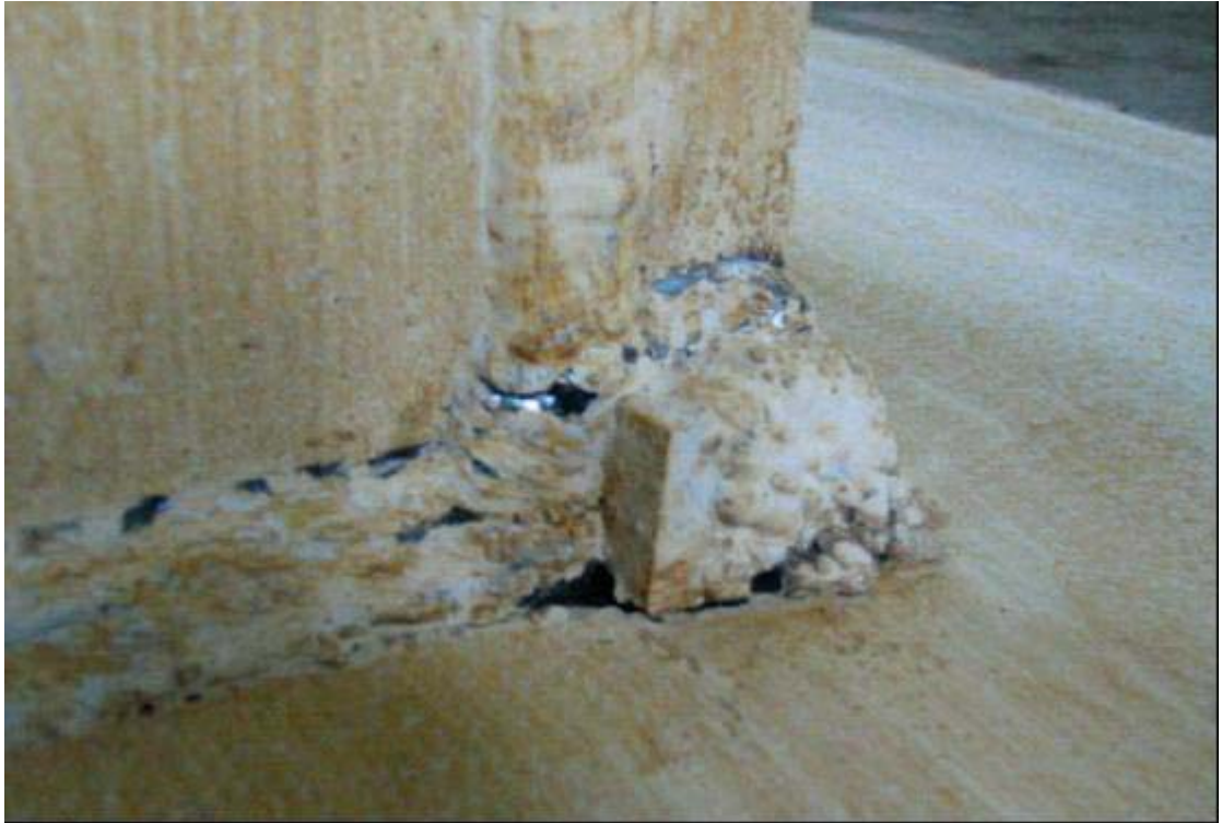
照片 3.39 試體 IFS3 梁上翼背墊板延柱面拉起 ( \theta = -4.0\% 弧度)
