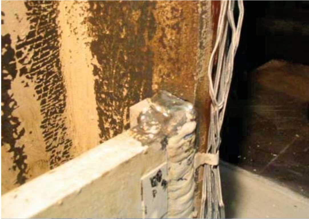
照片 4.29 試體 FDWS2 下翼板於加勁板端部出現裂痕 ( \theta=1.0\% 弧度結束)
