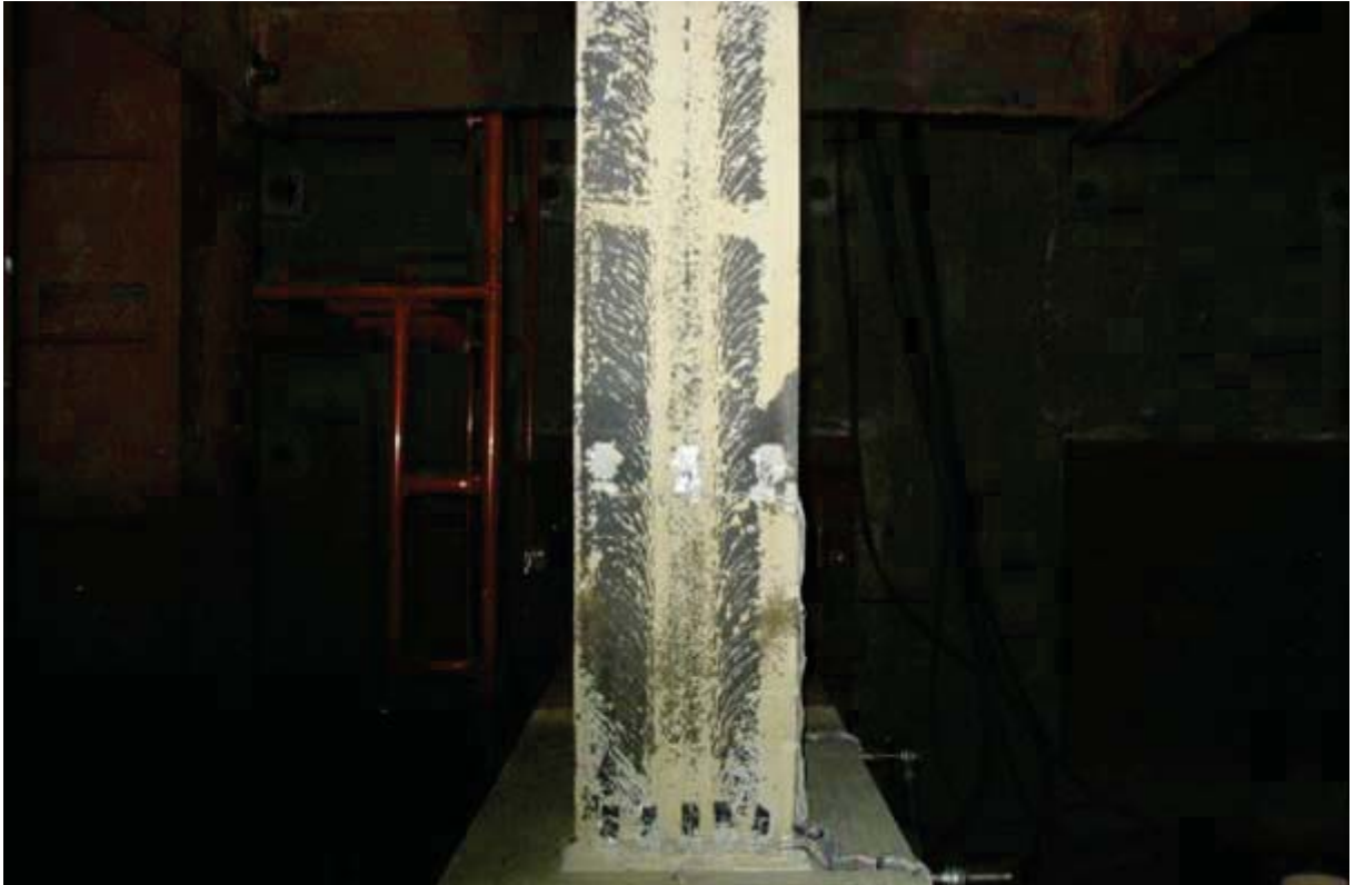
照片 3.47 試體 IFS4 梁上翼板之降伏情形 ( \theta=4.0\% 弧度結束)
