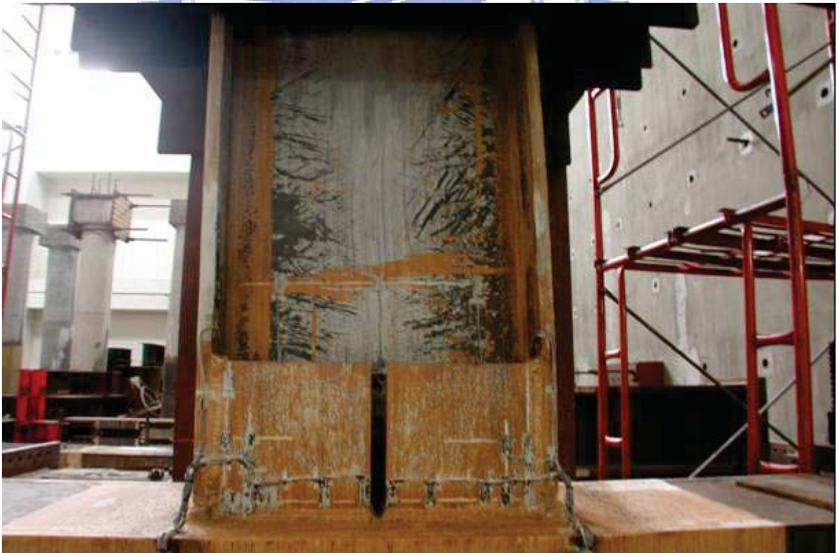
照片 3.68 試體 IFS5 梁腹板之降伏情形 (位移角 \theta=4.0\% 弧度結束)
