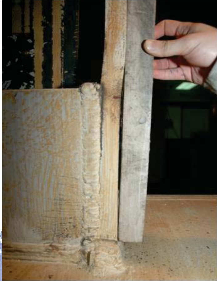
照片 4.57 試體 FDWS3 梁上翼板於加勁板端部挫屈 ( \theta=3.0\% 弧度結束)
