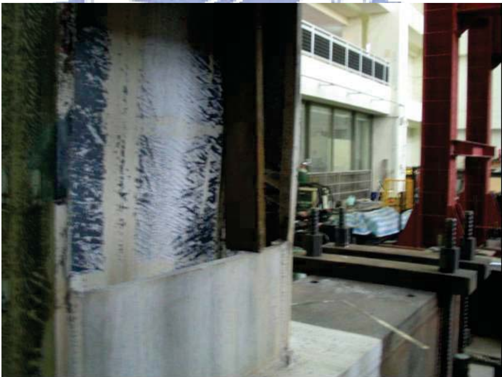
照片 4.24 試體 FDWS2 梁腹板距柱面 600 mm 處挫屈 ( \theta = +4.4\% 弧度)
