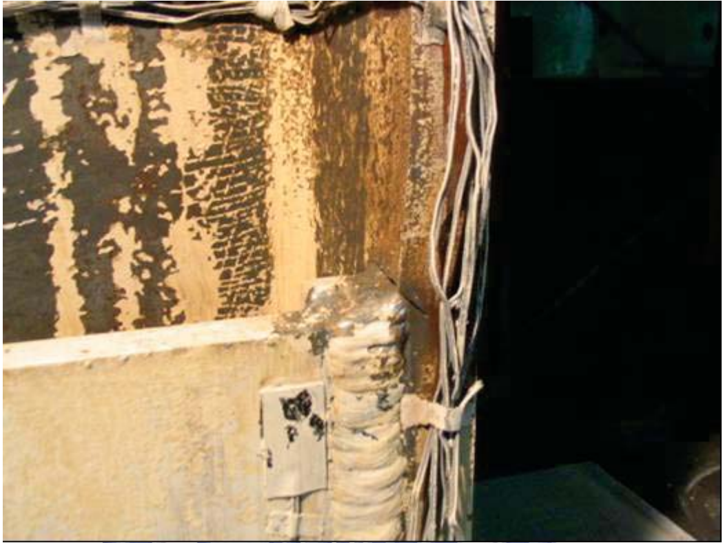
照片 4.31 試體 FDWS2 下翼板於加勁板端部出現裂痕 ( \theta=4.0\% 弧度結束)
