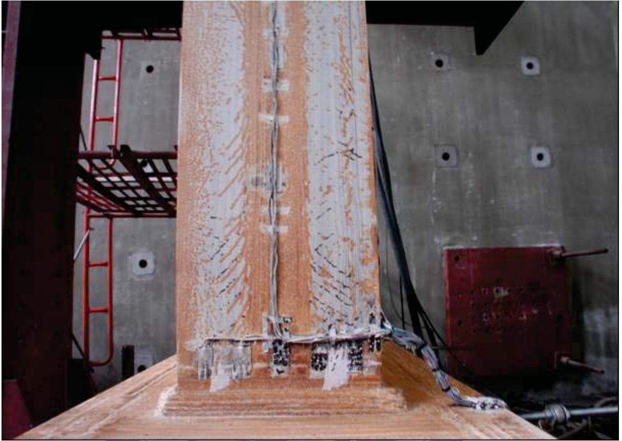
照片 3.61 試體 IFS5 上翼板降伏 ( \theta=0.5\% 弧度結束)
