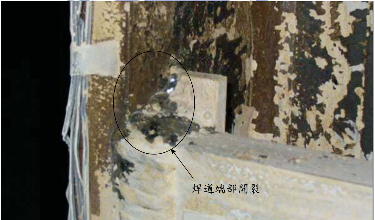
照片 3.50 試體 IFS4 下翼加勁板與梁接之焊道端部開裂 ( \theta=-4.4\% 弧度)
