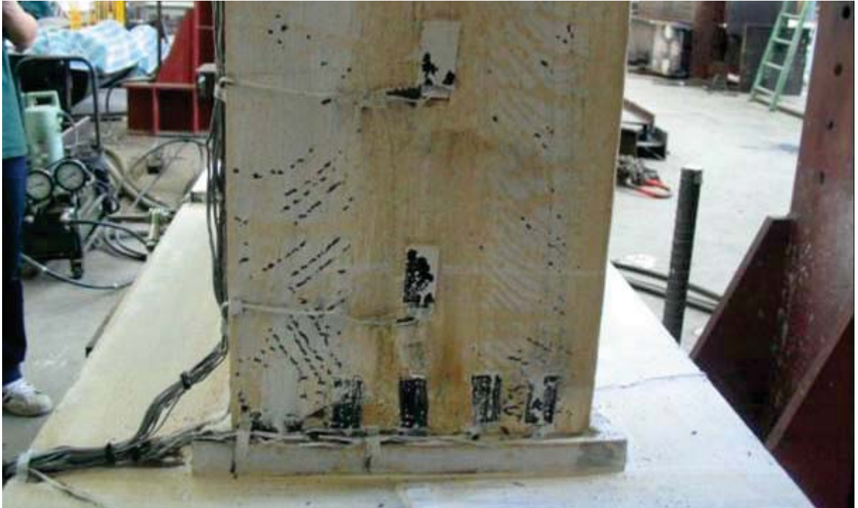
照片 4.15 試體 FDWS2 梁下翼板降伏 ( \theta=0.75\% 弧度結束)
