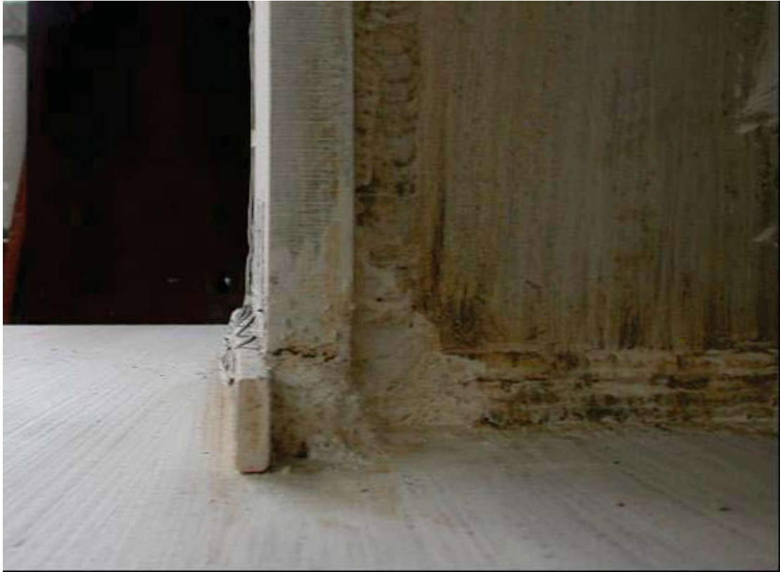
照片 3.29 試體 IFS2 梁柱接頭焊接處梁翼出現降伏 ( \theta = +2.0\% 弧度)
