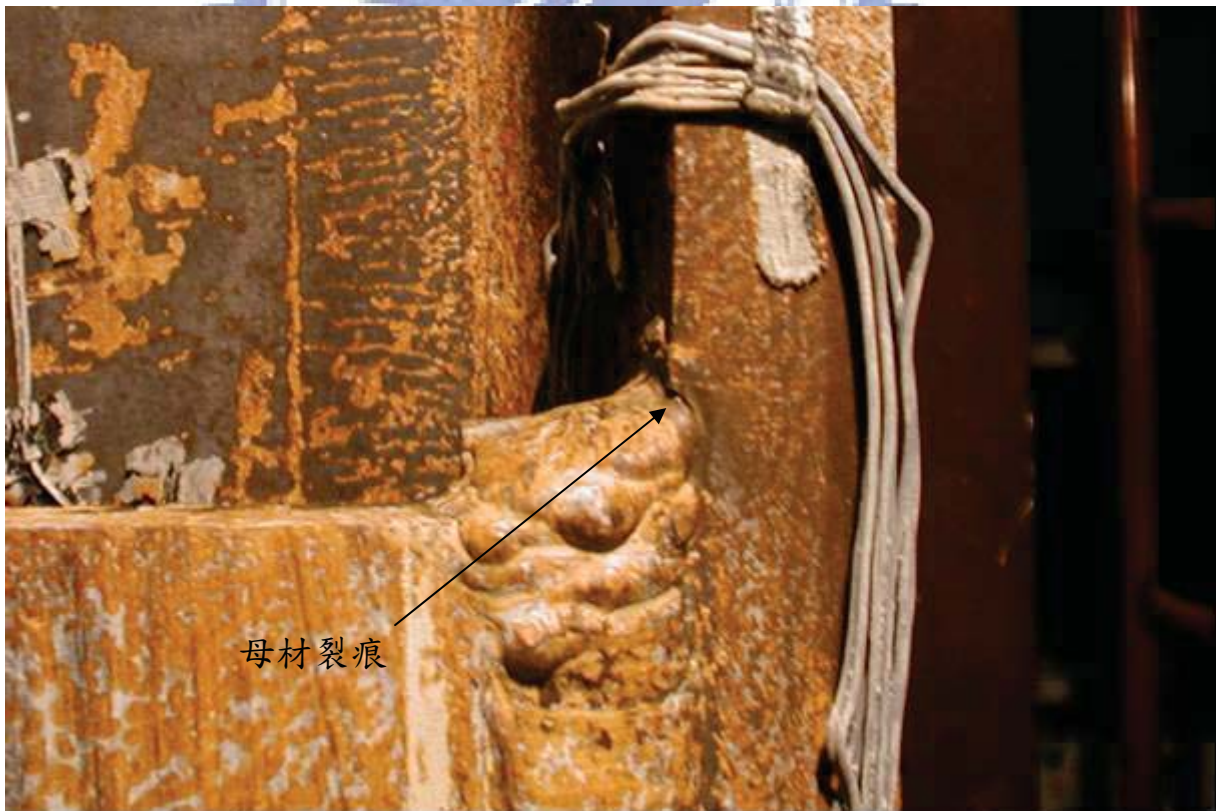
照片 3.78 試體 IFS5 下翼加勁板上方母材裂痕 (位移角 \theta=2.0\% 弧度結束)
