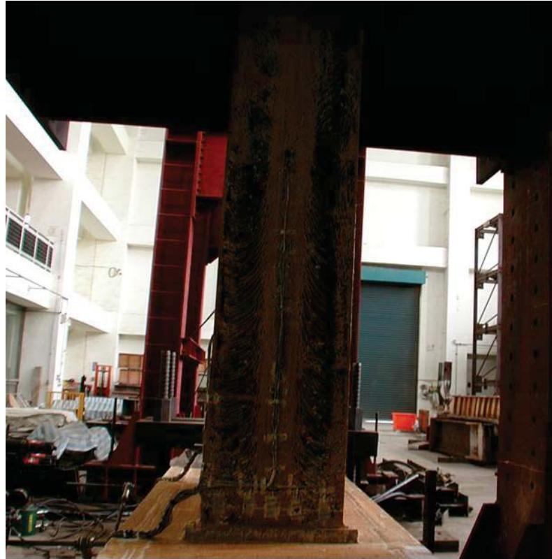
照片 3.67 試體 IFS5 梁下翼板之降伏情形 (位移角 \theta=4.0\% 弧度結束)
