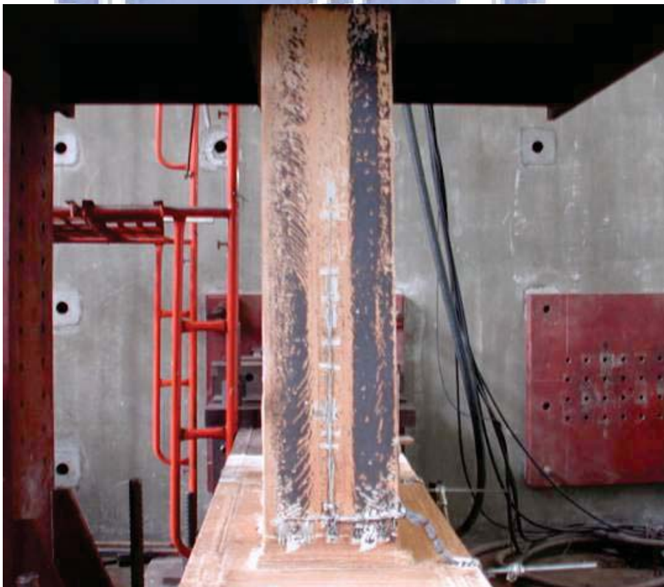
照片 3.66 試體 IFS5 梁上翼板之降伏情形 (位移角 \theta=4.0\% 弧度結束)
