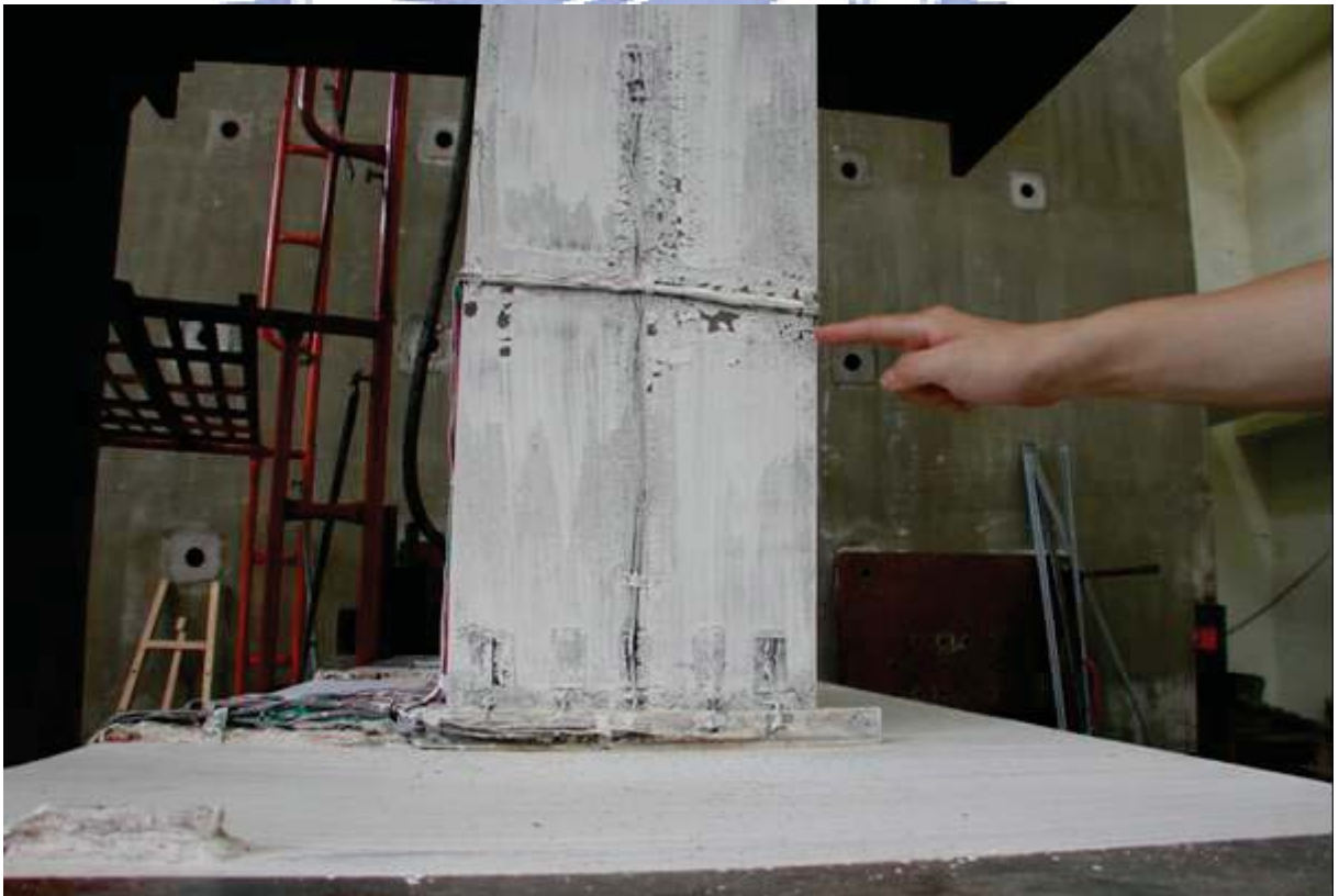
照片 3.30 試體 IFS2 由柱面起算 470 mm 降伏擴大 ( \theta = -3.0\% 弧度)
