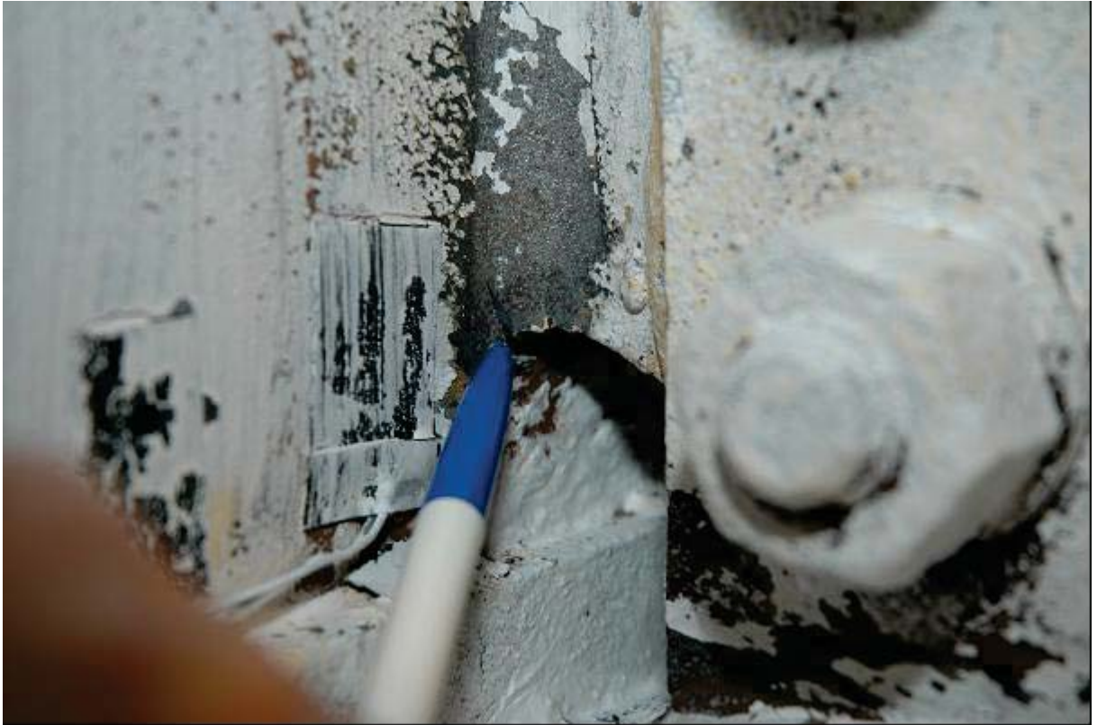
照片 3.9 試體 UR 梁上翼板扇形開口產生裂縫 ( \theta = -3.0\% 弧度第二圈)
