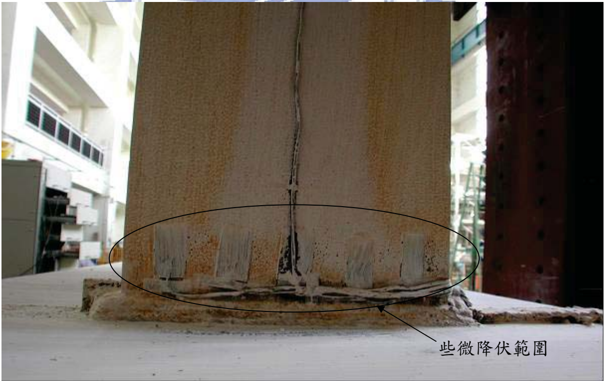
照片 3.26 試體 IFS2 上翼板降伏 ( \theta = -1.0\% 弧度)
