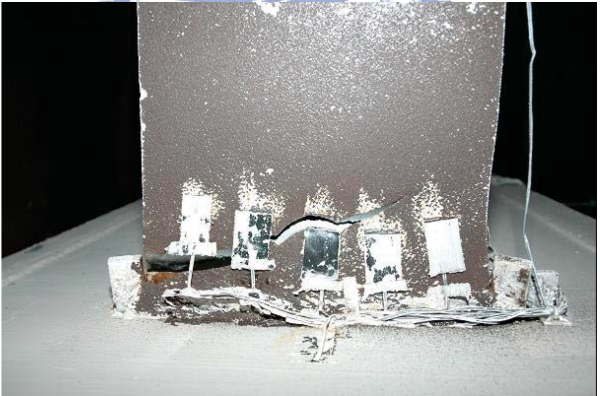
照片 3.10 試體 UR 梁上翼板開裂 ( \theta = -4.0\% 弧度第一圈)
