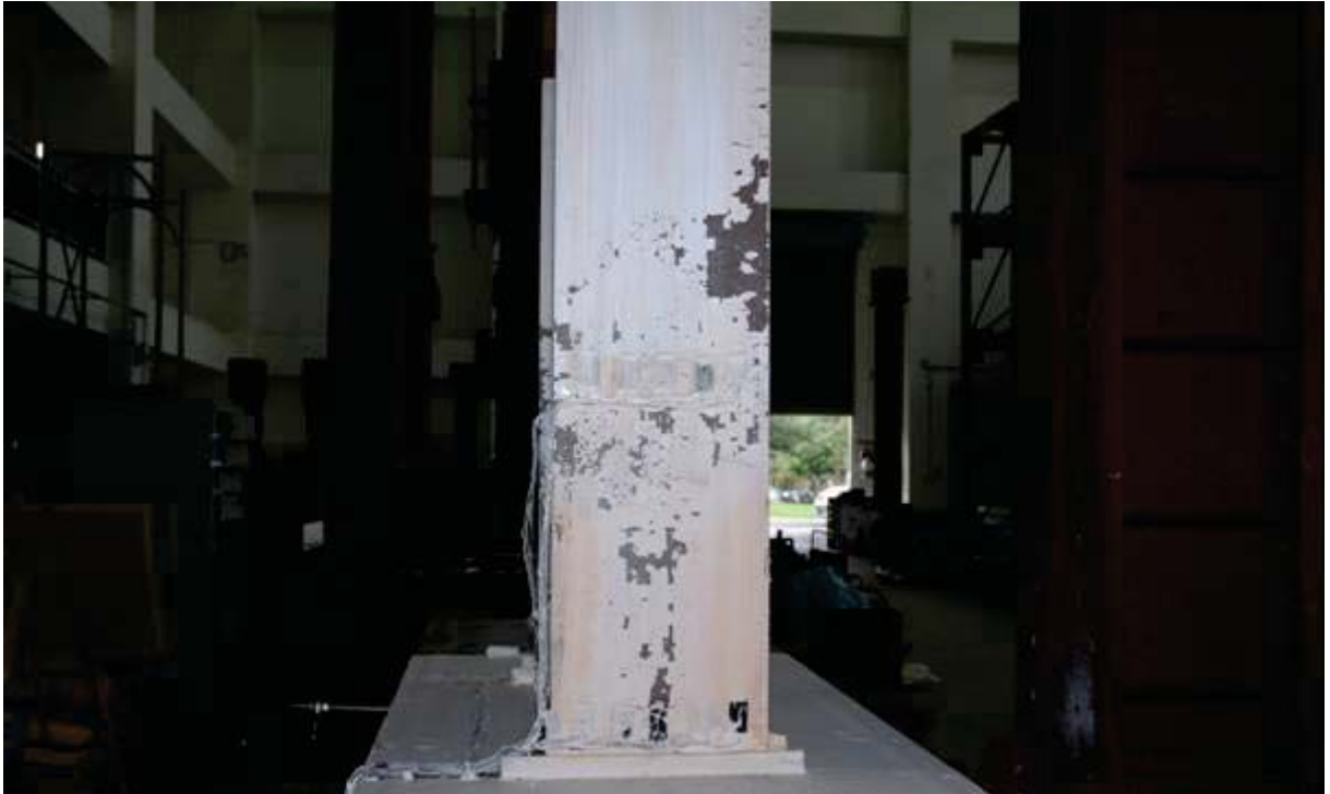
照片 4.5 試體 FDWS1 下翼板降伏擴大 ( \theta = +2.0\% 弧度)
