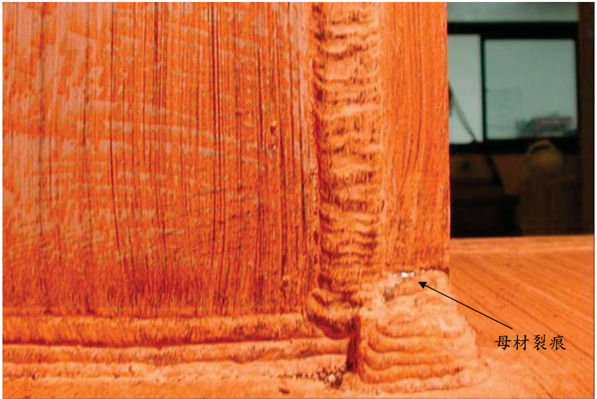
照片 3.77 試體 IFS5 梁上翼焊道上方母材裂痕 (位移角 \theta=2.0\% 弧度結束)
