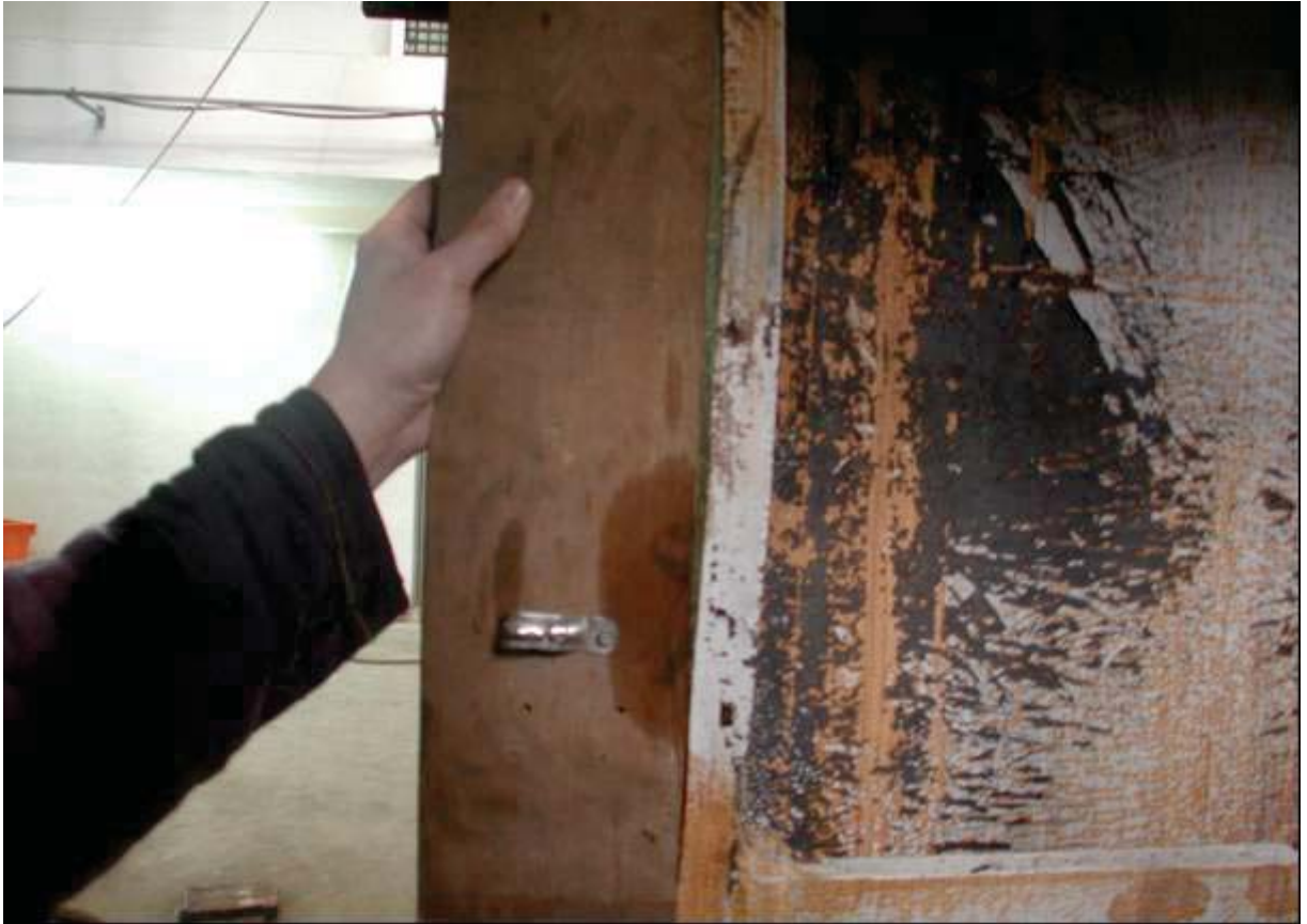
照片 3.75 試體 IFS5 梁下翼板挫屈 6 mm (位移角 \theta = -1.5\% 弧度)
