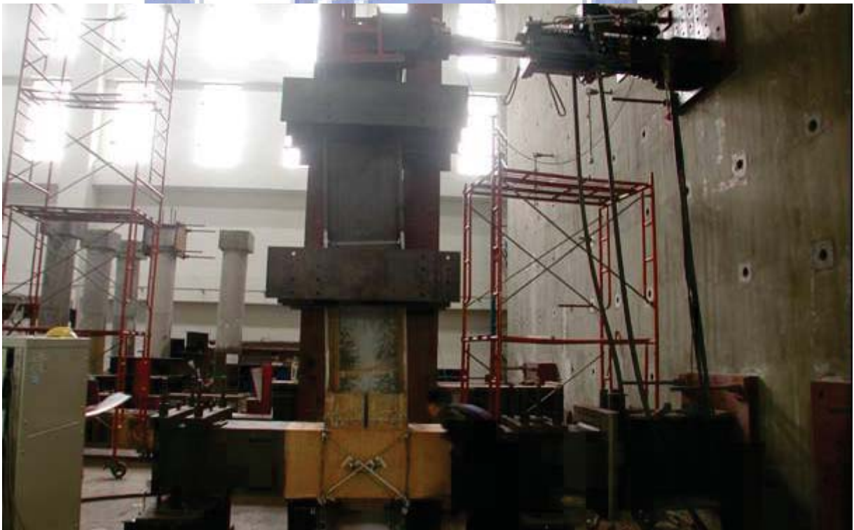
照片 3.72 試體 IFS5 最大位移角之全景 (位移角 \theta = +4.7\% 弧度)
