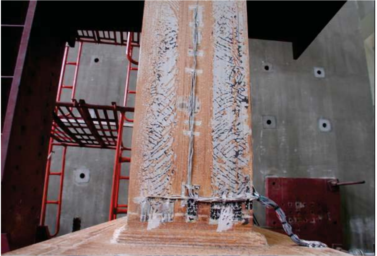
照片 3. 63 試體 IFS5 上翼板降伏 ( \theta=1.0\% 弧度結束)
