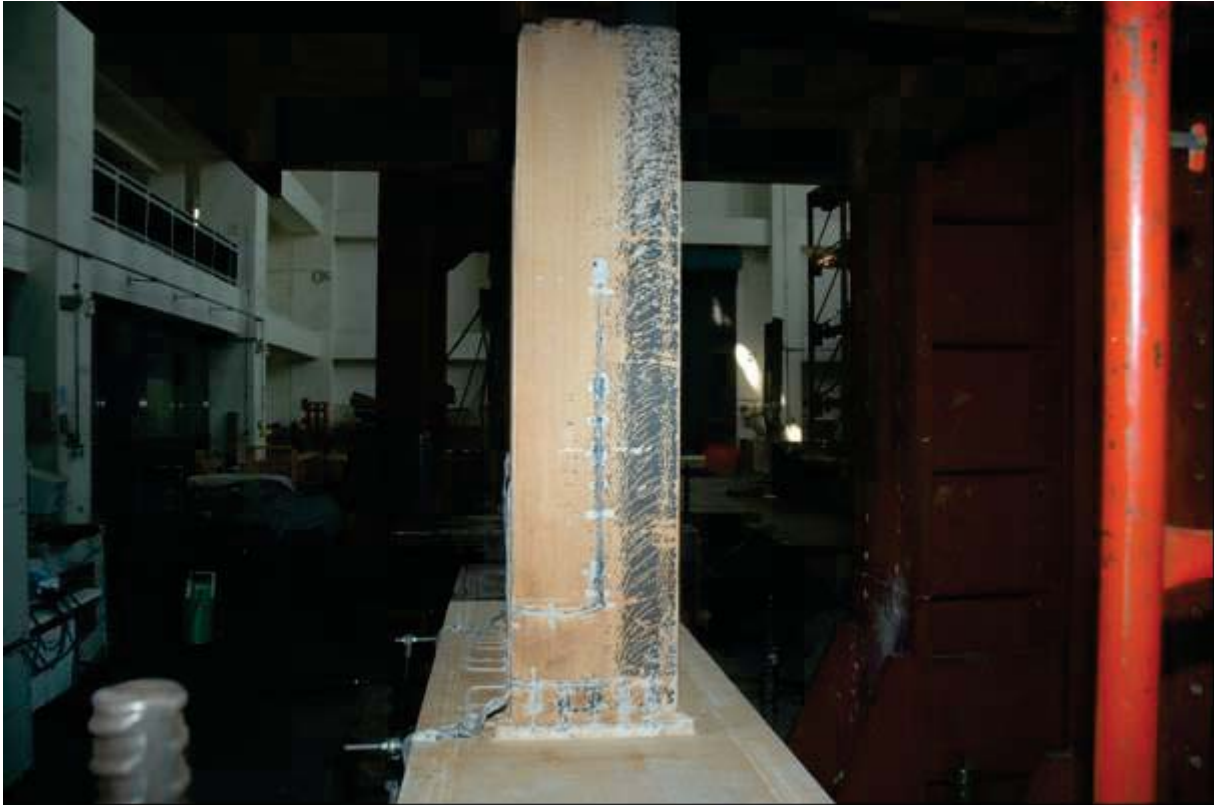
照片 4.45 試體 FDWS3 梁下翼板之降伏情形 ( \theta=4.0\% 弧度結束)
