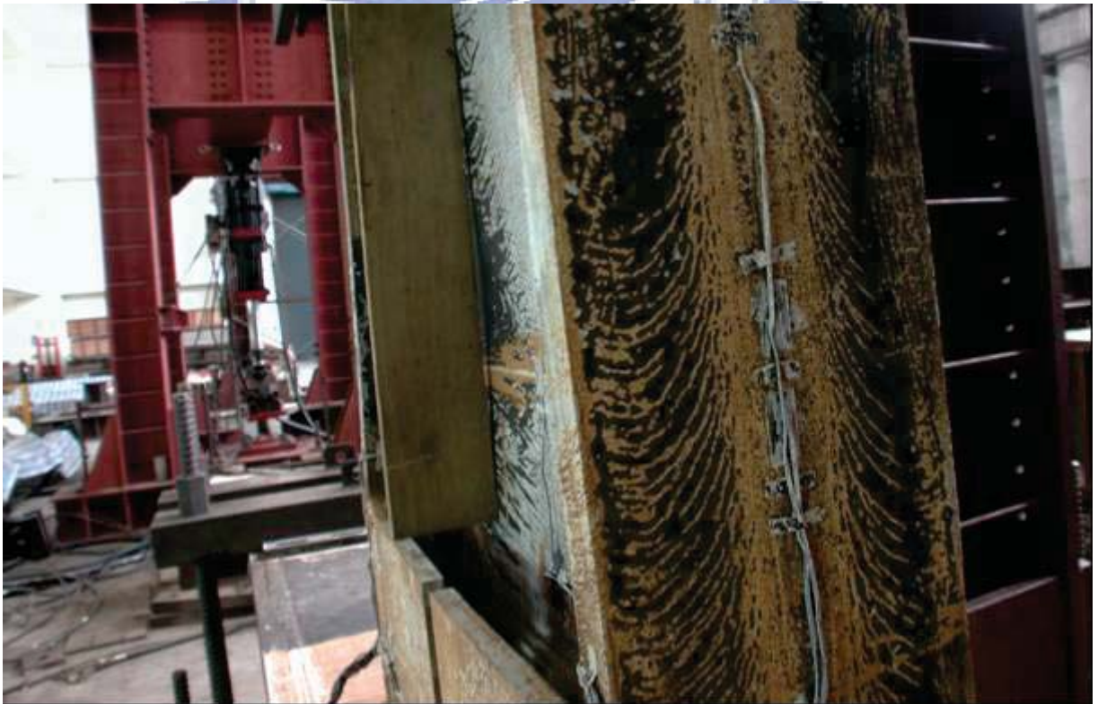
照片 3.74 試體 IFS5 梁下翼之腹板挫屈 12 mm (位移角 \theta = +1.0\% 弧度)
