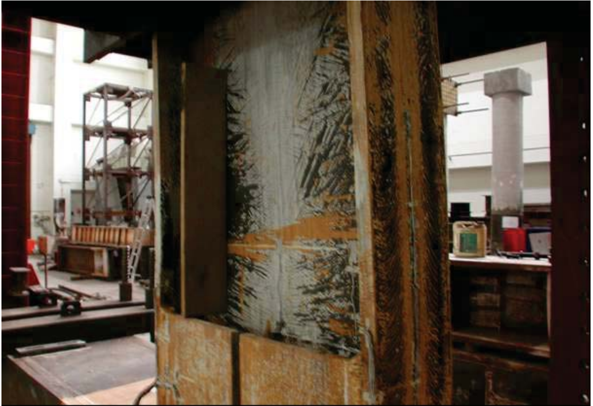
照片 3.71 試體 IFS5 梁上翼腹板挫屈 11 mm (位移角 \theta = +4.7\% 弧度)
