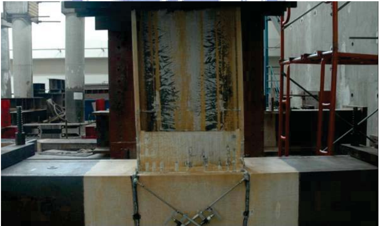
照片 4.46 試體 FDWS3 梁腹板之降伏情形 ( \theta=4.0\% 弧度結束)
