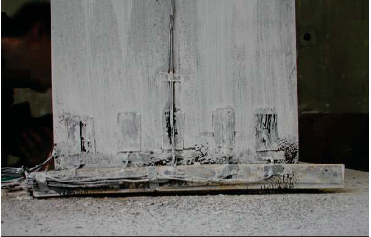
照片 3.31 試體 IFS2 梁下翼板焊道沿柱面將柱表面拉起 ( \theta = +3.0\% 弧度)
