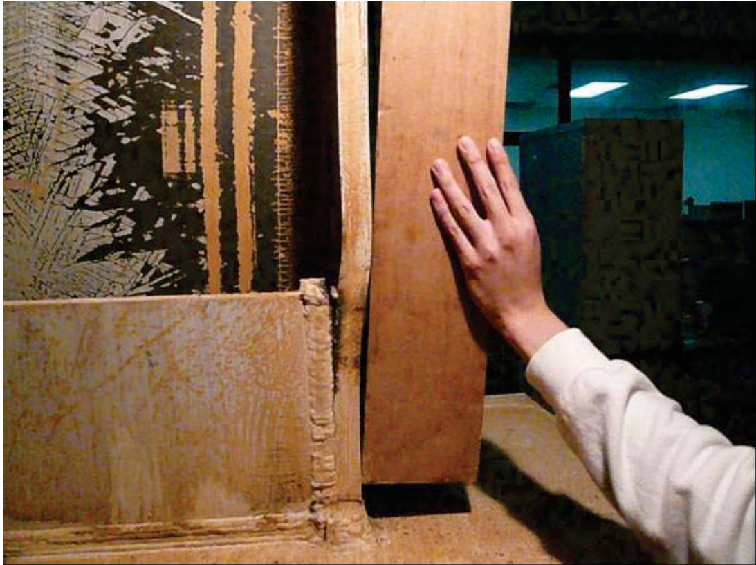
照片 4.59 試體 FDWS3 上翼板於加勁板端部挫屈擴大( \theta=3.77\% 弧度結束)
