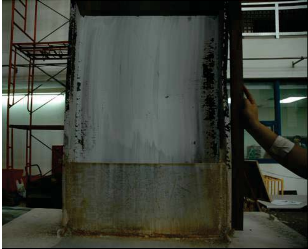
照片 4.7 試體 FDWS1 上翼板局部挫屈擴大 ( \theta = +3.0\% 弧度)
