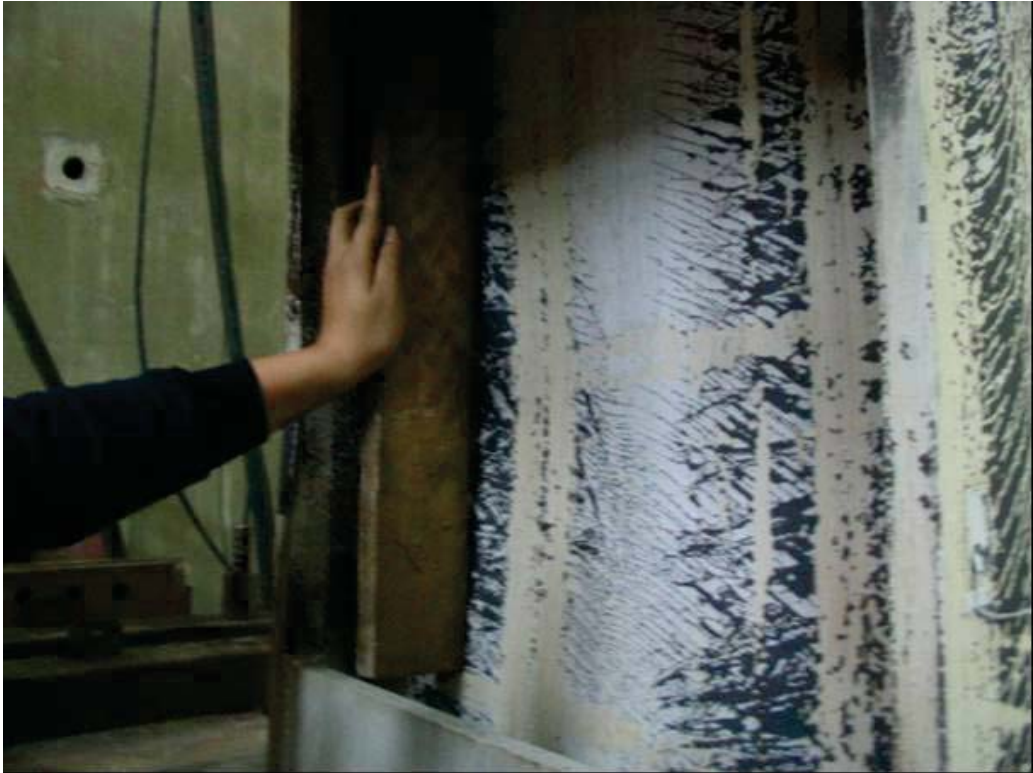
照片 4.23 試體 FDWS2 梁腹板距柱面 600 mm 處挫屈 ( \theta = -4.4\% 弧度)
