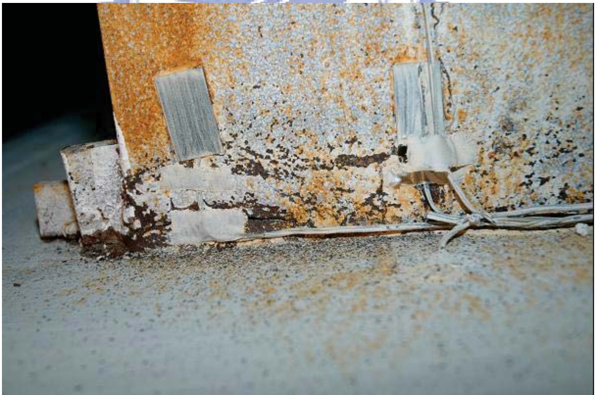
照片 3.20 試體 IFS1 上翼板焊道之裂痕 ( \theta = -3.0\% 弧度)
