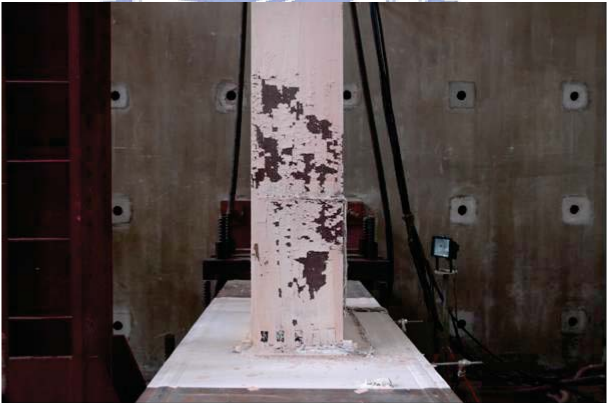
照片 4.4 試體 FDWS1 上翼板降伏擴大 ( \theta=-2.0\% 弧度)
