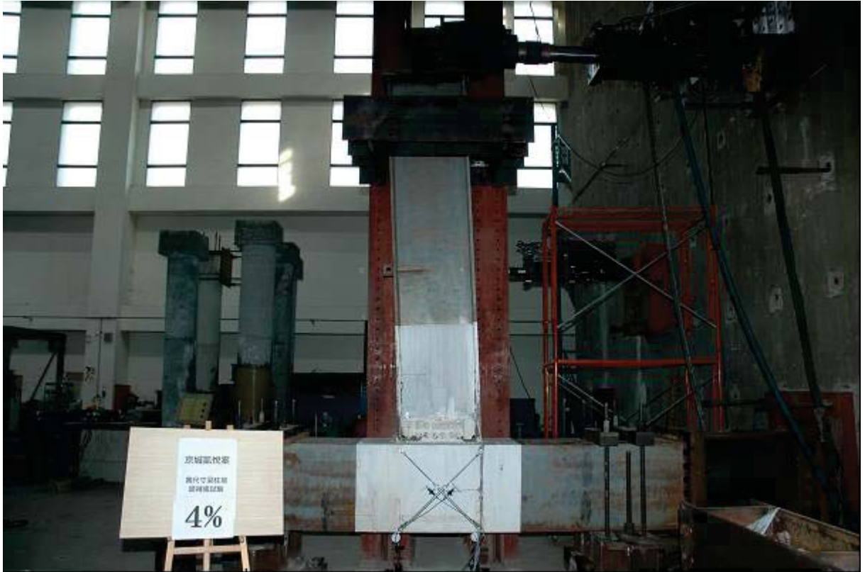
照片 3.13 試體 UR 最大位移角之全景 ( \theta = +4.0\% 弧度)
