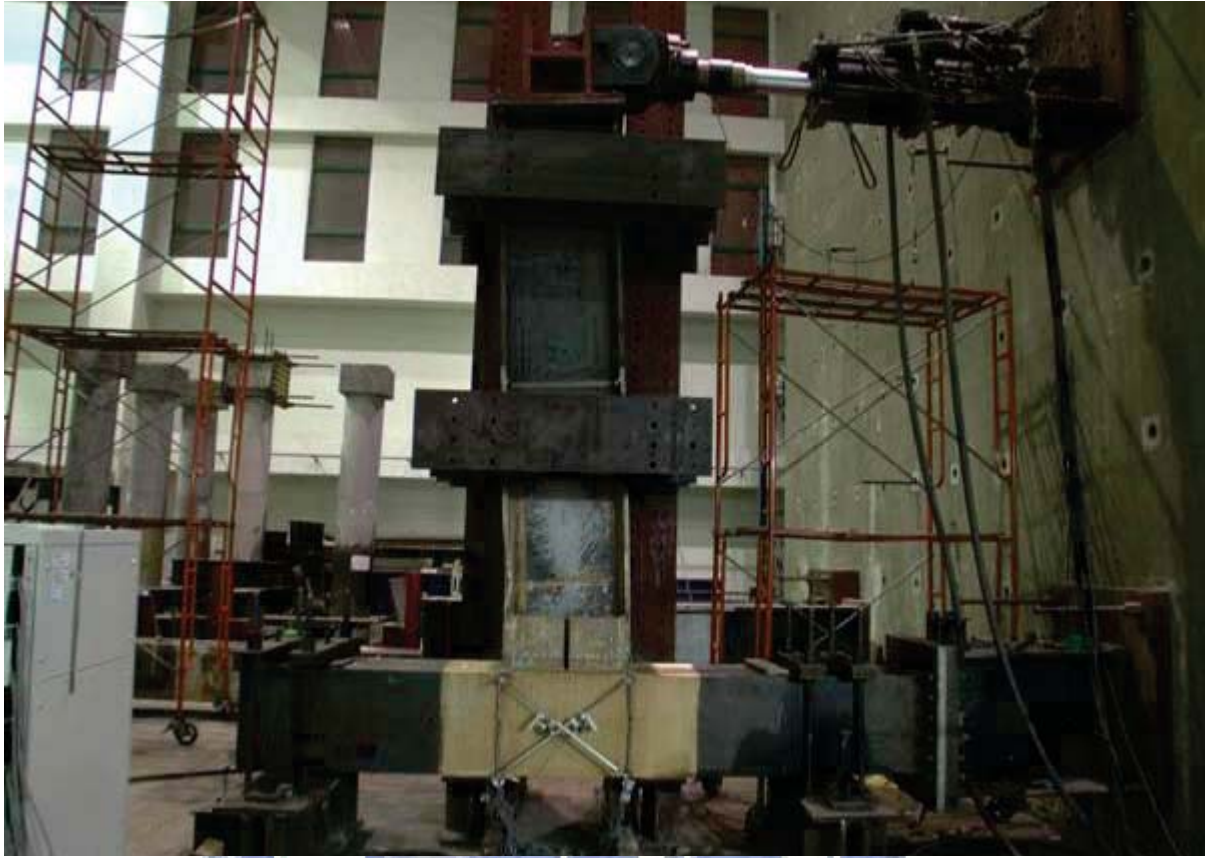
照片 3.81 試體 IFS5 第二次試驗最大位移角全景 (位移角 \theta = +3.6\% 弧度)
