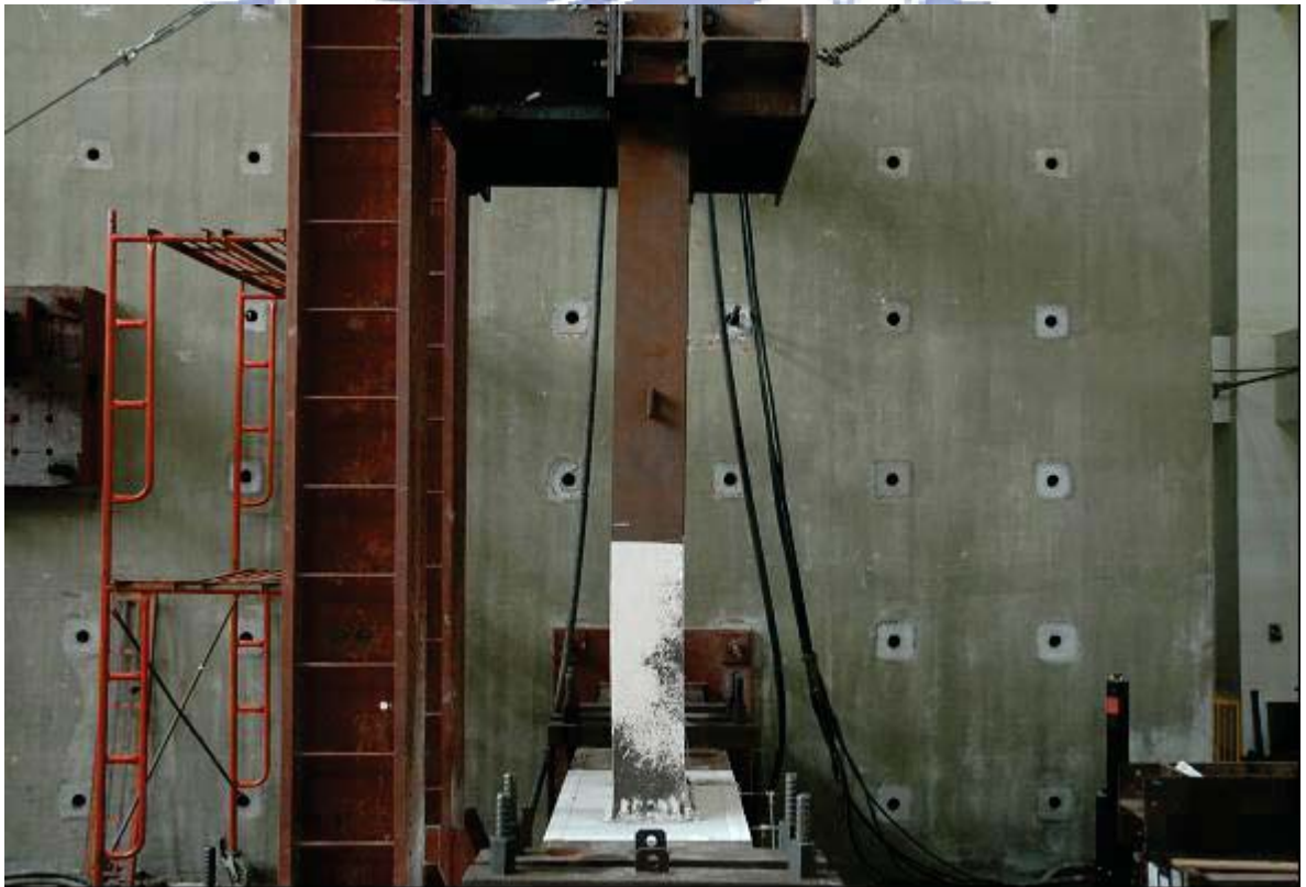
照片 3.8 試體 UR 側撐中心至柱面產生側向扭轉 ( \theta = +3.0\% 弧度第一圈)
