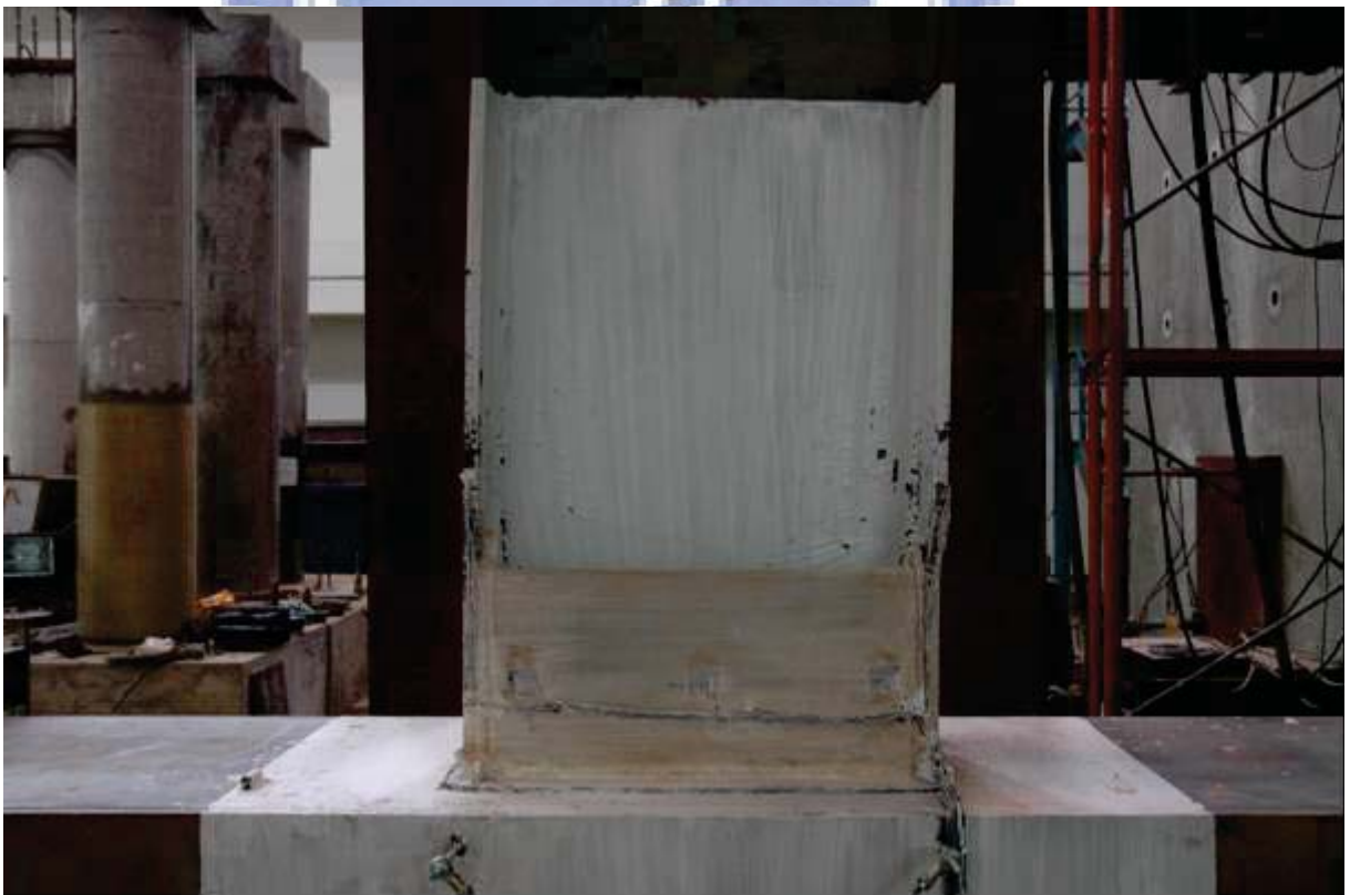
照片 4.6 試體 FDWS1 下翼板局部挫屈 ( \theta = -3.0\% 弧度)
