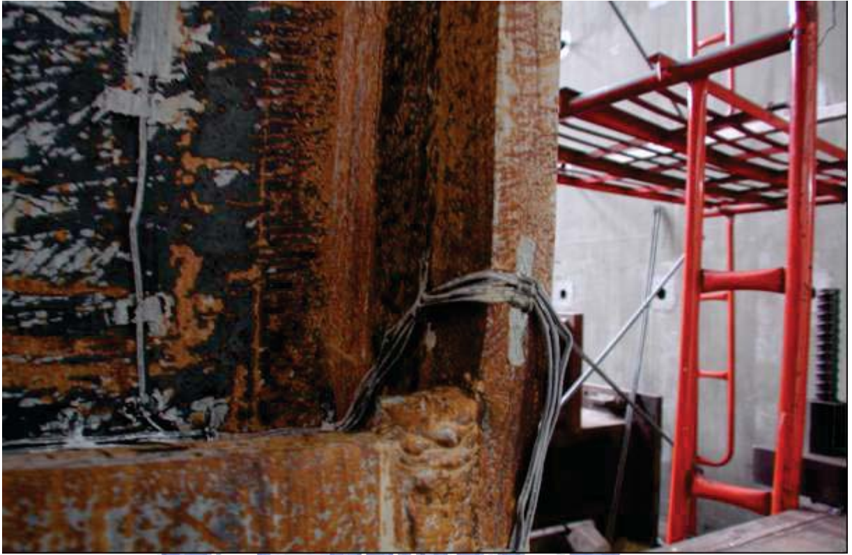
照片 3.69 試體 IFS5 梁下翼板挫屈 8 mm (位移角 \theta = -4.7\% 弧度)
