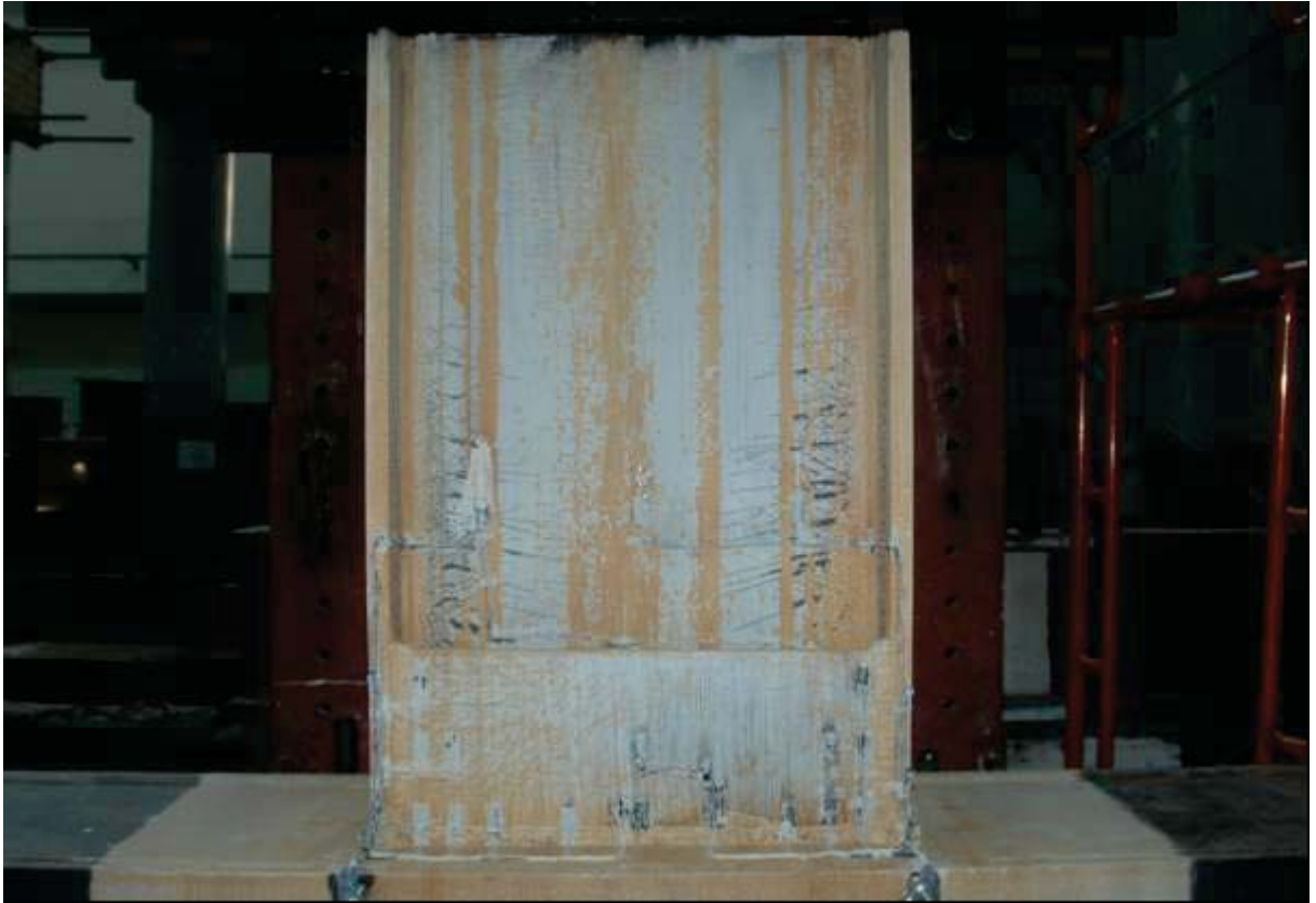
照片 4.41 試體 FDWS3 梁腹板之降伏情形 ( \theta=1.5\% 弧度結束)
