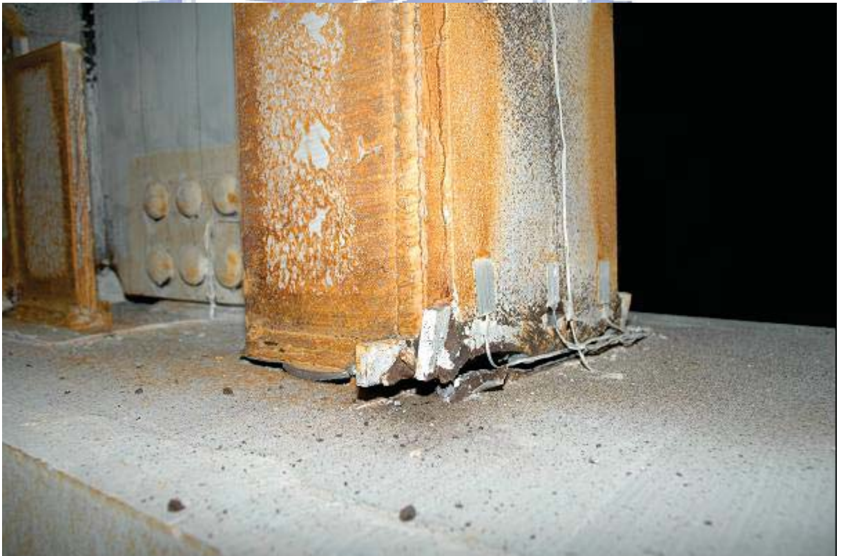
照片 3.22 試體 IFS1 梁上翼板焊道破壞 ( \theta = -3.0\% 弧度第二圈)
