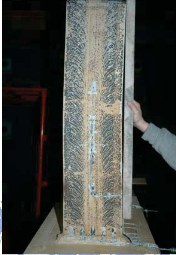
照片 4.49 試體 FDWS3 梁上翼板側向扭轉 9 mm ( \theta=4.8\% 弧度結束)
