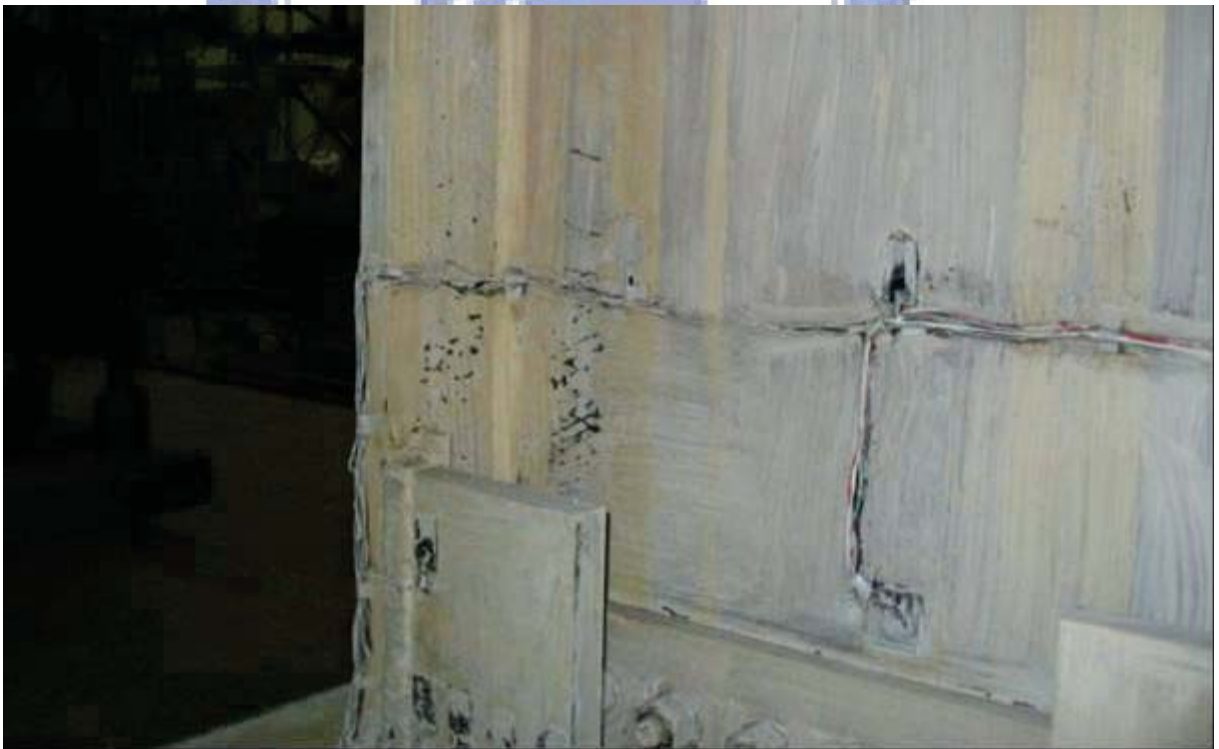
照片 3.44 試體 IFS4 上翼腹板於加勁板端部降伏 ( \theta=1.0\% 弧度結束)
