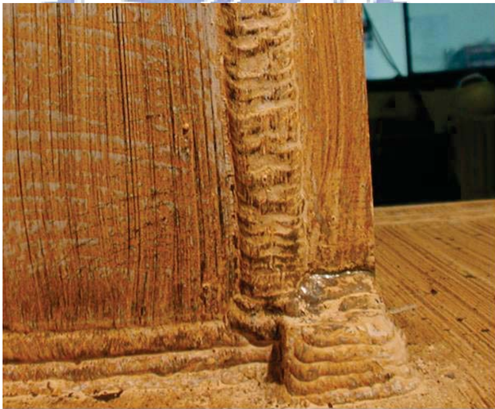
照片 3.80 試體 IFS5 梁上翼焊道上方母材裂痕（位移角 \theta = 3.6\% 弧度結束）
