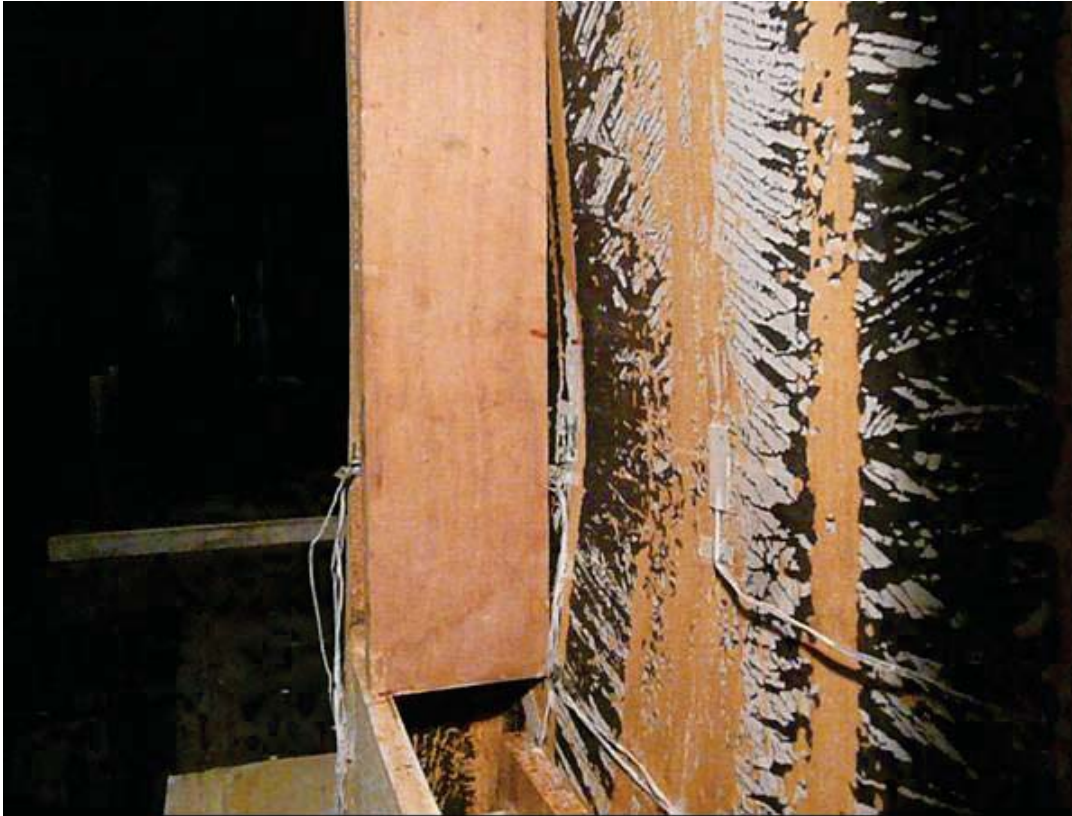
照片 4.61 試體 FDWS3 靠近梁上翼之腹板挫屈 ( \theta=3.77\% 弧度結束)
