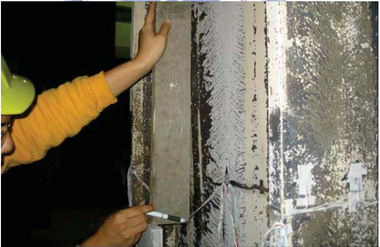
照片 3.52 試體 IFS4 梁上翼之腹板挫屈向外凸 14 mm ( \theta = 4.4\% 弧度結束)
