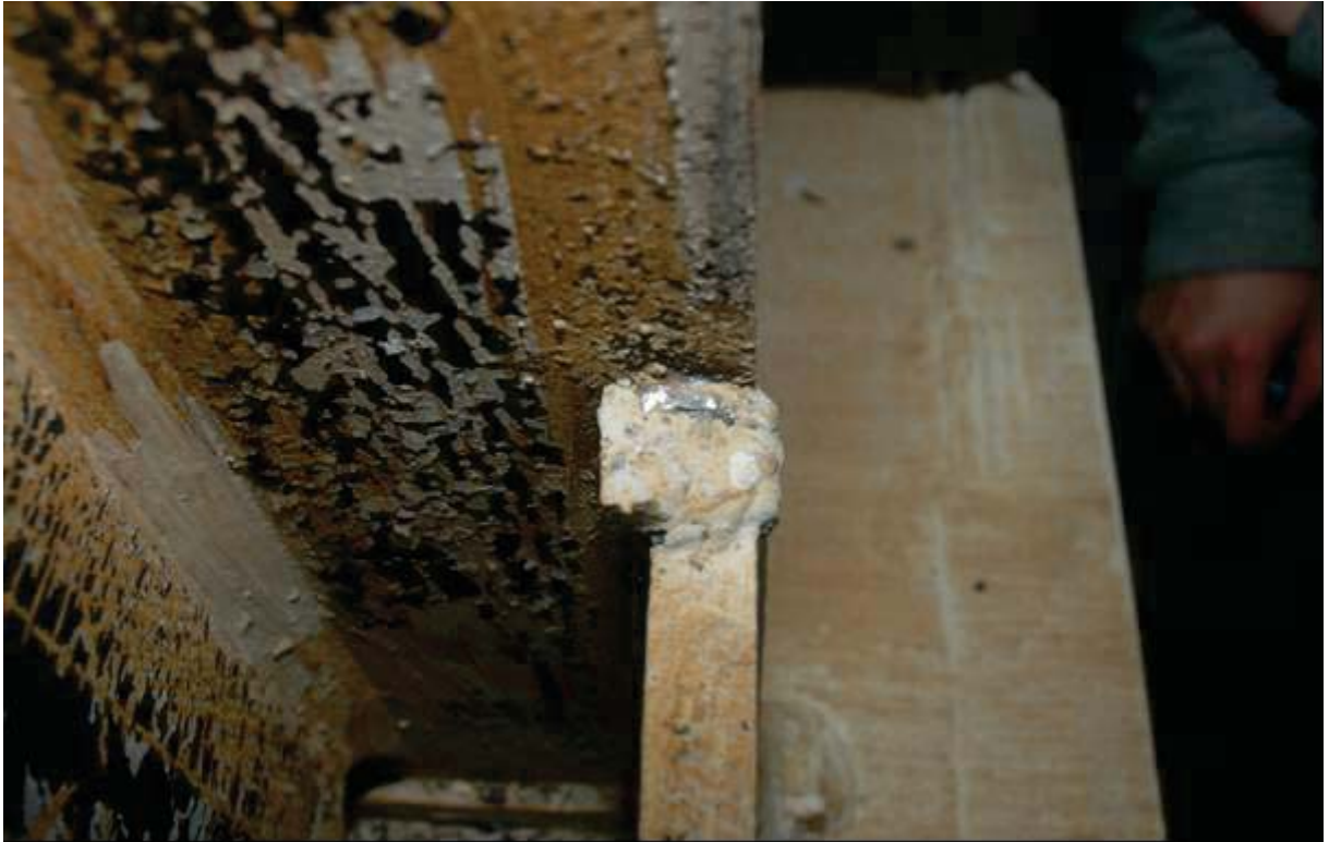
照片 4.43 試體 FDWS3 加勁板與梁接之焊道端部裂痕 ( \theta=4.0\% 弧度結束)
