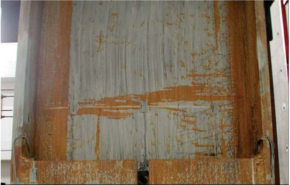
照片 3.65 試體 IFS5 梁腹板於加勁板端部降伏 ( \theta=1.5\% 弧度結束)
