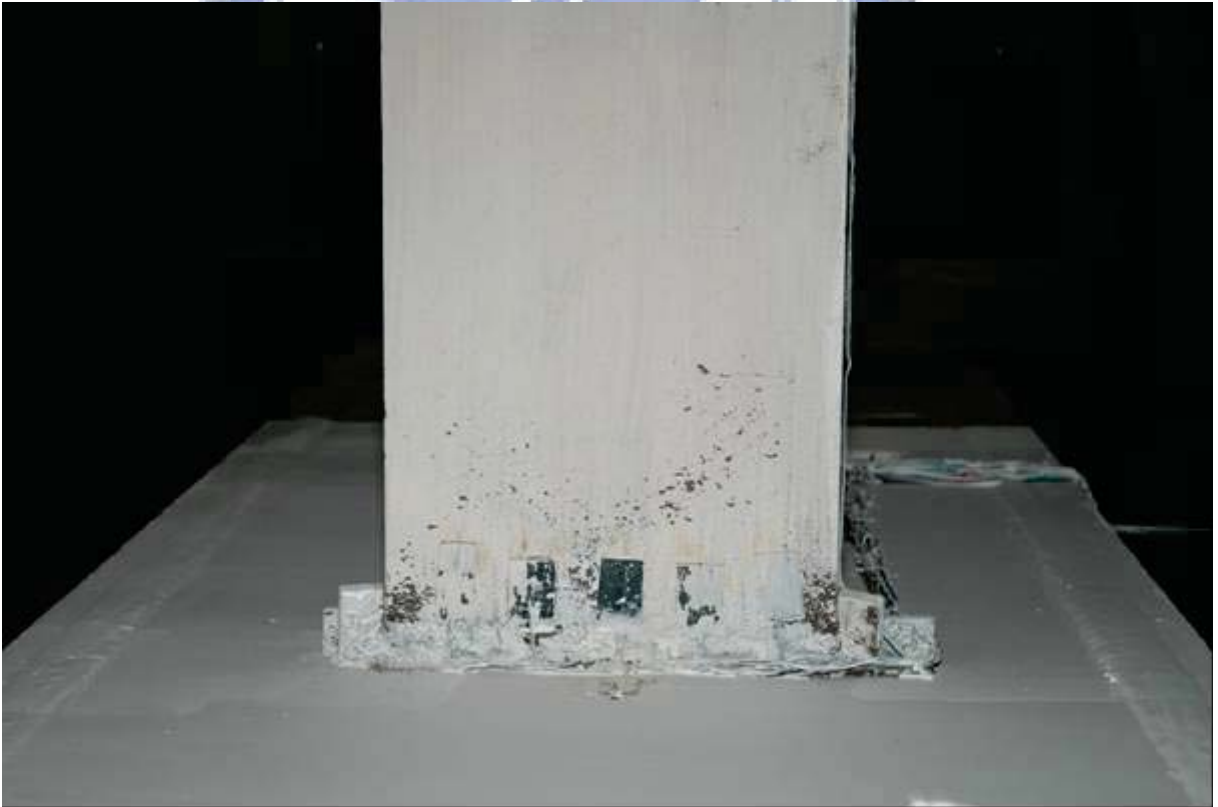
照片 3.2 試體 UR 上翼板降伏 ( \theta = -1.5\% 弧度)
