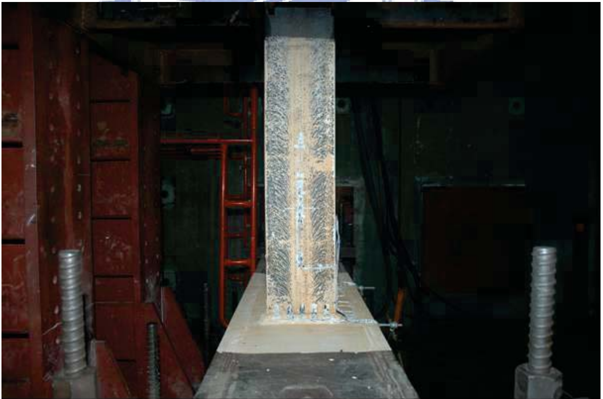
照片 4.44 試體 FDWS3 梁上翼板之降伏情形 ( \theta=4.0\% 弧度結束)
