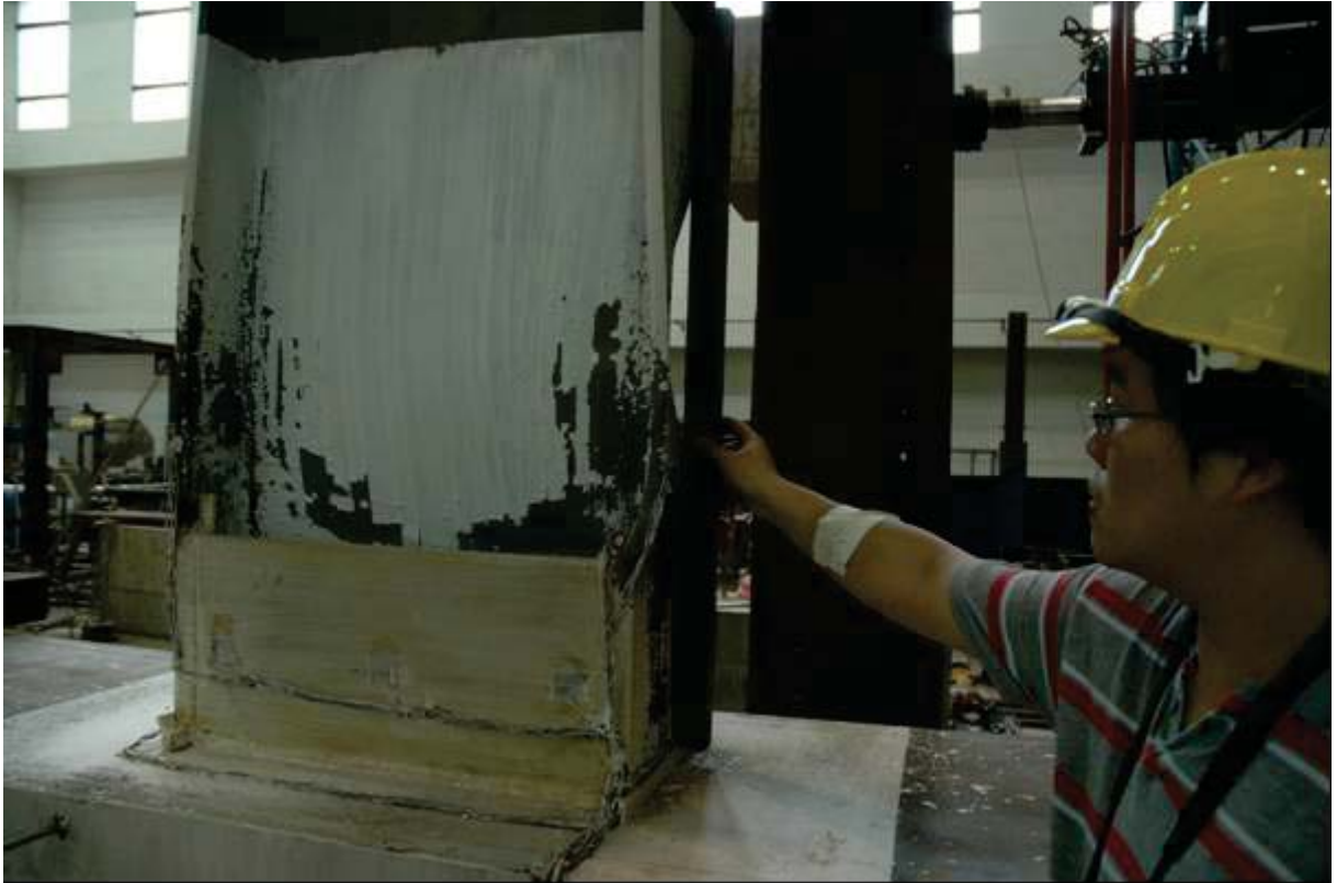
照片 4.9 試體 FDWS1 梁下翼板嚴重挫屈 ( \theta = -4.0\% 弧度)
