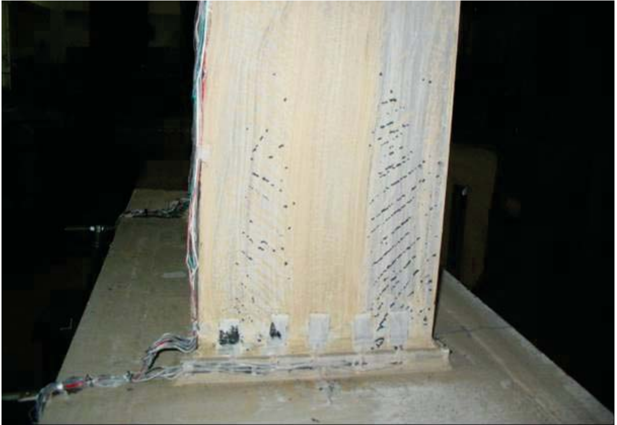
照片 3.43 試體 IFS4 下翼板降伏 ( \theta=0.75\% 弧度結束)
