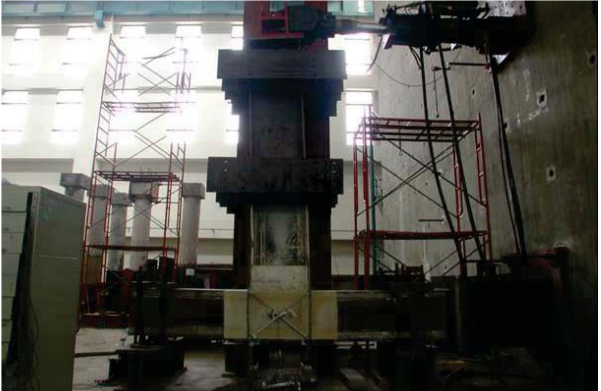
照片 4.27 試體 FDWS2 最大位移角之全景 ( \theta = +4.4\% 弧度)
