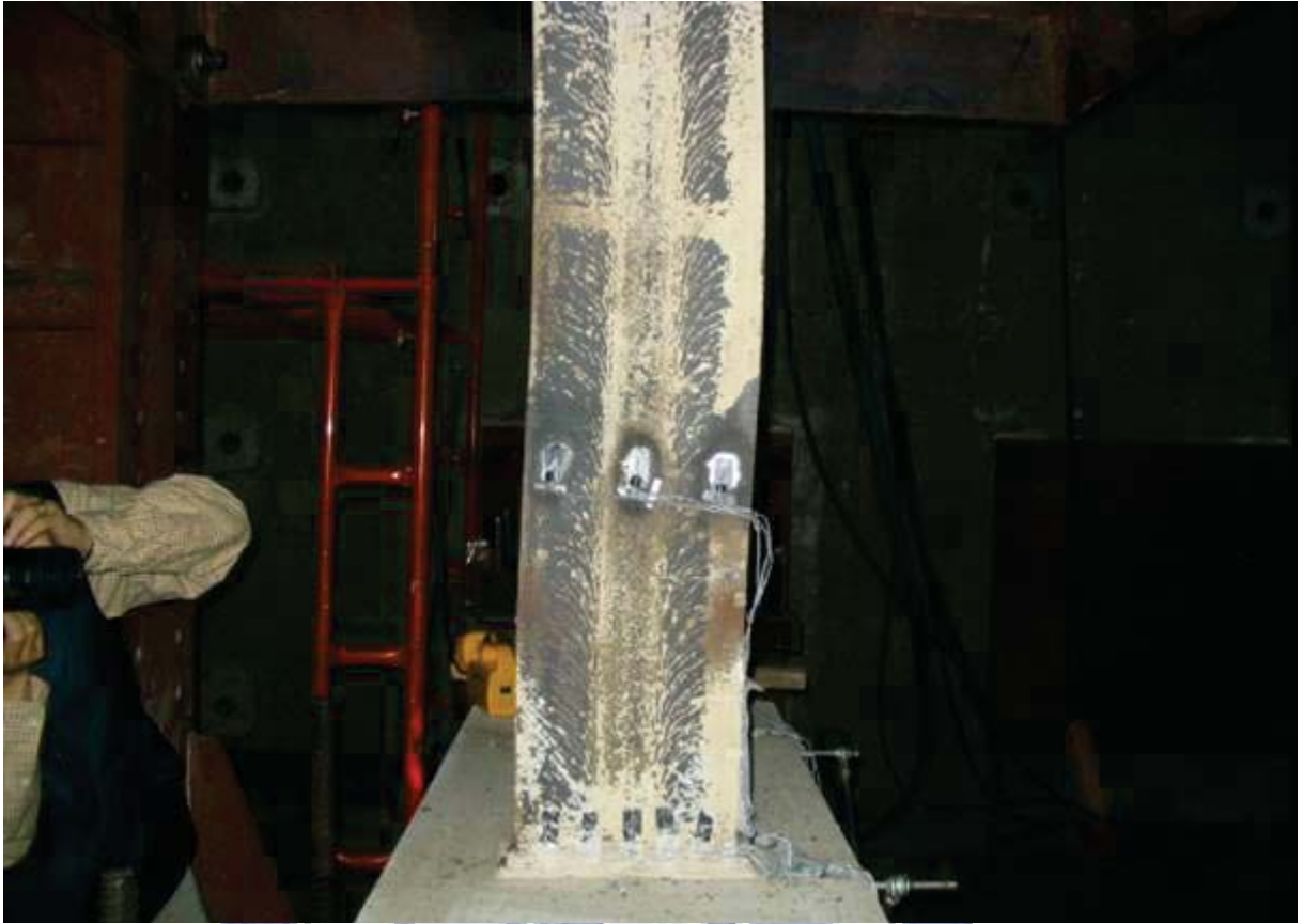
照片 3.57 試體 IFS4 上翼板整體挫屈之情形 ( \theta=3.0\% 弧度結束)
