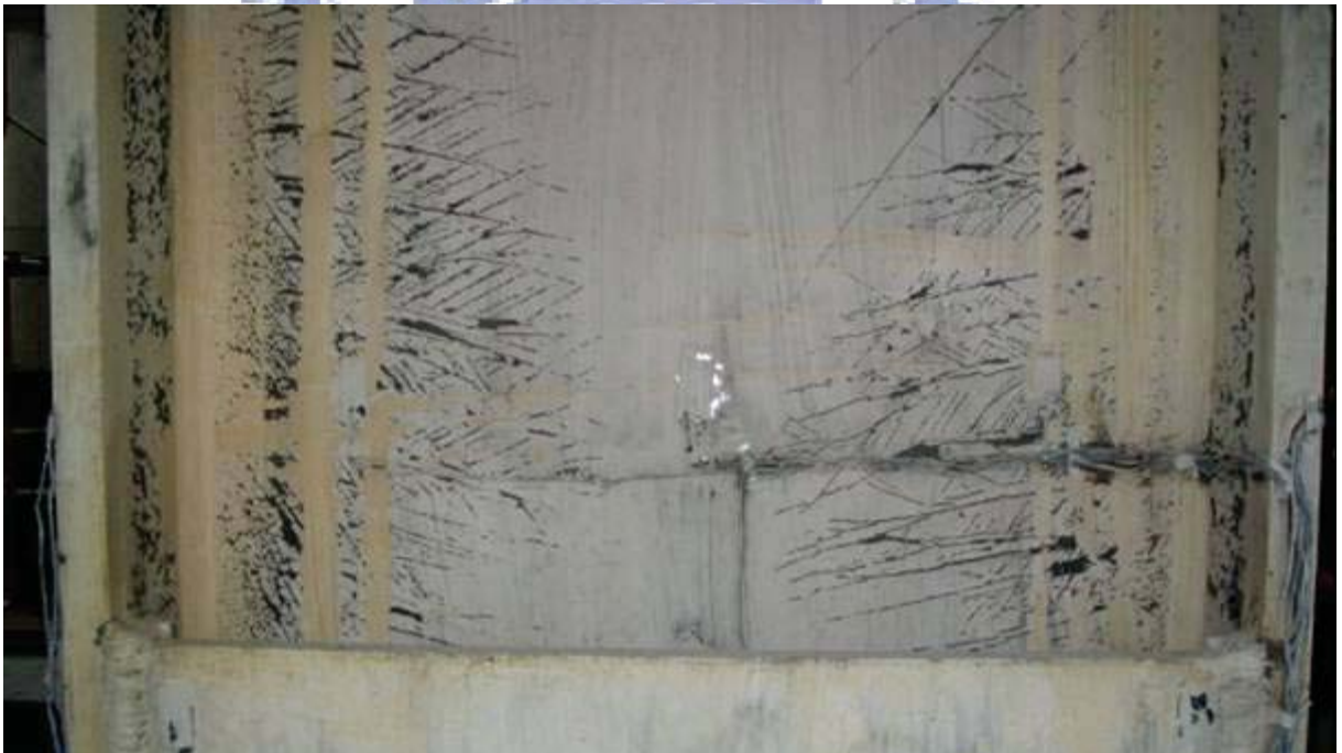
照片 4.20 試體 FDWS2 梁腹板降伏擴大之情形 ( \theta=2.0\% 弧度結束)
