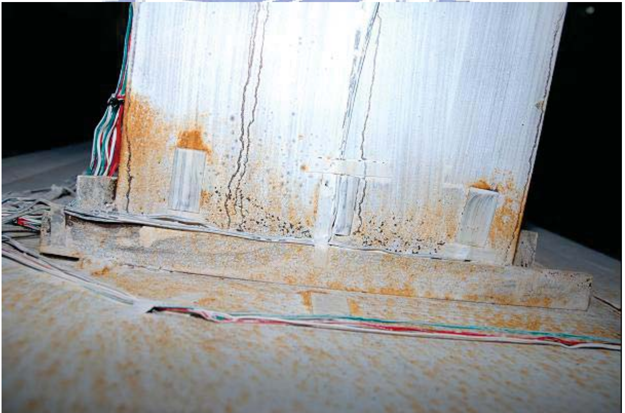
照片 3.16 試體 IFS1 下翼板降伏 ( \theta = -1.5\% 弧度)
