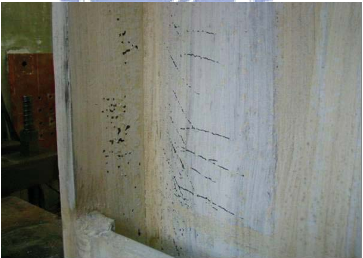
照片 4.16 試體 FDWS2 梁腹板降伏擴大之情形 ( \theta=1.0\% 弧度結束)
