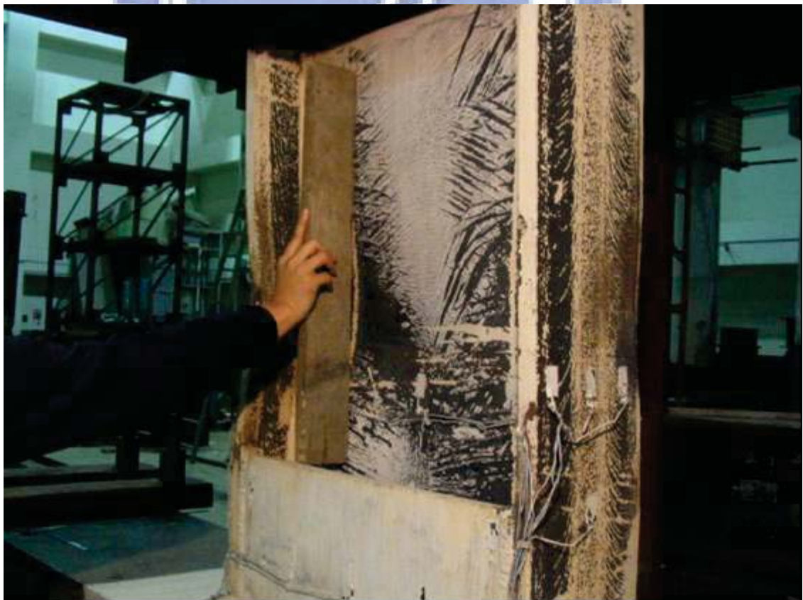
照片 4.34 試體 FDWS2 第二次試驗梁腹板最終之挫屈情形
