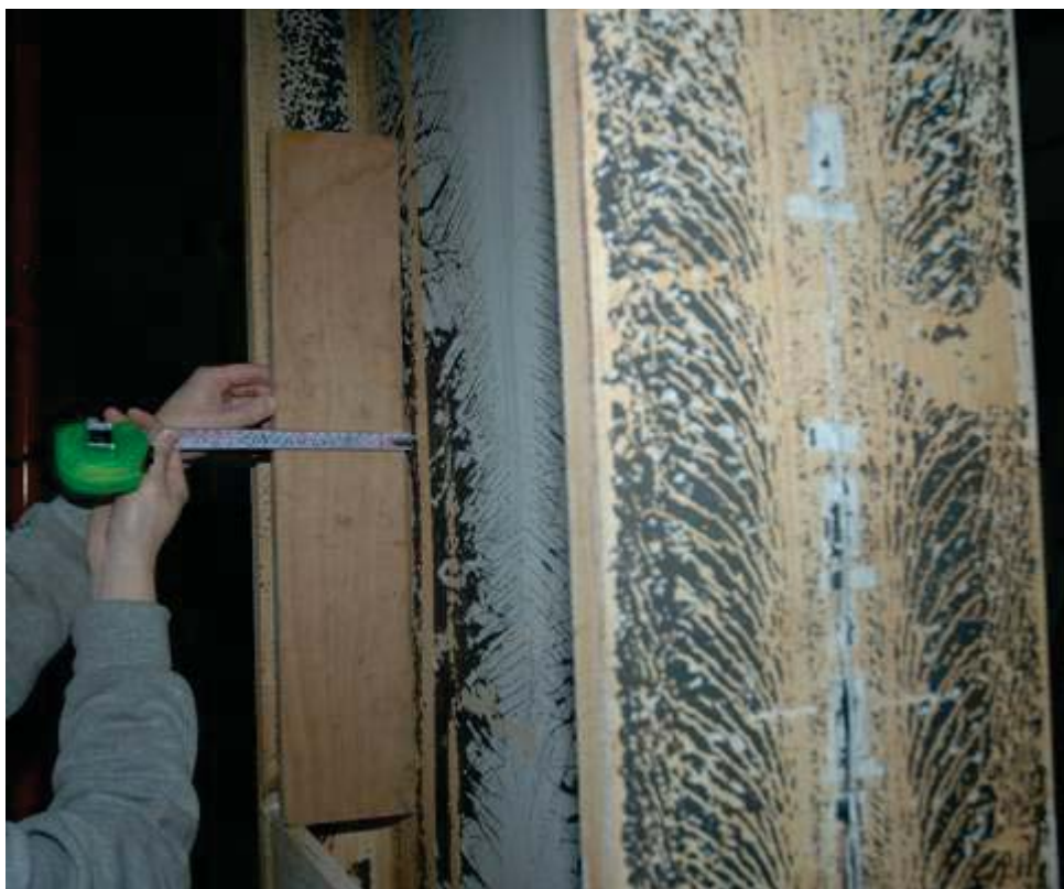
照片 4.47 試體 FDWS3 靠近梁下翼之腹板挫屈 5 mm ( \theta = -4.8\% 弧度)
