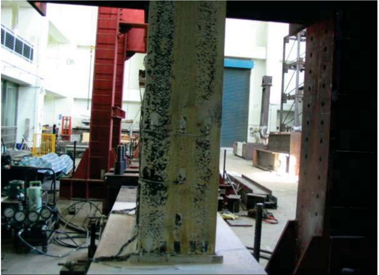
照片 4.19 試體 FDWS2 梁下翼板降伏擴大之情形 ( \theta=2.0\% 弧度結束)
