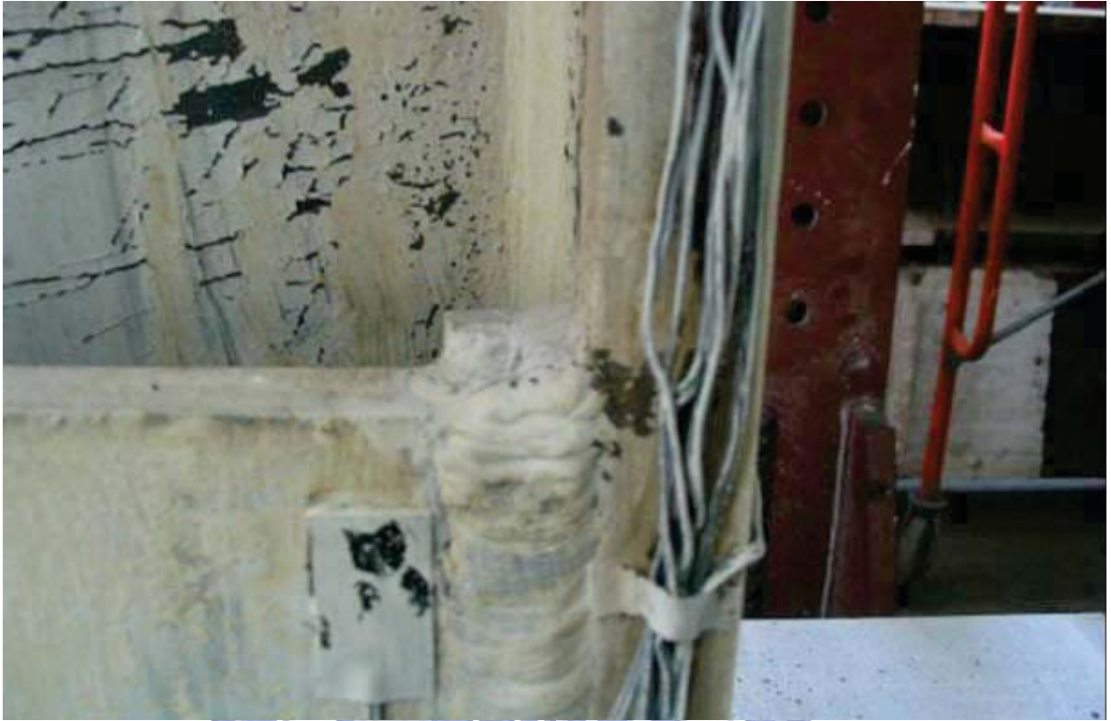
照片 4.17 試體 FDWS2 梁翼板之側面出現塊狀降伏 ( \theta=1.5\% 弧度結束)
