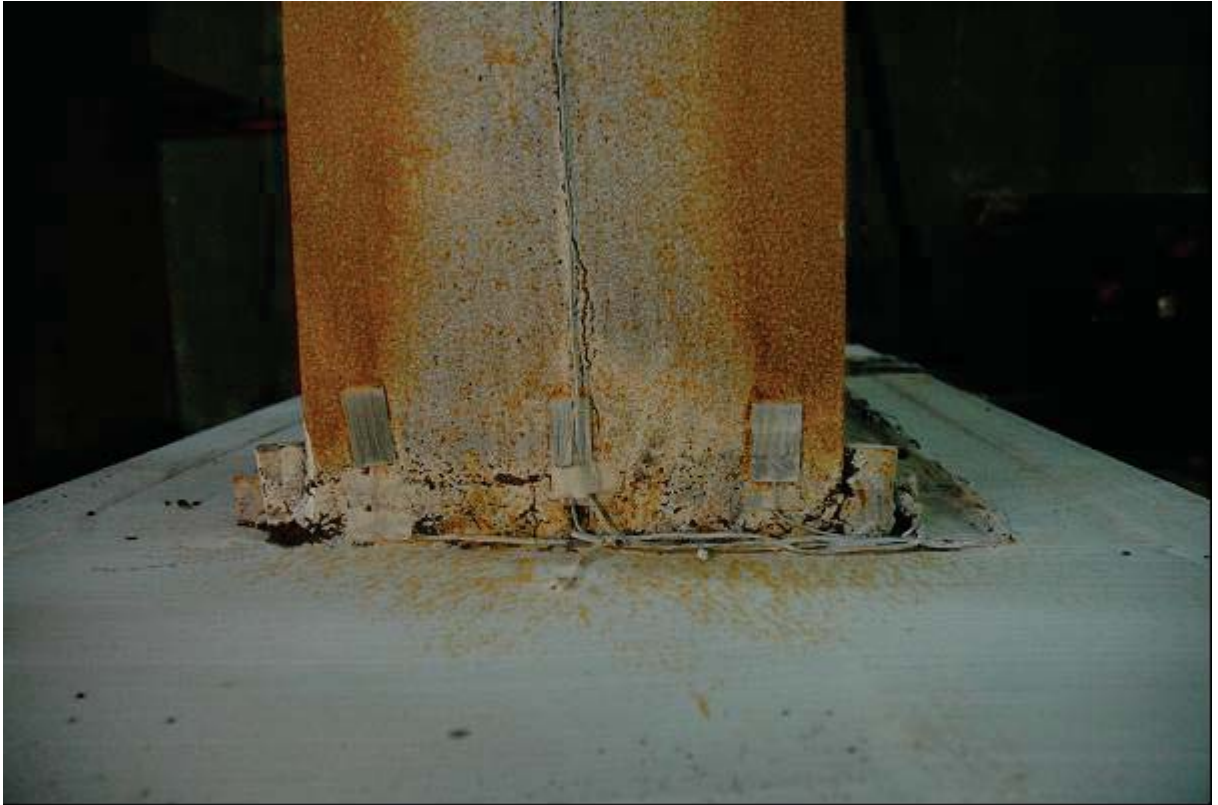
照片 3.17 試體 IFS1 上翼板角落鐵銹剝落 ( \theta = -2.0\% 弧度)
