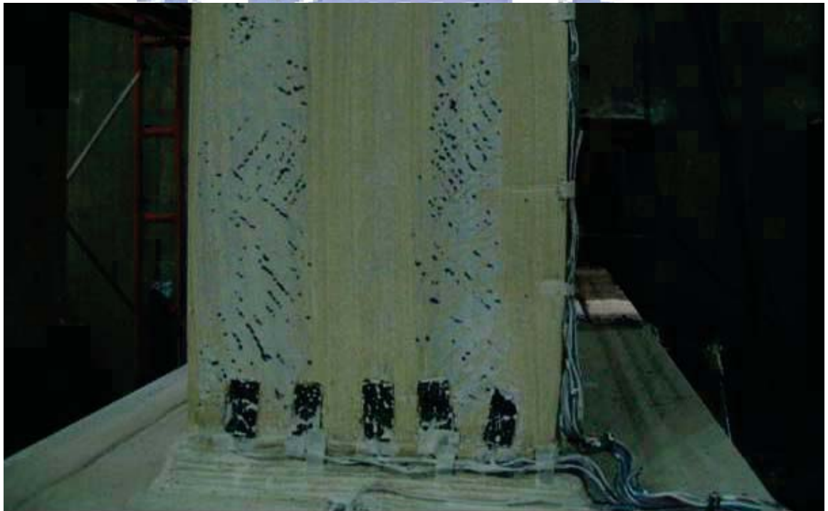
照片 3.42 試體 IFS4 上翼板降伏 ( \theta=0.75\% 弧度結束)
