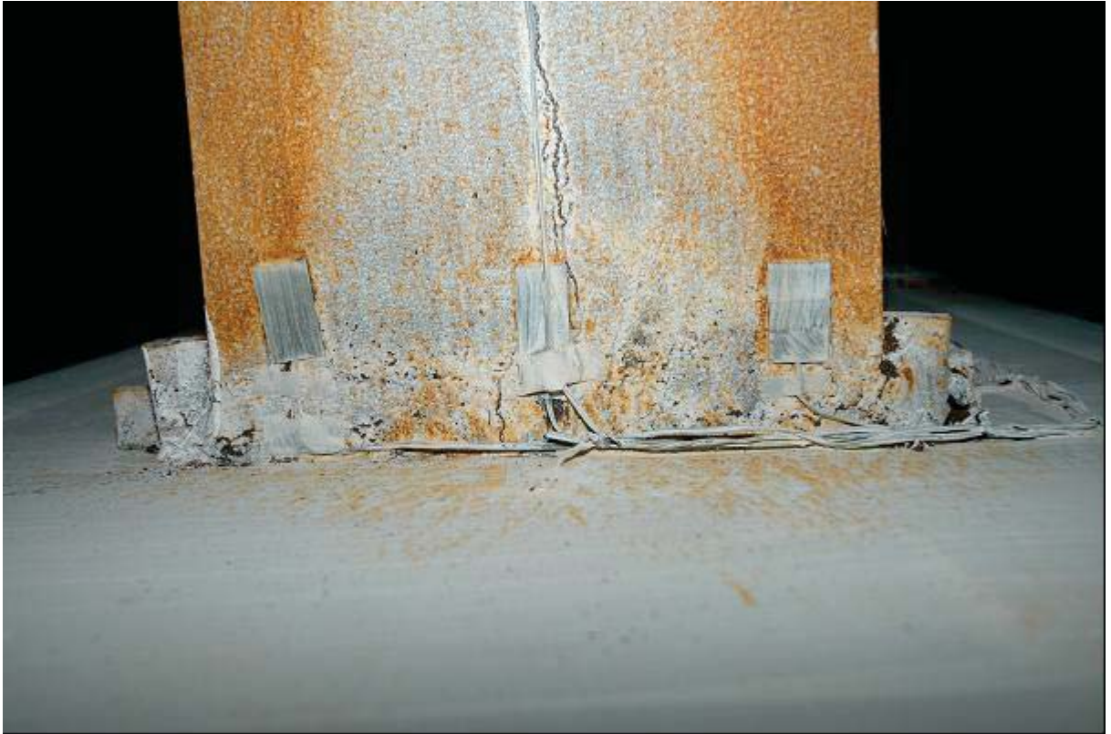
照片 3.15 試體 IFS1 上翼板降伏 ( \theta = -1.5\% 弧度)
