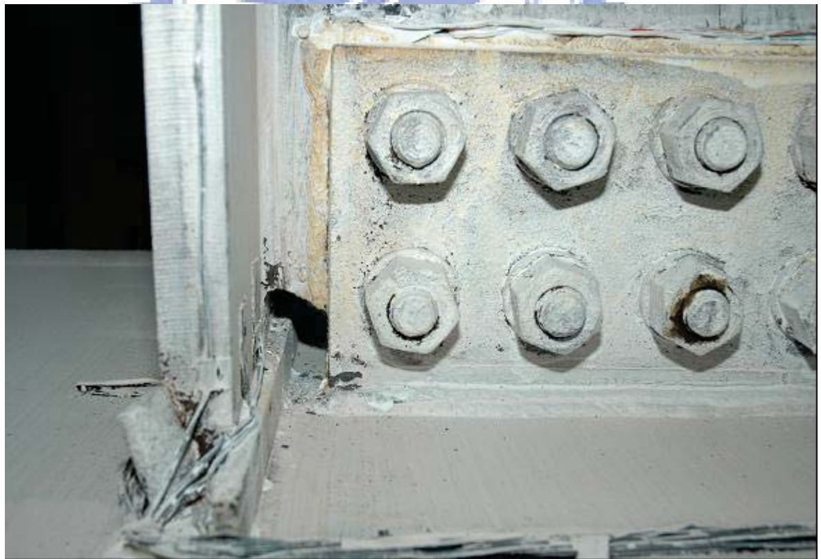
照片 3.4 試體 UR 剪力板降伏 ( \theta = 1.5\% 弧度結束)
