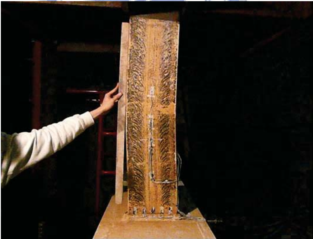
照片 4.62 試體 FDWS3 梁出現側向扭轉的情形 ( \theta=3.77\% 弧度結束)
