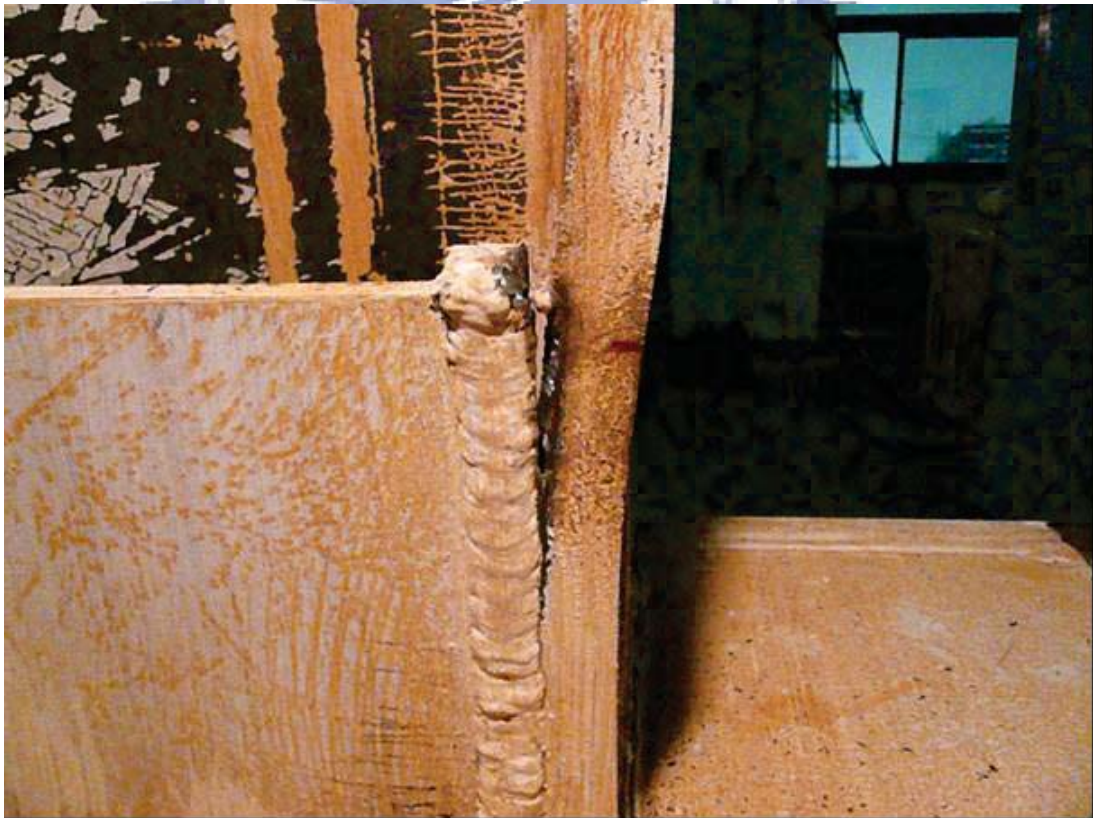
照片 4.60 試體 FDWS3 上翼於加勁板端部之焊道裂縫( \theta=3.77\% 弧度結束)
