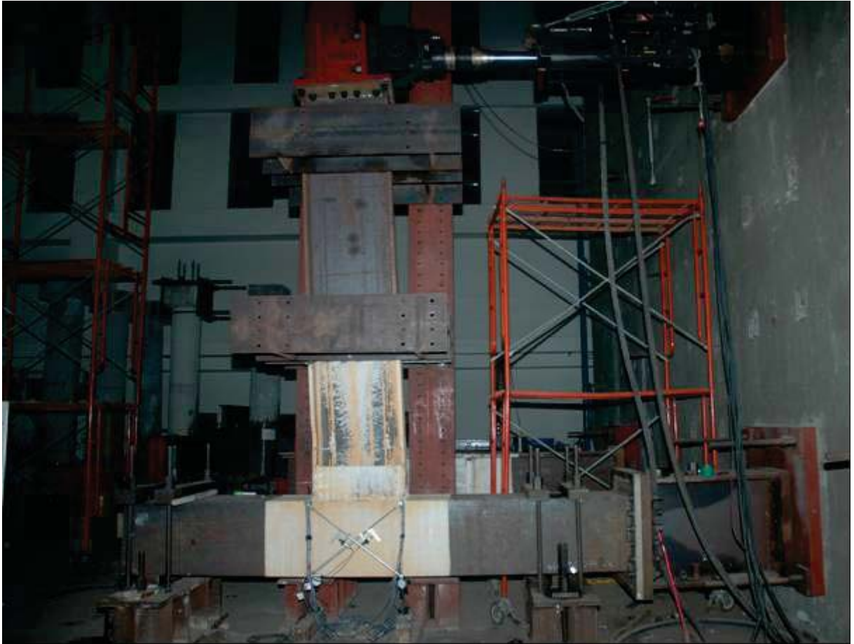
照片 4.63 試體 FDWS3 第二次試驗結束前最大位移角之全景
