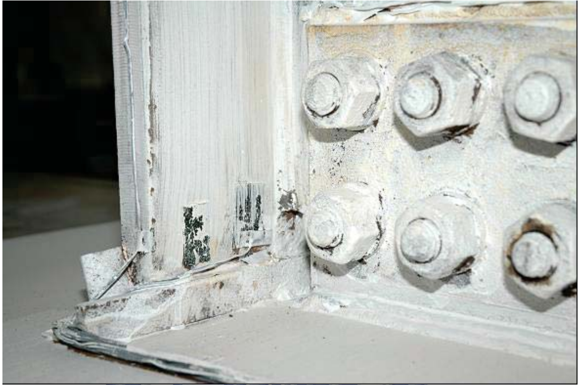
照片 3.3 試體 UR 梁腹板扇形開口處降伏 ( \theta = -1.5\% 弧度)
