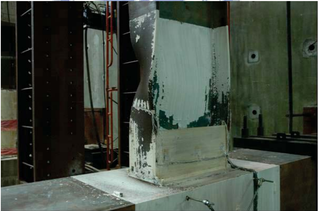
照片 4.10 試體 FDWS1 梁上翼板嚴重挫屈 ( \theta = +4.0\% 弧度)
