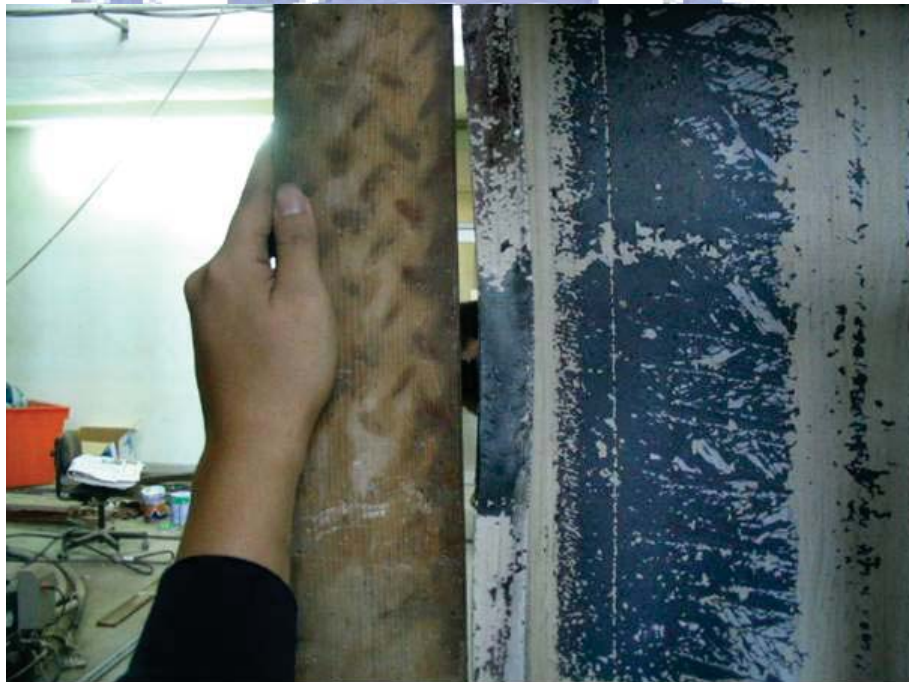
照片 4.22 試體 FDWS2 梁下翼板距柱面 500 mm 處挫屈 ( \theta=-4.4\% 弧度)
