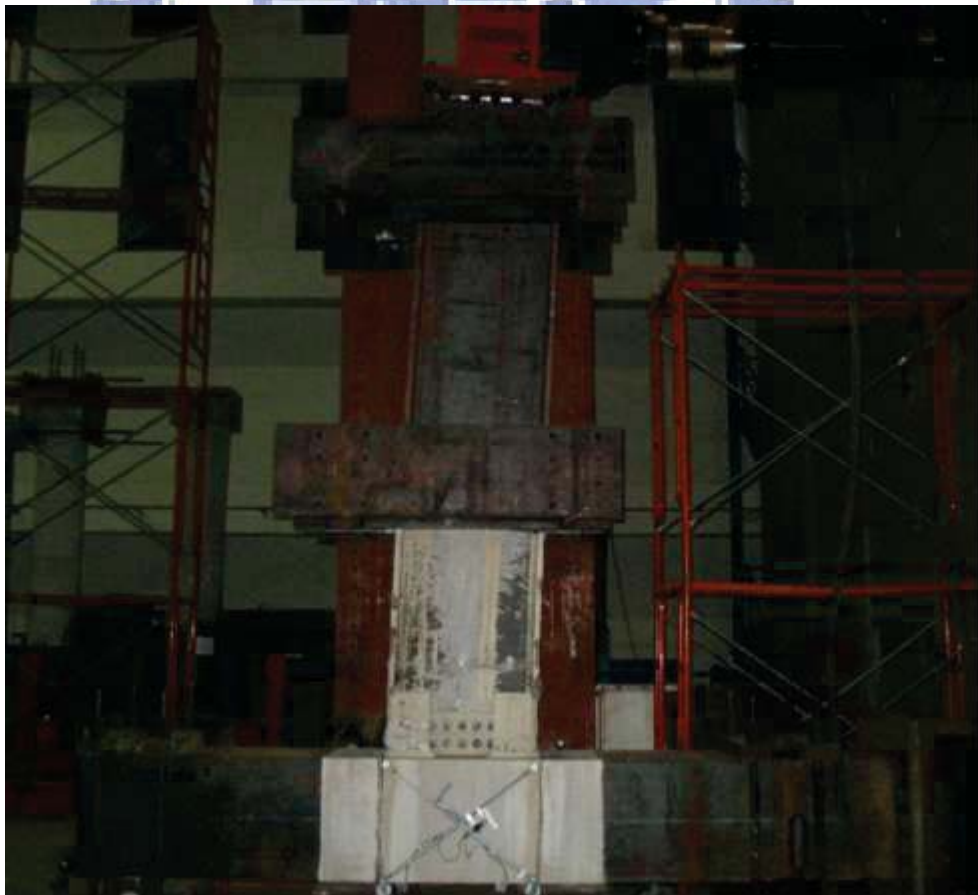
照片 3.54 試體 IFS4 最大位移角之全景 ( \theta=-4.4\% 弧度)
