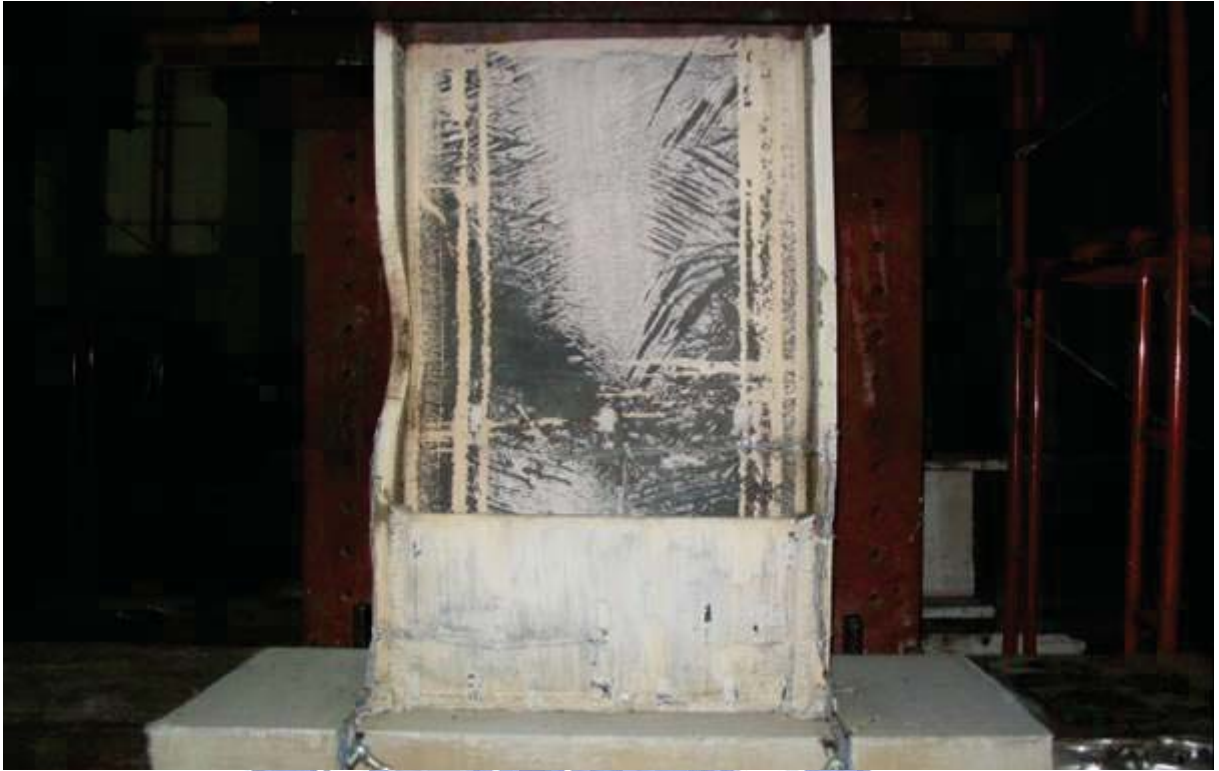
照片 4.33 試體 FDWS2 第二次試驗梁翼板最終之挫屈情形
