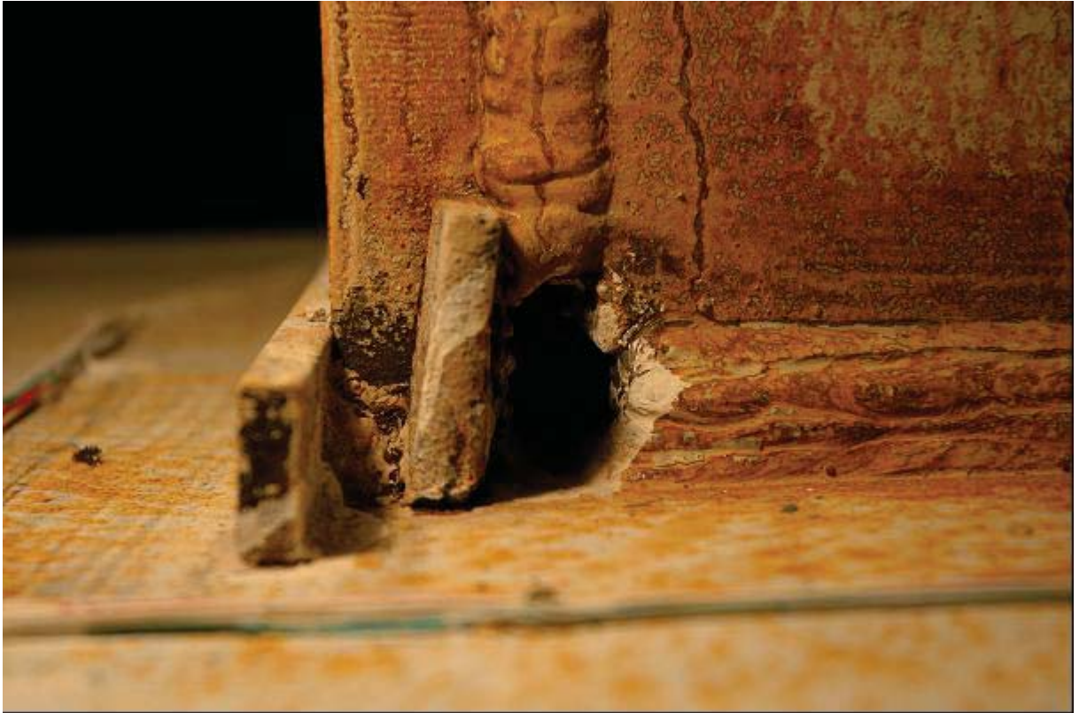
照片 3.21 試體 IFS1 加勁板與柱接之焊道裂縫 ( \theta = +3.0\% 弧度)
