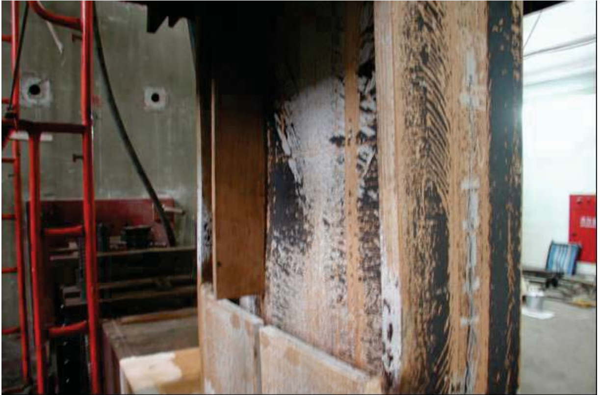
照片 3.73 試體 IFS5 梁下翼之腹板挫屈 11 mm (位移角 \theta = -1.0\% 弧度)
