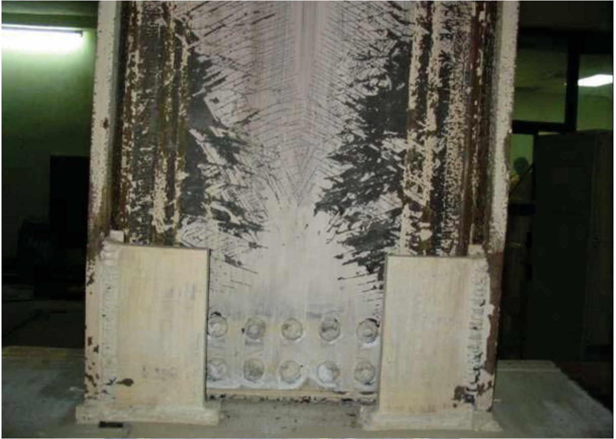
照片 3.49 試體 IFS4 梁腹板及加勁板降伏情形 ( \theta=4.0\% 弧度結束)
