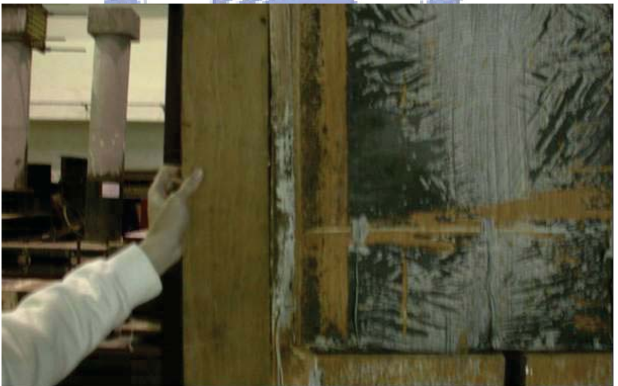
照片 3.76 試體 IFS5 梁上翼板挫屈 8 mm (位移角 \theta = +1.5\% 弧度)
