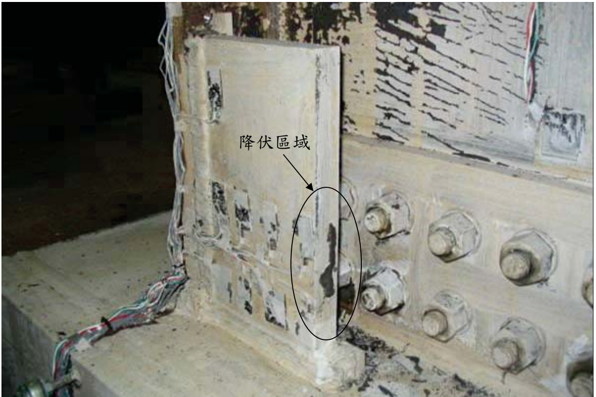
照片 3.51 試體 IFS4 加勁板與柱接之焊道端部上方降伏 ( \theta = -4.4\% 弧度)
