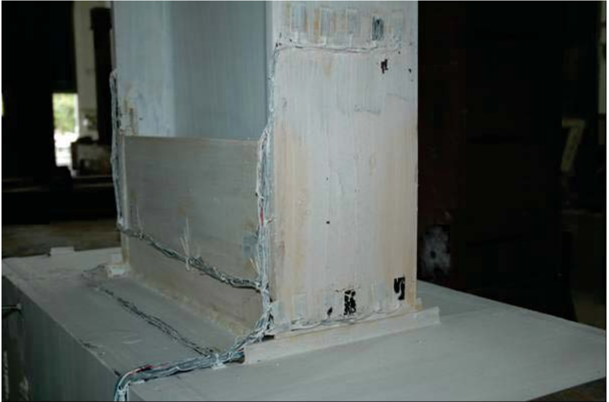
照片 4.3 試體 FDWS1 下翼板降伏 ( \theta=1.0\% 弧度結束)
