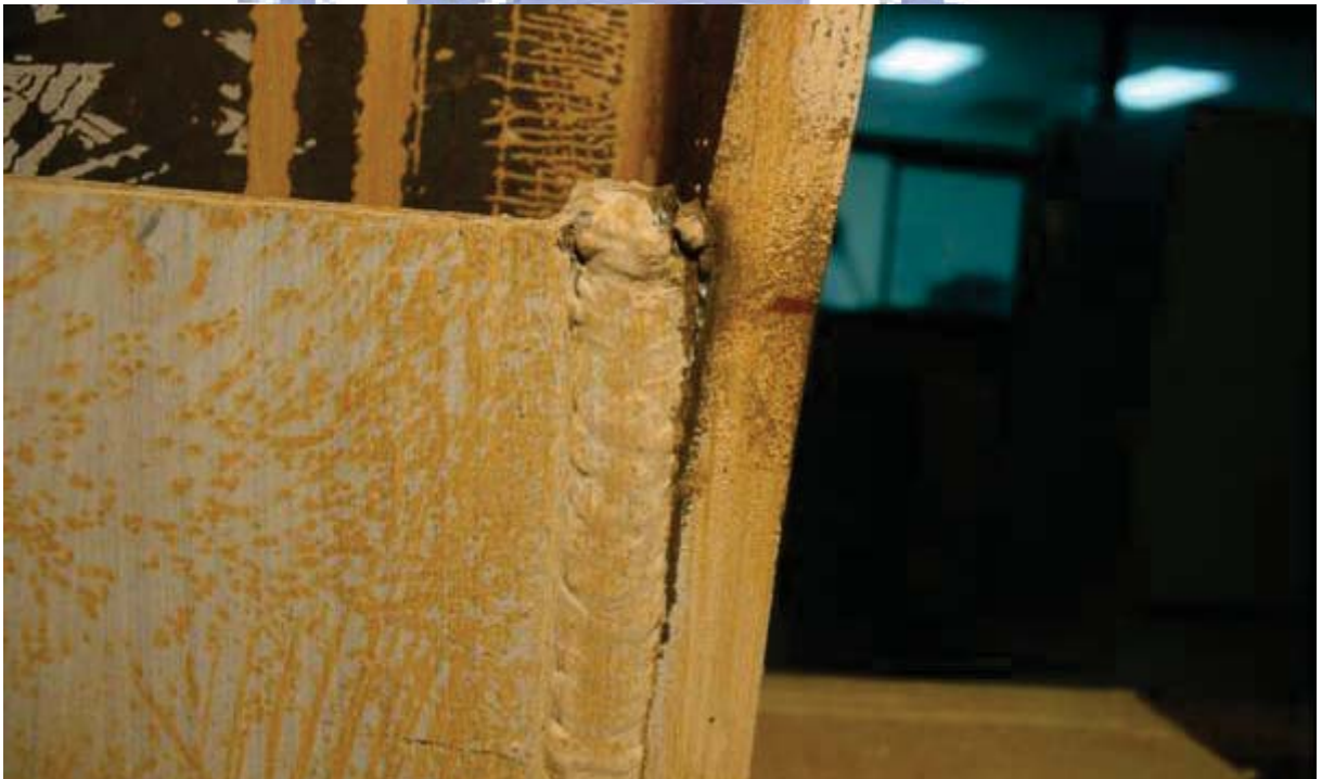
照片 4.58 試體 FDWS3 上翼於加勁板端部之焊道裂縫 ( \theta=3.0\% 弧度結束)
