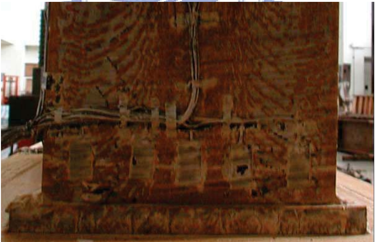
照片 3.61 試體 IFS5 上翼板降伏 ( \theta=0.5\% 弧度結束)
