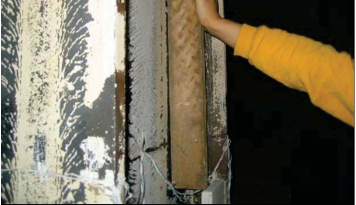
照片 3.53 試體 IFS4 梁下翼之腹板挫屈向內凹 7 mm ( \theta=4.4\% 弧度結束)
