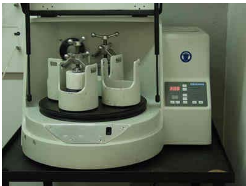
圖 15. 行星式球磨機。
