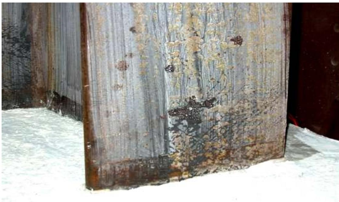
照片 4.2 試體 SRC1-VR1.38 位移  $4\Delta_y$  時 (Story Drift Angle  $\theta_t=1.91\%$  , Beam Plastic Rotation  $\theta_{bp}=0.57\%$ ) 鋼梁之降伏情況
