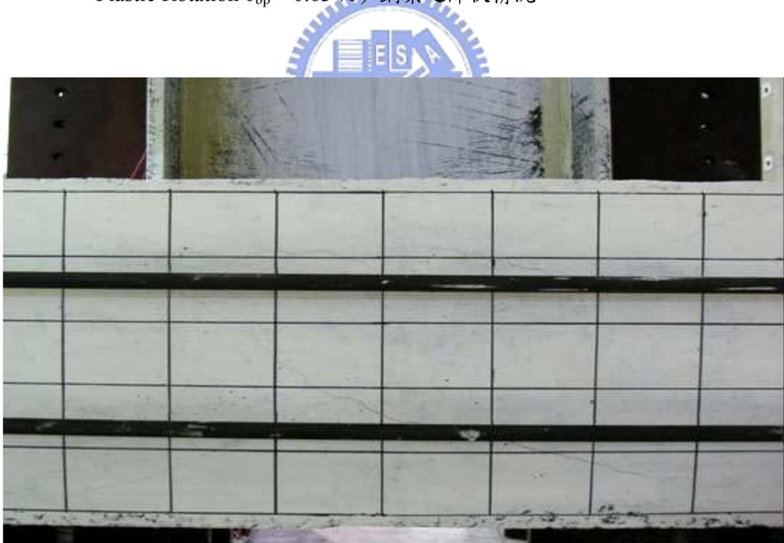
照片 4.10 試體 SRC2-VR1.15 位移  $4\Delta_y$  時 (Story Drift Angle  $\theta_t=1.91\%$  , Beam Plastic Rotation  $\theta_{bp}=1.05\%$ ) 接頭區混凝土之裂縫發展情況
