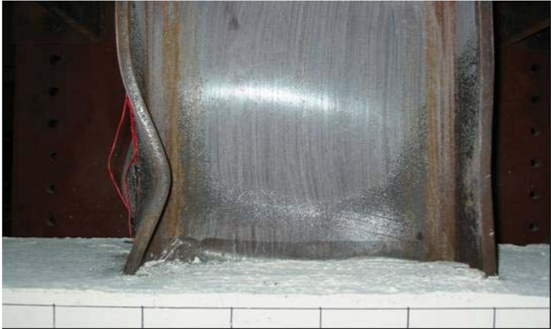
照片 4.6 試體 SRC1-VR1.38 位移  $8\Delta_y$  時 (Story Drift Angle  $\theta_t=3.82\%$  , Beam Plastic Rotation  $\theta_{bp}=2.63\%$ ) 鋼梁之塑性變形情況
