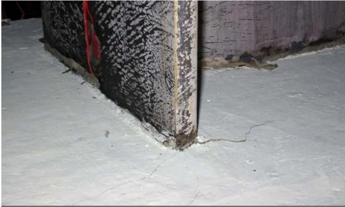
照片 4.30 試體 SRC4-VR0.82 位移  $6\Delta_y$  時 (Story Drift Angle  $\theta_t=2.86\%$  , Beam Plastic Rotation  $\theta_{bp}=1.68\%$ ) 柱上方混凝土之擠壓情況
