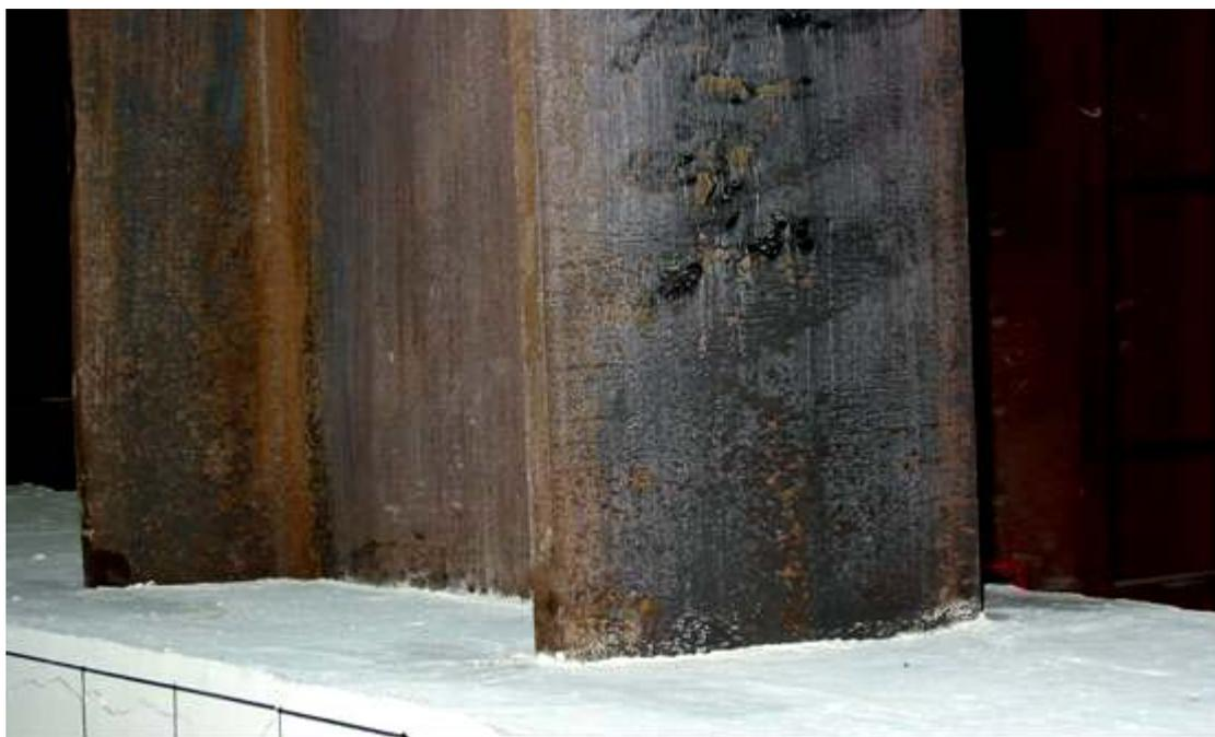
照片 4.43 試體 SRC5-VR0.58 位移  $7\Delta_y$  時 (Story Drift Angle  $\theta_t=3.34\%$  , Beam Plastic Rotation  $\theta_{bp}=1.75\%$ ) 鋼梁之降伏情況
