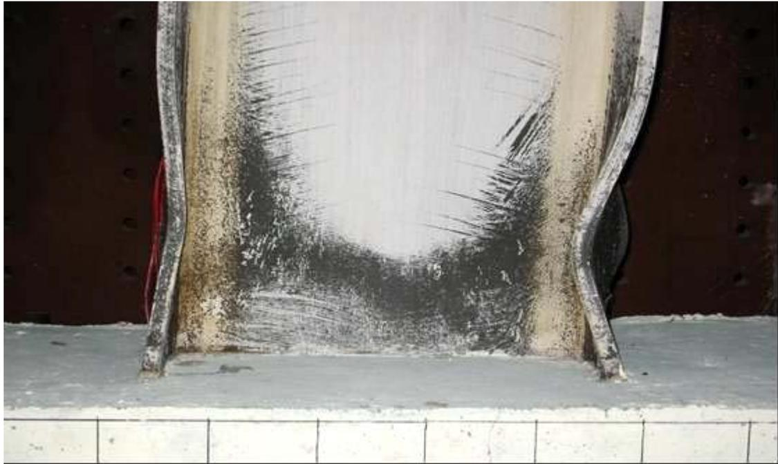
照片 4.24 試體 SRC3-VR0.98 位移  $8\Delta_y$  時 (Story Drift Angle  $\theta_t=3.82\%$  , Beam Plastic Rotation  $\theta_{bp}=2.72\%$ ) 鋼梁之塑性變形情況
