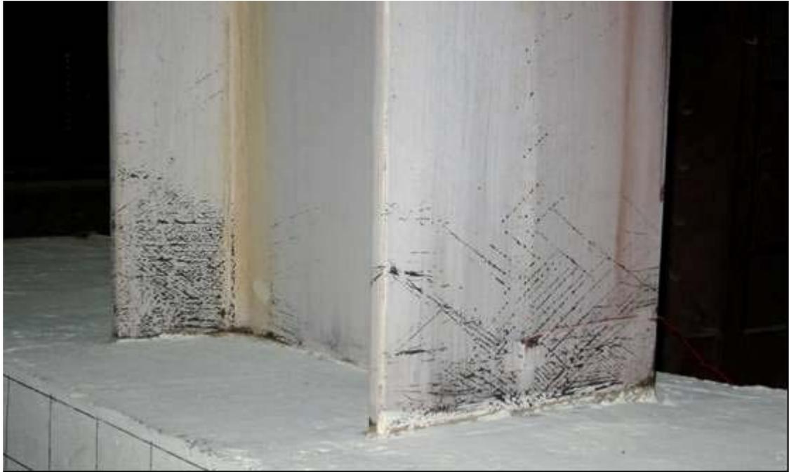
照片 4.20 試體 SRC3-VR0.98 位移  $3\Delta_y$  時 (Story Drift Angle  $\theta_t=1.43\%$  , Beam Plastic Rotation  $\theta_{bp}=0.51\%$ ) 鋼梁之降伏情況
