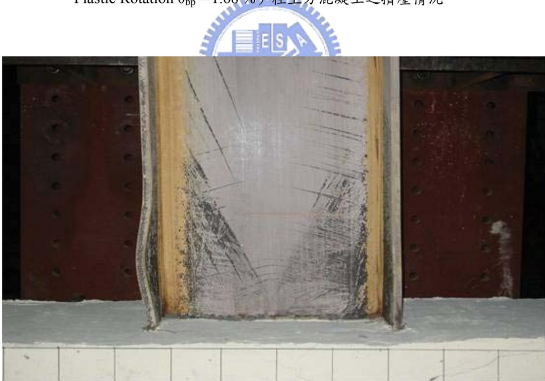
照片 4.31 試體 SRC4-VR0.82 位移  $8\Delta_y$  時 (Story Drift Angle  $\theta_t=3.82\%$  , Beam Plastic Rotation  $\theta_{bp}=2.54\%$ ) 鋼梁之塑性變形情況
