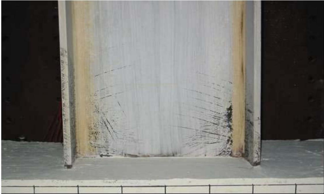
照片 4.11 試體 SRC2-VR1.15 位移  $4\Delta_y$  時 (Story Drift Angle  $\theta_t=1.91\%$  , Beam Plastic Rotation  $\theta_{bp}=1.05\%$ ) 鋼梁之降伏情況
