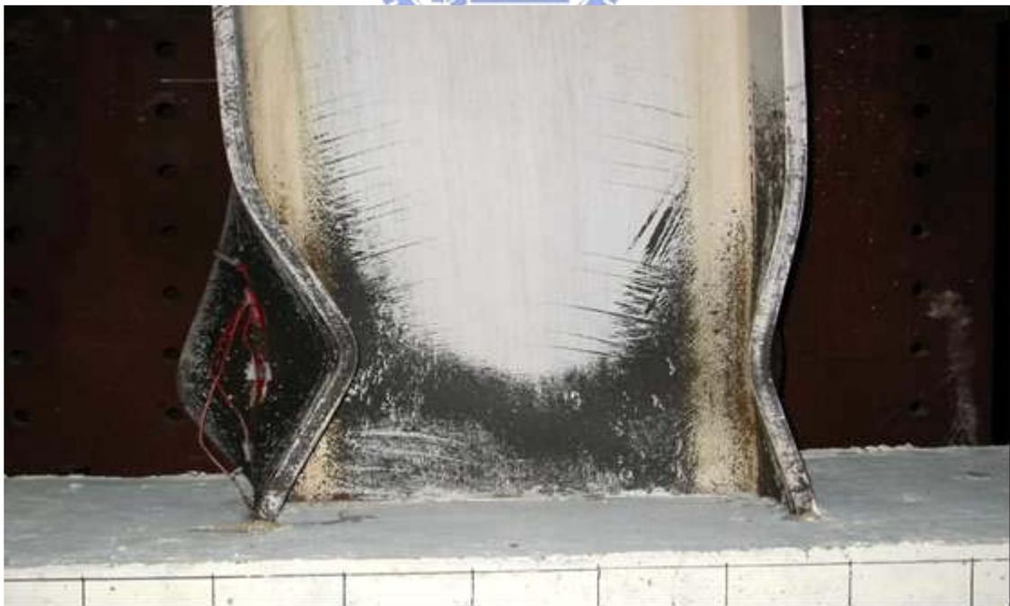
照片 4.26 試體 SRC3-VR0.98 位移  $10\Delta_y$  時 (Story Drift Angle  $\theta_t=4.77\%$  , Beam Plastic Rotation  $\theta_{bp}=3.81\%$ ) 鋼梁之塑性變形情況
