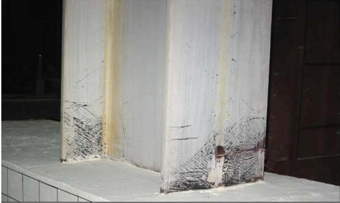
照片 4.9 試體 SRC2-VR1.15 位移  $3\Delta_y$  時 (Story Drift Angle  $\theta_t=1.43\%$  , Beam Plastic Rotation  $\theta_{bp}=0.63\%$ ) 鋼梁之降伏情況
