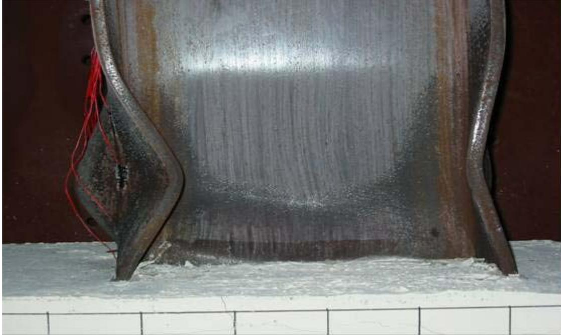
照片 4.8 試體 SRC1-VR1.38 位移  $10\Delta_y$  時 (Story Drift Angle  $\theta_t=4.77\%$  , Beam Plastic Rotation  $\theta_{bp}=3.74\%$ ) 鋼梁之塑性變形情況
