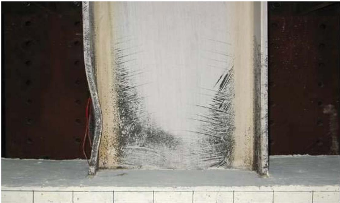
照片 4.23 試體 SRC3-VR0.98 位移  $7\Delta_y$  時 (Story Drift Angle  $\theta_t=3.34\%$  , Beam Plastic Rotation  $\theta_{bp}=2.08\%$ ) 鋼梁之塑性變形情況
