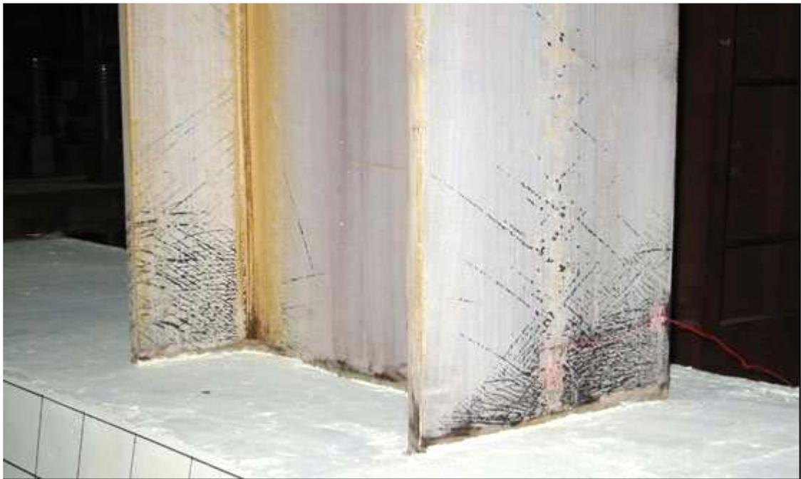
照片 4.28 試體 SRC4-VR0.82 位移  $3\Delta_y$  時 (Story Drift Angle  $\theta_t=1.43\%$  , Beam Plastic Rotation  $\theta_{bp}=0.55\%$ ) 鋼梁之降伏情況
