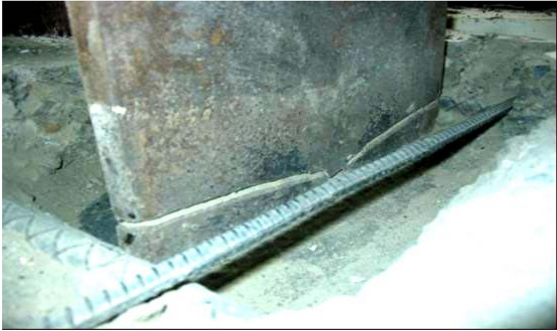
照片 4.46 試體 SRC5-VR0.58 鋼梁 V 型斷裂
