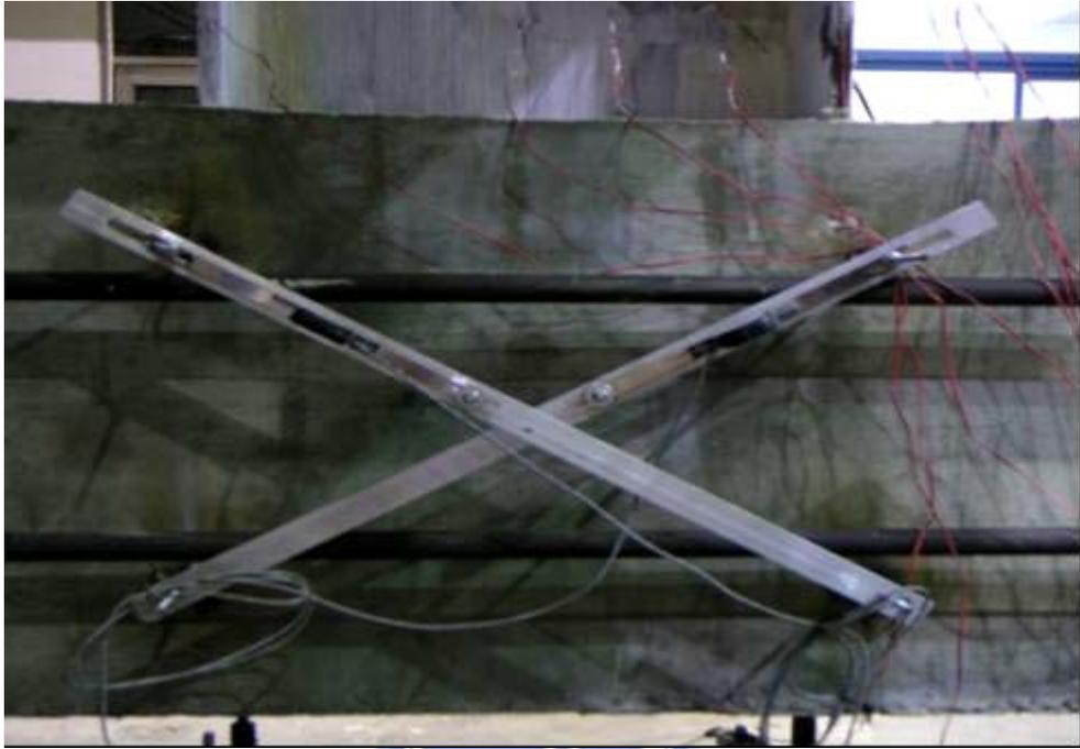
照片 3.5  $\pi$  gauge 架設情形
