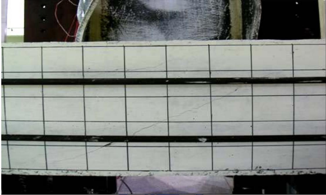
照片 4.15 試體 SRC2-VR1.15 位移  $9\Delta_y$  時 (Story Drift Angle  $\theta_t=4.30\%$  , Beam Plastic Rotation  $\theta_{bp}=3.35\%$ ) 接頭區混凝土之裂縫發展情況
