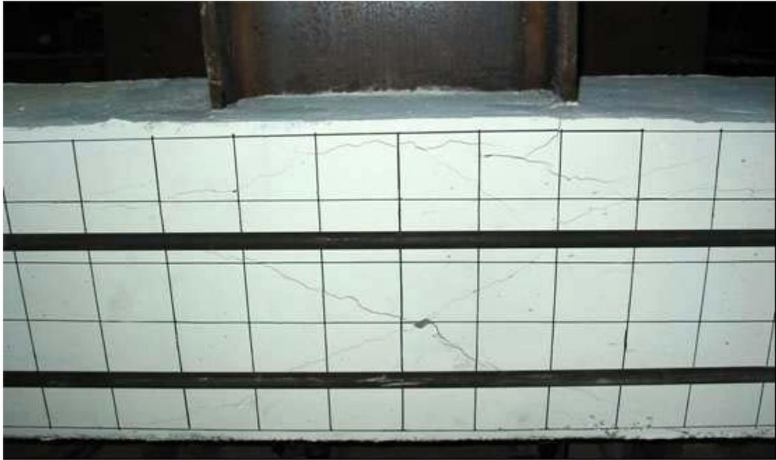
照片 4.39 試體 SRC5-VR0.58 位移  $6\Delta_y$  時 (Story Drift Angle  $\theta_t=2.86\%$  , Beam Plastic Rotation  $\theta_{bp}=1.35\%$ ) 接頭區混凝土之裂縫發展情況
