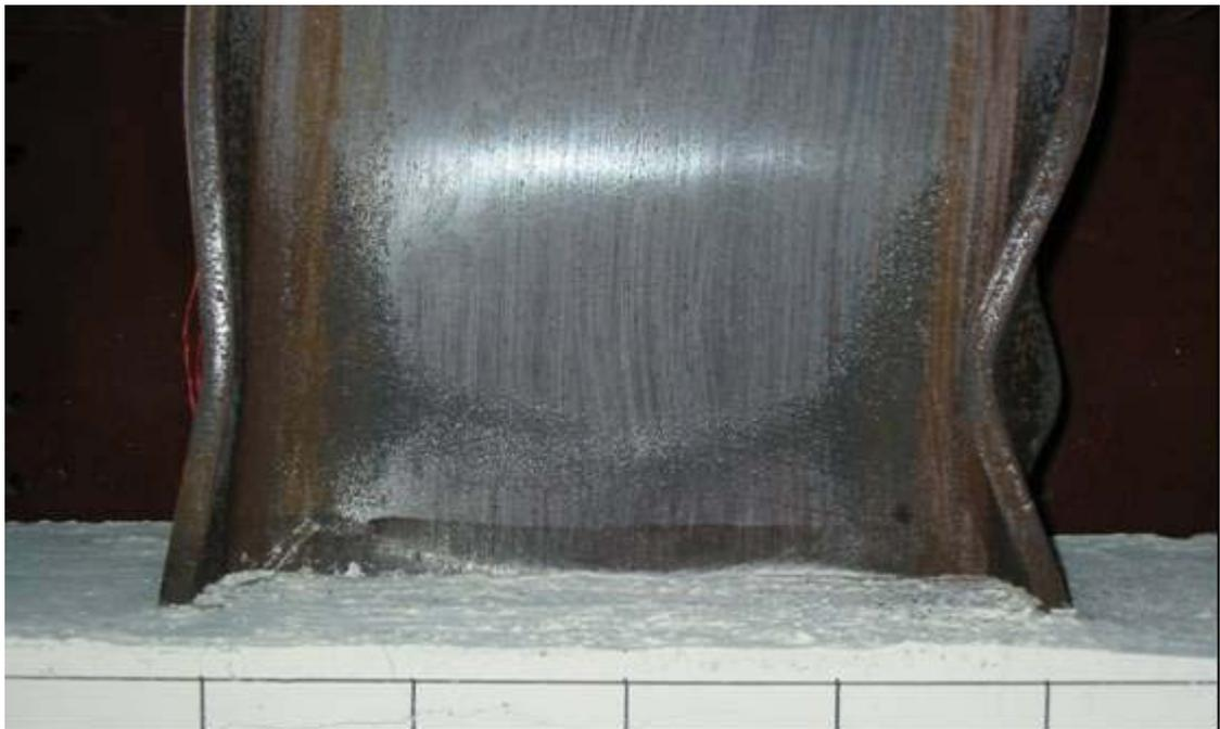
照片 4.7 試體 SRC1-VR1.38 位移  $9\Delta_y$  時 (Story Drift Angle  $\theta_t=4.30\%$  , Beam Plastic Rotation  $\theta_{bp}=3.25\%$ ) 鋼梁之塑性變形情況
