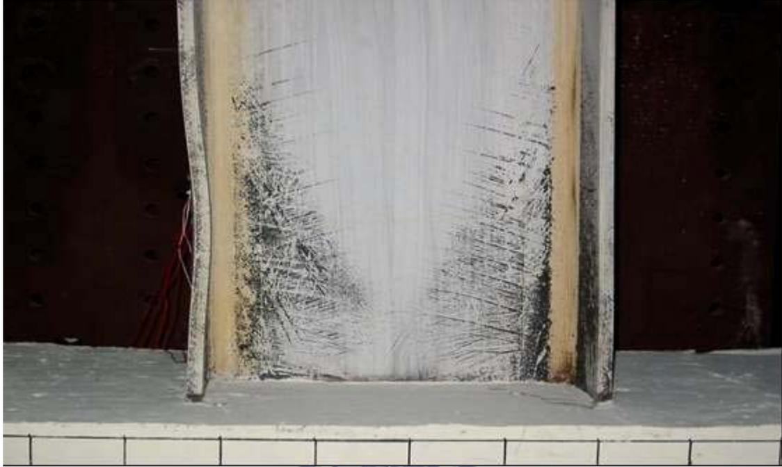
照片 4.13 試體 SRC2-VR1.15 位移  $7\Delta_y$  時 (Story Drift Angle  $\theta_t=3.34\%$  , Beam Plastic Rotation  $\theta_{bp}=2.30\%$ ) 鋼梁之塑性變形情況
