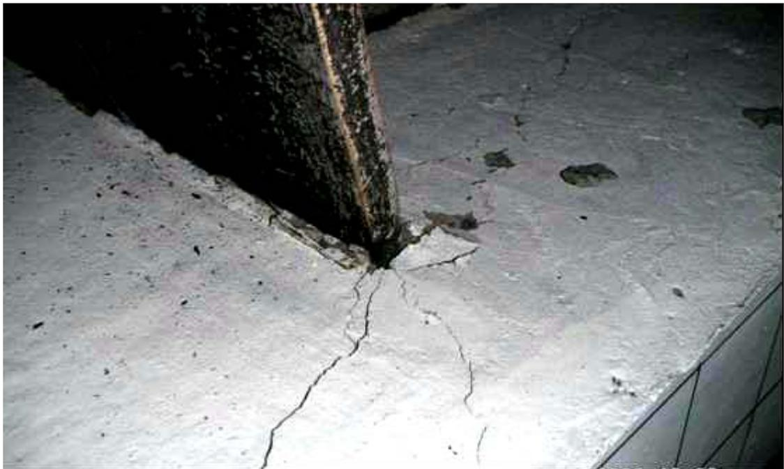
照片 4.35 試體 SRC4-VR0.82 位移  $12\Delta_y$  時 (Story Drift Angle  $\theta_t=5.73\%$  , Beam Plastic Rotation  $\theta_{bp}=4.78\%$ ) 柱上方混凝土之裂縫發展情況
