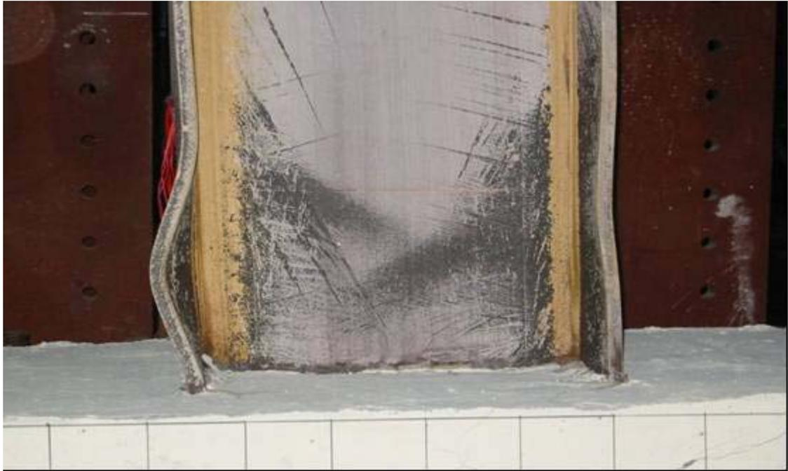
照片 4.32 試體 SRC4-VR0.82 位移  $9\Delta_y$  時 (Story Drift Angle  $\theta_t=4.30\%$  , Beam Plastic Rotation  $\theta_{bp}=3.09\%$ ) 鋼梁之塑性變形情況
