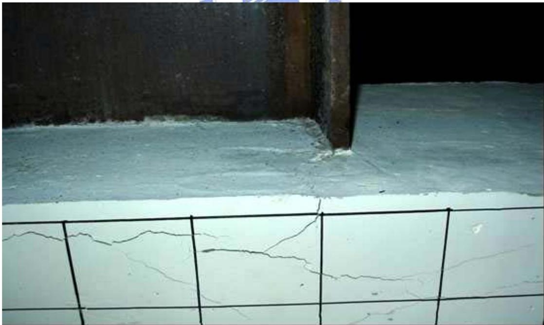
照片 4.40 試體 SRC5-VR0.58 位移  $6\Delta_y$  時 (Story Drift Angle  $\theta_t=2.86\%$  , Beam Plastic Rotation  $\theta_{bp}=1.35\%$ ) 接頭區混凝土之裂縫發展情況
