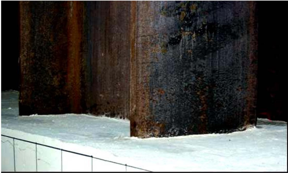
照片 4.41 試體 SRC5-VR0.58 位移  $6\Delta_y$  時 (Story Drift Angle  $\theta_t=2.86\%$  , Beam Plastic Rotation  $\theta_{bp}=1.35\%$ ) 鋼梁之降伏情況
