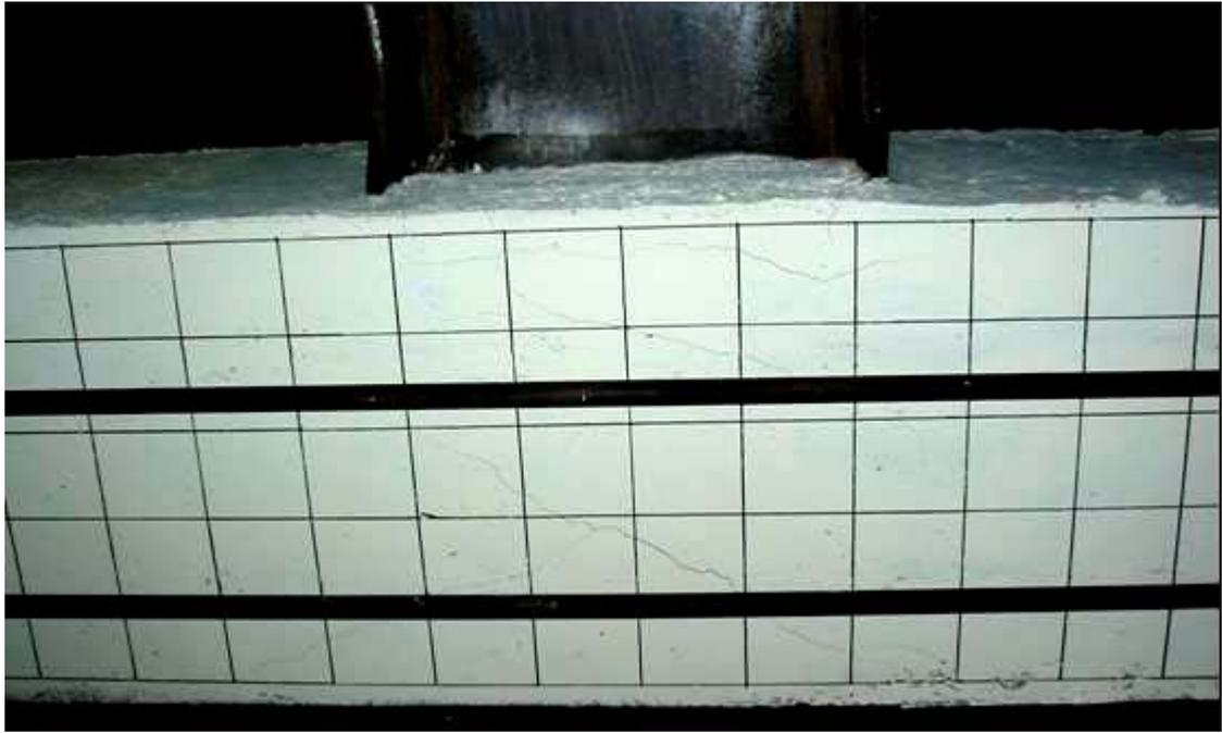
照片 4.4 試體 SRC1-VR1.38 位移  $7\Delta_y$  時 (Story Drift Angle  $\theta_t=3.34\%$  , Beam Plastic Rotation  $\theta_{bp}=1.89\%$ ) 接頭區混凝土之裂縫發展情況
