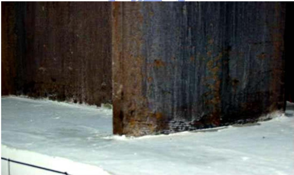
照片 4.38 試體 SRC5-VR0.58 位移  $3\Delta_y$  時 (Story Drift Angle  $\theta_t=1.43\%$  , Beam Plastic Rotation  $\theta_{bp}=0.40\%$ ) 鋼梁之降伏情況
