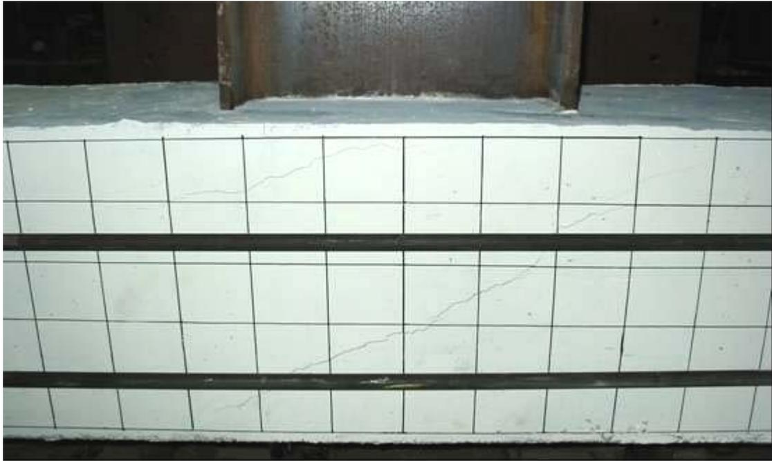
照片 4.37 試體 SRC5-VR0.58 位移  $3\Delta_y$  時 (Story Drift Angle  $\theta_t=1.43\%$  , Beam Plastic Rotation  $\theta_{bp}=0.40\%$ ) 接頭區混凝土之裂縫發展情況
