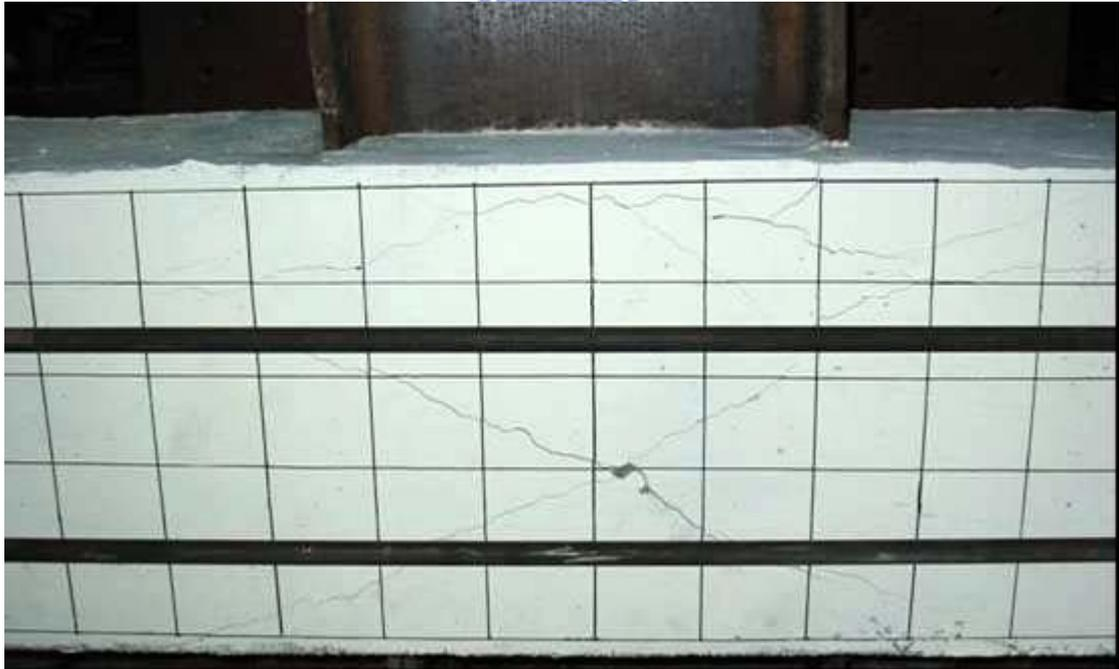
照片 4.42 試體 SRC5-VR0.58 位移  $7\Delta_y$  時 (Story Drift Angle  $\theta_t=3.34\%$  , Beam
