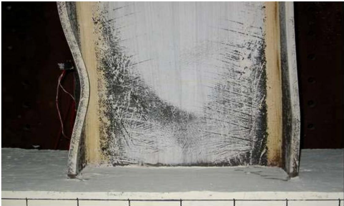
照片 4.14 試體 SRC2-VR1.15 位移  $8\Delta_y$  時 (Story Drift Angle  $\theta_t=3.82\%$  , Beam Plastic Rotation  $\theta_{bp}=2.85\%$ ) 鋼梁之塑性變形情況
