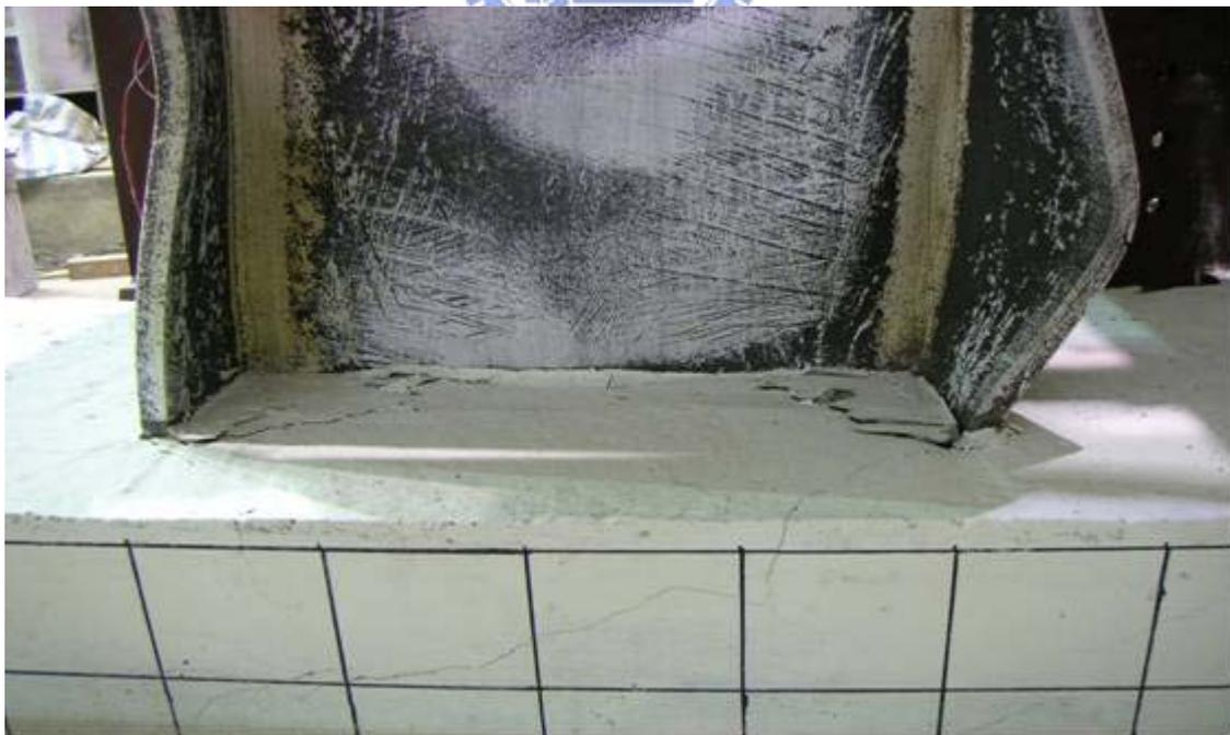
(a) 試體 SRC2-VR1.15 位移  $8\Delta_y$  時 (Story Drift Angle  $\theta_t=3.82\%$  , Beam Plastic Rotation  $\theta_{bp}=2.85\%$ ) 柱上方鋼梁附近混凝土之開裂情況
