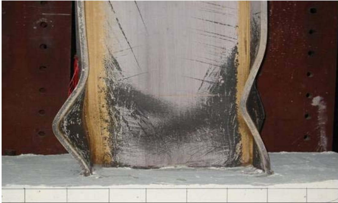
照片 4.36 試體 SRC4-VR0.82 位移  $12\Delta_y$  時 (Story Drift Angle  $\theta_t=5.73\%$  , Beam Plastic Rotation  $\theta_{bp}=4.78\%$ ) 鋼梁之塑性變形情況
