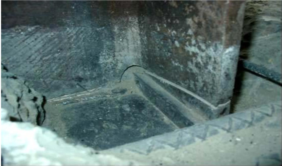
照片 4.45 試體 SRC5-VR0.58 鋼梁斷裂
