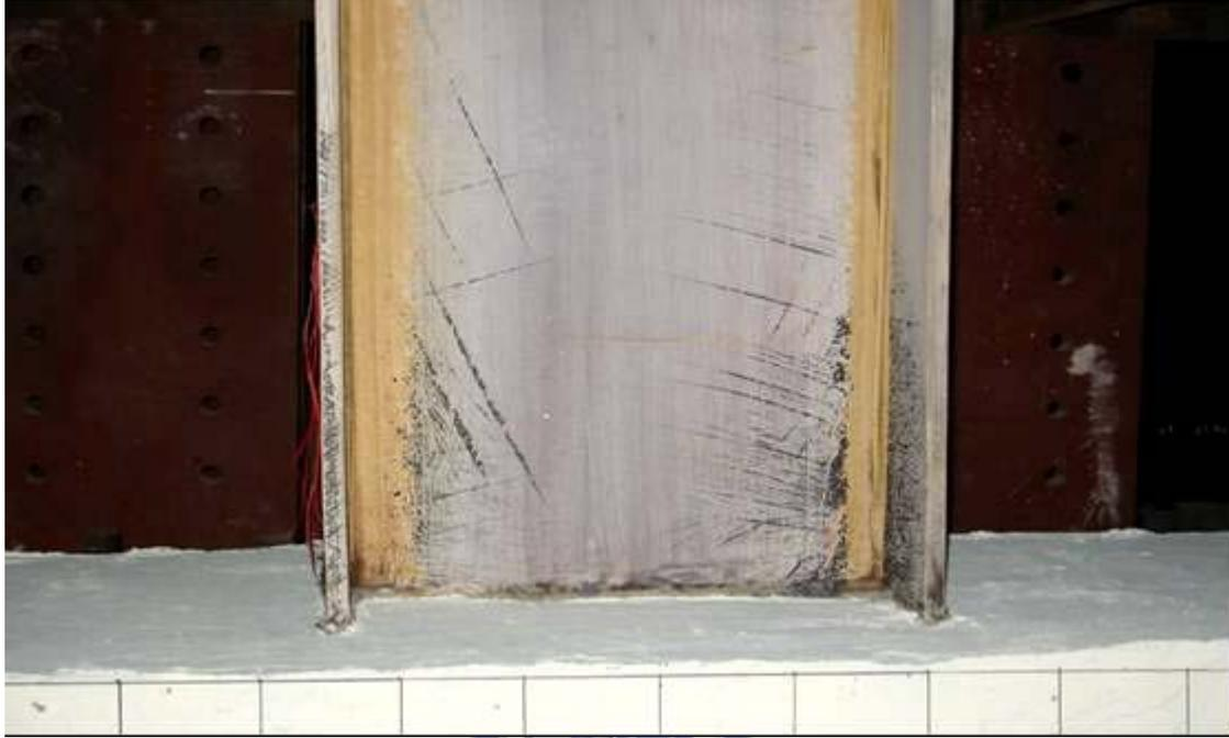
照片 4.29 試體 SRC4-VR0.82 位移  $5\Delta_y$  時 (Story Drift Angle  $\theta_t=2.39\%$  , Beam Plastic Rotation  $\theta_{bp}=1.30\%$ ) 鋼梁腹板之降伏情況
