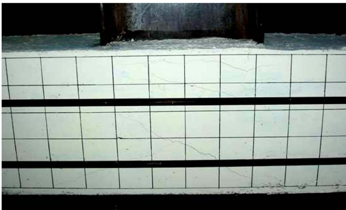
照片 4.3 試體 SRC1-VR1.38 位移  $6\Delta_y$  時 (Story Drift Angle  $\theta_t=2.86\%$  , Beam Plastic Rotation  $\theta_{bp}=1.31\%$ ) 接頭區混凝土之裂縫發展情況
