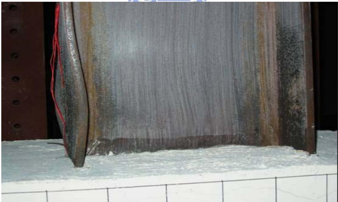
照片 4.5 試體 SRC1-VR1.38 位移  $7\Delta_y$  時 (Story Drift Angle  $\theta_t=3.34\%$  , Beam Plastic Rotation  $\theta_{bp}=1.89\%$ ) 鋼梁之塑性變形情況
