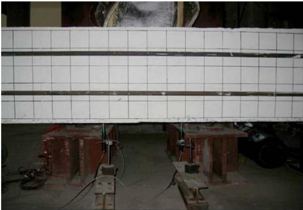
照片 3.6 位移計 (LVDT) 架設情形
