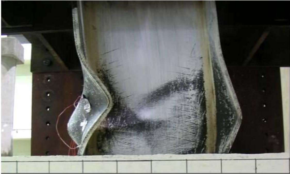
照片 4.18 試體 SRC2-VR1.15 位移  $13\Delta_y$  時 (Story Drift Angle  $\theta_t=6.20\%$  , Beam Plastic Rotation  $\theta_{bp}=5.48\%$ ) 鋼梁之塑性變形情況
