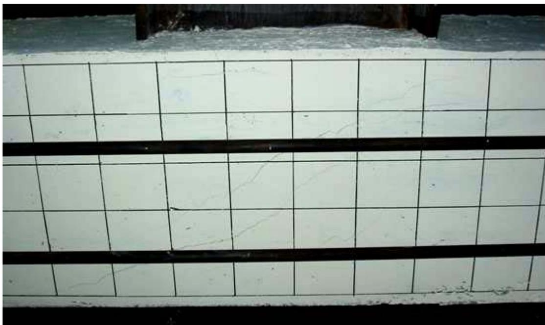
照片 4.1 試體 SRC1-VR1.38 位移  $4\Delta_y$  時 (Story Drift Angle  $\theta_t=1.91\%$  , Beam Plastic Rotation  $\theta_{bp}=0.57\%$ ) 接頭區混凝土之裂縫發展情況
