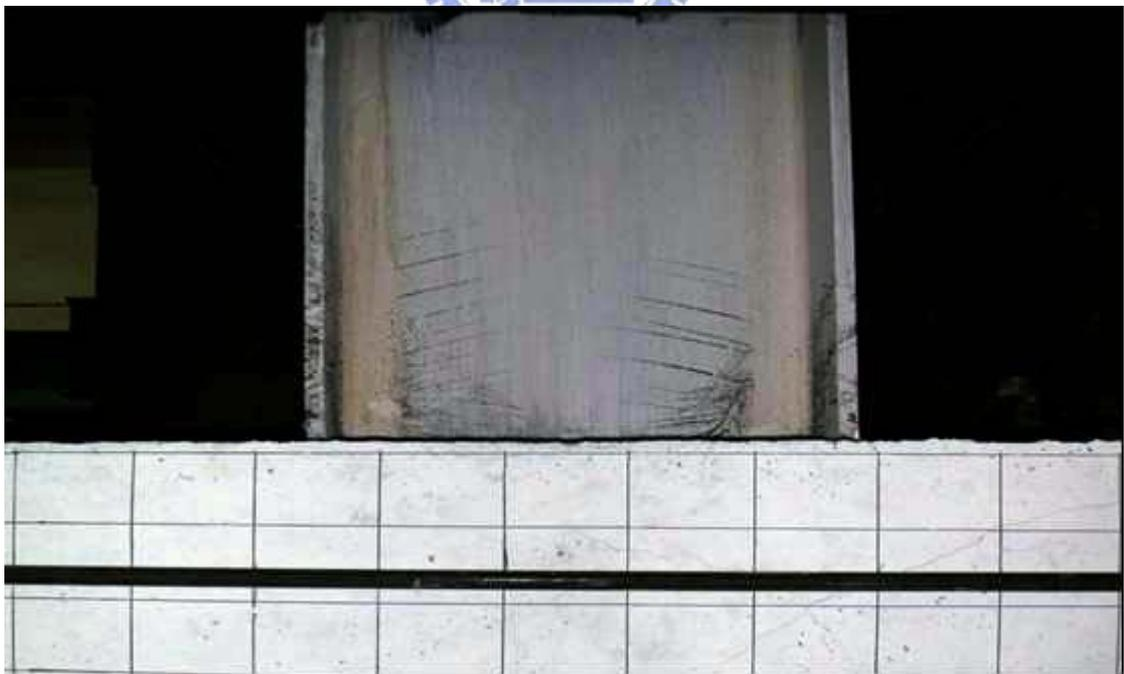
照片 4.21 試體 SRC3-VR0.98 位移  $4\Delta_y$  時 (Story Drift Angle  $\theta_t=1.91\%$  , Beam Plastic Rotation  $\theta_{bp}=0.83\%$ ) 鋼梁腹板之降伏情況
