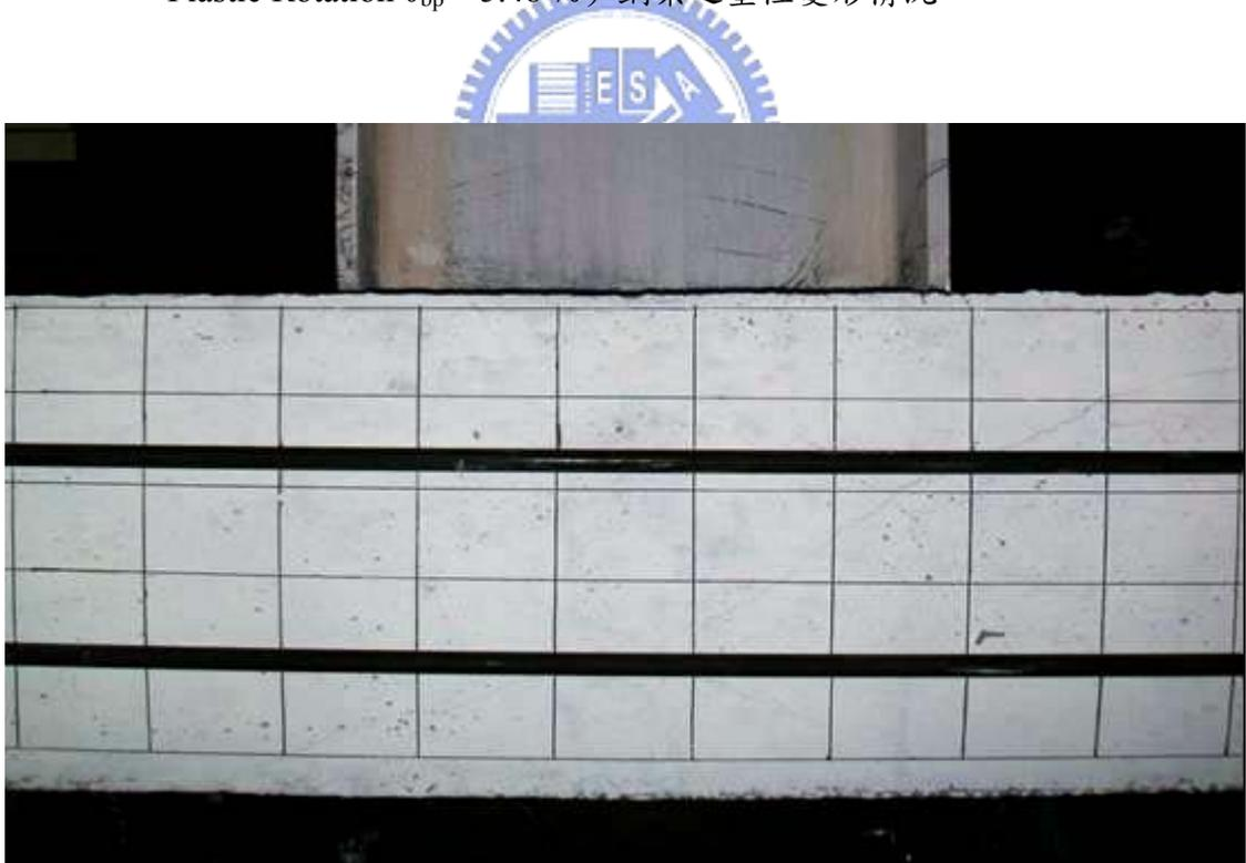
照片 4.19 試體 SRC3-VR0.98 位移  $3\Delta_y$  時 (Story Drift Angle  $\theta_t=1.43\%$  , Beam Plastic Rotation  $\theta_{bp}=0.51\%$ ) 接頭區混凝土之裂縫發展情況
