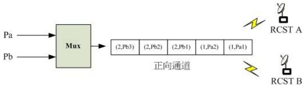
圖 8 正向通道上的多工/解多工
