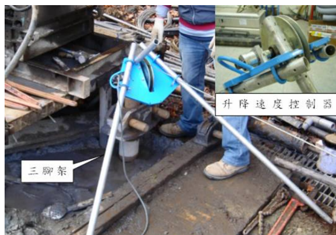
圖 3-26 三腳架與升降速度控制器架設
