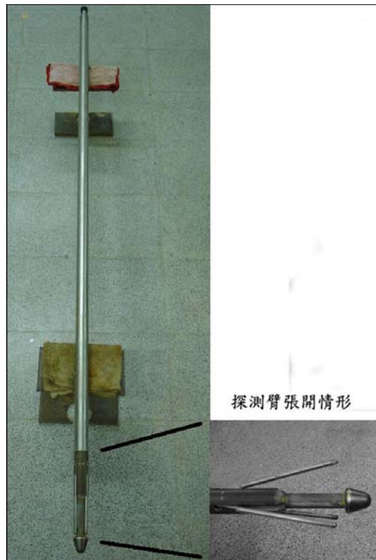
圖 3-21 三臂孔壁狀態探測器(摘自黃玉麟，2006)
