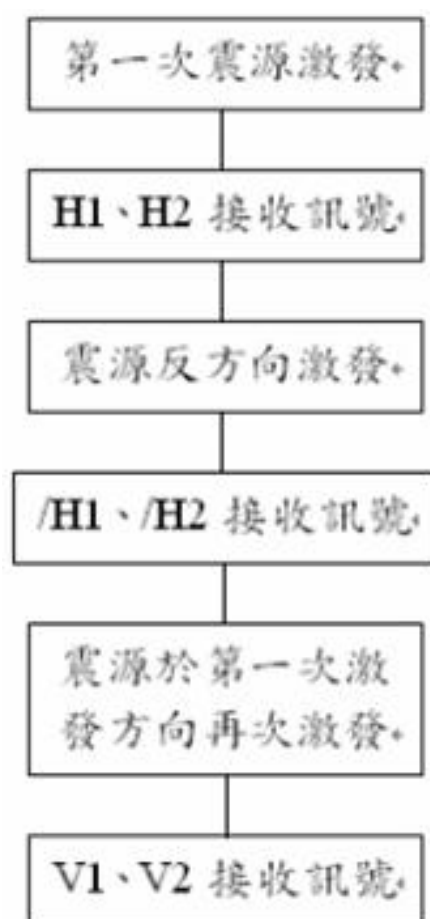
圖 3-33 P-S 波量測流程(摘自林忠義，1999)
