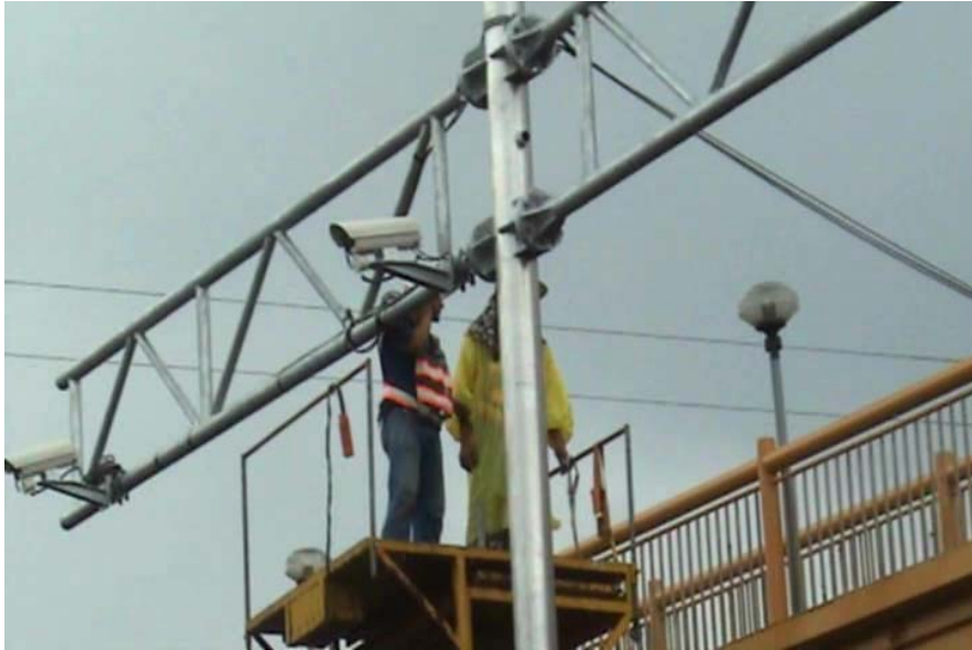
圖 6.3.4-3 人力方式搖動攝影機 CCD 支架使之據烈振動
