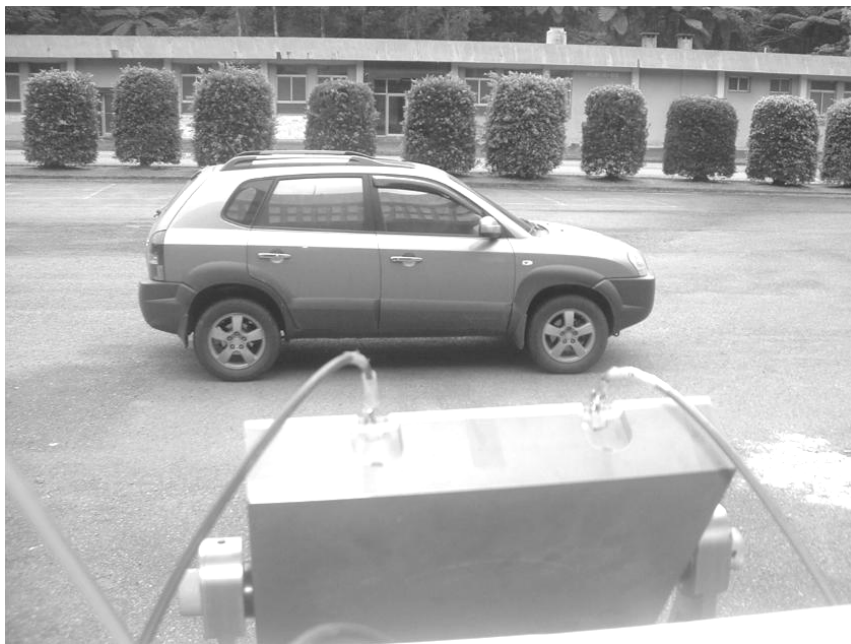
圖 4.3-5 FMCW 雷達系統之戶外實際量測圖
