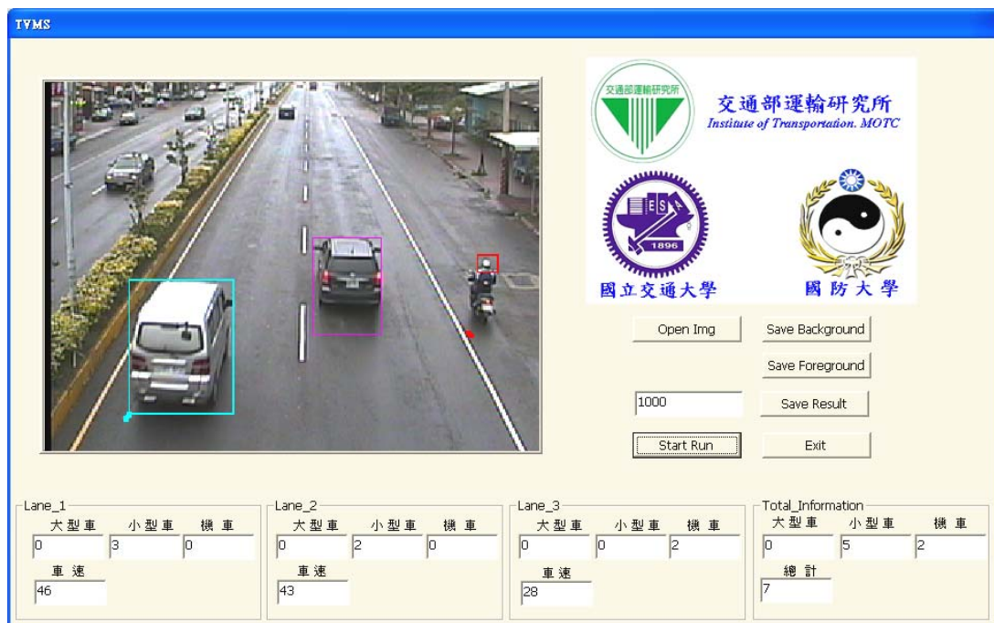
圖 6.3-2 CCD 攝影機擷取之影像辨識單元畫面
