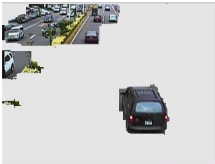
圖 6.3.4-2 中華路攝影機在受人為振動所拍攝之影像 (a)在受人為振動下之背景；(b)為在受人為振動下之及即時景像；(c)前景無法切割成所其望之狀況；(d)系統背景切割上經修正的結果
