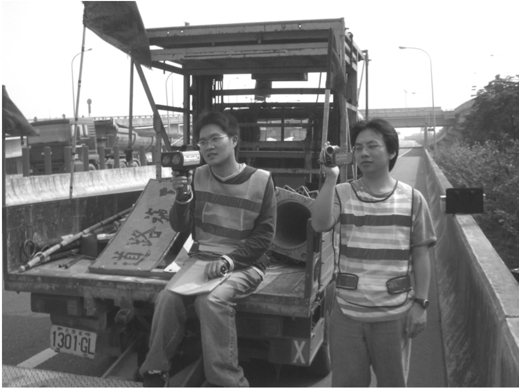
圖 6.3-5 雷射槍車速準確率測試情況圖
