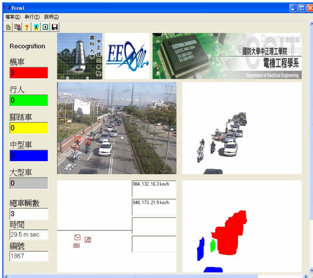
圖 5.5-2 Borland C++ Builder 編譯機車影像偵測程式
