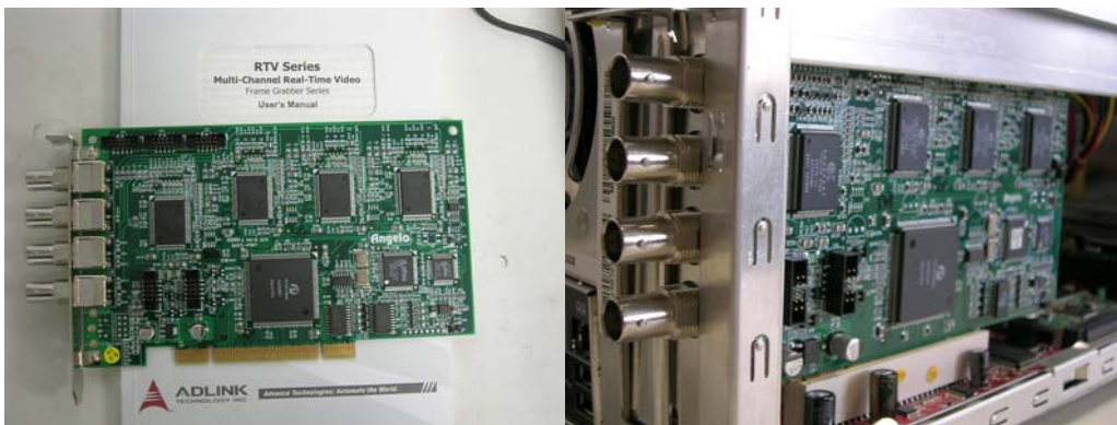
圖 4.6-1 ADLink - RTV24 高速影像擷取卡
