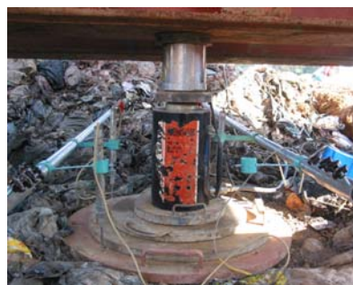
圖 22 架設 LVDT 與 Load Cell、加載
