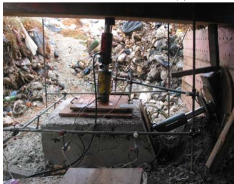
圖 12 架設千斤頂、位移感測計與荷重元
