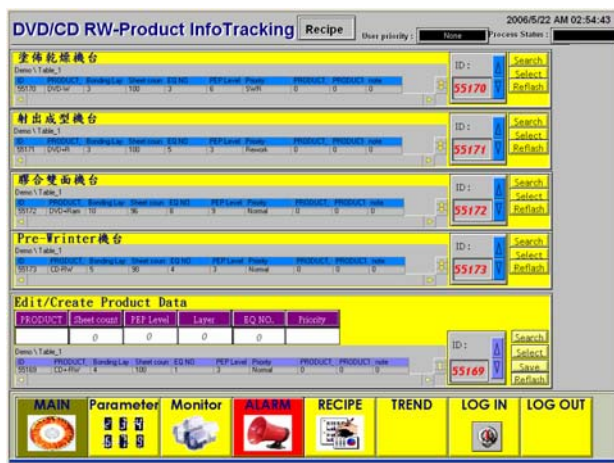
圖 5、以 WinPC32 開發光碟製程資料追蹤 Recipe Function (配方)
