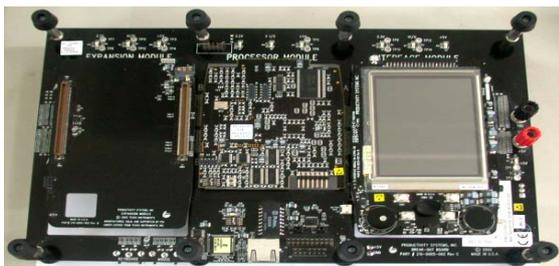
圖 1-6 ARM/DSP 系統外觀圖
