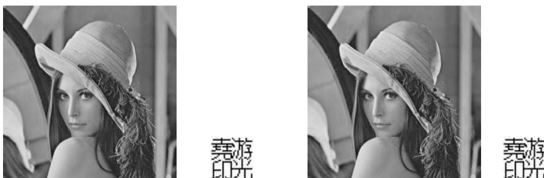
(a) (b) (c) (d) 圖(四) 在圖形未受攻擊下，嵌入數位浮水印於 HL_3 波段 (a)原始圖形 Lena (b)嵌入之數位浮水印 (c)Watermarked 影像 (PSNR=40.79dB) (d)擷取之數位浮水印
