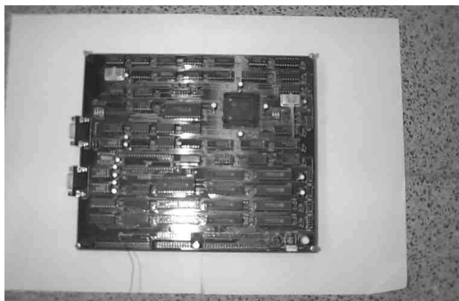
圖 1、以 TMS320C5x 為中央處理器電路母板的基本架構圖
