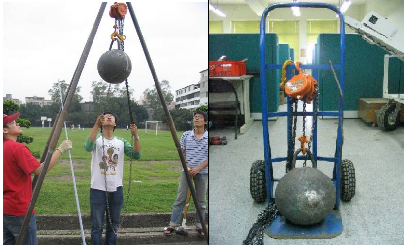
圖 3-12 自由落錘震源系統(修改自經濟部水利署，民國 94 年)
