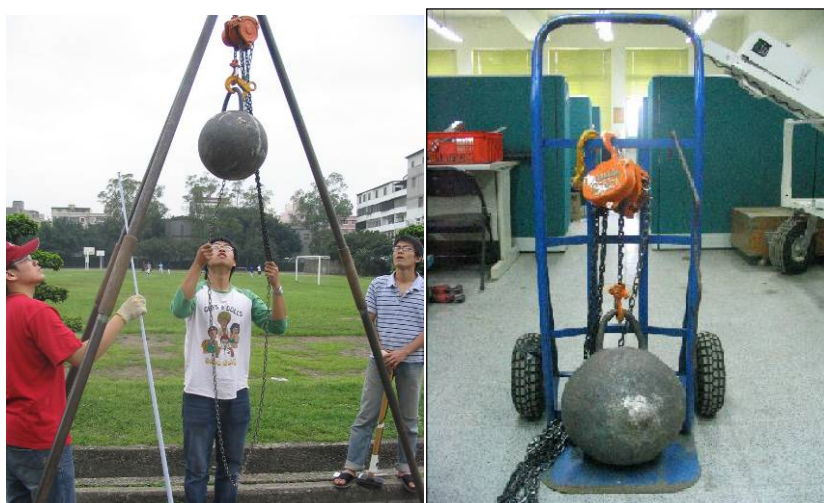
圖 A-33 自由落錘震源系統(修改自經濟部水利署，民國 94 年)
