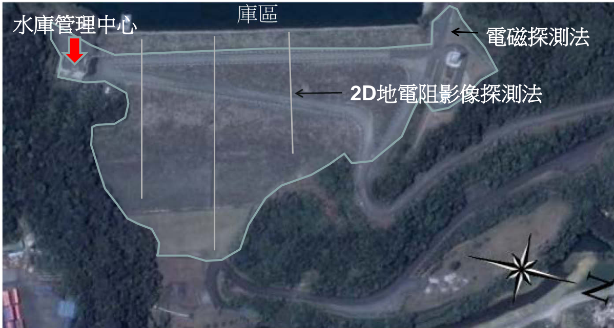
圖 5-14 新山水庫壩體及壩址滲漏問題地球物理探測技術現地施作規劃示意圖
